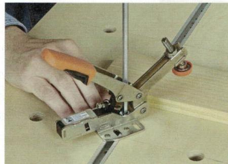
Zum Schluss können Sie noch die Schraube festziehen, um den Schnellspanner in der T-Nut zu arretieren. Der Schnellspanner funktioniert aber auch mit leicht geöffneter Schraube. Das hat den Vorteil, dass Sie ihn ohne Werkzeug in der T-Nut verschieben können.
