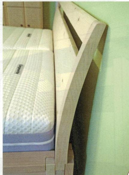
21 > Runden Sie die obere Kante des Betthauptes sowie die Kanten rund um die Ausklinkung großzügig ab. Anschließend können Sie Rahmen und Fläche verleimen. Damit das Holz arbeiten kann, wird nur auf die untersten und obersten Zentimeter der Steher Leim gegeben.
