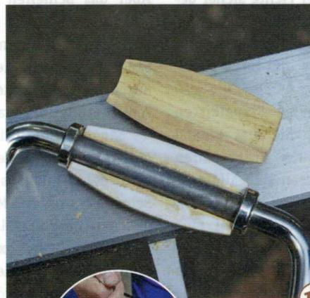
**17** > Geben Sie nun wieder Leim an und richten die beiden Hälften masergetreu aus. Spannen Sie mit mehreren Kabelbindern und lassen Sie den Griff über Nacht ruhen. Mitunter ist ein leichter Nachschliff nötig, um einen Versatz zu beheben. Dann kann auch der Kurbelgriff geölt werden.
