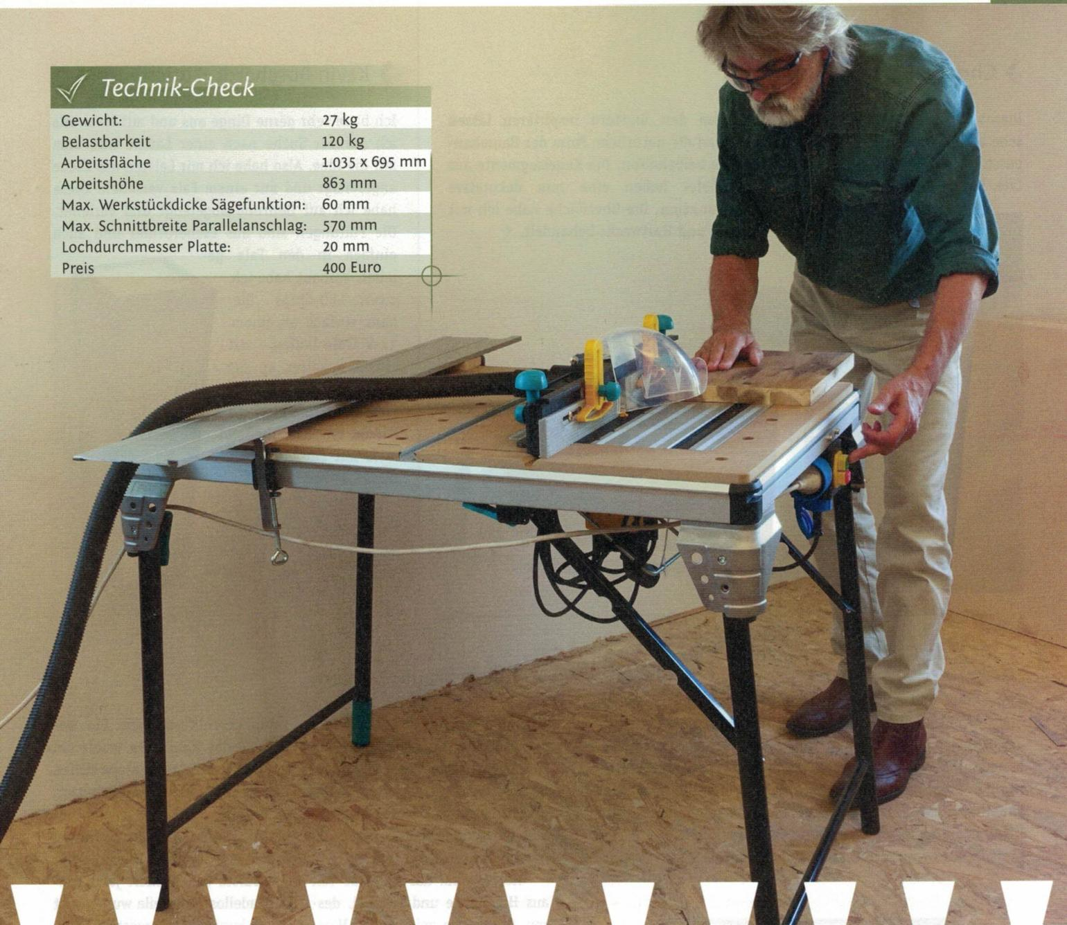
rer Anschlagreiter ermöglicht wiederholgenaue Schnitte.
