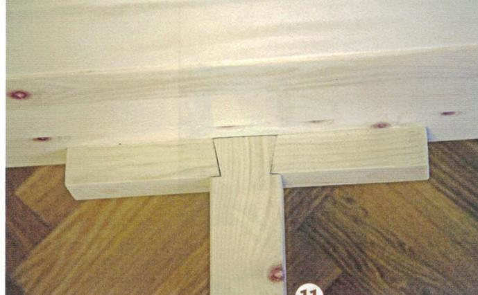
11 > Der Mittelsteg liegt schwalbenschwanzförmig an einer an Kopf- und Fußende aufgedübelten Leiste auf. Schwalbe und Ausklinkung werden von Hand gesägt und ausgestemmt. Im Zentrum des Bettes liegt der Steg auf zwei Klötzen auf, die je mit einem durchgesteckten Dübel fixiert sind (siehe Explosionszeichnung).
