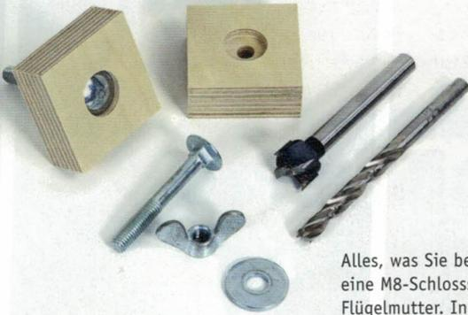
Alles, was Sie benötigen, ist ein 18 mm dickes Multiplexbrettchen (hier 50 x 50 mm), eine M8-Schlossschraube (Länge 50 - 60 mm) eine große Kotflügelscheibe und eine Flügelmutter. In das Brettchen bohren Sie zuerst mit einem 20er Forstnerbohrer mittig ein 5 mm tiefes Sackloch. Danach erst bohren Sie mit dem 8er Holzbohrer das Durchgangsloch. Stecken Sie dann die Schlossschraube in die Bohrung und schlagen Sie den Vierkant (unter dem Schraubenkopf) ins Sackloch ein.
