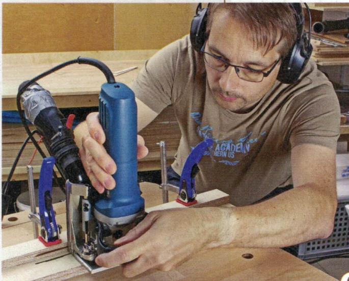
6 > Die Verbindung der drei Pfostenbretter zu einem stabilen Kreuz können Sie mit einer Flachdübelfräse, passenden Dübeln und Leim herstellen. Oder Sie bohren verteilt über die beiden schmalen Pfostenbretter (Pos. 5) je drei 3,5-mm-Löcher und schrauben diese mit 4-x-60-mm-Senkschrauben mittig auf das breite Pfostenbrett.
