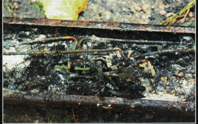
Reste eines Wackelkontakts
