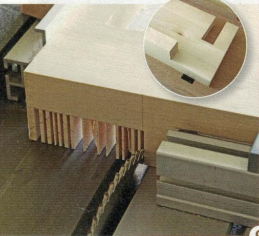
9 > Die Aufdoppelung wird im Bereich der Füße gekürzt. Sägen Sie das zu entfernende Material mit mehreren nebeneinander liegenden Schnitten an der Kreissäge ein. Die stehenbleibenden Brettchen brechen Sie von Hand und hobeln oder schleifen dann die Fläche glatt.
