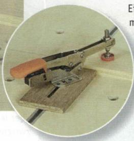
Ein Unterlegbrettchen erweitert die Möglichkeiten noch einmal: In ein 10 mm dickes Sperrholzbrettchen (150 x 80 mm) sägen oder fräsen Sie ein 100 mm langes und 8 mm breites Langloch. Mit einer 20 mm langen M8-Zylinderkopfschraube können Sie nun das Brettchen zusammen mit dem Schnellspanner in der Nut befestigen. Über das Langloch lässt sich das Brettchen als Werkstückanschlag beliebig positionieren.
