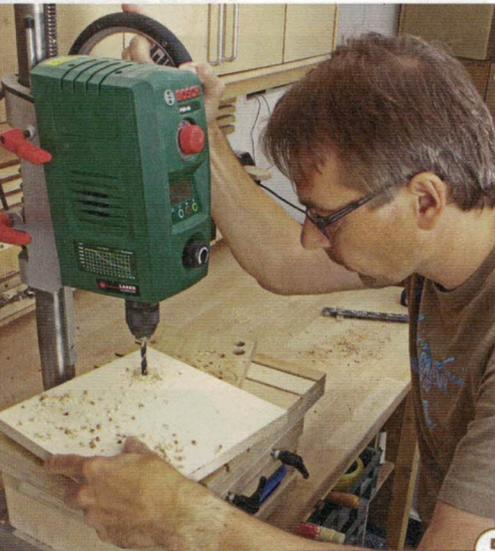
5 > Damit die Auslegerarme und der Pfosten an die Grundplatte geschraubt werden können, bohren Sie vier 8-mm-Löcher und vier 3,5-mm-Löcher in die Grundplatte.
