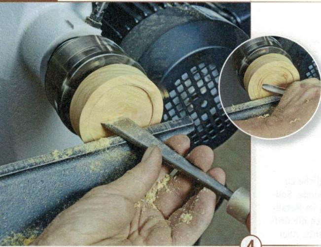
**4** > Beim umgespannten Rohling gilt es zuerst, wieder eine plane Fläche herzustellen. Die Stahlplatte am Ende misst an unserer Winde 67 x 2 mm. Das Holz soll sie ganz – also auch am Rand – überdecken. Und so fertigen Sie diese Vertiefung: Stechen Sie am Rand mit dem Abstecher drei Millimeter ein, dann folgen die Röhre zum Ausräumen und der liegende Meißel zum Glätten des Bodens.
