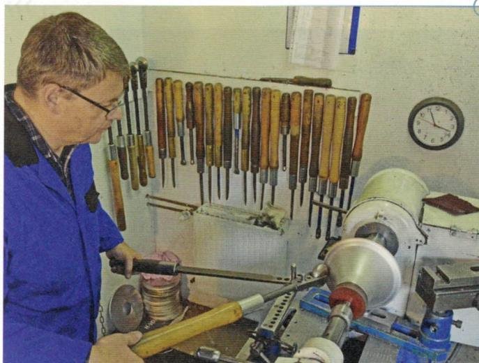
Bei größeren Projekten wie diesem Lampenschirm aus Aluminium muss schwereres Gerät ran: Rübsamen nutzt eine Handdrückrolle und verstärkt die Kraft mit einem Hebelarm.
