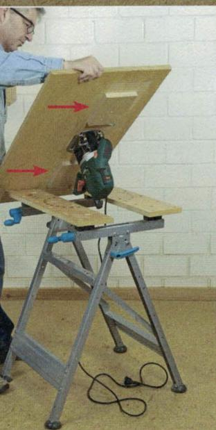
3> Alle Spanntische mit einer Spannweite von mindestens 140 mm können nun die Frästischplatte über die beiden Spannplatten (Pfeile) sicher festspannen.
