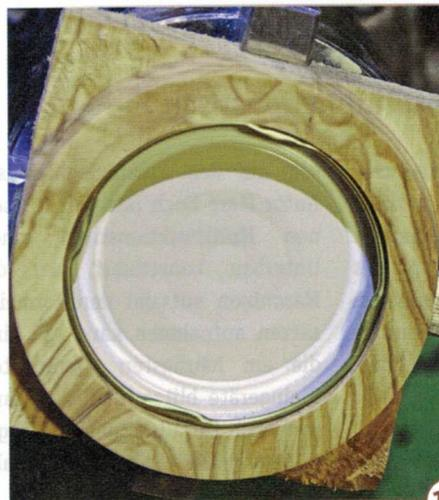
14 > Sie können auch einen Blechdeckel mit Gewinde in einen edlen Holzdeckel für Gläser verwandeln. Spannen Sie nach einer der Methoden einen Rohling und drehen ihn innen millimetergenau so aus, dass der Blechdeckel hineinpasst. Das Blech mit 120er Körnung anschleifen und mit Heißkleber fixieren.
