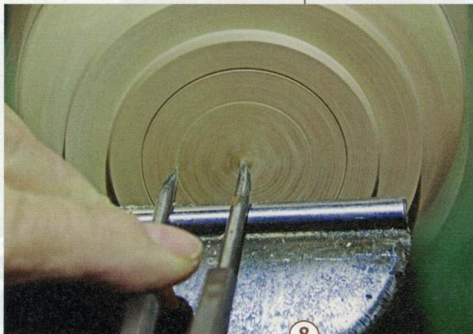
**8** > So aufgespannt, lässt sich auch ein Kapselheber im Deckelchen unterbringen. Auf der plan gedrehten Unterseite markiert der Zirkel die Durchmesser für 1) den Deckel insgesamt 2) den Falz 3) das Edelstahlblech des Kapselhebers und 4) das Aufnahme-Loch, damit ausreichend Platz für den Kronenkorken bleibt.
