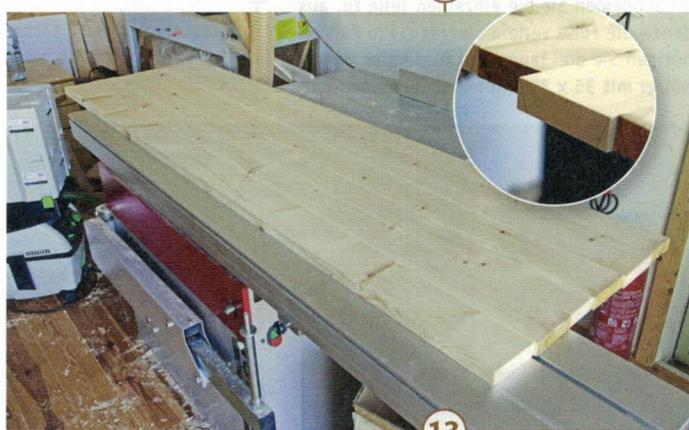
13 > Weiter geht es mit dem Betthaupt. Sortieren Sie die Bretter und markieren Sie deren Anordnung mit dem Schreinerdreieck. Zeichnen Sie am Hirnholzende der Bretter den Verlauf der Schräge an, und notieren Sie sich dort auch die Winkel.
