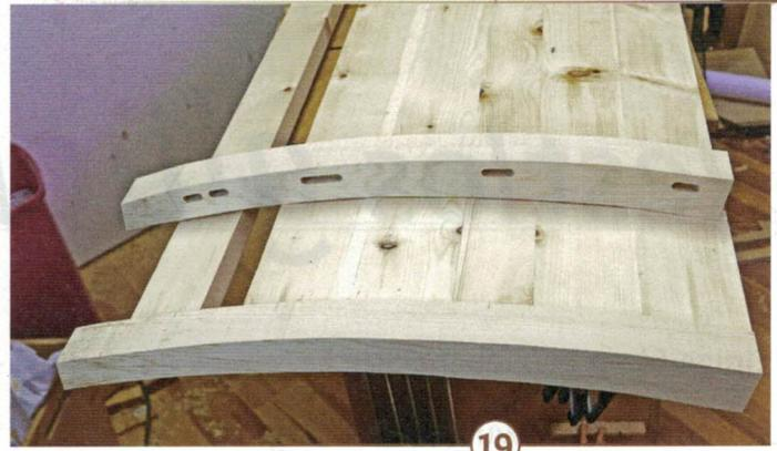
19 > Steher und Fläche des Betthauptes werden mit Dominodübeln verbunden. Damit das Holz arbeiten kann, werden nur die Dübel der Abschlussleiste und die untersten Dübel des Mitteleils passgenau gesetzt, die anderen Fräsungen erhalten extralange Langlöcher.
