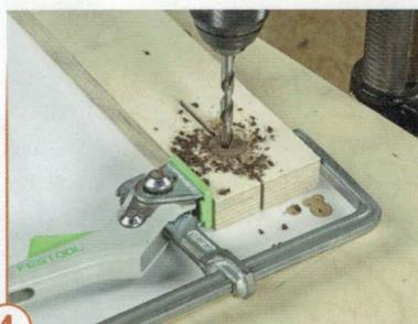
**4** > ... und klemmen Sie ihn mithilfe einer Zwinde in der Bohrung fest. Jetzt können Sie genau mittig das 7,5er-Loch bohren, ohne dass das ...
