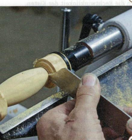
**14** > Mit einem schmalen Abstecher lässt sich nun im rechten Bereich bereits der Trennschnitt vollziehen. Das geht nur gefahrlos, sofern die Körnerspitze ohne Druck nur locker mitläuft – also unbedingt überprüfen!
