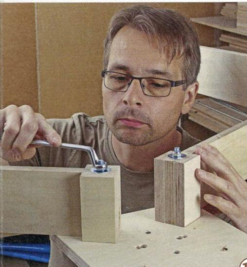
**12** > Verbinden wir nun die Grundplatte mit den Auslegerarmen. Stecken Sie die 150mm-Gewindestange durch die äußeren Bohrungen der Grundplatte und stecken Sie darauf das freie Ende des Auslegerarms. Verschrauben Sie beide Enden mit M8-Muttern und Scheiben.
