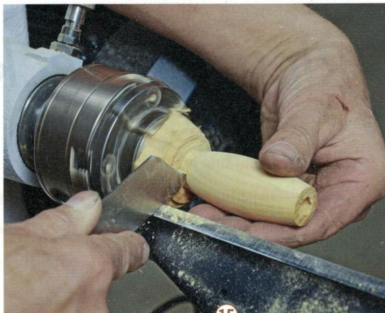
**15** > Messen Sie nun die endgültige Länge (ein kleiner Versatz zum zuvor angezeichneten Längenmaß ist normal) und stechen Sie den Kurbelgriff ab. Die Hand fängt das Werkstück dann auf.
