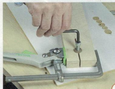
**5** > ... Dübelstück sich dabei verdreht. Zum Schluss schneiden Sie einfach mit der Zylinderkopfschraube ein Gewinde in die Bohrung ein.
