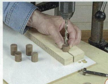
**3** > Entfernen Sie den 19er Forstnerbohrer wieder und setzen Sie einen 7,5-mm-Bohrer ein. Stecken Sie einen Dübelabschnitt in die Brettbohrung ...
