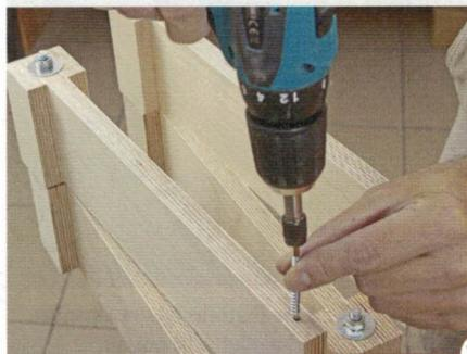
**13** > Zum Schluss werden die Stockschrauben in die Enden der Auslegerarme geschraubt. Dazu wird je eine 6x80-Stockschraube in das Ende des Auslegerarmes geschraubt, so dass sie noch etwa 20 mm herausragt. Alternativ können Sie auch Dübel einbohren.
