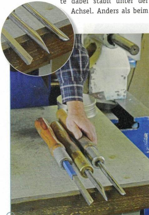
Die Druck-Werkzeuge samt Heften sind viel länger und massiver als die meisten Drechseisen. Die drei Standard-Werkzeuge für leichtere Arbeiten sind der Spitzstahl (rechts), der Flachstahl (Mitte) und der Schneidstahl zum Trimmen des Randes.
