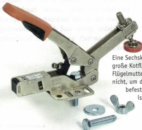
Eine Sechskantschraube M8, eine große Kotflügelscheibe und eine Flügelmutter: Mehr brauchen Sie nicht, um den Schnellspanner zu befestigen. Ein Steckbolzen ist gar nicht nötig.
