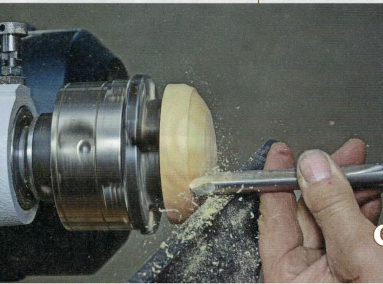
**6** > Wie der Zufall so spielt: Die eben fertiggestellte Vertiefung dient hier gleich als Aufspannmöglichkeit des umgedrehten Werkstücks, weil die Backen des Futters gut passen. Ansonsten hilft ein Spundfutter in einem Stück Restholz. Dann kann der Knauf mit einer Schalenröhre in eine schöne Form gebracht werden – Handschmeichler-Qualität ist das Ziel!
