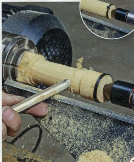
**11** > Auf Nummer sicher: Damit sich die papierverleimten Hölzer auf keinen Fall trennen, wird das Ende mit einem Kabelbinder gesichert (kleines Bild). Die potenziell spaltende Körnerspitze ist nur locker eingedreht. Reißen Sie die Länge des Kurbelgriffs an und reduzieren Sie dann die Dicke auf das Zielmaß plus zwei Millimeter, also hier 32 Millimeter.
