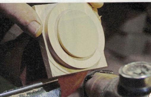
13 > Auch so wird die Deckel-Unterseite schnell fertig. Diese Methode funktioniert nur mit ausgehobelten Rohlingen. Aufnahme-Walzen in verschiedenen Durchmessern und mit grobem Schleifleinen und einem kleinen Zentrierstift versehen können nützliche Dienste leisten.
