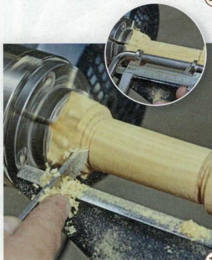
**12** > Messen Sie das Maß zwischen den Metallkragen der Winde (hier 73 Millimeter) und ziehen Sie einen halben Millimeter ab, damit der Kurbelgriff frei laufen kann. Übertragen Sie das Maß und stechen Sie jenseits der Enden auf das Außenmaß der Metallkragen (hier 22 Millimeter herunter).
