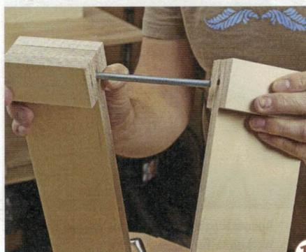
**11** > Der Zusammenbau der Auslegerarme beginnt: Legen Sie je ein Ende eines äußeren Auslegerarms auf ein Ende eines inneren. Stecken Sie nun die 250mm-Gewindestange durch und drehen auf beiden Enden selbstsichernde Muttern mit Unterlegscheiben auf.
