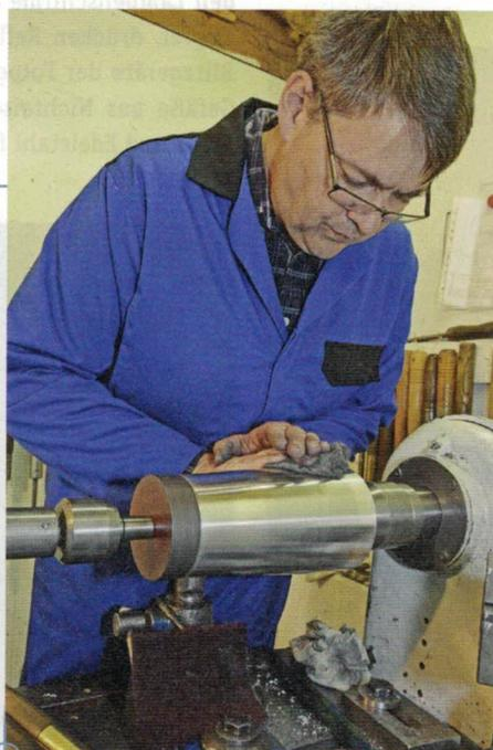
Nach einigen Durchgängen hat sich das Metall komplett über die hohe Form gelegt. Ein edles Hochglanz-Finish ist dann auch nur eine Frage von Minuten.
