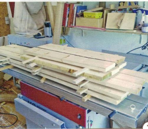
1> Bereiten Sie das Holz vor, indem Sie es abrichten und grob zuschneiden. Hobeln Sie das Holz für Zargen und Füße auf exakt dieselbe Dicke, nämlich 35 Millimeter.
