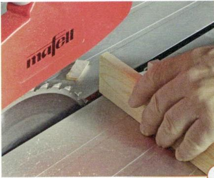
5> Hochkant gegen den Anschlag gelegt, werden die Leisten zunächst auf die ungefähre Länge gesägt. Äste und Fehlstellen werden herausgeschnitten. Von Vorteil ist bei einer Zugsäge, dass sich das Blatt und nicht das Werkstück bewegt. So kann man auch kleine Leisten noch gefahrlos festhalten.
