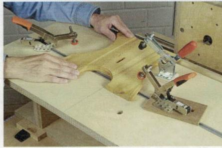
Und so spielen die Varianten äußerst flexibel zusammen: Wenn Sie den Bessey-Spanner in der T-Nutschiene zusammen mit einem Anschlagbrettchen und einen herkömmlichen Schnellspanner mit einem weiteren Anschlagbrett einsetzen, können Sie nahezu jede Werkstückform sicher und wiederholgenau positionieren.
