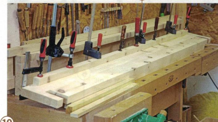
10 > Befestigen Sie nun die Lattenrostauflagen mit Dübeln und Leim an den Seitenzargen. Beachten Sie, dass die Auflagen kürzer sind als die Zargen, denn sie enden dort, wo die Füße beginnen.
