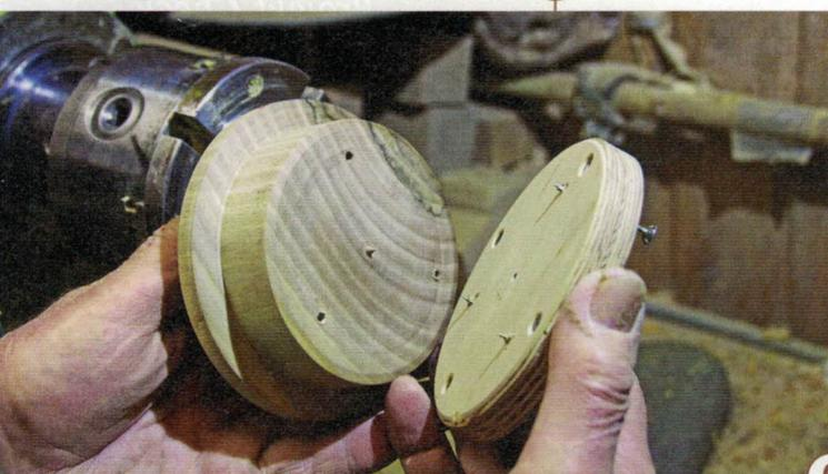
**6** > Hier eine Spannvariante: Nehmen Sie einen Langholzklotz im Futter auf, drechseln Sie ihn rund und schrauben Sie mit drei Schrauben eine Multiplex-Scheibe auf. Auf der anderen Seite der MPX-Scheibe ragen vier kleine, flachgefeilte Schraubenspitzen heraus (hier verdeckt).
