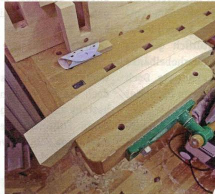
20 > Stecken Sie Steher und Fläche des Betthauptes probeweise zusammen und markieren Sie den Verlauf des Betthauptes an den Rahmenteilen (Steher sowie oberstes und unterstes Brett). Stecken Sie nun die beiden Rahmenteile lose mit Dübeln zusammen und schleifen Sie diese im Paket bis zur Markierung. Klinken Sie die Steher aus, damit sie in die Füße passen.
