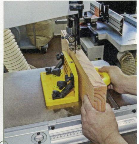
Die Universalführung hat mittig einige Rollen. Direkt am Sägeband positioniert dient sie als Anschlag beim Herunterschneiden dünner Brettchen an der Bandsäge.
