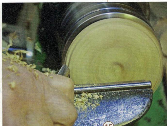
15 > Spannen Sie jetzt um, indem Sie mit vier Backen von innen spreizen. Die Oberseite des Deckels kann jetzt sicher profiliert und handfreundlich geschliffen werden.
