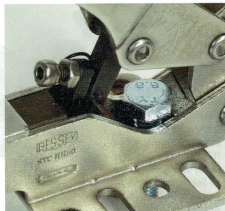
Der Sechskantkopf passt perfekt in den Schnellspanner. Ein Durchdrehen ist unmöglich und somit benötigen Sie auch keine zusätzliche Gewindehülse.
