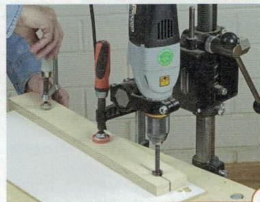
**2** > Stellen Sie sich zuerst ein Holzbrett mit einer 19-mm-Bohrung her. Sägen Sie mit der Stichsäge einen etwa 3 mm breiten Schlitz durch diese Bohrung hindurch. Dann senken Sie den stehenden Bohrer in das Loch und befestigen das Brett mit zwei Zwingen auf dem Bohrtisch.
