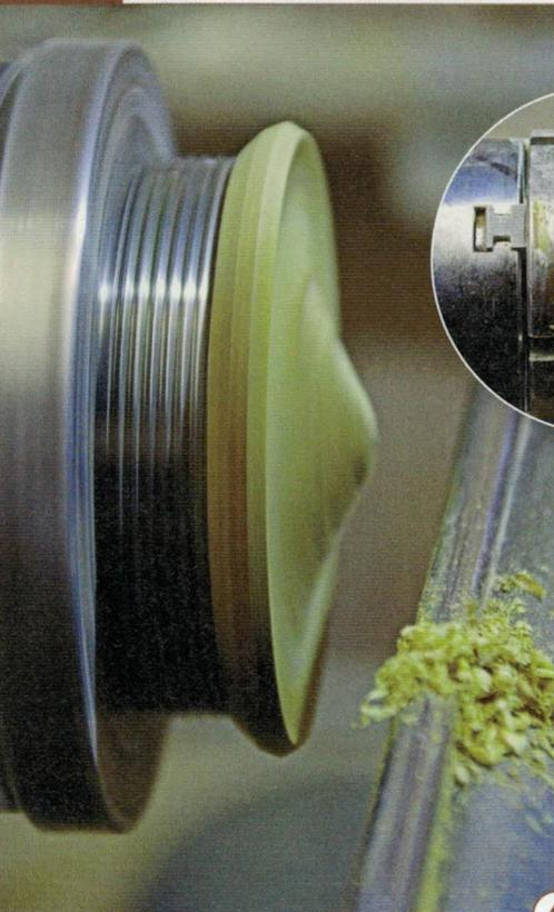
**4** > Klemmen Sie nun den Deckel ins Vierbackenfutter. Alle bekannten Hersteller bieten geeignete gerade Backen an. Dann beginnt der Endspurt: Entfernen Sie die restlichen Ecken und profilieren Sie mit sehr scharfen Röhren ziehend die Oberseite.
