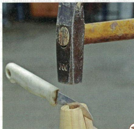
**16** > Mit einem dünnen Messer und einem kleinen Hammerschlag spaltet sich der Rohling sofort an der Papiernaht. Die Kontaktflächen werden mit einem auf einen planen Untergrund (Abriecht-Tisch, Glasplatte) aufgelegten Schleifpapier gesäubert.
