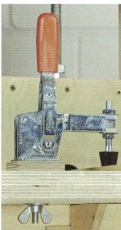
Der Schnellspanner wird einfach von oben in die Tischbohrung eingesteckt und von unten mit einer U-Scheibe und Flügelmutter fixiert. Das Ganze dauert höchstens 15 Sekunden und die Kosten belaufen sich auf weniger als drei Euro!
