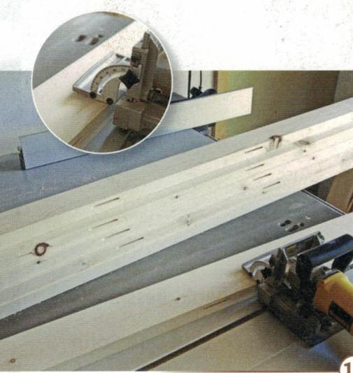
15 > Flachdübel (Formfedern) erleichtern die Verleimung des Betthauptes. Passen Sie den Winkelanschlag der Flachdübelfräse an das jeweilige Brett an. Die Flachdübel lassen kleine Winkelabweichungen aber zu. Der Winkel muss also nicht auf das zehntel Grad perfekt sein.
