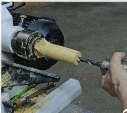
**10** > Drehen Sie das freie Ende plan und bohren Sie für die Aufnahme der Kurbel. Sie misst in unserem Beispiel 12 mm im Durchmesser. Damit sich der Kurbelgriff drehen kann, addieren Sie einen halben Millimeter. Bohren Sie so tief wie möglich. Gehen Sie langsam vor, sichern Sie beim Herausziehen das Bohrfutter mit der Hand.
