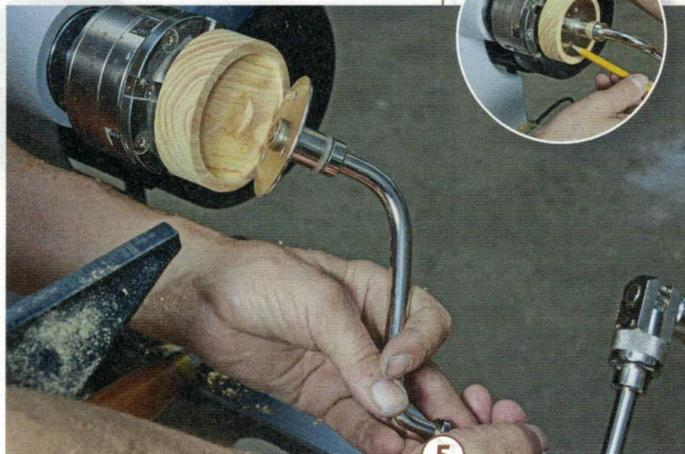
**5** > Drechseln Sie für das Lagerende noch eine passende Vertiefung, so dass sich das Endstück der Bohrwinde in den Knauf versenken lässt. Anders als beim Plastikvorgänger ist die Stahlkante elegant umschlossen. Zeichnen Sie bereits jetzt die Bohrlöcher an und bohren Sie für die drei Befestigungsschrauben. Bei der Bohrtiefe kommt es auf den Millimeter an – je nach Länge der Originalschrauben, die wir hier wiederverwenden.
