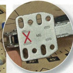
Mit einem HSS-Metallbohrer können Sie das Loch aber leicht selbst herstellen. Es liegt genau mittig zwischen den beiden vorderen Laschen, die von unten gut sichtbar sind. Können Sie das Loch vorher an und senken Sie die Bohrposition dann mit einem kleineren Bohrer an.
