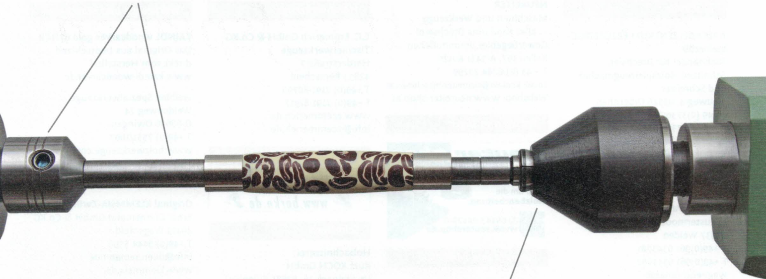
Mitlaufende Körnerspitze mit Spannange D=6,3 mm
