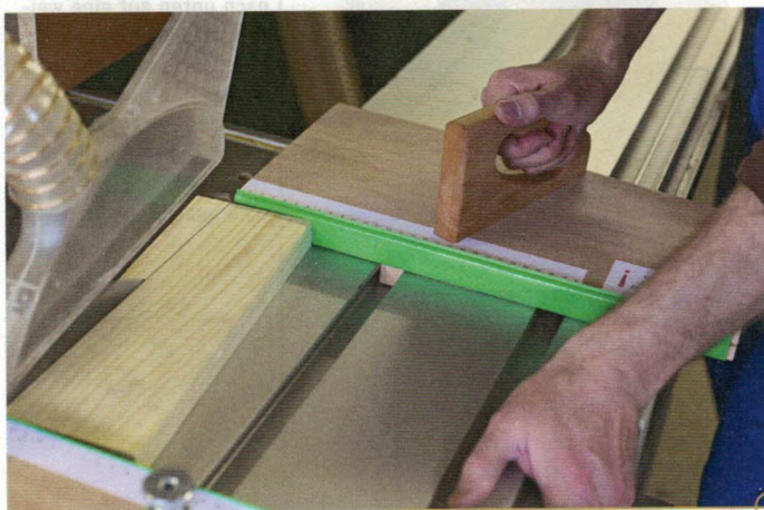
„Fritz und Franz“: Die Doppel-Vorrichtung für die Formatkreissäge macht unmögliche Schnitte möglich.
