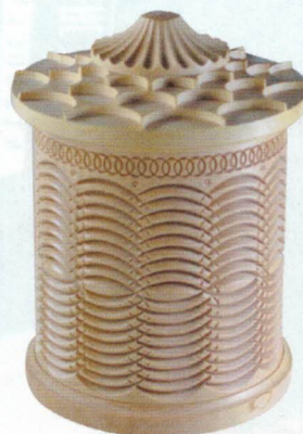
Mit aufwändiger Technik mechanisch hergestellte Ornamente an gedrechselten Formen (Ornamentalturning nach „Holtzapffel“)
