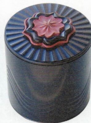
Mit aufwändiger Technik mechanisch hergestellte Ornamente an gedrechselten Formen (Ornamentalturning nach „Holtzapffel“)
