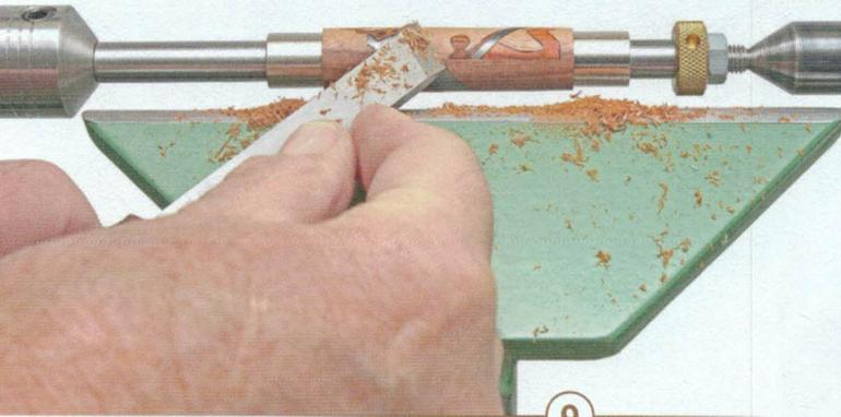
**9** > Hier ist der Rohling zur Bearbeitung auf der Drechselbank. Die Zentrierbohrung der Mandrel-Achse dient als Gegenlager, die Körnerspitze muss nur spielfrei in der Zentrierbohrung sitzen. Die Pinole ist beim Drechseln arretiert. Verwenden Sie von Anfang an keine Röhre, wie sonst üblich, sondern nur einen sehr scharfen Meißel. Wählen Sie ca. 2400 U/min.
