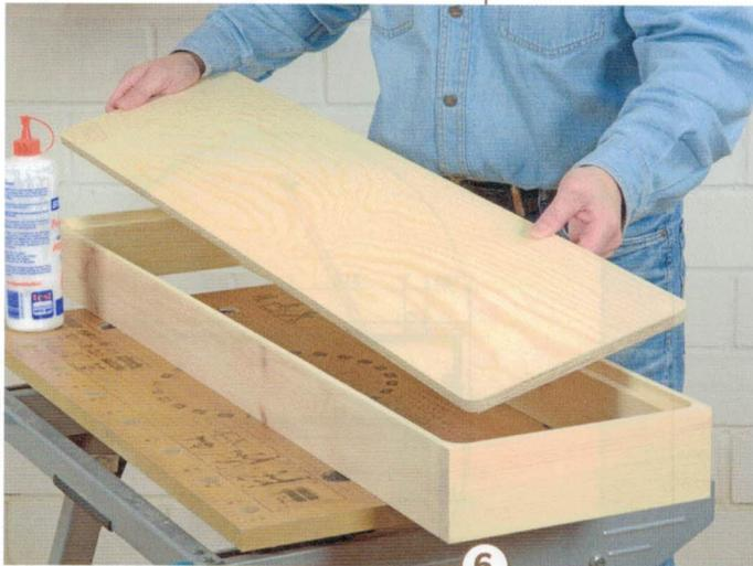
6> ... Führungsschienenadapter ein oder bauen sich mit zwei 8-mm-Gewindestangen selbst eine Abstützung. Zum Schluss sägen Sie den Boden exakt auf Maß zu, runden die Ecken und leimen ihn im Falz ein.
