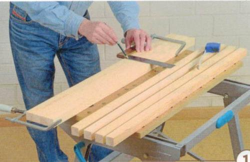
1 > Legen Sie die hinteren langen Stuhlbeine zusammen und zeichnen Sie sich die Position der Längnut (in der später der Edelstahlstab läuft) und das 8-mm-Dübelloch für den Rundstab an.
