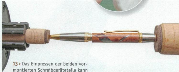
**13** > Das Einpressen der beiden vormontierten Schreibgeräteeile kann sehr gefühlvoll mit der Pinole auf der Drechselbank erfolgen. Mit einer Hand richten Sie das einzupressende Teil aus und mit der anderen betätigen Sie den Vorschub der Pinole mit dem Handrad. Der Filzbelag schützt die Teile vor Druckstellen oder Kratzern.
