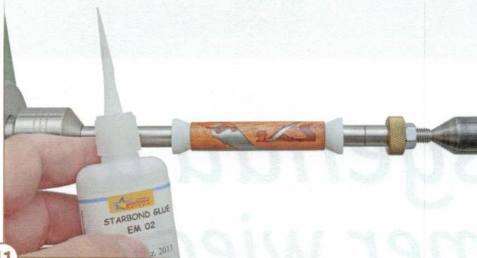
**11** > Mit dieser Aufspannung schleifen Sie die Oberfläche von K 240 bis K 600 bei 1400 U/min. Nach tadellos geschliffener Oberfläche erfolgt eine Versiegelung mit CA-Kleber EM 02 (ohne Beschleuniger!). Der überschüssige Kleber muss sofort sauber abgewischt werden. Die CA-Kleber-resistenten „Non-stick bushings“ verhindern ein ungewolltes Verkleben mit dem Mandrel. Dann muss die Oberfläche gut trocknen.
