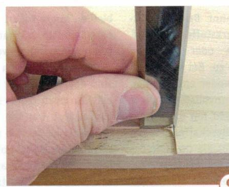
9> Da die Fräse nun einmal runde Ecken macht, müssen diese mit einem Stemmeisen nachgestochen werden, damit das eckige Scharnier in die Ausfräsung passt.
