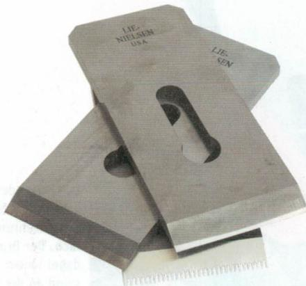
Erst mit unterschiedlich geschliffenen Hobeisen können Sie das volle Potenzial dieses Hobels nutzen. Die Grundausstattung sollte aus einem auf 25° geschliffenen Eisen und einem Eisen mit einem Fasenwinkel von 35° bestehen. Das Zahneisen ist optional und kann für den schnellen Materialabtrag eingesetzt werden.
