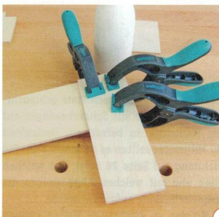
**2** Die Einzelteile werden schrittweise miteinander verleimt. Die untere Lage stabilisiert und verbindet die Teile der oberen Lage miteinander. Die Streifen der Unterlage messen in unserem Beispiel 221 x 80 mm sowie 100 x 90 mm. Geben Sie nur wenig Leim an, damit die Teile nicht verrutschen. Federzwingen halten alles sicher am Platz.
