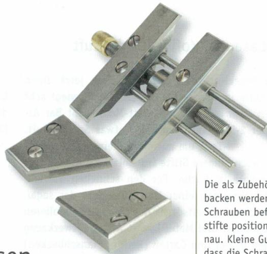
Die als Zubehör erhältlichen Spannbacken werden mit jeweils zwei Schrauben befestigt. Je zwei Passstifte positionieren die Backen genau. Kleine Gummiringe verhindern, dass die Schrauben herausfallen.
