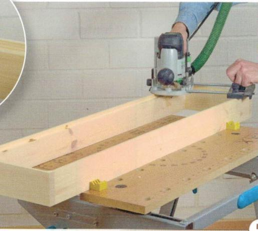
5> In die untere Tischzarge fräsen Sie anschließend mit einem Falzfräser samt Kugellager einen Falz für den Sperrholzboden. Damit die Oberfräse dabei auf den schmalen Zargenkanten nicht abkippt, setzen Sie den ...
