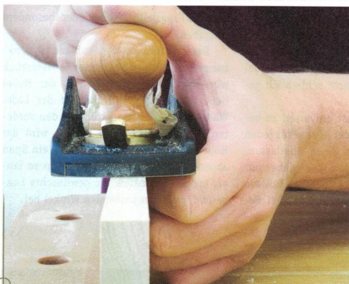
Beim Bearbeiten von Kanten greift man am besten mit der vorderen Hand um den Hobel herum. Die Finger an der Sohle sind wie ein Anschlag und verhindern, dass der Hobel seitlich abdriftet.
