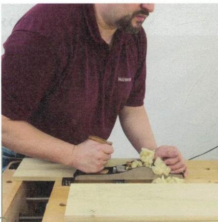
Vor allem bei maschinell gehobeltem Holz, das bereits eben ist, merkt man kaum einen Unterschied zwischen dem recht langen No. 62 und einem kürzeren Putzhobel. Durch schräges Anstellen des Hobels kann man die effektive Auflagefläche aber auch verkürzen.
