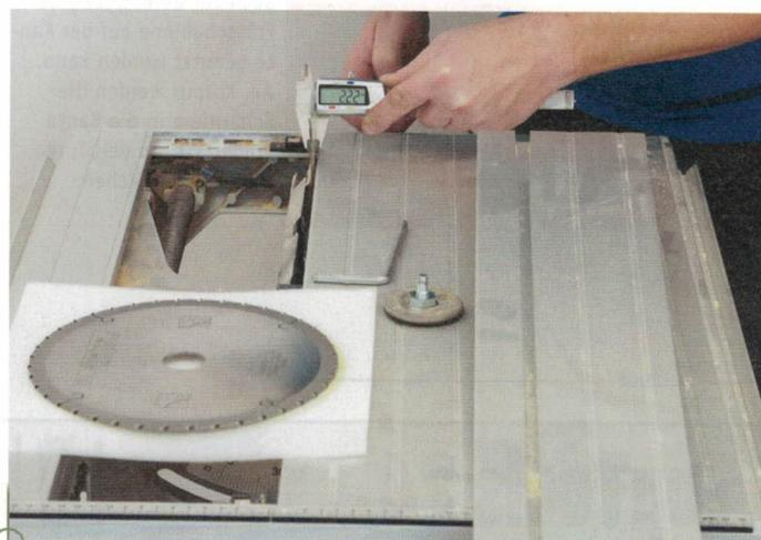
Der Spaltkeil darf nur zwischen 2 und 2,4 mm dick sein, wenn Sie die mit Diamant besetzten Sägeblätter verwenden möchten. Eine sorgsame Handhabung dieser Blätter zahlt sich aus: Benutzen Sie zum Ablegen eine weiche Unterlage, dies schon das Sägeblatt bei der Montage und auch bei der Aufbewahrung.
