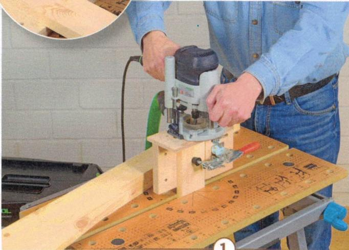
**1** Die Tischzargen werden mit Runddübeln aus Eiche verbunden. Diese Dübellöcher können Sie passgenau und absolut senkrecht mit einer solchen Vorrichtung einbohren.
