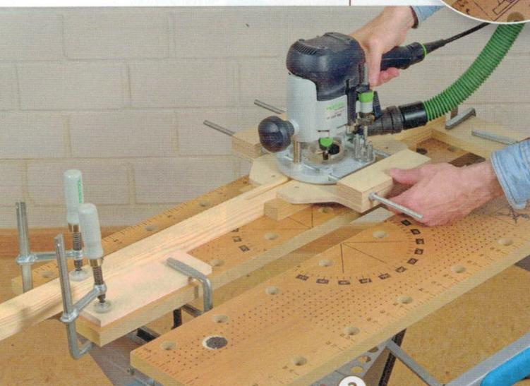
3 > Das geht am einfachsten, wenn Sie die Parallelanschlüge so einstellen, dass der Nutfräser beim Drehen der Maschine die Nut um einen Millimeter erweitert. Stopplötze auf dem Arbeitstisch begrenzen die Nutlänge.
