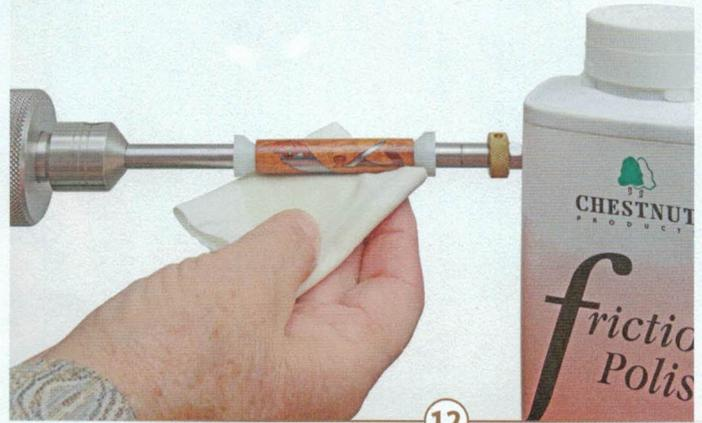
**12** > Am nächsten Tag wird die Oberfläche nochmal ganz leicht mit K 800 oder Schleifvlies K 1000 überschleifen. Abschließend können Sie die Hülse, wie hier zu sehen, mit „Friction Polish“, behandeln. Sie können die mit CA-Kleber versiegelte Oberfläche auch direkt an einer Polierscheibe auf Seidenglanz bringen.
