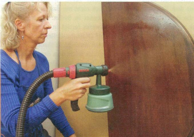
Ob Sprühsystem oder Sprühdose: Beides benötigt etwas Übung und die richtige Technik. Etwa sollten Sie nicht wie hier gezeigt ohne Maske arbeiten und das Werkstück nicht senkrecht platzieren. Wie Sie beim Spritzen Fehler vermeiden, erfahren Sie im zweiten Teil des Artikels.
