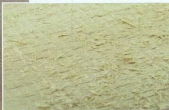
Fürs grobe Schruppen wird das Hobelmaul weit geöffnet, sonst verstopft es. Beim Hobeln mit einem Zahneisen quer zur Wuchsrichtung des Holzes entstehen keine langen Späne, sondern ganz kurze. Das verhindert tiefe Ausrisse, hinterlässt aber eine raue Oberfläche.
