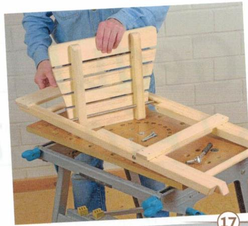
17 > Stecken Sie als nächstes den Sitz mit dem Edelstahlstab links und rechts in die Längsnut und befestigen Sie ihn ebenfalls mit Schlossschraube, U-Scheibe und Sicherungsmutter an den Vorderbeinen.
