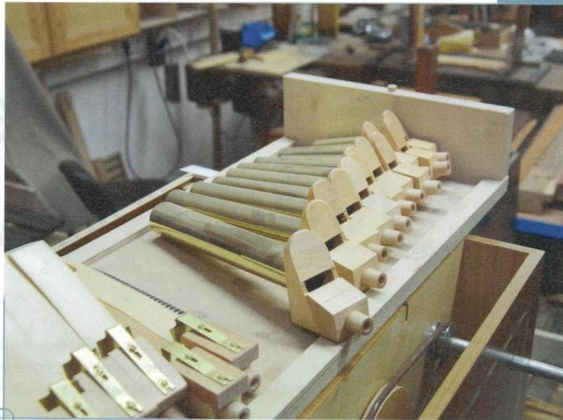
Modellbau-Fähigkeiten sind bei der Anfertigung auch der hölzernen Bestandteile der Messingpfeifen gefragt.
