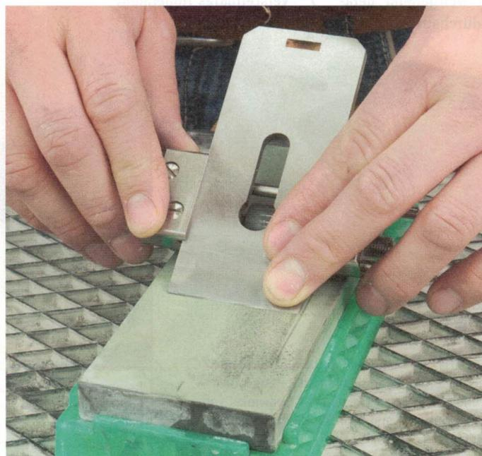
Das Verrunden der Schneide geht mit einer Schleifführung sehr einfach. Der Druck erfolgt dabei immer abwechselnd an der rechten und linken Außenkante des Hobeisens. Mit einer Leiste oder einem Winkel kann man die Stärke der Verrundung prüfen.
