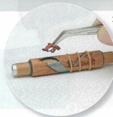
3> Bauen Sie nun die Puzzleteile mit einer abgewinkelten Pinzette trocken ein. Bei diesem Motiv beginne ich mit dem Unterteil des Hobels und baue an diesem Teil weiter an. Gummiringe oder schmale Malerkreppstreifen fixieren die Teile.
