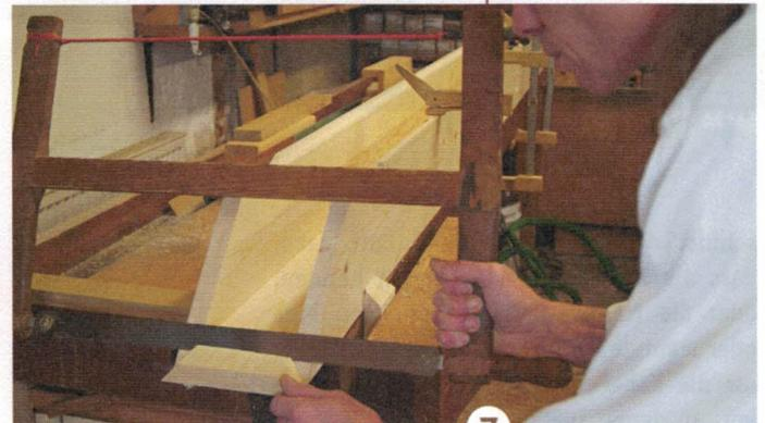
**7** > Die jetzt überlangen und noch nicht auf Gehrung geschnittenen Enden der Mittelteile (Unterseite der Verkleidung) schneiden Sie am besten mit einer schräg gestellten Absetzsäge ab. Die bereits bearbeiteten Enden der Seitenteile dienen hierbei als exakte Führung.
