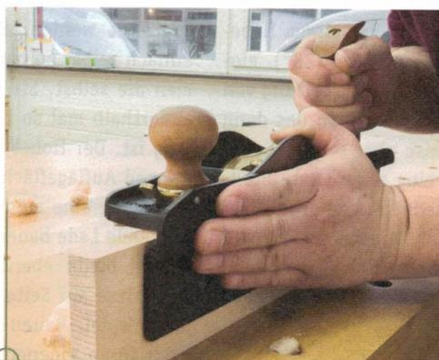
Werden rechteckige Kanten benötigt, kann ein solcher Fügeanschlag gute Dienste leisten. Er wird mittels Magnet am Hobelkörper gehalten. Die Handhaltung beim Hobeln ist so, dass auch seitlicher Druck auf den Anschlag ausgeübt wird.
