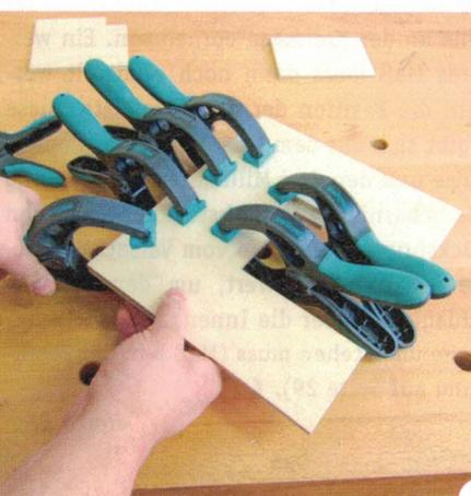
**3** Nach einer kurzen Abbindezeit von etwa zehn Minuten können die Zwingen bereits abgenommen werden. Die nächsten Teile werden dann angeleimt. In drei bis vier Schritten wird die Schablone auf diese Weise fertiggestellt.
