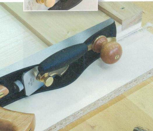
Bei der Arbeit an der Stoßlade wird der Hobel auf der Seite liegend geführt. Mit einem möglichst flachen Schnittwinkel und einem scharfen Hobeisen entsteht auch am Hirnholz ein zusammenhängender Span und kein Holzstaub.
