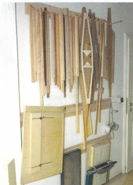
Fräs- und Bohrmodelle sowie viele Anrissstäbe werden fein säuberlich an einer Werkstattwand aufbewahrt.
