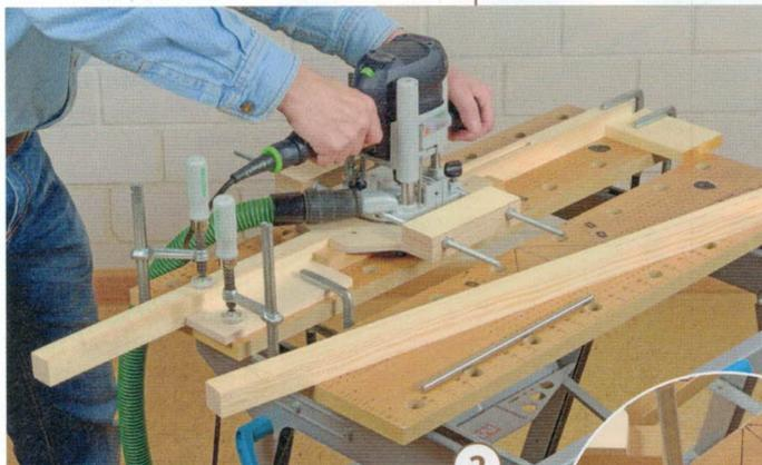
2 > Montieren Sie zwei Parallelanschlüge an die Oberfräse, die das Stuhlbein quasi ein-klemmen. Mit einem 10-mm-Nutfräser fräsen Sie jetzt die Längsnut heraus. Die Breite sollte etwa 11 mm betragen (s. kleines Bild).
