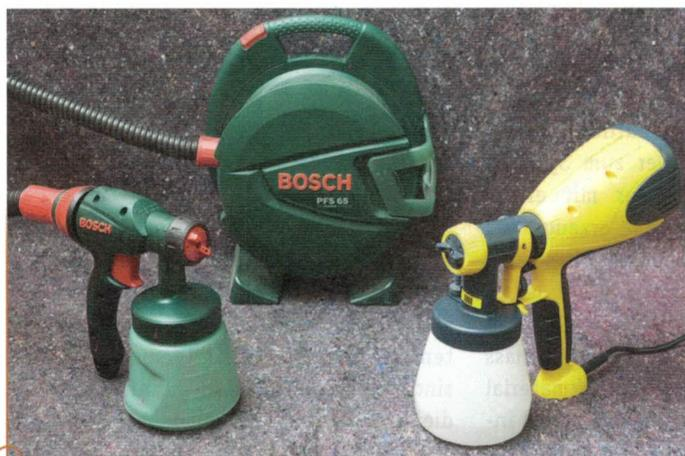
Links im Bild ist beispielhaft eine PFS Feinsprühpistole von Bosch mit separater Basis-/Pumpeinheit zu sehen. Sie ist vor allem für Lasuren, Grundierungen und Lackfarben, sowohl wasser- als auch lösemittelverdünnt, geeignet. Mit dem Farbsprühsystem W 100 von Wagner, rechts im Bild, kann man die gleichen Oberflächenmittel verarbeiten. Hier ist die Pumpe in der Pistole eingebaut.
