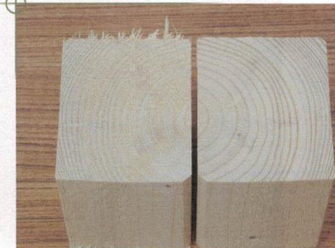
Die Werkstücke links in allen drei Bildern wurden mit einem herkömmlichen, die auf der rechten Seite mit einem mit Diamant bestückten Sägeblatt gesägt. Beim linken Bild wurden alle Unterseiten nach dem Sägen nach oben gelegt. Auf dem rechten Bild sieht man das Schnittbild auf einem Kantholz aus Fichte im Detail. Die wesentlich glattere Oberfläche bedarf kaum Nacharbeit.
