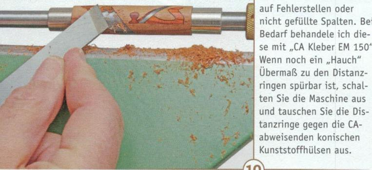
**10** > Der 13-mm-Flachmeißel eignet sich gut zur behutsamen Abnahme von geringen Spandicken. Kontrollieren Sie die Oberfläche in kurzen Abständen auf Fehlerstellen oder nicht gefüllte Spalten. Bei Bedarf behandle ich diese mit „CA Kleber EM 150“. Wenn noch ein „Hauch“ Übermaß zu den Distanzringen spürbar ist, schalten Sie die Maschine aus und tauschen Sie die Distanzringe gegen die CA-abweisenden konischen Kunststoffhülsen aus.
