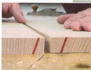
Kanten, die zum Verleimen gefügt werden, müssen nicht zwingend exakt im rechten Winkel zur Fläche stehen. (Die roten Striche zeigen das in übertriebener Darstellung an). Das Fügen zweier Bretter gleichzeitig funktioniert jedoch nur, solange beide Bretter zusammen nicht breiter als das Hobeisen sind.
