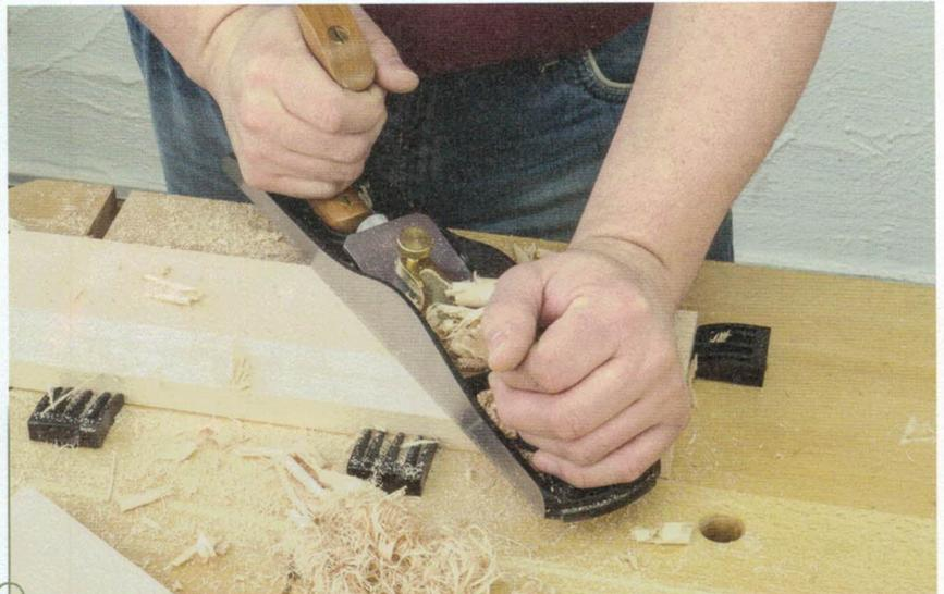
Soll möglichst viel Material in kurzer Zeit abgetragen werden, führt man den Hobel schräg, fast quer zur Holzfaser. Wenn man die Richtung beim Hobeln immer wieder wechselt, geht es sogar noch schneller. Durch das gezahnte Eisen ist der Kraftaufwand dabei recht gering.
