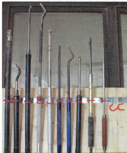
Um die Sicherheit zu erhöhen, können Sie unter die mit Gummi bezogenen Haken noch eine Leiste an die Wand dübeln und so ein Abrutschen der Werkzeuge verhindern.
