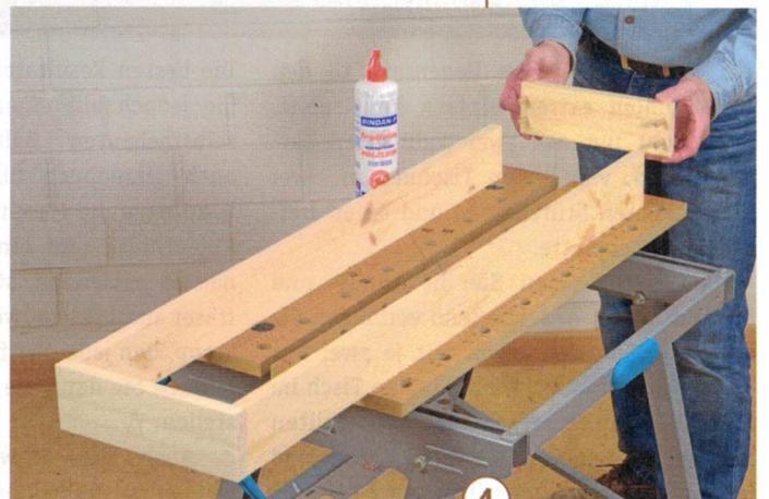
**4** Wichtig: Die Längszargen bekommen die Runddübel in die Stirnenden, die kurzen Quersargen hingegen in die Brettfläche. So verdecken später die Tischbeine das Stirnholz der Quersargen.
