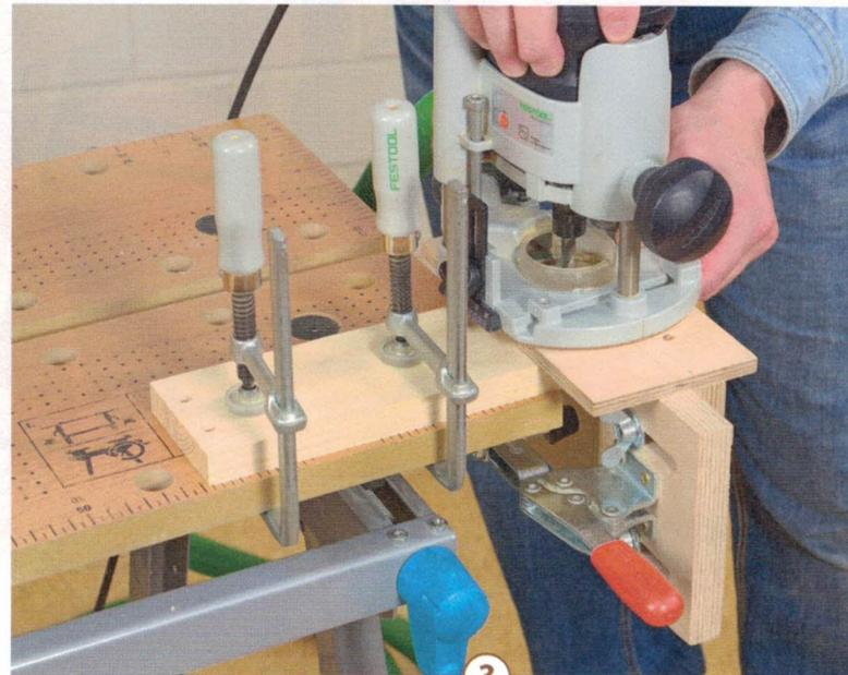
**3** Auch für die Dübellöcher in der Zargenfläche können Sie die Vorrichtung einsetzen. In diesem Fall wird sie einfach von Hand zusammen mit der Oberfräse am Werkstück gehalten.
