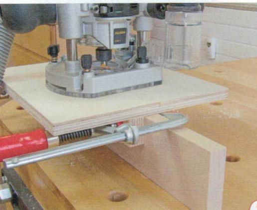
8> Die Anschlagleiste ist hoch genug, so dass sie auch zur Befestigung der Frässhablone auf der Kante genutzt werden kann. Am Korpus werden die Scharniere in die Kante eingefräst, an den Türen in die Innenflächen.
