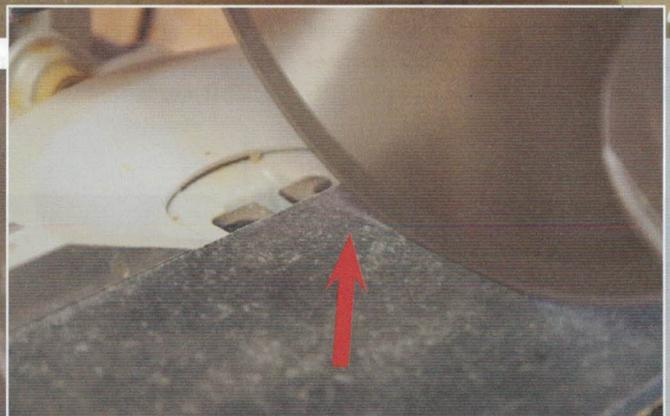
Der Test zeigt: Im linken Bild schneidet ein mit Hartmetall bestücktes Sägeblatt durch ein Stück Laminat, im rechten schneidet ein mit Diamant bestücktes Blatt durch dasselbe Material. Der Pfeil zeigt, dass die Rückstände auf dem rechten Bild (Diamant) deutlich feiner sind als im linken (Hartmetall). Auch ist die Schnittkante rechts feiner. Das ist nicht nur den harten Schneiden, sondern auch den kleineren Spanräumen der Diamant-Blätter geschuldet.
