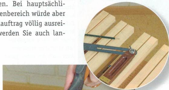
4 > Stellen Sie die Schmiege auf den passenden Winkel ein und markieren Sie sich das untere Ende der Stuhlbeine. Achten Sie darauf, dass Sie dabei immer wechselseitig arbeiten, damit später ein rechtes und ein linkes Stuhlbein entsteht. Das Ablängen kann dann bequem mit einer Handsäge erfolgen.
