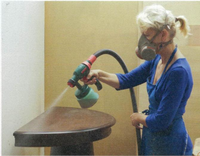
Die Filtermaske schützt vor Dämpfen und Stäuben. So kann man gelegentlich auch in weniger gut belüfteten Räumen sprühen. Die waagerechte Positionierung des Werkstücks verhindert Läufer im Lack. Das Bild unten neben unserem Kasten zeigt, wie man es nicht macht.
