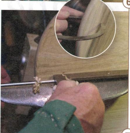
**7** > Der Taster misst die gleichmäßige Dicke des Tellers. Testen Sie dann mit einer Winkelzunge oder einem kurzen Lineal, ob die Oberfläche des unteren Tellers auch tatsächlich eben ist.
