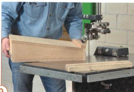
**9** Sind alle Zinkenbretter eingesägt, wird die Zinkenbox gedreht und mit der Gegenseite erneut am Parallelanschlag befestigt.
