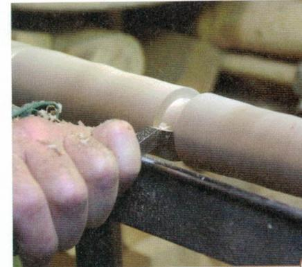
**15** > Beide Zapfen müssen zylindrisch sein und exakt 32 mm Durchmesser haben. Ungenauigkeiten werden beim Zusammenfügen später mitunter bitter bestraft: Die Leimfuge klemmt, Hammerschläge beschädigen das Werkstück, das Holz spaltet ... Oder, im umgekehrten Fall: Der Ständer hält nicht dauerhaft.
