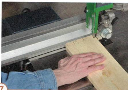
**7** Die beiden Außenzinken können Sie bequem und präzise am Parallelanschlag anliegend absägen (absetzen).
