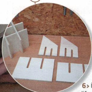
**6** > Überprüfen Sie an der verleimten Kiste die Maße für die Trennwände (Pos. 4 bis 7) und passen Sie die Zuschnitte entsprechend an. Dann fräsen Sie die Schlitzze, stecken die Trennwände ineinander und setzen alles in die äußere Kiste ein.
