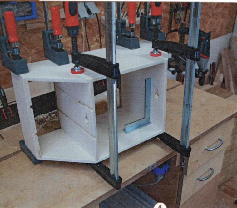
**4** > Verleimen Sie die äußere Kiste bis auf die Unterteilungen. Prüfen Sie die Rechtwinkligkeit sehr genau und korrigieren Sie gegebenenfalls mithilfe leicht schräg angesetzter Zwingen. Schrauben Sie danach den Boden mit gut gesenkten Schrauben fest.
