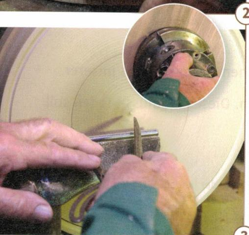
**3** > Drechseln Sie zunächst die Unterseite des unteren Tellers plan und schneiden Sie einen Rezz ein. Dabei ist genaues Messen geboten. Letzte Gewissheit über Maßgenauigkeit garantiert der praktische Test mit dem Futter (kleines Bild).
