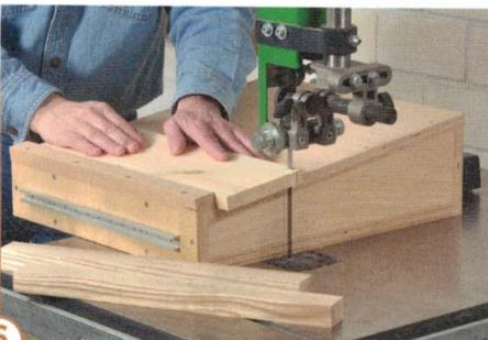
**6** Schalten Sie die Maschine ein und schieben Sie das Zinkenbrett dicht an der Anschlagleiste anliegend bis zur Dickenmarkierung (Bild 1) ...
