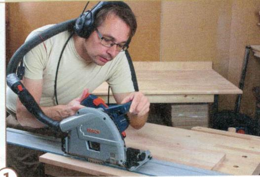
**2** > Erstellen Sie die Vorrichtung zum Sägen der 60°-Gehrungsschnitte an Fußteilen (Pos. 1) wie auf der Zeichnung auf Seite 40 zu sehen. Legen Sie je ein Fußteil in diese Vorrichtung und sägen mit der um 30° gekippten Handkreissäge.
