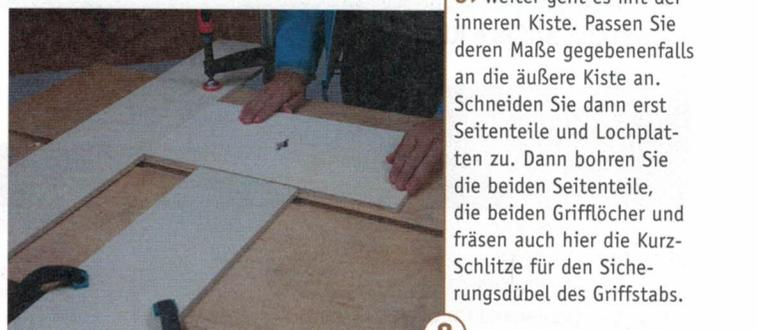
**8** > Weiter geht es mit der inneren Kiste. Passen Sie deren Maße gegebenenfalls an die äußere Kiste an. Schneiden Sie dann erst Seitenteile und Lochplatten zu. Dann bohren Sie die beiden Seitenteile, die beiden Grifflöcher und fräsen auch hier die Kurzschlitze für den Sicherungsdübel des Griffstabs.
