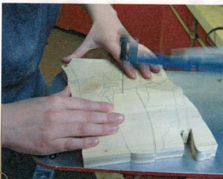
1> Besonders genau lässt sich das Puzzle an der Dekupiersäge mit mittelfeinem Sägeblatt von außen nach innen in seine Einzelteile zersägen.
