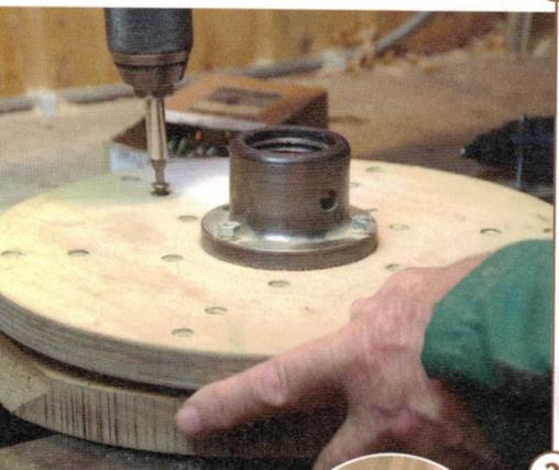
**2** > Lösung 2 ist eine Planscheibe, die mindestens so groß wie der untere Teller ist. Fixieren Sie den Rohling mit vielen kleinen Schrauben. Es reicht, wenn die Schraubenspitzen 5 bis 8 mm in das Holz dringen.
