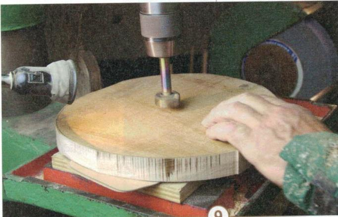
**9** > Den grob zugeschnittenen Rohling des oberen Tellers durchbohren Sie mit demselben Forstnerbohrer, allerdings auf der Ständerbohrmaschine. Vermitteln Sie Verwerfungen des Rohlings mit kleinen Holzscheiben, so dass die Bohrung senkrecht erfolgt. Legen Sie eine hölzerne Opferplatte unter, um den Bohrer nach dem Durchbruch zu schützen.
