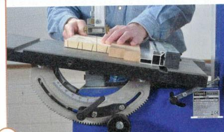
Sind die ersten Zinkenschrägen eingesägt, den Tisch auf die Gegenseite wieder um 8° schwenken, den Parallelanschlag neu justieren (s. Bild 1) und auf die gleiche Weise die noch fehlenden Zinkenschrägen einsägen.
