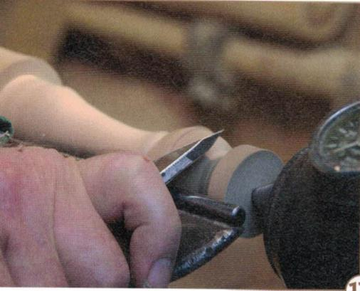
17 > Nun kann die Kugel an der Spitze geformt werden. Andere geometrische Gebilde sind natürlich auch möglich. Hinweis: Alle Teile oberhalb des Zapfens in der Mitte dürfen 31 Millimeter Durchmesser nicht überschreiten.
