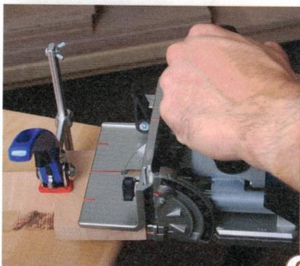
6> In die Seiten der Kopfverbinder und in die oberen Enden der Beine werden auch Flachdübel eingefräst. Jedoch hier in Größe 20. Auch an dieser Stelle könnten Sie ebenso gut mit Runddübeln arbeiten.
