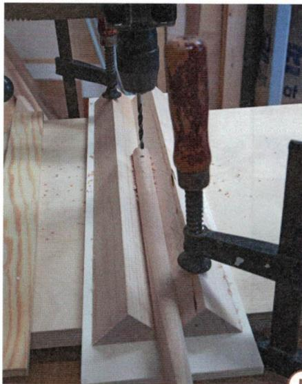
**5** > Nun wird der Griff abgelängt; bohren Sie dann die 5-mm-Löcher für die Sicherungsdübel. Eine einfache Bohrschablone aus einer Trägerplatte und zwei abgeschrägten Leisten sichert den Griffstab gegen Verrutschen. Dann die Sicherungsdübel ablängen und einsetzen.
