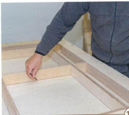
**18** > Nun können Sie den Aussteifungsrahmen probeise zusammensetzen und auf die Unterbauplatte legen. Zeichnen Sie die Kontur des Rahmens komplett auf die Platte auf.
