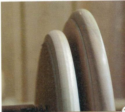
**11** > Ziel ist, den Rand dem des unteren Tellers anzupassen. Weil bei dem oberen Teller kein Sackloch, sondern ein durchgehendes Loch gebohrt wird, kann mehr Material abgetragen werden. Statt fünfzehn Millimeter Dicke reichen hier elf Millimeter.
