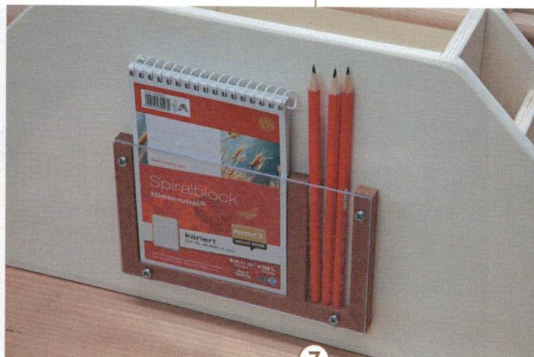
**7** > Nun können Sie bereits die Leisten für die Notizhalterung mit doppelseitigem Klebeband anbringen. Können Sie die Plexiglasabdeckung vorsichtig an und bohren Sie die Löcher für die Senkkopfschrauben mit niedriger Drehzahl. Plexiglas und vorgebohrte Leisten werden dann mit der Seitenwand verschraubt.
