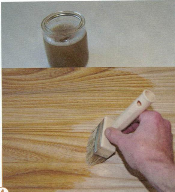
**4** Die flüssige Seife wird mit der Rolle oder einem Pinsel aufgetragen. Der Auftrag erfolgt wie bei einem Lack oder einer Lasur immer in Faserrichtung.
