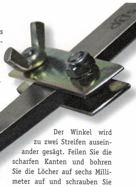
Der Winkel wird zu zwei Streifen auseinander gesägt. Feilen Sie die scharfen Kanten und bohren Sie die Löcher auf sechs Millimeter auf und schrauben Sie alles zusammen. Der Abstand der Bleche entspricht der Dicke des Quernutenstechers.
