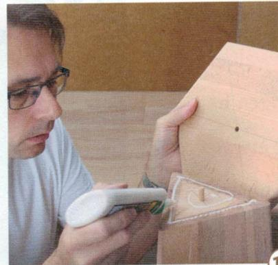
12 > Das Unterteil und die Sitzfläche werden miteinander verleimt. Um die Mitte der beiden Teile gut zu finden, hilft ein mittig in beide Bauteile gesetzter Runddübel. Sparen Sie nicht mit dem Leim, da die Sitzfläche nur stumpf aufgeleimt wird.
