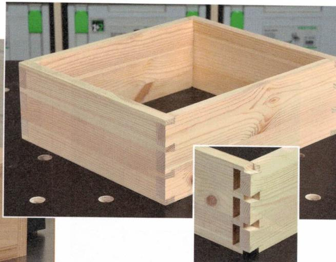
Eine sauber und präzise gefertigte offene Zinkung wertet jedes Möbelstück auf. Sie ist aber nicht nur ein optischer Blickfang, sondern hat auch konstruktive Vorteile zu bieten. Denn die mehrfache Verzahnung aus Zinken und Schwalben lässt Vollholzflächen ungehindert schwinden und quellen. Gleichzeitig entsteht dabei eine einseitig formschlüssige Verbindung, die auch das „Werfen“ der Holzteile verhindert.
