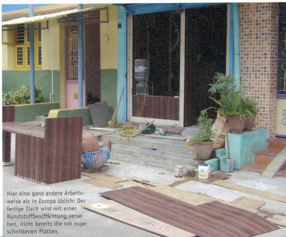
Hier eine ganz andere Arbeitsweise als in Europa üblich: Der fertige Tisch wird mit einer Kunststoffbeschichtung versehen, nicht bereits die roh zugeschnittenen Platten.
