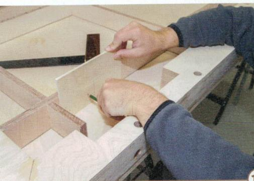
**19** > Für die Stangen der Spannzanze sind noch Durchlässe im Längsträger nötig. Zeichnen Sie mit der zuvor bereits benutzten Schablone diese Löcher an.
