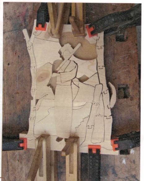
3> Nichts verrutscht beim Verleimen, wenn Sie die Puzzleteile lose einlegen. Nach dem Trocknen werden die Kanten aller Teile mit Schleifpapier und Schlüsselfeilen fein gebrochen. Wer dabei Kimono- und Bambusstücke stärker rundet, erreicht insgesamt mehr Plastizität.
