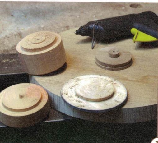
**1** > Zu Beginn steht die Frage: Wie spannen? Lösung 1: Wenn die Oberfläche des Rohlings einigermaßen plan ist, leimen Sie einen Hilfszapfen aus der Restholzbox für passende Backen an. Ist die Oberfläche schief oder gerissen, eignet sich Heißkleber als sichere Verbindung.
