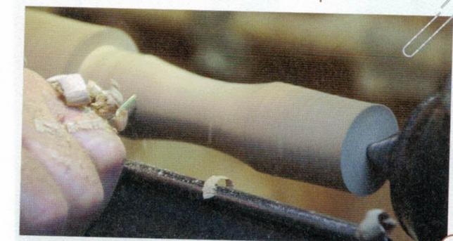
**16** > Wenn die beiden Zapfen perfekt sind, kann der sichtbare Teil des Ständers mit Röhre und/oder Meißel so geformt werden, dass der untere Zapfen oben einen rechtwinkligen Anschlag und der obere einen Anschlag unten hat. Dadurch wird die Leimfläche vergrößert und werden die Teller exakt rechtwinklig zum Ständer positioniert.
