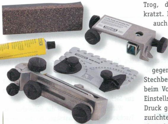
Neben der Polierpaste und dem Steinpräparierer zur Veränderung der Körnung (links) liegen drei wichtige Vorrichtungen bei der T8 (rechts, von vorne nach hinten): Die neue Schleifführung SE-77, die Winkellehre WM-200 und der Steinabrichter TT-50.
