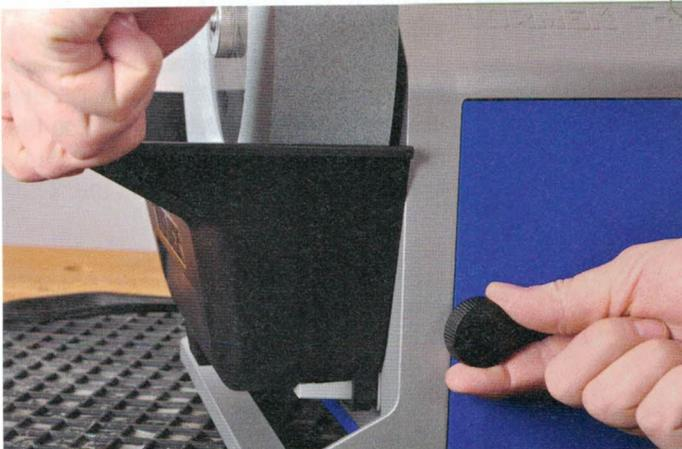
Das Geplanske beim Ein- und Aushaken des Wassertrogs hat Dank der Aufzugsschraube ein Ende.
