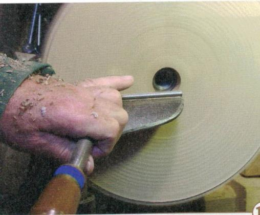
**10** > Das Loch dient jetzt als Spannfläche für beide Seiten. Zum Einsatz kommen kleine Spannbacken zum Spreizen. Profilieren Sie jetzt die Oberseite des oberen Tellers.
