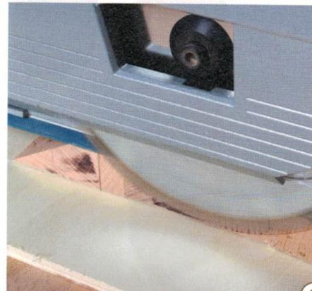
8> Nun müssen die Kopf- und Fußenden der Seitenteile angepasst werden. Bei diesem Schnitt wird die Säge um 3° gekippt. So erreichen Sie eine plane Ebene, auf die später die Sitzfläche geleimt wird. Die Beine stehen dann auch vollflächig auf dem Boden.
