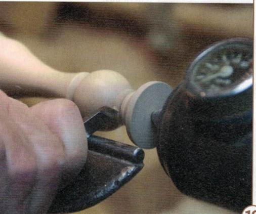
19 > Die Arbeit an der Drechselbank endet mit dem Abstechen an der Spitze und dem Absägen des unteren Zapfens.
