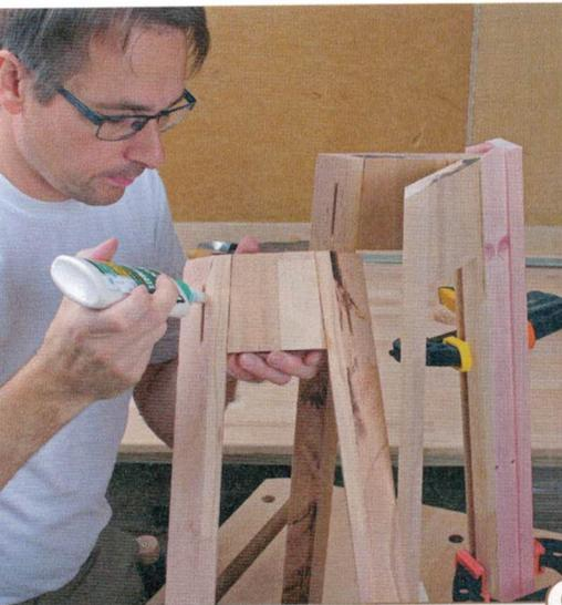
9 > Tragen Sie reichlich Leim an den Kontaktflächen auf. Setzen Sie die Dübel ein und pressen Sie alles mit Zwingen und den von Ihnen im Vorfeld erstellten Leimhilfen zusammen. Richten Sie die Teile aus und ziehen die Zwingen dann noch einmal nach.
