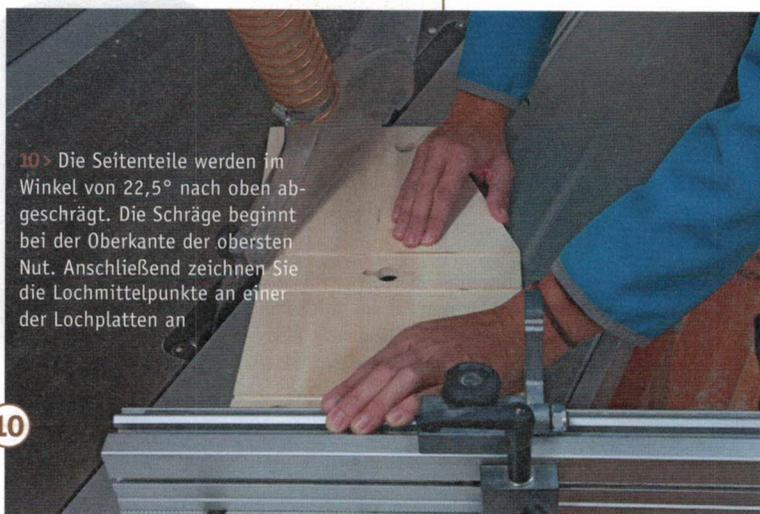
**10** > Die Seitenteile werden im Winkel von 22,5° nach oben abgeschrägt. Die Schräge beginnt bei der Oberkante der obersten Nut. Anschließend zeichnen Sie die Lochmittelpunkte an einer der Lochplatten an
