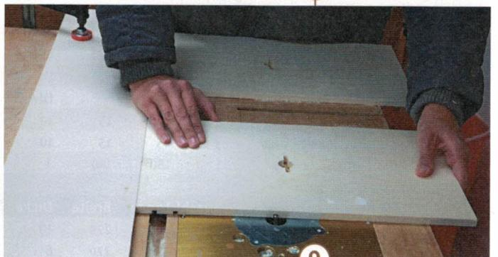
**9** > Nun werden die vier Nuten für die Lochplatten in die beiden Seitenteile gefräst. Die Nuten sind vier Millimeter tief und so breit, wie die Lochplatten dick: 6 mm. Die Position der Nuten entnehmen Sie der Zeichnung.
