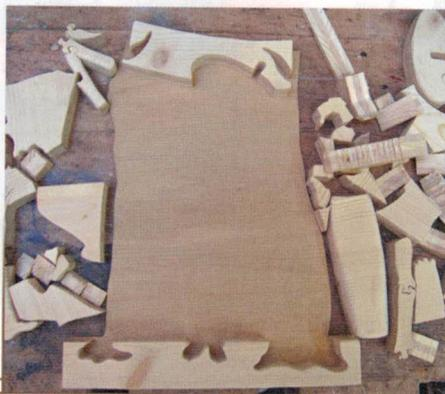
2> Seine Stabilität erhält das Puzzlespiel durch eine Grundplatte aus Sperrholz, 4 bis 6 mm stark und in seinen Außenkonturen den massiven Puzzleteilen angepasst. Das obere und untere Randstück wird fest mit dieser Platte verleimt.
