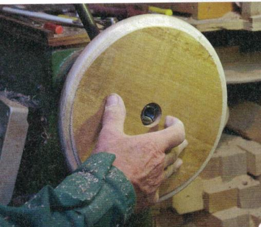
**12** > Jetzt wird umgespannt und die Unterseite des Tellers profiliert, gemessen und geschliffen – und fertig ist auch der zweite Teller.
