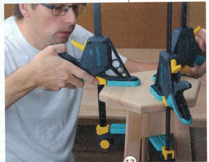
13 > Richten Sie die Sitzfläche parallel zur Außenkante des Unterteils aus. Pressen Sie dann die beiden Bauteile mit drei Zwingen zusammen. Nach einer Presszeit von gut einem Tag wird der Hocker geschliffen und es kann eine Oberflächenbehandlung erfolgen.
