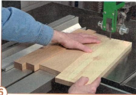
**6** Für die letzten beiden Schwalbenschnitte legen Sie dann noch eine weitere Schwalbenleiste an den Parallelanschlag.
