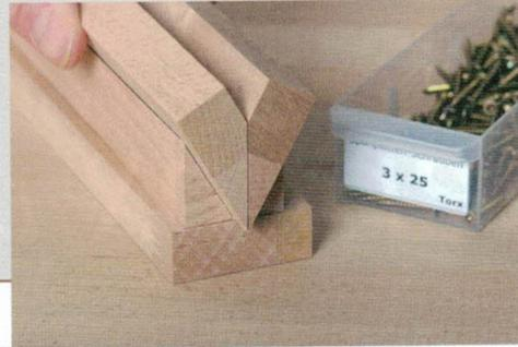
Zwei auf Gehrung geschnittene Fußteile liegen nur zur besseren Darstellung des Prinzips in der Leimhilfe.
