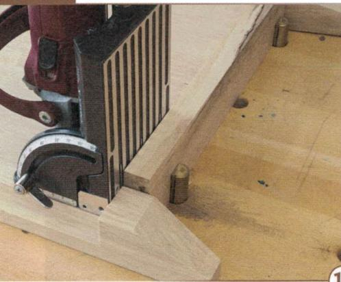
17 > Die Clamex-Verbinders für die Verbindung zwischen Seite und Boden müssen genau bündig mit der Unterkante der Seite eingefräst werden. Eine Hilfsleiste als Anschlag macht das möglich.
