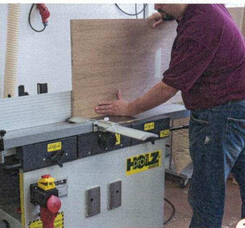
3 > Wenn Sie eine Abricht-hobelmaschine haben, schneiden Sie die Teile, die Umleimer bekommen, zwei Millimeter breiter zu und hobeln Sie dann jede Kante genau einen Millimeter nach. Sie werden dafür mit einer dichten Leimfuge belohnt werden.
