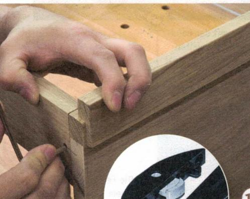
18 > Die Bohrung für den Sechskantschlüssel zum Verriegeln der Clamex-Verbinders ist bei den Traversen nach oben und beim Boden nach unten gerichtet. Die Bohrungen sind dann am fertigen Möbel nicht mehr zu sehen.
