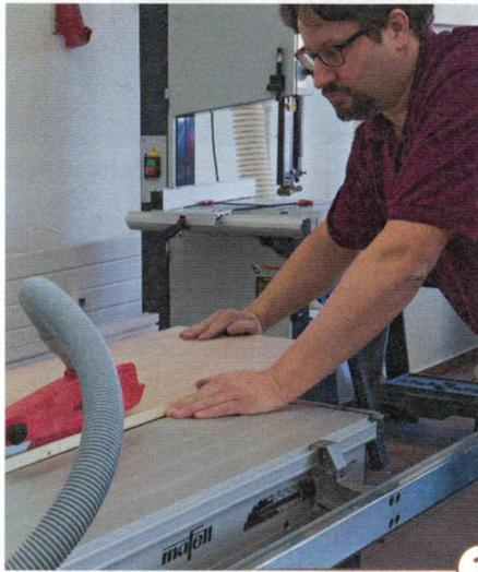
2 > Die endgültigen Maße werden auf der Tischkreissäge geschnitten. Verwenden Sie auch für die Längsschnitte ein scharfes Feinschnittblatt, damit keine großen Ausrisse entstehen. Berücksichtigen Sie beim Zuschnitt die noch hinzukommende Dicke der Umleimer.
