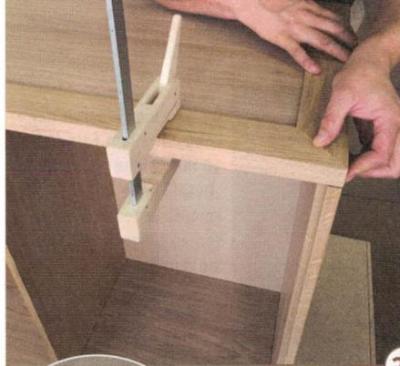
21 > Der Rahmen für die obere Platte wird auf Geh-rung genau bündig zur Korpuskante geschnitten. Erst wenn der Rahmen komplett geschnitten ist, wird die Tischlerplatte genau eingepasst. Die Rahmen werden mit Hilfe von Flachdübeln an die Platte geleimt.
