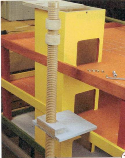
16 > Mit aufgesteckten Fixierringen wird die Mechanik (hier noch außerhalb des Schachts) in den Fahrstuhl eingesetzt. Der untere Teil der Gewindestange steckt dann in dem Sackloch der Bodenplatte. Der obere Fixierring verhindert, dass sich das Gewinde nach oben schraubt.
