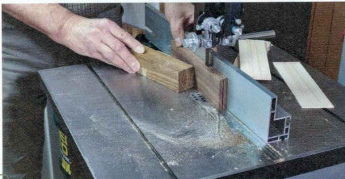
Das Auftrennen von breiteren Hölzern am Parallelanschlag klappt perfekt, wenn das richtige Band aufgelegt ist und die Justierungen von Arbeitstisch und Anschlag bei der Maschinenmontage exakt gemacht wurden.
