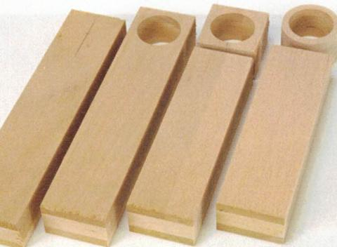
9 > Hier im Bild sind die vier Stadien der Entstehung des Fixierings zu sehen: Bohren Sie zunächst in einen Plattenrest in je ein Ende mittig ein 25-mm-Loch. Sägen Sie das gebohrte Ende bei 34 mm ab und schleifen das entstandene Quadrat rund. Nun haben Sie einen Ring mit etwa 4 mm Wandstärke.
