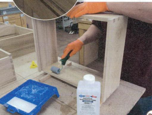
27 > Die Schubladen, Einlegeböden und die Innenseite des Korpus werden lackiert. Ein Wasserlack eignet sich dafür besonders gut. Die Fronten und alle von außen sichtbaren Flächen werden geölt.
