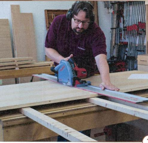
1 > Die große Tischlerplatte wird gemäß Zuschnittplan mit der Handkreissäge mit etwas Zugabe in handliche Stücke zerlegt. Die Fronten sollen ein durchlaufendes Furnierbild zeigen und müssen auch so zugeschnitten werden.
