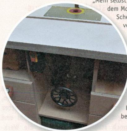
„Mein selbst gebauter **Frästisch** entspricht dem Modell von Guido Henn.“ Der Scherenwagenheber zur Höhenverstellung ist umgebaut: „Ich habe da ein altes Antriebsrad von einer Nähmaschine angebracht. Ich liebe so alte Sachen!“ Hinter dem Frästisch an der Wand hängt eine **WoodRat-Fräsvorrichtung**. „Die nutze ich nur noch selten, höchstens für Zinken, da ich jetzt den Frästisch habe. Der ist besser bei breiten Teilen.“
