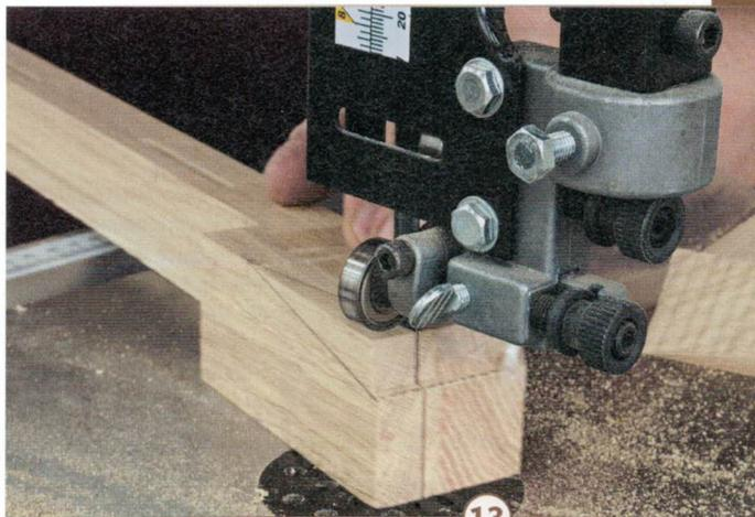
13 > Das Abschrägen der Füße ist mit der Bandsäge am einfachsten. Für den jeweils zweiten Schnitt wird das Abfallstück vom ersten Schnitt wieder mit Klebeband an den Pfosten fixiert. So hat man wieder eine gerade Auflagefläche.
