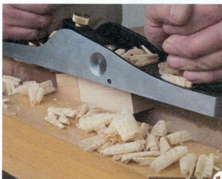
14 > Die Feinarbeit kann mit einem Handhobel oder mit Schleifpapier erledigt werden. Beim Schleifen besteht allerdings die Gefahr, dass die Form ungewollt verrundet wird.
