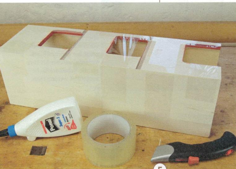
5 > Die letzte Ecke wird mit mehreren Klebebändern fixiert: Drücken Sie es erst auf einer Fläche gut an und ziehen Sie es dann mit Kraft (!) auf die zweite Fläche herüber. Auch dort wird es dann gut angedrückt. So wird der ganze Schacht in den rechten Winkel gezogen.
