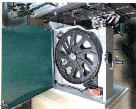
Blick unter den Säge Tisch: Mit der kleinen Kurbel wird der Antriebsriemen ge- und entspannt. Es gibt zwei Riemenscheiben zum Ändern der Schnittgeschwindigkeit. Mit der langsameren Drehzahl können z. B. Materialien wie Kunststoff bearbeitet werden.
