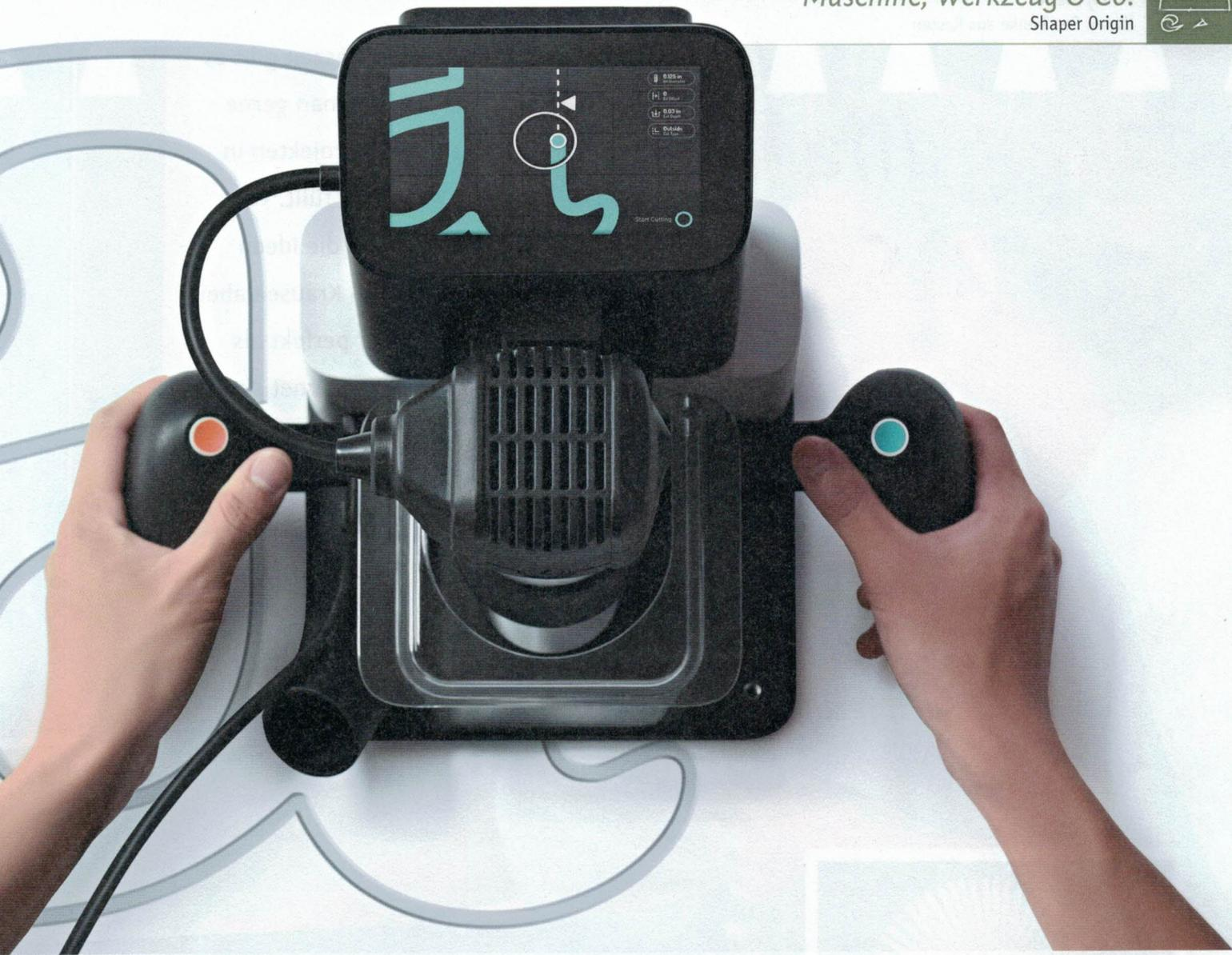
15 Zentimeter wird ein solches Band längs über das Werkstück geklebt. Eine eingebaute Kamera und sehr clevere Algorithmen erstellen daraus quasi eine digitale Landkarte, anhand derer die Maschine den Anwender navigiert und dessen Abweichun-
