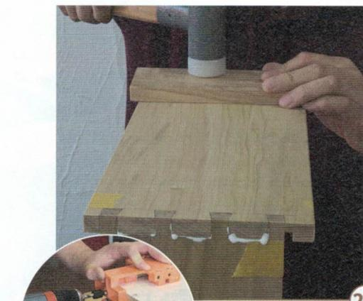
26 > Wenn die Zinken passen, braucht man zum Verleimen keine Zwingen. Nach dem Verleimen werden die Böden montiert und die Bohrungen für die Beschläge gemacht. Eine Bohrschablone ist dabei eine große Hilfe.
