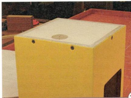
17 > Setzen Sie nun die Dachplatte in den Fahrstuhl ein und verschrauben Sie sie mit den Wänden. Dazu verwenden Sie sechs Senkschrauben. Achten Sie darauf, dass die Gewindestange noch leicht zu drehen ist. Eventuell muss die Plattform leicht angepasst werden.
