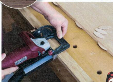
10 > Mit Flachdübeln und Leim werden die Pfosten an den Seitenteilen befestigt. Verleimt wird aber zu diesem Zeitpunkt noch nicht. Die lose eingesetzten Flachdübel erleichtern die folgenden Arbeitsgänge ein wenig.
