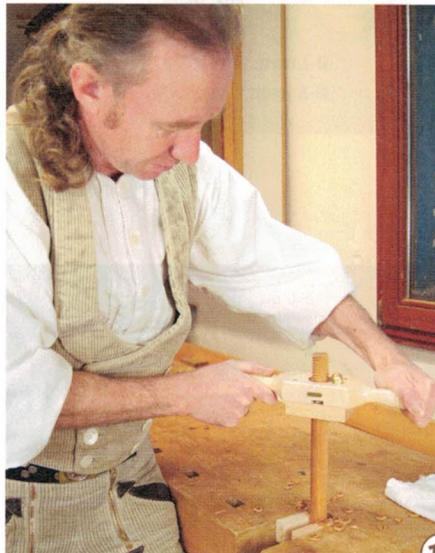
13 > Wischen Sie tags darauf das Öl vom Rundholz ab und spannen Sie es zum Schneiden senkrecht ein. Zum leichteren Ansetzen geben Sie dem Stab oben noch eine Fase. Gleichmäßiges Drehen erzeugt ein gleichmäßiges Gewinde, welches bis kurz vor die Hobelbankfläche ausgeführt werden kann.
