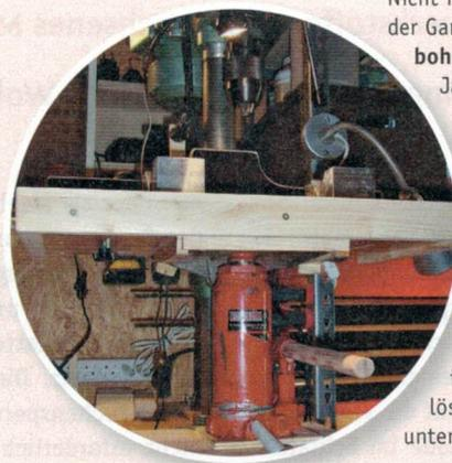
Nicht in der Werkstatt, sondern in der Garage steht Abels **Ständerbohrmaschine**: „Die über 20 Jahre alte **Interkrenn** habe ich überholt, 20 Zentimeter höher gelegt, mit einem Tisch versehen und eine **Hydraulik** eingebaut.“ Der von unten wirkende Wagenheber war übrig. „So kann ich millimetergenau nach oben pumpen. Wenn alles ganz oben ist, muss ich die Schraube lösen und alles wieder nach unten drücken.“
