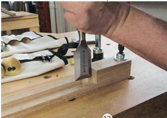
12 > Die aufgeleimten Aufdopplungen erleichtern das genaue Ausstemmen am Ende des gefrästen Falzes. Stemmen Sie mit einem möglichst breiten Stemmeisen bis an die Aufdopplung heran.
