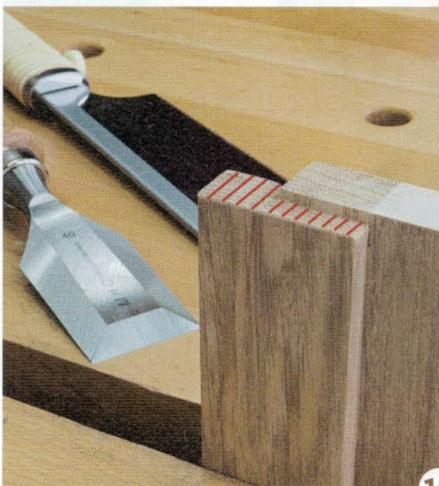
16 > Zur Verdeutlichung: Hier im Bild liegt der gefräste, aufrechte Falz verdeckt auf der Rückseite des Pfostens. Der kleine Hirnholz-Falz am oberen Ende der Pfosten erzeugt eine Schattenfuge zwischen den Seitenteilen und der oberen Platte. Er wird mit Handwerkzeugen gemacht. Wenn Sie einen Falzhobel haben, können Sie ihn hierzu auch nutzen.
