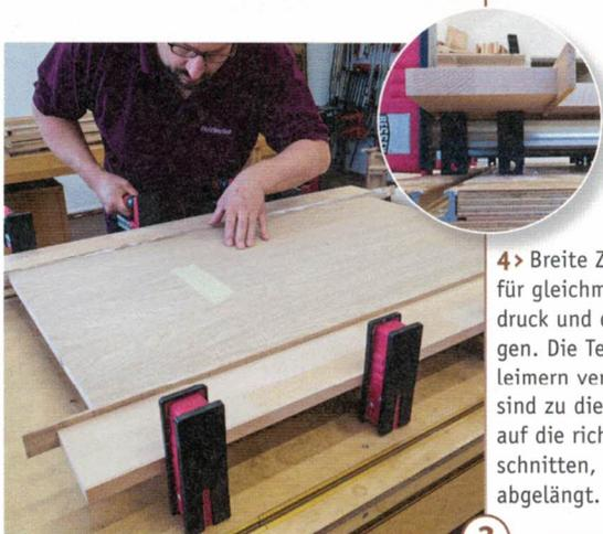
4 > Breite Zulagen sorgen für gleichmäßigen Pressdruck und dichte Leimfugen. Die Teile, die mit Umleimern versehen werden, sind zu diesem Zeitpunkt auf die richtige Breite geschnitten, aber noch nicht abgelängt.
