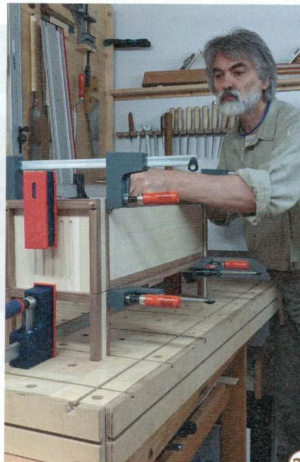
20 > Das Verleimen sollte in mehreren Einzelschritten erfolgen. Erst werden die Fußgestelle, Scharnierleisten und Scharnierlappen mit den Platten verleimt. Erst danach werden die anderen Einzelteile miteinander verleimt.
