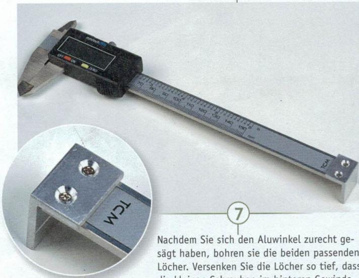
Nachdem Sie sich den Aluwinkel zurecht gesägt haben, bohren sie die beiden passenden Löcher. Versenken Sie die Löcher so tief, dass die kleinen Schrauben im hinteren Gewinde teil noch gut greifen und den Aluwinkel vernünftig fixieren.
