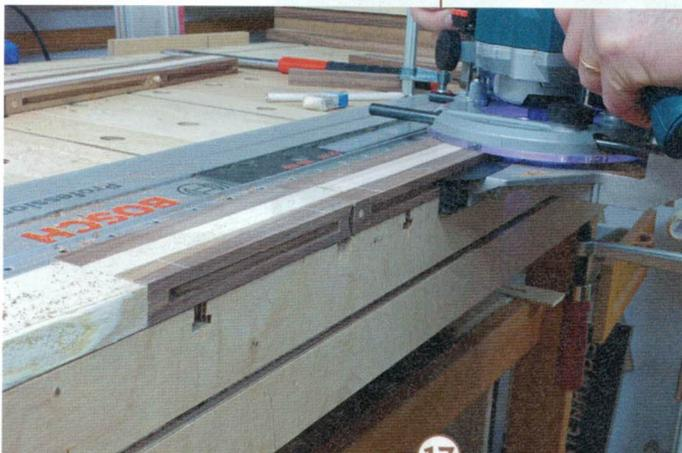
17 > In die Innenflächen der Scharnierbänder wird eine Nut für die Feder (Pos. 16) mit einem Scheibennutfräser D = 6 mm gefräst. Dabei liegen die Werkstücke flach auf dem Tisch. Eine Führungsschiene bildet eine lange Anschlagkante.
