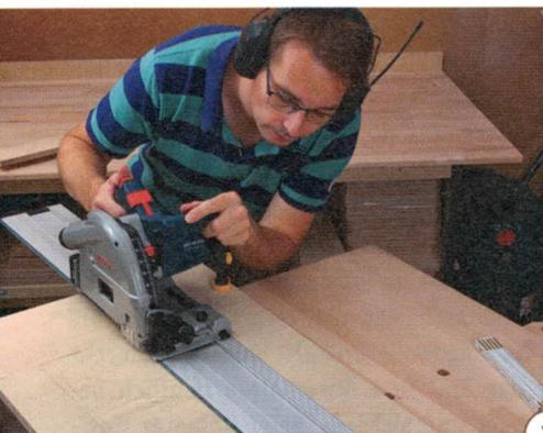
1 > Beginnen Sie mit dem Zuschnitt der einzelnen Platten. Lediglich die Platte, aus der später die beiden Tischverlängerungen und die Deckplatte geschnitten werden, wird erst nach dem Nuten auf Maß gesägt.
