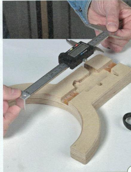
Im letzten Schritt legen Sie die Schiebellehre mit dem Klebeband vorsichtig in die Aussparung, aber noch nicht mit dem Klebeband am Holz anliegend! Halten Sie die Schiebellehre dabei an den Enden fest und versuchen Sie sie gleichmäßig in der Aussparung und Nut auszurichten, bevor Sie dann endgültig Druck auf das Gehäuse und das Klebeband geben. Eine Korrektur ist bei einem extra starken Klebeband nicht mehr möglich!
