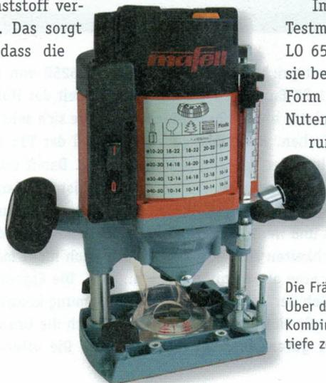
Die Frästiefeneinstellung der LO 65 Ec ist einfach und funktionell. Über die Rändelschraube kann der Austauschweg begrenzt werden. Kombiniert man sie mit der Tiefenbegrenzung, kann man die Frästiefe zehntelmillimetergenau einstellen.
