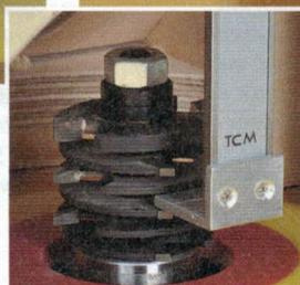
Der lange Tastschenkel kann nicht nur von oben, sondern auch von unten an die Fräuserschneide herangeführt werden. Wenn Sie bei der ersten Messung die Zero-Taste drücken, können Sie auf diese Weise sogar die Schneiddicke ausmessen. Bei dem weichen Aluminium sind in der Regel keine Schäden an den Schneiden zu befürchten. Sie können den Tastschenkel aber auch zusätzlich noch mit einem dünnen Klebestreifen versehen.
