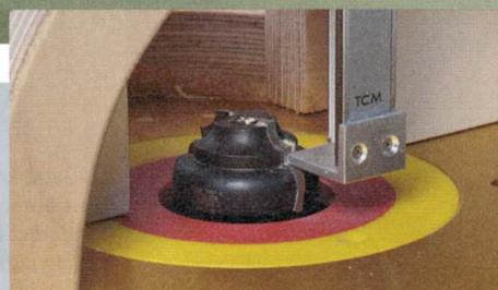
Das Herzstück der Messhilfe ist ein einfaches Winkelstück aus Alu. Um das ganze Potenzial ausnutzen zu können, sollte der lange Tastschenkel genau bis zur Tischfläche reichen und dort dicht aufliegen, wenn Sie die Messbrücke flach auf den Frästisch legen. Das Ende des Schenkels unbedingt scharfkantig lassen und nicht runden, damit man auch bestimmte Teile eines komplexen Profils präzise abgreifen kann (kleines Bild).
