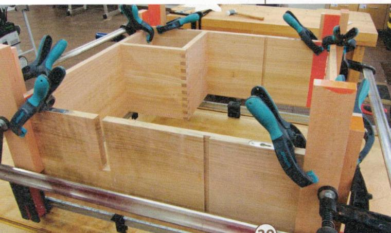
20 > Erst wenn alle Ecken verleimt sind, werden daraus die beiden Korpusse zusammengesetzt. Acht Schraubzwingen mit einer Spannweite von 800 Millimetern sind dazu notwendig.
