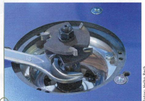
Für den Einsatz der Oberfräse im Frästisch ist es von Vorteil, wenn sich die Fräse über die Tischkante hinaus verfahren lässt. Dann kann man den Fräserwechsel ganz bequem von oben erledigen. Die Öffnung in der Grundplatte sollte dann aber auch schön groß sein.
