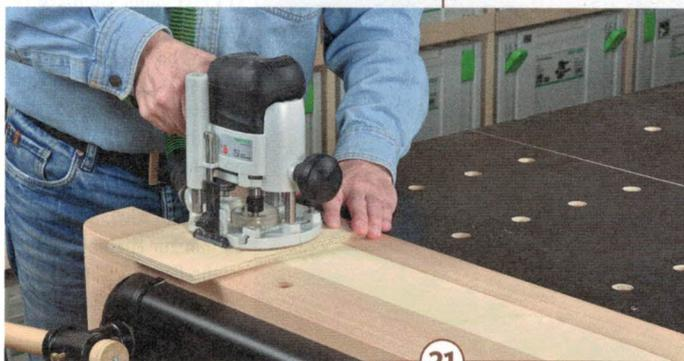
21 > ... (Berechnung:  $2 \times 16,5 \text{ mm} = 33 \text{ mm}$  plus 10 mm Fräserdurchmesser ergibt exakt 43 mm Lochdurchmesser). Wichtig: Fräsen Sie das Loch im Fräsenhalter (Pos. 10) nicht komplett durch, sondern lassen Sie etwa 2 mm Material stehen. Den Rest sägen Sie mit der Stichsäge grob aus und fräsen mit einem Bündigfräser sauber nach.
