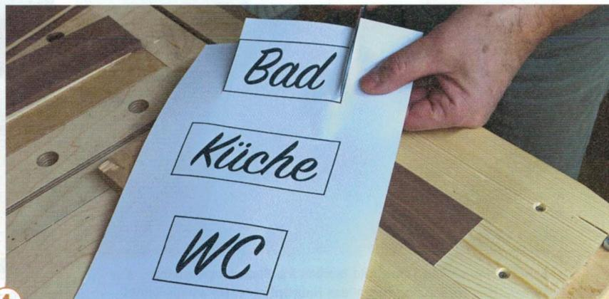
**3** Die Einspannschablone besteht aus den im Text genannten fünf Teilen. Das fertig vorbereitete Schild wird fixiert. Haltebrettchen und Schild müssen gleich dick sein, damit die Oberfräse über alle Flächen gleiten kann.
