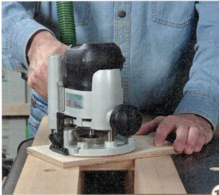
10 > ...Lochmitte aus 27 mm entfernt schlagen Sie einen Nagel als Drehpunkt ein. Auf diese Weise können Sie nun mit einem 8-mm-Nutfräser (in mehreren Tiefen-Etappen) den kreisförmigen Schlitz fräsen.
