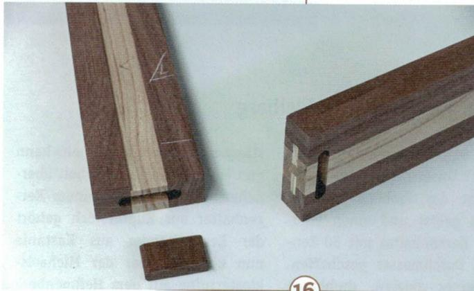
16 > Fremzapfen, auch lose Zapfen genannt, sind eine bewährte Verbindung für schmale Bauteile. Wird der Zapfen etwas schmaler als der Schlitz angefertigt, können die Bauteile beim Verleimen noch genau ausgerichtet werden.
