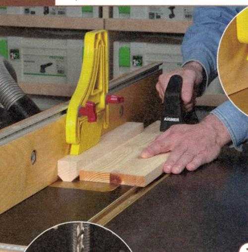
**1** > Zuerst fräsen Sie mit einem 45°-Fasefräser an zwei Kanten der Kugellagerleisten (Pos. 3 + 4) eine 14 mm lange Schräge an. Benutzen Sie dazu am besten einen Frästisch.
