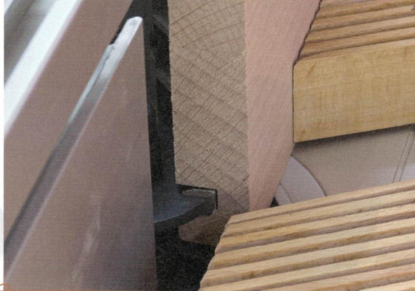
Die passende Nut wird gefräst, ohne dass der Anschlag des Frästisches verstellt wird. Nur die Höhe des Fräasers muss neu eingestellt werden. Somit ist sichergestellt, dass die Feder genau in die Nut passt.
