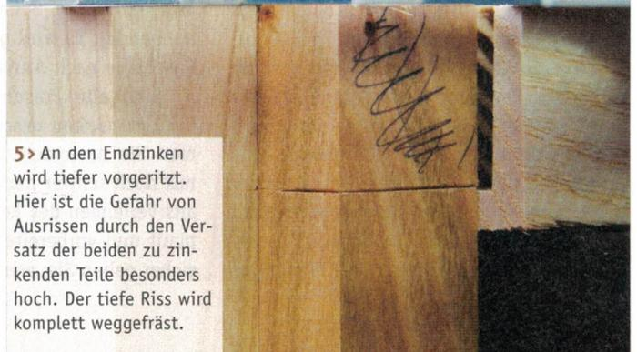
5 > An den Endzinken wird tiefer vorgeritzt. Hier ist die Gefahr von Ausrissen durch den Versatz der beiden zu zinkenden Teile besonders hoch. Der tiefe Riss wird komplett weggefräst.
