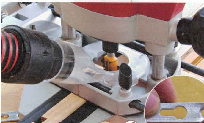
16 > Für das Fräsen der Aufhängebeschläge wird keine Schablone benötigt. Es reicht, diese nach Anriss einzulassen. Ein zweiter Parallelschlag hält Ihre Oberfräse in der Spur.
