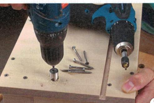
3 > Die Stützen werden mit je zwei Schrauben in ihren Hirnhölzern mit der Deck- und Bodenplatte gehalten. Damit später das zu fräsende Werkstück schadlos über den Frästisch gleiten kann, müssen die Schraublöcher gesenkt werden.
