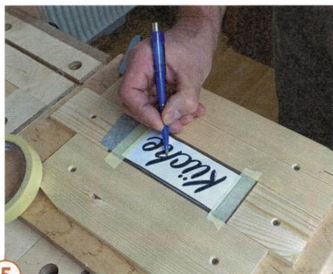
**5** Das ausgeschnittene Wort wird mit Hilfe eines zwischenliegenden Durchschlagpapiers auf das Schild übertragen. Die beiden Papiere sind mit Malerkrepp gut fixiert. Mit einem festen Stift lässt sich die Schriftkontur gut übertragen.
