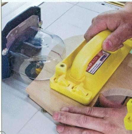
Sicheres Fräsen auch bei offen laufendem Fräser: Die Hände sind weit genug vom Fräser entfernt. Dennoch kann das Werkstück hervorragend am Fräser entlanggeführt werden.
