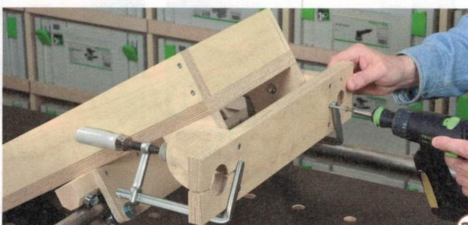
22 > Stecken Sie jetzt die beiden Aufhängungen links und rechts auf den Edelstahlstab (hier verdeckt) auf. Danach befestigen Sie den Fräsenhalter mit Zwingen an den Aufhängungen. Wenn er perfekt ausgerichtet ist, schrauben Sie ihn mit je drei Schrauben an den Aufhängungen fest.
