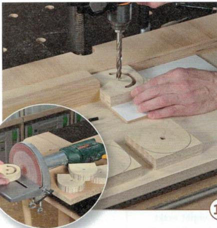
11 > Erst wenn Sie diese kreisförmige Nut gefräst haben, bohren Sie das 10-mm-Loch für den Edelstahlstab. Eine der Aufhängungen erhält noch eine 6-mm-Bohrung passend zur halbrunden Nut – also mit einem Abstand von 27 mm zur Mittenbohrung (siehe Pfeil in Bild 14). Sägen Sie die halbrunde Form und schleifen sie die Schnittkanten.
