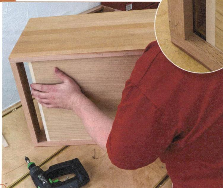
Eine typische Anwendung für einen Scheibennutfräser: Die Nut für die Rückwand wurde damit erstellt. Damit die Rückwand perfekt in die Nut passt, wurde diese mit einer Abplattung versehen. Beide Arbeitsgänge können mit dem gleichen Fräser gemacht werden.
