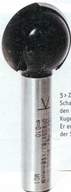
5 > Zum Fräsen der konkaven Form der Scharnierleisten und der Hohlkehle an den inneren Flügelkanten haben wir einen Kugelfräser D = 19,05x18,2 verwendet. Er erzeugt Bögen passend zur Holzdicke der Scharnierleisten und der Flügel.
