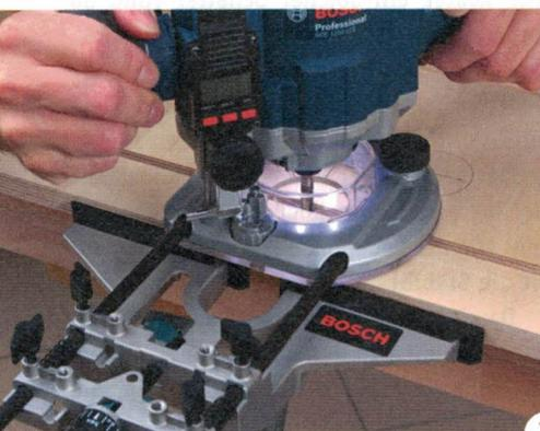
2 > Fräsen Sie eine Nut in das Holzstück, aus dem die Pos. 1 und 2 Stück der Pos. 3 gesägt werden. Verwenden Sie dazu Ihre Oberfräse mit Parallelanschlag und einen Nutfräser mit 10 mm Durchmesser. Die Nut beginnt 80 mm hinter der vorderen Kante.
