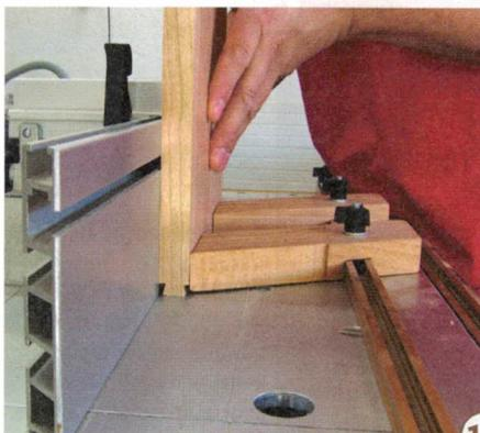
15 > Die Gratfeder wird am einfachsten auf dem Frästisch erstellt. Die Verbindung ist dann gut, wenn ganz sachte Hammerschläge zum Eintreiben genügen. Wenn Sie die Gratfeder und die Nut fein schleifen, rutschen die Teile von vornherein leichter ineinander.
