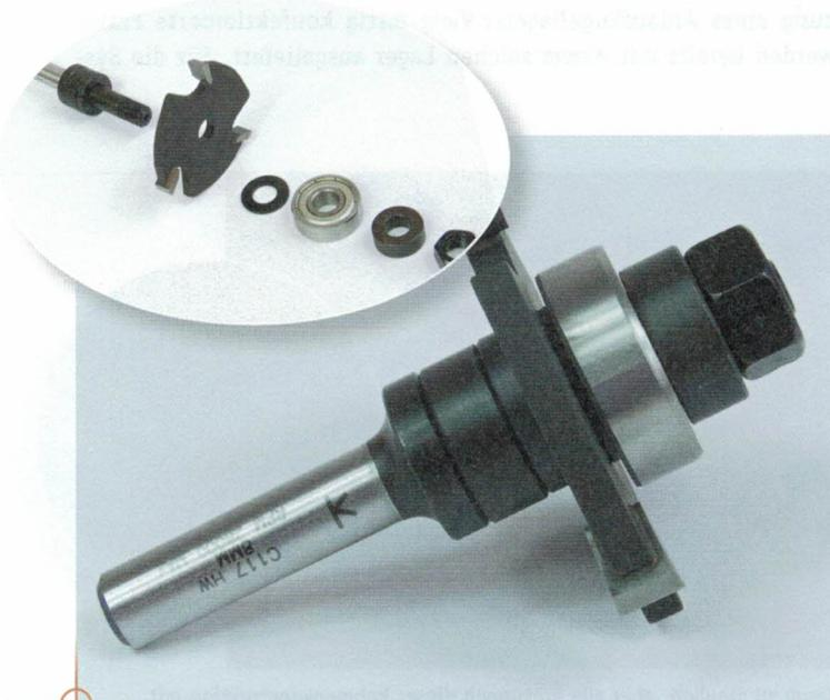
Für die meisten Anwendungen lassen sich die passenden Fräser sowohl aus dem Trend- als auch aus dem Sistemi Klein-Baukasten zusammensetzen. Sie können aber nicht gemischt werden. Auch unterschiedlich große Anlaufkugellager findet man bei beiden Herstellern.
