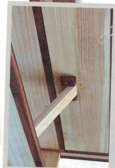
Der Klappmechanismus kommt ganz ohne Beschläge aus. So wird die Tischgröße im Handumdrehen verdreifacht.
