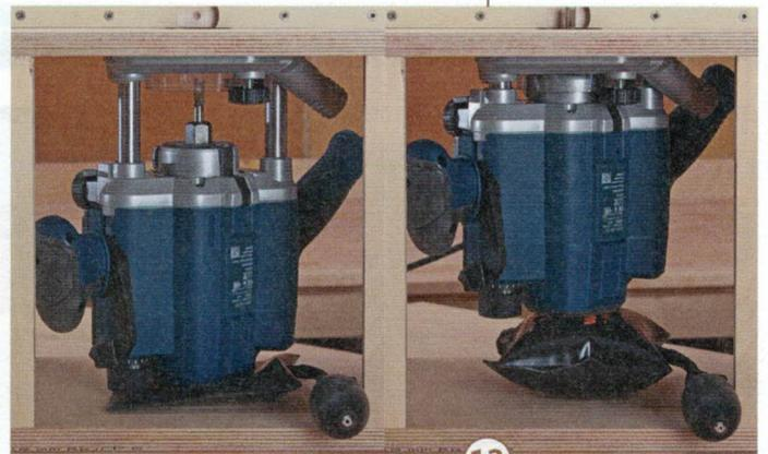
13 > Der Winbag ermöglicht es, auf eine platzraubende mechanische Höhenverstellung unter der Maschine zu verzichten.
