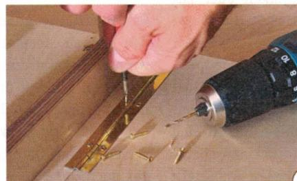
6 > Damit die Nut der Tischverlängerung mit der Nut der Deckplatte fluchtet, legen Sie je eine Seite der Tischverlängerung mit der Deckplatte bündig und schrauben das Klavierband, das schon auf die Tischverlängerung geschraubt ist, auch an die Deckplatte.
