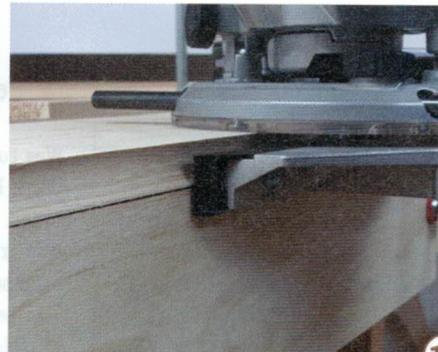
19 > Die Hohlkehle wird mit Hilfe des Parallelanschlags der Oberfräse an die Kante der Flügelplatten gefräst.
