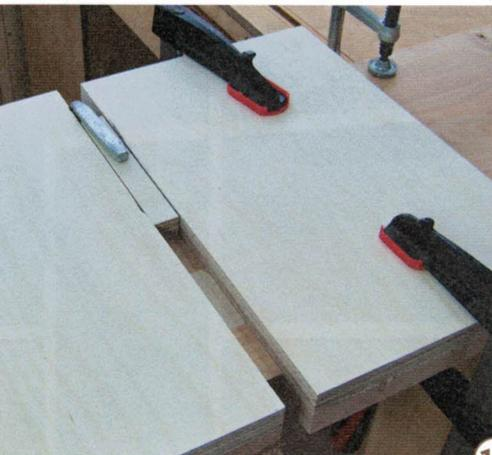
10 > Zwischen den beiden Anschlagbrettern wird ein Klötzchen befestigt. Die Länge des Klötzchens entspricht genau der halben Regaltiefe. Bei uns also 125 Millimeter.
