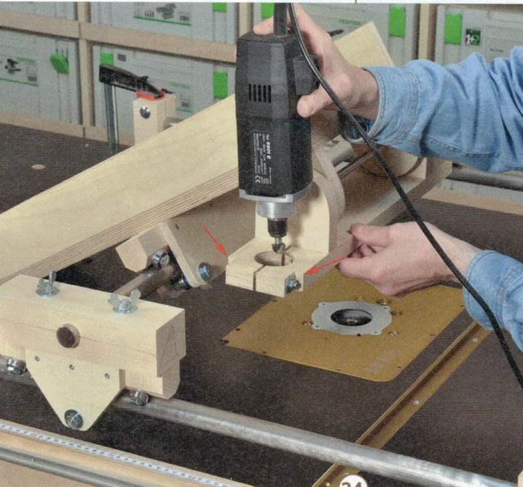
24 > Damit die Schlossschraube und Mutter nicht an der Kante vorsteht, die Enden an den Ecken ein wenig ausklinken (Pfeile). Zur Verbesserung der Klemmwirkung auch hier wieder den Schlitz etwa 15 mm über das 43-mm-Loch hinaus gehen lassen.
