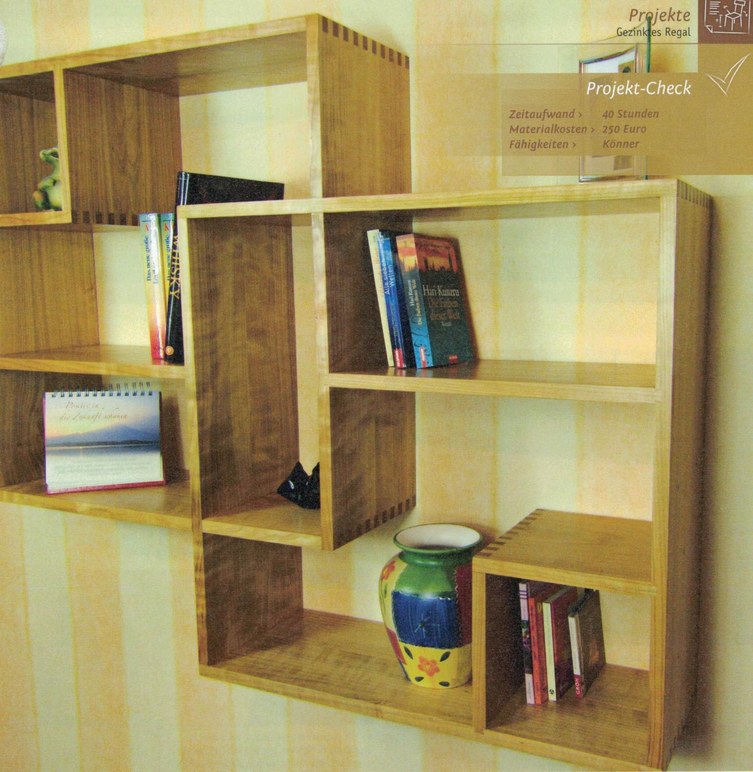
nem Arbeitsgang erzeugen oder ob Sie zunächst mit einem Nutfräser vorfräsen. Das Gegenstück, die auf dem Frästisch erstellte Gratfeder, darf natürlich nicht zu straff eingepasst werden. Und auch die Zwischenböden und Ecken müssen sich problemlos in den Korpus einschieben lassen.
