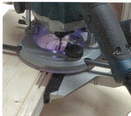
**4** Das Werkstück passt formschlüssig in die Öffnung zwischen den Leisten (C). Oberdräsensohle und Parallelanschlag drücken es an die Anschlag- und Trägerplatte. Die kleine Leiste kann nicht verrutschen. Weitere Fixierungen sind nicht nötig.
