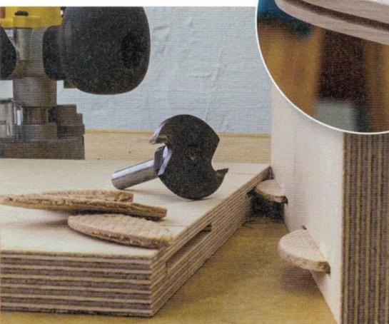
Ein vier Millimeter breiter Fräser kann zum Einfräsen von losen Federn oder eben für solche Flachdübelfräsungen eingesetzt werden. Die verschiedenen Frästiefen werden durch unterschiedlich große Anlaufkugellager realisiert.
