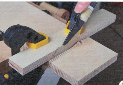
8 > Jetzt noch die Anschlaghinterseite herstellen: Bohren Sie in die Pos. 10 zwei 6-mm-Löcher gemäß der Zeichnung Anschlag-Maße und sägen zwei 90 mm lange und 6 mm breite Schlitz ein. Diese Schlitz werden die Führung des Anschlags.
