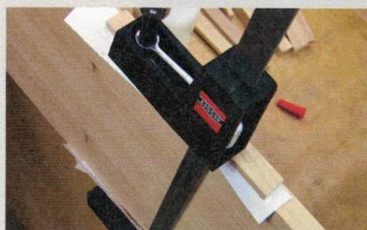
An den Ein- und Austrittsstellen des Fräasers wird eine Leiste angeleimt. Zwischen der Leiste und eigentlichem Werkstück wird jedoch eine Lage Papier geleimt.
