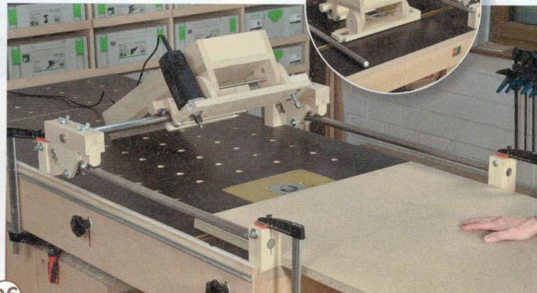
26 > Die Vorrichtung wird mit vier Zwingen auf dem Tisch (Mindestmaß 100 x 90 Zentimeter) befestigt. Schieben Sie anschließend noch eine alte Spanplatte zwischen die Rohrträger, um darauf die Vorlagen und Werkstücke zu fixieren. Mit ein paar wenigen Handgriffen lässt sich nach getaner Arbeit alles wieder platz sparend verstauen.
