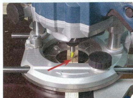
7 > Vor dem Einbau des Kugelfräasers wird mittels eines V-Nutfräasers die exakte Mittenposition des Fräasers zur Anrisslinie eingestellt. Erst danach wird der Kugelfräser eingebaut. Diese Methode eignet sich immer dann, wenn ein Fräser an einer Mittellinie ausgerichtet werden muss.
