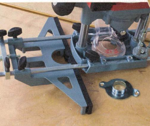
Während das Angebot an Zubehör für kleine und mittlere Fräsen groß ist, wird es bei großen Oberfräsen meist schwierig. Einen guten Parallelschlag mit Feineinstellung und passende Kopierringe bieten außer Triton aber alle Hersteller an.
