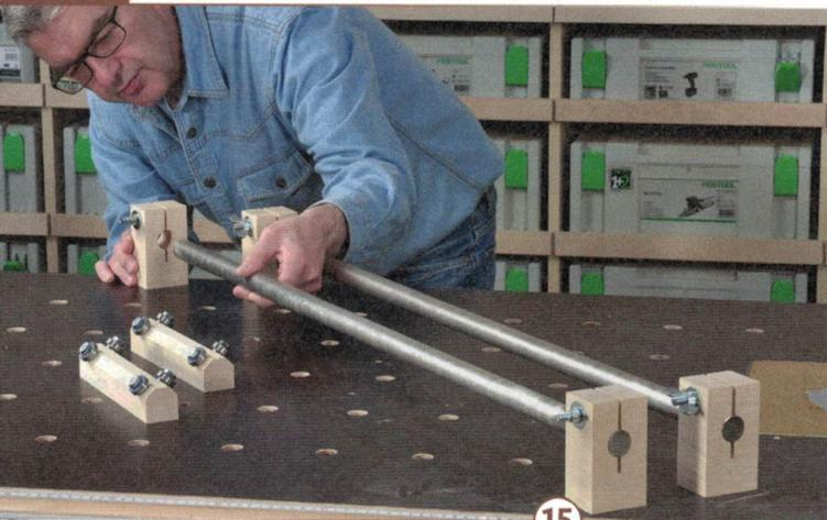
15 > Stecken Sie auf die Enden der beiden ein Meter langen Edelstahlrohre je einen Rohrträger. Klemmen Sie die Rohre mithilfe der Schlossschraube und Flügelmutter gut fest.
