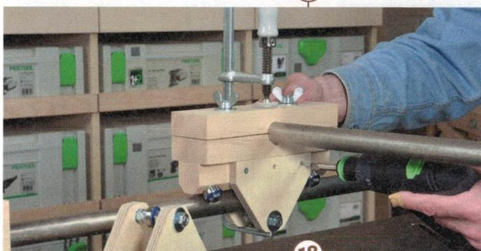
18 > Dieses komplette Paket nun von unten auf die Kugellagerleiste aufschieben, leicht mit einer Zwinne von unten gegen drücken und dann mit je drei Schrauben an der Leiste befestigen.
