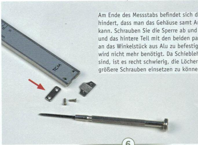
Am Ende des Messstabs befindet sich die Auszugssperre, die verhindert, dass man das Gehäuse samt Anzeige vom Stab abziehen kann. Schrauben Sie die Sperre ab und nutzen Sie die Schrauben und das Winkelstück aus Alu zu befestigen. Das vordere Teil (Pfeil) wird nicht mehr benötigt. Da Schiebellehren in aller Regel gehärtet sind, ist es recht schwierig, die Löcher im Stab aufzubohren, um größere Schrauben einsetzen zu können.
