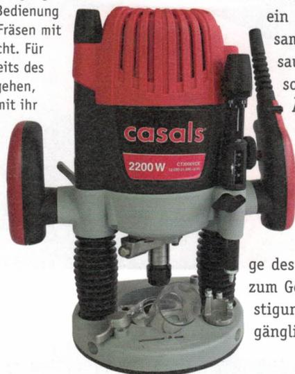
Die Maschine taucht nicht feinfühlig ein und verhält sich insgesamt eher ruppig. Die Absaugung funktioniert nicht sonderlich gut. Ein echtes Ärgernis ist der Absauganschluss. Er hat eine viel zu kleine Öffnung, so dass Fräser mit großem Durchmesser nicht hindurch passen. Die Montage und Demontage des Absauganschlusses wird zum Geduldsspiel, da die Befestigungsschrauben kaum zugänglich sind. Dies hört sich
