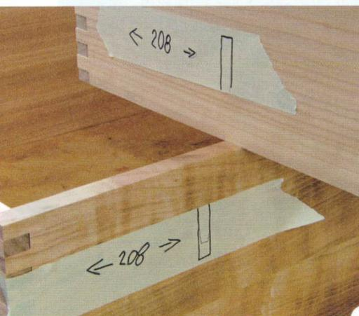
8> Die Überschiebung der beiden Korpusteile muss unbedingt an den richtigen Stellen gefräst werden. Verwechslungen beugen Sie vor, wenn Sie die Teile ganz deutlich markieren.
