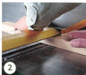
Die Hände gleiten vom Aufgabetisch über die Schutzbrücke und führen das Werkstück auf dem Abnahmetisch mit Druck weiter bis zum Brettende.
