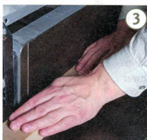
3 Ist das Werkstück länger, üben abwechselnd beide Hände Druck auf das Brett über dem Abnahmetisch aus. Eine Hand wird hinter die andere gesetzt, ohne dass der Vorschub des Werkstückes unterbrochen wird. Eine Hand muss immer den Druck aufrechterhalten.
