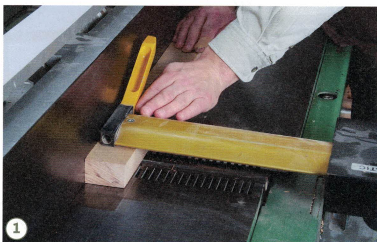
1 Abrichten: Die breite, hohle Seite liegt auf dem Aufgabetisch und beide Hände schieben mit geschlossenen Fingern das Brett vor. Die Hände liegen flach und eine Handbreit vom Vorderende auf.
