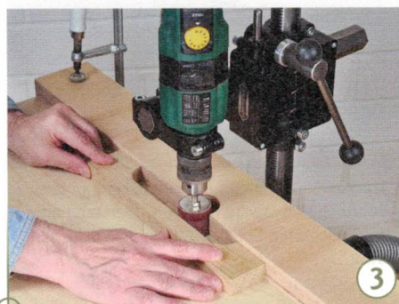
3 Spannen Sie eine gerade Anschlagleiste, die in der Kantenmitte eine Ausklinkung passend zur Schleifrolle hat, mit Zwingen fest. Stellen Sie über den Auslegerarm den gewünschten ...
