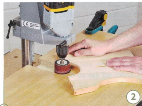
2 ... Sie lediglich eine Spanplatte, die im hinteren Bereich entsprechend ausgesägt wurde. Dort kann die Schleifrolle bequem abgesenkt werden, wenn ein Teil der Schleiffläche zu sehr abgenutzt ist.
