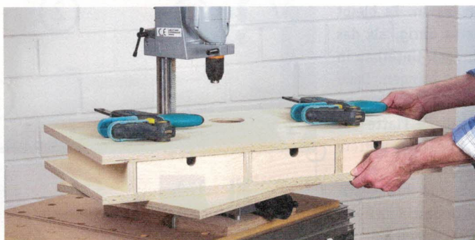
Die Schleifstation wird einfach auf der Tischfläche des Bohrständers mit zwei Zwingen befestigt. Sie hat daher auch genau die gleiche Plattengröße. So ist sie jederzeit in sekundenschnelle einsatzbereit.
