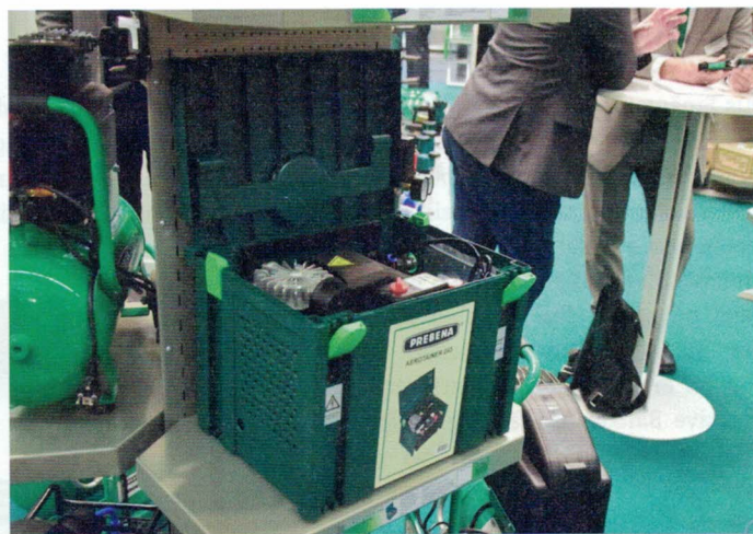
Der Aerotainer 245 von Prebena ist ein Kompressor, der in einem Systainer sitzt. Schlauchanschlüsse außen ermöglichen das Anzapfen auch in geschlossenem Zustand.
