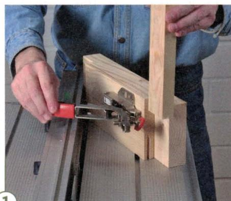
1 Fixieren Sie das Werkstück mit dem Schnellspanner (Kniehebelspanner) im Falz der Vorrichtung.
