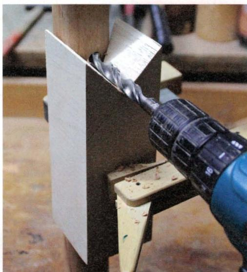
Kantholz, in das auf einer Längskante eine rechtwinklige V-Nut eingebracht wird. Sie dient der Anlage der Schablone am Rundstab.
