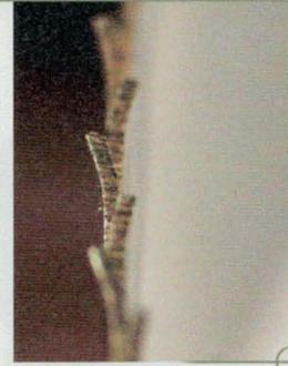
Nahaufnahme eines geschränkten Bandsägeblattes. Das wechselseitige Umbiegen der einzelnen Zähne ist gut zu erkennen.
