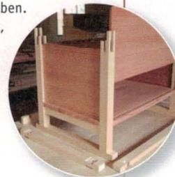
**14** > Der Boden wird an der Unterseite an beiden Köpfen genutet, am schnellsten an der Tischkreissäge. Diese Nut soll nur 2 mm tief sein, damit das „Vorholz“ (die verbleibenden kurzen Fasern) nicht abschert. Die Nut dient als Lagesicherung für den Boden und verhindert, dass die Truhe in die Grätsche geht.
