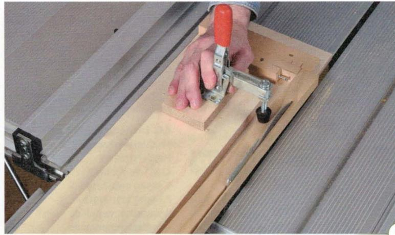
Wenn Sie auch die beiden restlichen Pfostenseiten anschränken möchten, legen Sie für den ersten Schnitt wieder eine nicht angeschrägte Seite gegen den Schraubenkopf, dann den Pfosten um 180° drehen und in der darunterliegenden Aussparung anlegen, um den letzten Schrägschnitt durchzuführen.
