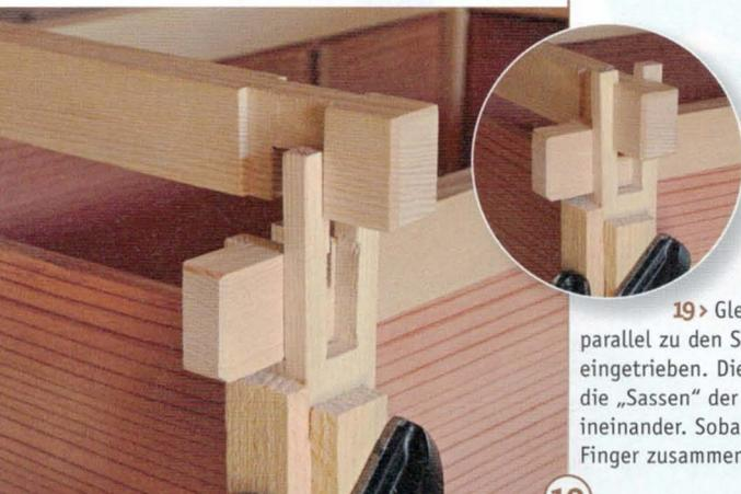
**19** > Gleich macht es „Klick“! Die kurzen Zargen, die parallel zu den Seiten der Truhe verlaufen, werden vorsichtig eingetrieben. Die kurzen Zargen spreizen sich deutlich, die „Sassen“ der innenliegenden Kreuzüberblattung greifen ineinander. Sobald die Zarge in Position ist, schnappen die Finger zusammen und verriegeln ihren Sitz.
