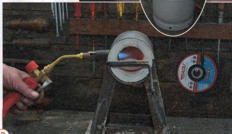
**2** Vollgas! Ein Gasbrenner mit Propan reicht bei dem kleinen Brennraum aus. Es muss nicht das heißere Propan-Butan-Gemisch aus einer kleinen Lötampe (siehe Teil 2 der Serie) sein.
