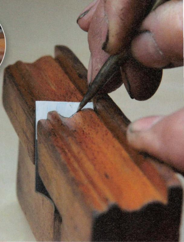
**6** Ist alles wieder kalt, weißeln Sie die künftige Fasenseite des Eisens mit heller Farbe (hier: simples Tipp-Ex). Setzen Sie das Eisen ein und verkeilen Sie es so, dass es leicht über das Profil hinaussteht. Eine Reißnadel überträgt nun das Sohlenprofil haargenau in die Farbschicht.
