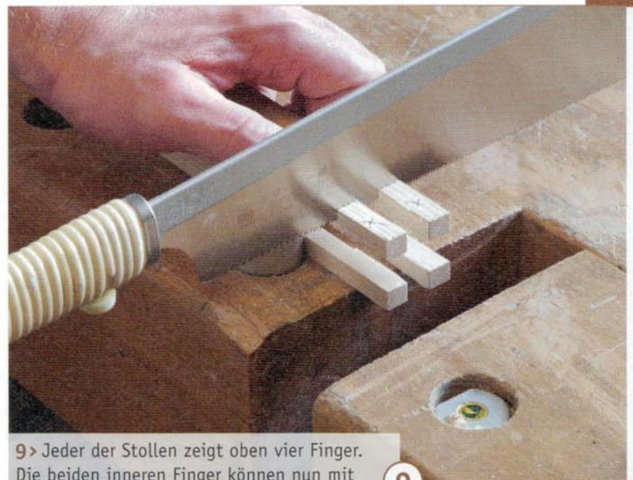
9 > Jeder der Stollen zeigt oben vier Finger. Die beiden inneren Finger können nun mit der Feinsäge sauber auf halbe Länge abgesetzt werden. Die äußeren Finger bleiben stehen, sie bilden das Schloss und dienen zugleich als Anschlag für den Deckel. Sie werden erst ganz zum Schluss auf drei Millimeter über Deckelniveau gekürzt.
