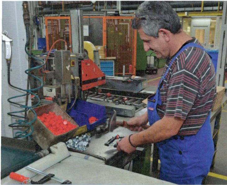
Aber nur fast alle: Jede Zwinge wird zum Schluss mit geschultem Auge geprüft und bei Bedarf mit einem Schlosserhammer nachgerichtet.
