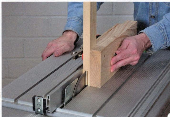
Schieben Sie dann den Klotz am Längsanschlag vorbei über das laufende Sägeblatt. Auch hier wird das Werkstück wieder gedreht und ein weiteres Mal vorbeigeschoben.
