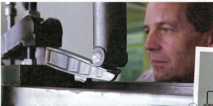
Der Belastungstest beim Besuch von *HolzWerken* bringt den Temperguss-Stahl erst bei einer Kraft von knapp 15.000 Newton in die Knie. Gemessen wird ganz analog per Messuhr und Papierschreiber.
