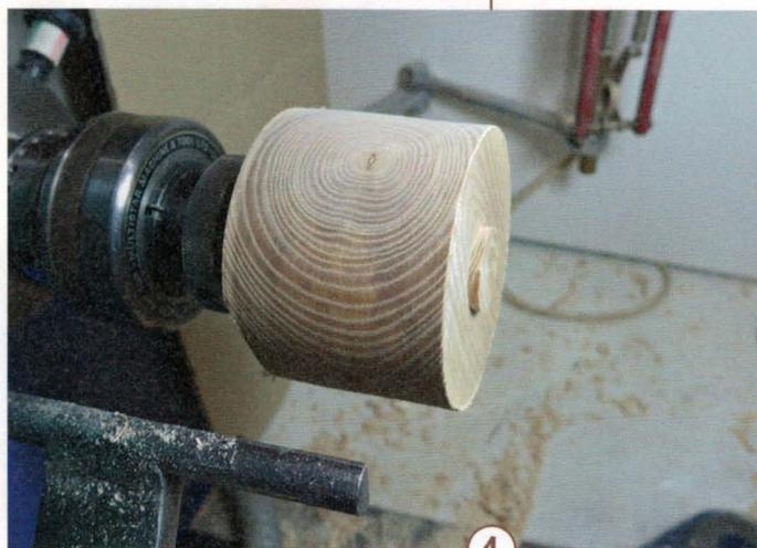
4 > Nach dem Runddrehen und der Begrädigung von Stirn- und Bodenfläche erhält der Rohling einen kleinen Schwalbenschwanzzapfen für die spätere Aufnahme in einem Spannzangenfutter. Hier sollte ein kleiner Durchmesser gewählt werden, um eine elegante Form zu ermöglichen.
