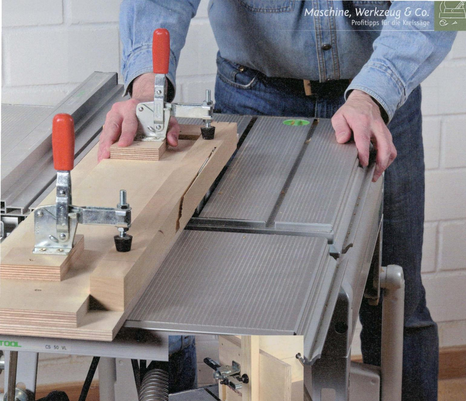
Zapfen immer genau in der Kantenmitte. Selbstverständlich können Sie am Anfang als Ersatz für die Schnellspanner auch eine Hebelzwinde einsetzen.
