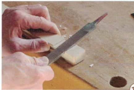
**18** > Ein Riss im Stollen beim Zusammenbau wäre verheerend. Um das Risiko zu verringern, wird der Teil der Verbindung, der die beiden verbliebenen Finger spreizen wird, unten etwas konisch geraspelt.
