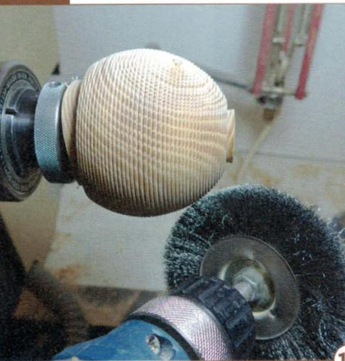
**13** > Anschließend wird der Rohling wie im ersten Struktur-Beispiel mit einer rotierenden Drahtbürste bearbeitet und wiederum mit einer Messingbürste geglättet.
