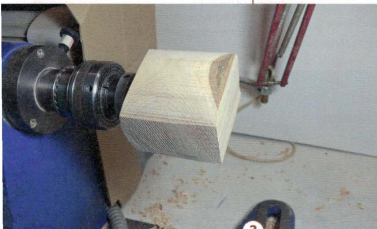
3 > Zum Spannen dient ein Spreizdorn. Alternativ sind natürlich auch Schraubfutter oder Spannen zwischen den Spitzen möglich.
