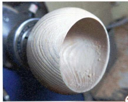
**16** > Die Wandstärke beträgt etwa drei Millimeter. Je mehr der kleinen Schalen Sie fertigen, desto leichter geht das Drechseln von der Hand.
