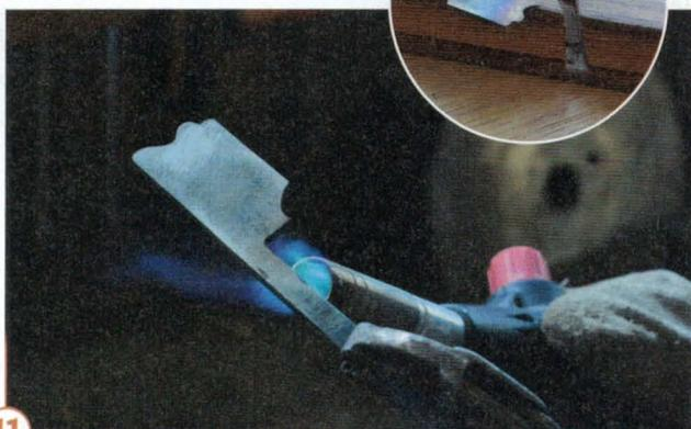
**11** Schleifen sie das Eisen nun rundum sauber. Lassen Sie es danach wie in Teil 2 beschrieben an: Wedeln Sie mit der Lötlampe von hinten langsam vorwärts, bis die strohgelbe Farbe die Schneide erreicht. Wenn das Eisen später zu schwer zu schärfen ist, können Sie auch noch etwas weiter anlassen. Doch mit Diamantfeilen ist das Schärfen von Profilen heute viel leichter als früher.
