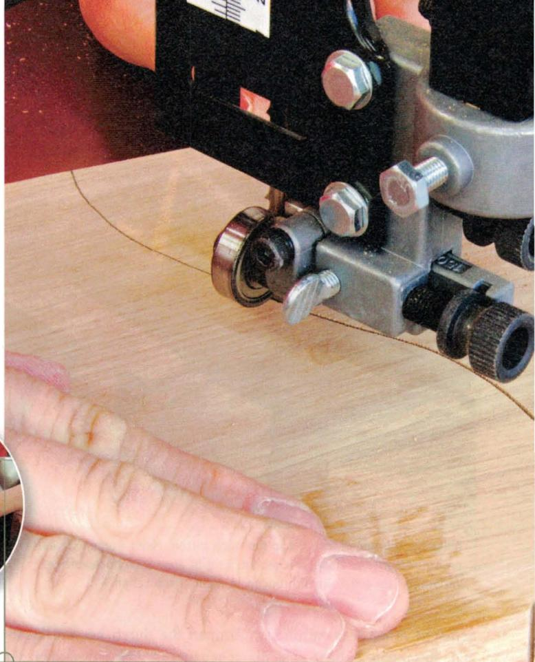
Für Kurvenschnitte brauchen sie ein schmales Band. Je nach Bandsägenmodell und Führung können sogar Bänder mit einer Breite von nur drei Millimetern eingesetzt werden.
