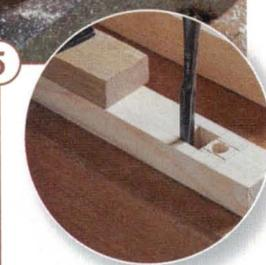
5> An den Kufen wird zunächst eine quadratische Vertiefung vorgebohrt und ausgestochen. Anschließend wird der Teil ausgearbeitet, der den Grat aufnehmen wird. Hier müssen die Wangen vorsichtig schrittweise schräg gestochen werden.
