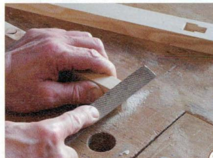
11 > Bevor es an den Zusammenbau geht, greifen Sie noch zur Feile: Runden Sie die kurzen Zapfen des Riegels, der als Auflage für den Boden dient, oben und unten etwas ab. Das erleichtert das Zusammenstecken.
