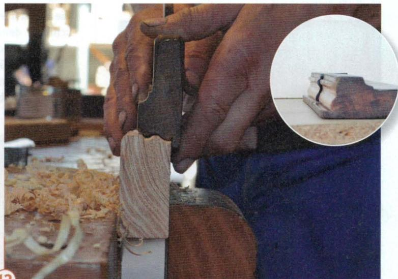
**12** Der Test mit Härteprüfweilen ergibt nach dem Anlassen rund 57 HRC, was für einen Profilhobel ein guter Kompromiss zwischen großer Standzeit und leichter Schärfbarkeit ist. Nach anderthalb Stunden Arbeit ein sehr vorzeigbares Ergebnis. Und dann: Rauf aufs Holz! In wenigen Zügen entsteht das exakte Profil – der kleine Spalt hier im Bild erscheint durch die abgenutzte „Nase“ des alten Hobels.
