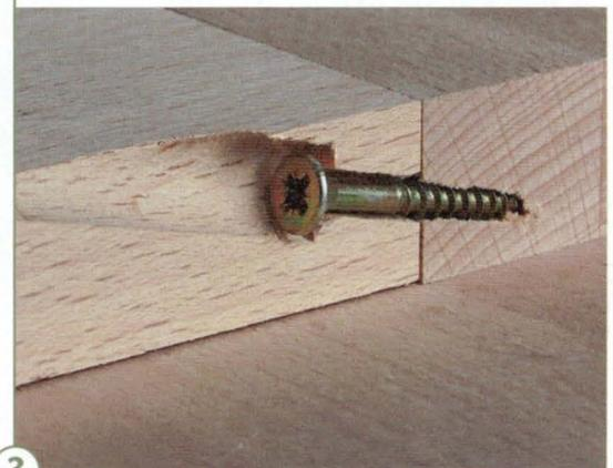
4 > Richtig kompliziert wird es erst bei winkligen Verbindungen wie dieser hier: Der Winkel, die Dicke der Materialien, die Einstellmöglichkeiten am „Undercover Jig“ – das alles will beachtet werden, damit der Bohrer nicht aus dem Holz herausbricht und die Schraube auch satt in beiden Werkstücken sitzt. Normalerweise heißt es: Ausprobieren, doch alle diese Parameter lassen sich wunderbar mit dem Programm „Undercover Planer“ simulieren.
