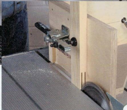
Um den passenden Zapfen zu sägen, muss der Abstand der Vorrichtung zum Sägeblatt neu eingestellt und mit ein paar Probehölzern überprüft werden.
