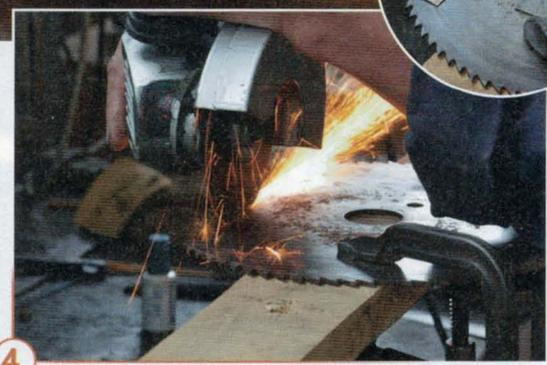
**4** Das 3 mm starke, einteilige Kreissägeblatt (ebenfalls vom Flohmarkt) dient als Materialspender. Zeichnen Sie die Kontur der Schablone auf und schneiden sie mit Flex oder Säge den Rohling aus. Anschließend wird dieser entgratet. Sie können ihn jetzt schon testhalber in den Hobelkörper hineingleiten lassen.
