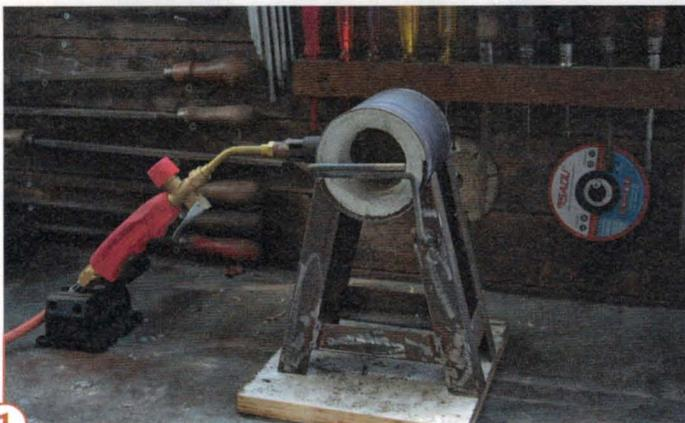
**1** Eine alte Suppendose, ausgekleidet mit einer Handvoll feuerfestem Beton: Fertig ist der selbst gebaute Härteofen. Das hier gezeigte Unterstellgestell ist geschweißt, lässt sich aber auch aus Gewindestangen und Flacheisen einfach erstellen. Sehr praktisch ist der vorgesezte Haltebügel aus gebogenen Rundmaterial.
