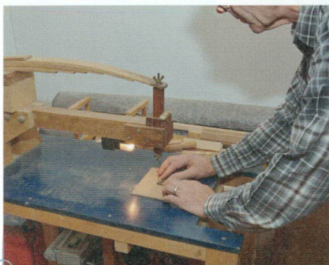
Ebenfalls ein Flohmarktfund und doch im Einsatz: Eine Dekupiersäge fast komplett aus Holz.
