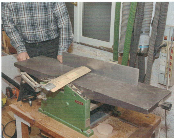
Flohmarkt-Fundstücke wie diese Abricht-Dicken-Kombi der verbliebenen Schweizer Firma Inca bilden das Rückgrat der Werkstatt.
