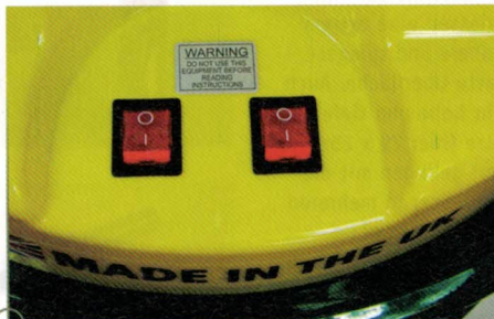
Die beiden Turbinen müssen komplett manuell geschaltet werden. Eine Elektronik, welche die beiden Turbinen abwechselnd betreibt fehlt ebenso wie eine Einschaltautomatik.
