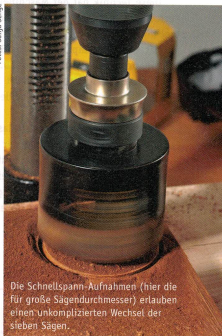
Geschränkte Sägezähne aus wärmehartem M42er HSS-Stahl schneiden das Holz zwar zuverlässig, die Teflon-Beschichtung blieb aber gleich auf der Strecke, selbst bei Nadelholz.
