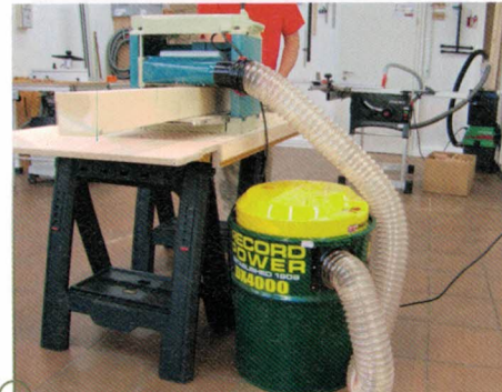
Zum Absaugen von Sägen und Fräsen eignet sich die DX4000 sehr gut. Für den Betrieb an einer Hobelmaschine ist das Behältervolumen aber schon grenzwertig.
