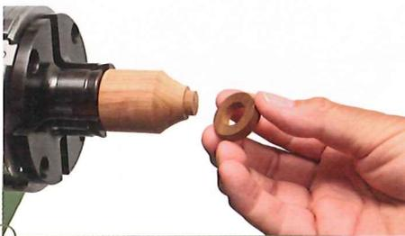
Dieses Zapfenfutter klemmt Kleinteile mit Innenbohrung; ist also zugleich ein Klemmfutter.
