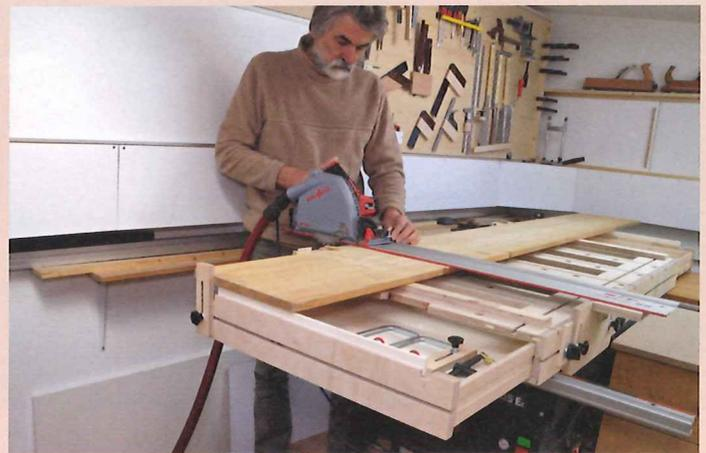
Anwendungsmöglichkeit 2, ablängen mehrerer kurzer Bretter: Brettlänge am Werkstück markieren, die Linie an die Schnittfuge der vorderen Führungsschienen-Halterung legen. Anschlagklotz als Längenanschlag in die T-Nut der Schubkastenblende anschrauben.
