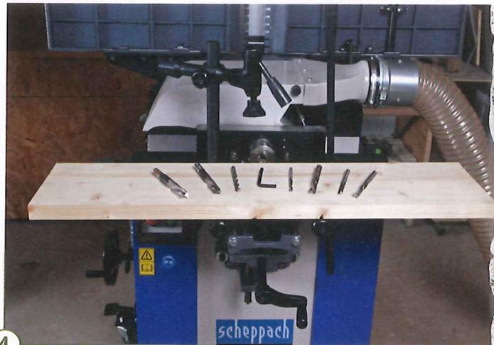
4 Da bei dieser Vorrichtung das Bohrfutter einen großen Spannbereich hat, sind auch Bohrer mit unterschiedlichen Schaftdurchmessern einsetzbar. Auch einfache Holzbohrer können eingesetzt werden, wenn die Drehrichtung stimmt. Holzbohrer sind in vielen Durchmessern rechts- beziehungsweise linksschneidend erhältlich.
