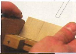
8> Vor dem Verleimen werden mit dem Streichmaß die Überlappungsflächen der Nuten gekennzeichnet, an die kein Leim gelangen darf (kleines Bild). Beim Verleimen muss penibel auf eine exakt bündige Passung der Quadrate geachtet werden.
