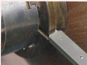
Durch die weite Ausladung des Wandungstasters können Sie sogar die Bodendicke einer großen Schale messen: Zunächst nullen, dann den Tasthaken zwischen die Backen des Futter schieben.
