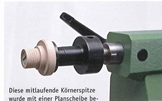
Diese mitlaufende Körnerspitze wurde mit einer Planscheibe bestückt, auf der ein selbstgefertigter Adapter montiert ist.
