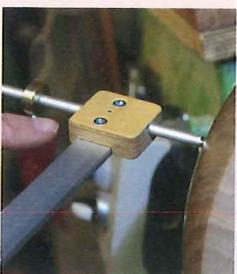
Lösen Sie die Schraube, so dass der Arm mit dem Messstab wieder verschiebbar wird und ziehen Sie die Arme auseinander. Schieben Sie sie an der Messposition wieder aufeinander zu, bis Messstab und Tasthaken am Werkstück anliegen. Der Abstand des Tiefenstoppings zum Führungsblock gibt exakt die Wandstärke wieder.
