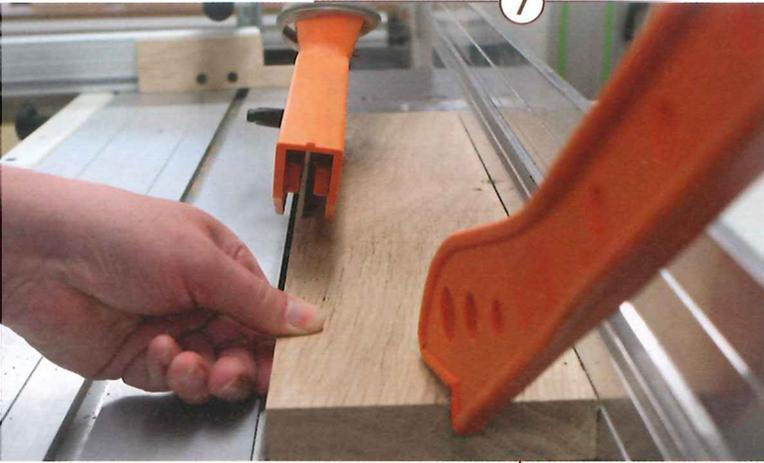
7 > Die Zargen (außer die Mittelzarge) stehen auch um 8° schräg. Damit die oberen und unteren Längskanten trotzdem in der Waagerechten liegen, erhalten die Längskanten eine 8°-Schräge. Durch Wenden der Zarge zwischen den beiden Sägeschnitten zeigen beide Schrägen in dieselbe Richtung.
