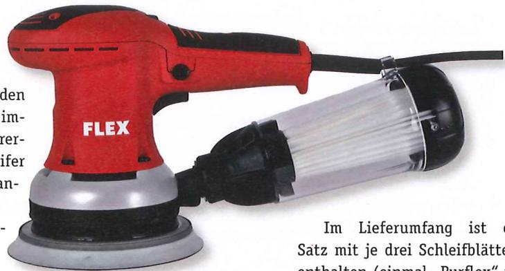
tut dem guten Ergebnis aber keinen Abbruch. Außerdem wurde ein Gefäß aus durchsichtigem Kunststoff entwickelt, an dessen Außenhülle das Maschinenkabel sauber angeklemt werden kann und man sehr gut sehen kann, wann der Staubbehälter geleert werden muss.
