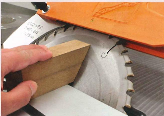
Mit der nicht angeschrägten Seite eines der beiden Klötze auf dem Maschinentisch liegend, kann nun die Sägeblattneigung eingestellt werden. Dies gelingt am besten bei voll ausgefahrenem Sägeblatt. Liegt die gesamte Schnittfläche genau auf der Fläche des Sägeblattes, dann stimmt der Neigungswinkel.
