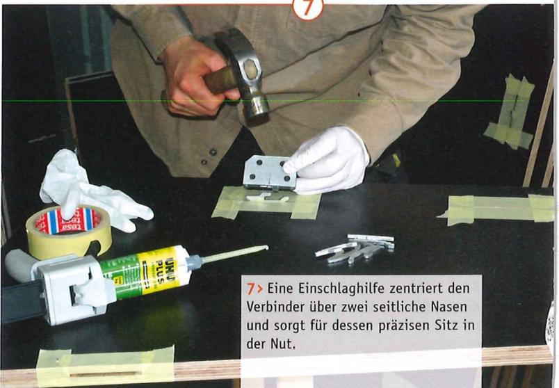
7> Eine Einschlaghilfe zentriert den Verbinder über zwei seitliche Nasen und sorgt für dessen präzisen Sitz in der Nut.
