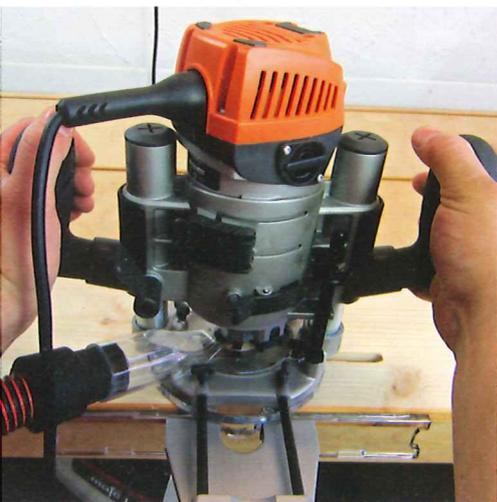
Eine solche Handhaltung ist für das Fräsen mit Anschlag sehr ungünstig. Anders kann der Parallelanschlag jedoch nicht montiert werden.
