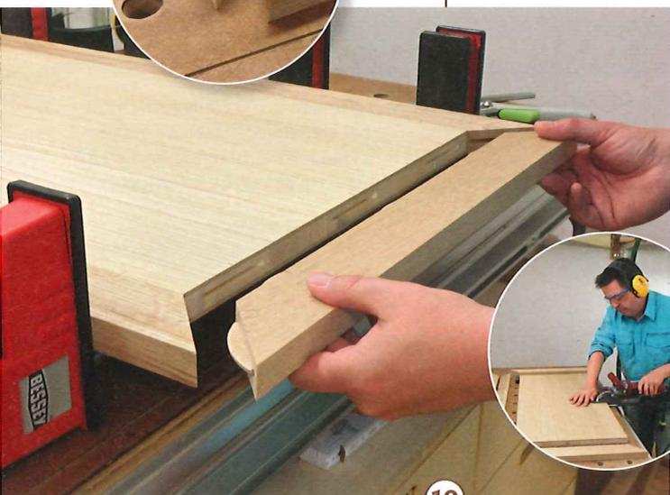
19 > Die zuvor am trocken zusammengeklebten Rahmen eingepasste Platte bekommt ringsum Fräsungen für Flachdübel. Spannen Sie den Rahmen abermals ohne Leim zusammen und richten alle Teile genau aus. Lösen sie nun jedes Teil einzeln, verleimen und verzwingen Sie es und lassen Sie den Leim trocknen.
