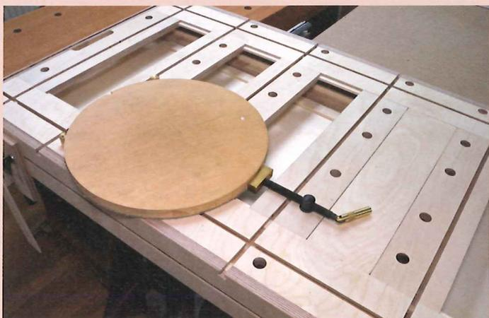
Anwendungsmöglichkeit 3: Mit den Veritas-Spannzangen Werkstücke wie auf einer Hobelbank einspannen, unabhängig von der Form der Werkstücke. Lose Tischeinlagen schließen die Zwischenräume der Querbretter, wenn eine geschlossene Arbeitsfläche gewünscht wird.
