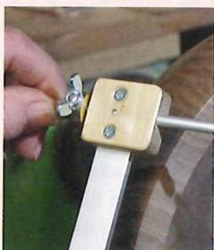
Bringen Sie zunächst die Querschiene und die Tastarme in die für Ihre Messsituation passende Grobposition und ziehen Sie alle Schrauben fest. Schieben Sie dann den runden Messstab bis an den Tasthaken heran. Drücken Sie danach den Tiefenstopp-Ring an den Führungsblock heran und ziehen ihn fest: Der Wandungstaster ist jetzt genullt.
