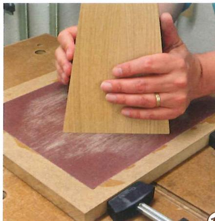
13 > Die Oberkanten der fertigen Tischbeine erhalten den richtigen Schliff auf einer mit Schleifpapier beklebten, ebenen Unterlage. Häufiges Drehen der Tischbeine um die Hochachse sorgt dabei für einen gleichmäßigen Schliff und dafür, dass nichts krumm wird.
