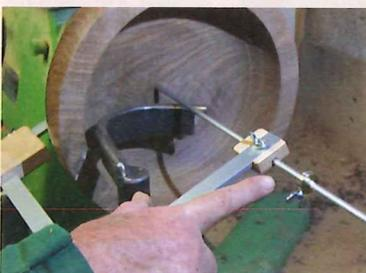
Führen Sie dann den Messstab innen an den Boden der Schale heran. Wieder zeigt der Abstand des Tiefenstoppings zum Führungsblock die verbliebene Materialstärke an.
