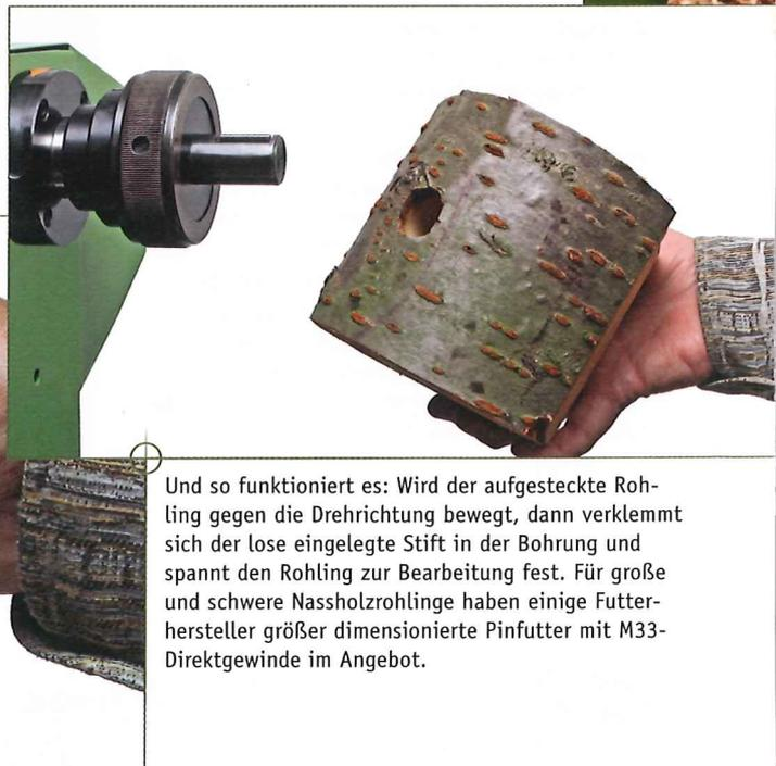
Und so funktioniert es: Wird der aufgesteckte Rohling gegen die Drehrichtung bewegt, dann verklemt sich der lose eingelegte Stift in der Bohrung und spannt den Rohling zur Bearbeitung fest. Für große und schwere Nassholzrohlinge haben einige Futterhersteller größer dimensionierte Pinfutter mit M33-Direktgewinde im Angebot.
