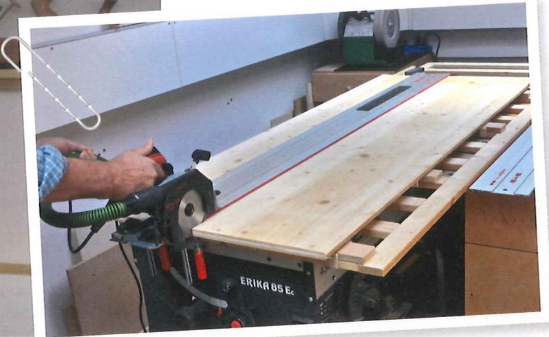
Das Ergebnis ist der Multifunktions-Tischaufsatz. An der Gitterkonstruktion aus Birke-Multiplexplatten (18 Millimeter stark) kann man normale Zwingen an vielen Stellen ansetzen. Zusätzlich werden quer und längs T-Nuten gefräst (siehe Kasten, S. 65) und 19-mm-Löcher gebohrt. In die T-Nuten passen die vorhandenen Mafell-Schraubzwingen für die Befestigung von Führungsschienen. Wer ein anderes Schienensystem verwendet, muss hier gegebenenfalls anpassen. Zusätzlich finden selbstgebaute
