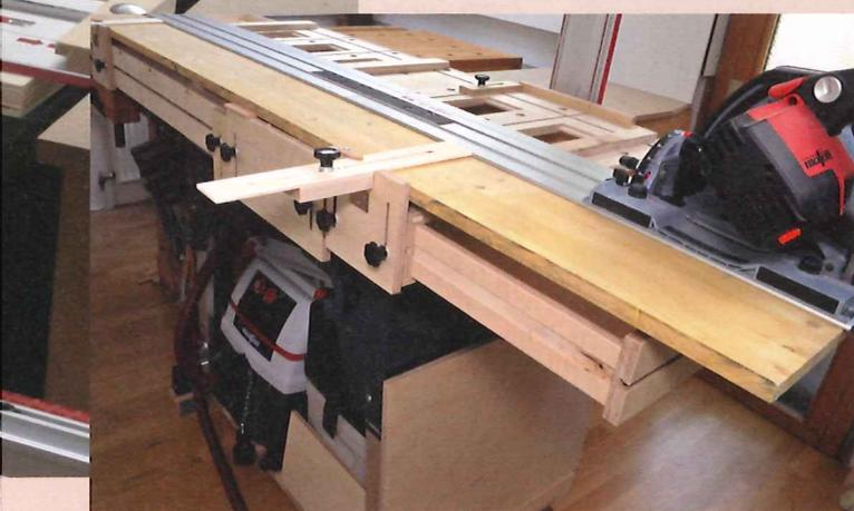
Anwendungsmöglichkeit 1, auf Breite sägen: Beide Klappanschläge auf gleiche Länge einstellen. Die linke Brettkante an die Halterungen der Klappanschläge und die Führungsschiene an die Zungen der Klappanschläge legen. Die Schubkästen dienen als Auflage. Das Werkstück liegt auf Distanzleisten.
