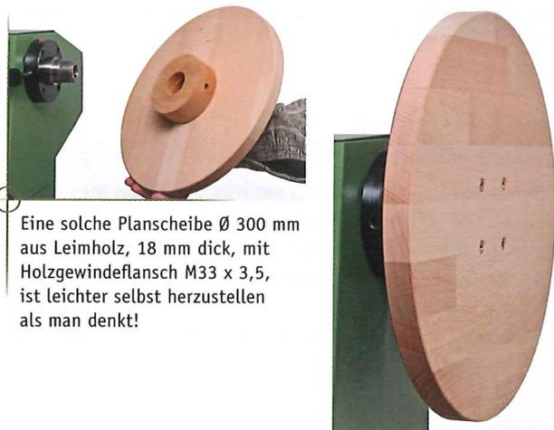
Eine solche Planscheibe Ø 300 mm aus Leimholz, 18 mm dick, mit Holzgewindeflansch M33 x 3,5, ist leichter selbst herzustellen als man denkt!
