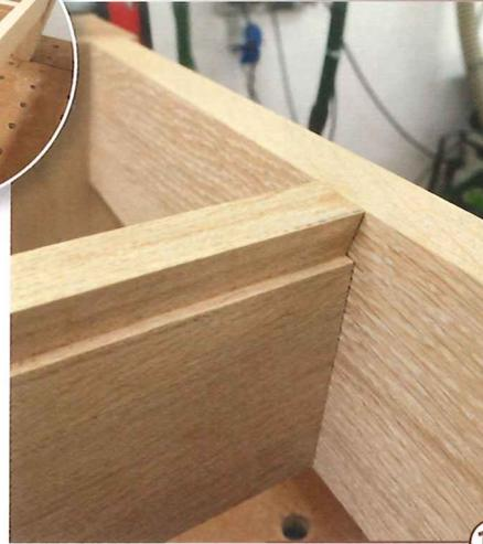
17 > Die Mittelzarge wird am trocken zusammengeklebten Tischgestell eingepasst. Die Stirnseiten sind um 8° abgeschrägt. Für sicheren Halt an den Längszargen sorgen wiederum drei parallel eingefräste Flachdübel. Wenn alles passt, verleimen Sie das ganze Tischgestell.
