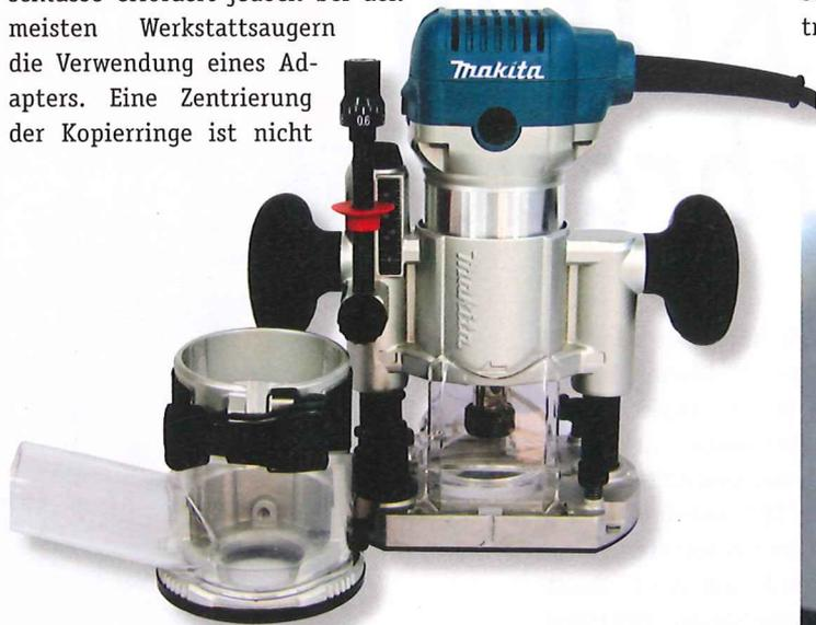
möglich. Bei unserer Testmaschine saß der Kopiererring mit tolerablen 0,2 Millimetern Abweichung in der Taucheinheit.
