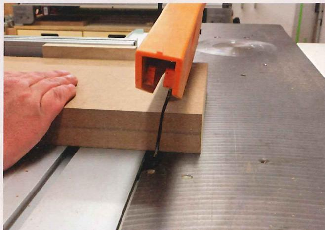
Leimen Sie zwei Reststücke (etwa zwanzig mal fünfzig Zentimeter) MDF von wenigstens 22 mm Dicke aufeinander und sägen Sie dann dieses Brett genau rechtwinklig zu. Mit der Sägeblattneigung im gewünschten Flankenwinkel (hier 8°) trennen Sie einen Streifen stirnseitig ab. Der Streifen sollte dabei in etwa so breit wie dick sein.
