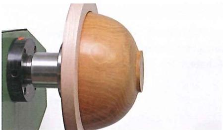
Mit dieser klemmenden Aufspannung kann die Standfläche der Schale nun auch noch bearbeitet werden.
