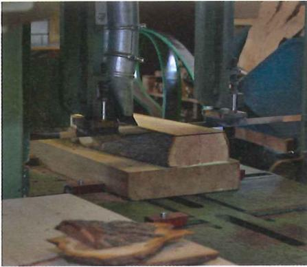
Über zwei hochfein angesteuerte Stempel findet das Sägeblatt genau die richtige Höhe. Eine Genauigkeit von zwei Zehntelmillimetern ist so drin. Das Holz – hier ein Pflaumenstämchen – wird auf eine Trägerbohle geleimt, um bis auf das letzte Blatt schneiden zu können.
