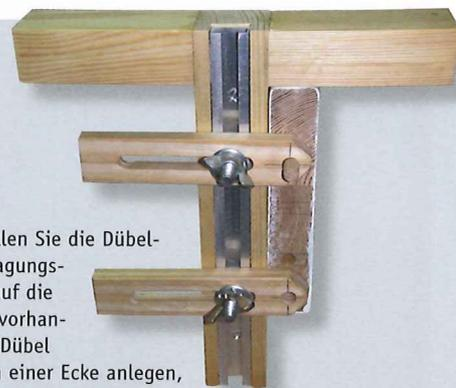
So stellen Sie die Dübelübertragungslehre auf die schon vorhandenen Dübel ein: an einer Ecke anlegen, die obere Zunge mit dem Holzdübel auf das erste Loch einstellen und festspannen. Dann die zweite Zunge auf das zweite Loch einstellen und festziehen.
