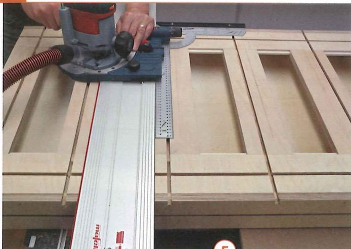
5 > Sind die Korpusseiten angeleimt und ist der Boden angeschraubt, können Sie die T-Nuten in die Arbeitsfläche fräsen. Führen Sie dazu die Oberfräse mit der Führungsschiene. Die Querbretter werden gedrittelt. Die Nuten verlaufen im ersten Drittel; sie müssen exakt rechtwinklig zur vorderen Längskante laufen.
