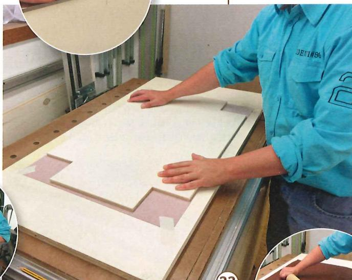
22 > Sprühkontakkleber auf Boden und Rückseite der Kunstlederbeschichtung ergibt einen guten Halt. Ein aus der Küche geliehenes Werkzeug erzeugt den nötigen Druck, damit der gut abgelüftete Kontakkleber seine Haftkraft entwickelt.
