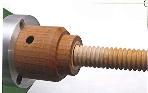
... Holzgewindestangen, die entweder selbst angefertigt oder als Fertigteile gekauft wurden. Mit dieser Methode spannt man solche Gewindeelemente am besten auf.
