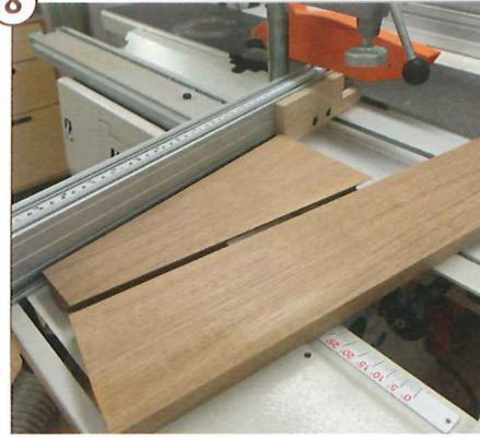
8 > Damit die Stirnkanten der Zargen flach an den Beinseiten anliegen, bekommen auch sie eine doppelte Schräge. Der Queranschlag steht unverändert im richtigen Winkel. Die Sägeblattneigung ist der Komplementärwinkel des doppelten Gehrungswinkels der Beinseiten (in diesem Fall etwas mehr als ein Grad). Mit einer Beinseite als Hilfsanschlag erfolgt der erste Schnitt. Der zweite Schnitt auf Endmaß am Queranschlag erfolgt am gedrehten Brett. Bei beiden Schnitten zeigt die Sichtseite nach oben.
