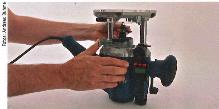
Praktisch ist der neue Arretierhebel, der die Hände frei macht für die Handhabung des Werkzeugs. Ist er geöffnet, rastet die Welle fest ein. Die Maschine ruht beim Fräserwechsel stabil auf ihrer planen Oberseite.
