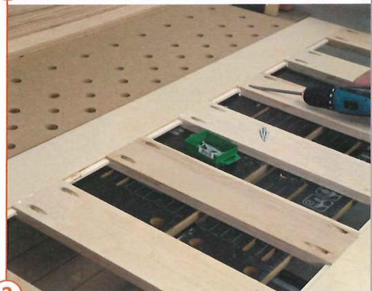
4 > Fräsen Sie die Nuten für die Fremdfeder, die T-Nuten und den Falz für den Boden, um dann die Seitenbretter mit der Arbeitsfläche zu verleimen. Spannen Sie die Seiten dazu auf die verleimte Arbeitsfläche. Die handgeführte Oberfräse arbeitet hier mit einem T-Nutfräser (D = 12,7 mm).
