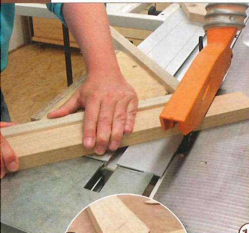
18 > Die genauen Maße der Tischplatte können einfach am Tischgestell abgegriffen werden. Der Zuschnitt der Gehrungen für den Tischrahmen gelingt am genauesten mit einem Doppelgehrungsanschlag. Flachdübel an den Gehrungen sorgen für mehr Halt und entspannteres Verleimen.
