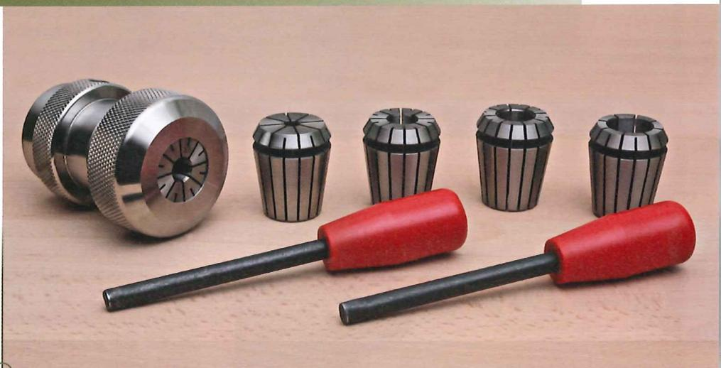
Spannzangenfutter mit M33-x-3,5-Spindelgewinde und austauschbaren Präzisionszangen von Ø 6,3 mm bis Ø 20 mm. Mit einem solchen Futter lassen sich Klein- und Zubehörteile mit hoher Präzision fertigen.
