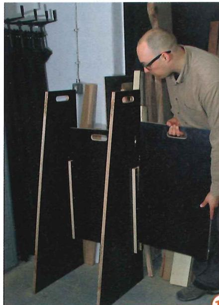
**12** > Der Zusammenbau erfolgt modulweise, je nach Anwendungsfall mit angepasster Anzahl der Felder. Die Führungsleisten erstrecken sich oben absichtlich nicht über den obersten Verbinder – so findet man den Zugang leichter.
