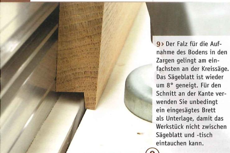
9 > Der Falz für die Aufnahme des Bodens in den Zargen gelingt am einfachsten an der Kreissäge. Das Sägeblatt ist wieder um 8° geneigt. Für den Schnitt an der Kante verwenden Sie unbedingt ein eingesägtes Brett als Unterlage, damit das Werkstück nicht zwischen Sägeblatt und -tisch eintauchen kann.
