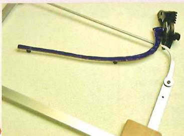
Der Schnitt durch eine Schale (symbolisiert durch den dunkelblauen Streifen) zeigt, wie weit der Wandungstaster in das Gefäß hereinreicht. Weil er nur mit einer Schraube befestigt wird, kann der Tasthaken im beliebigen Winkel arretiert werden.
