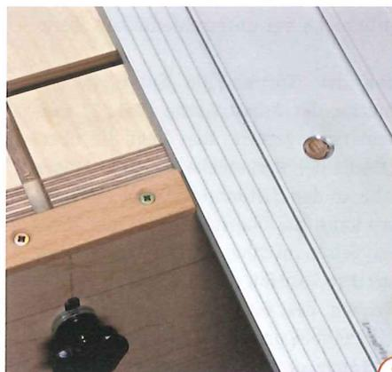
8 > Die vordere Auflage der Führungsschiene erhält eine Zwangsführung: bohren Sie ein 8-mm-Loch durch die Führungsschiene in die obere Schmalfläche der Halterung und stecken Sie einen Holzdübel ein. Ein 6-mm-Hartholz links neben die Schienenkante schrauben.
