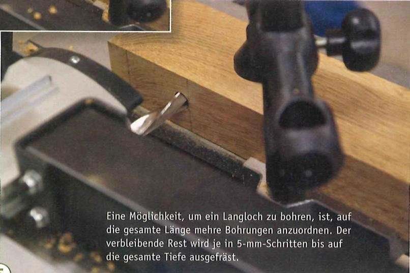
Eine Möglichkeit, um ein Langloch zu bohren, ist, auf die gesamte Länge mehrere Bohrungen anzuordnen. Der verbleibende Rest wird je in 5-mm-Schritten bis auf die gesamte Tiefe ausgefräst.
