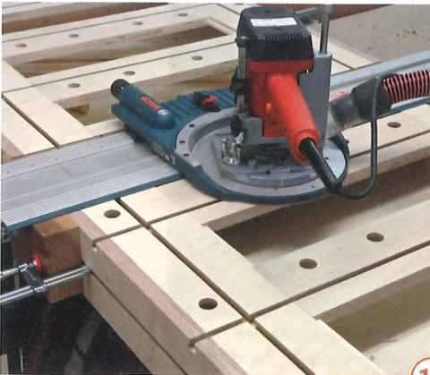
**11** Fertigen Sie die Schubkästen gemäß Stückliste und Illustrationen. Dann erhält die Arbeitsfläche noch 19-mm-Löcher für die Veritas-Spannzangen. Eine Schiene mit 32-mm-Lochraster übernimmt die Führung der mit einem stirnschneidenden 19-mm-Nutfräser bestückten Oberfräse. Ein Hilfsanschlag hält die Schiene rechtwinklig. Der Mufta ist nun fertig!
