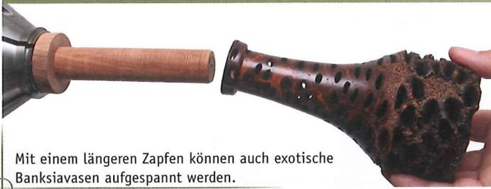
Mit einem längeren Zapfen können auch exotische Banksiavasen aufgespannt werden.
