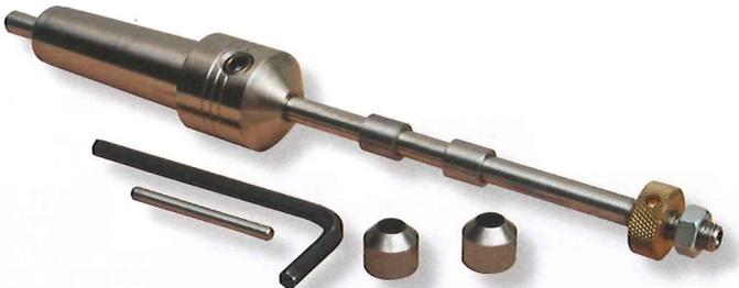
MK2-Mandrel mit längenverstellbarer Achse mit Ø 6,3 mm. Solche Vorrichtungen sind für die Fertigung von Schreibgeräten und anderen Bausätzen mit zentrischen Messinghülsen entwickelt worden. Es gibt sie in zahlreichen Varianten und mit umfangreichem Zubehör.
