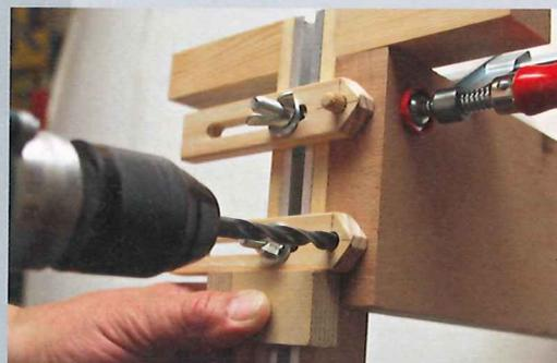
So können Sie sehr schnell die neuen Dübellöcher anfertigen: Dübellehre aufspannen, erstes Loch bohren, Holzdübel in die obere Zunge stecken, unteres Loch bohren – fertig. Der kleine Winkel unten im Bild hilft, wenn man einen Dübel auf gleicher Ebene versetzen muss.
