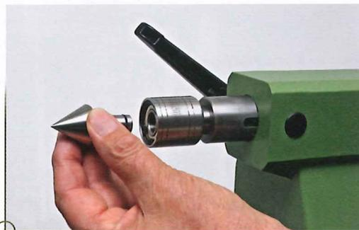
Hier wird die 25-mm-Standardspitze eingesetzt.
