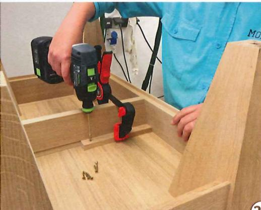
25 > Am kopfüber liegenden Tisch werden nun noch die Führungsleisten an die genau an den Tischbeinen ausgerichtete Tischplatte geschraubt. Die Dicke der Leisten ist einen Hauch geringer als die Höhe der Schwalbenschwanzführung in der Mittelzarge. Eine Längskante erhält eine der Schwalbenschwanzführung entsprechende Schräge (hier: 15°) und die Stirnkanten sind um 8° abgeschrägt.
