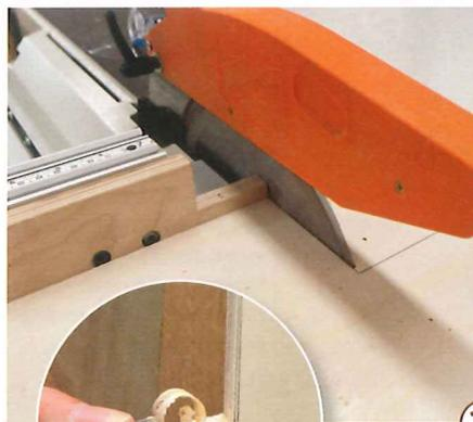
21 > Greifen Sie nun die Länge und Breite des Bodens am Tischgestell ab und sägen eine Sperrholzplatte zu. Die Maße der Ausklinkungen für die Tischbeine können direkt vom Tischgestell übertragen werden. Planen Sie rundum einen Millimeter Luft (für das Kunstleder) ein. In den Ecken versäubert ein Stechbeitel die Kanten.
