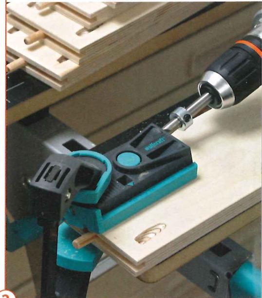
3 > Die Schraubenlöcher sind auf der Unterseite. Nehmen Sie Rundkopf-Schrauben (4 x 30 mm). Diese mit einem langen Bit vorsichtig eindrehen, die Schrauben nicht überdrehen. Benutzen Sie dazu die Drehmoment-Einstellung des Akku-Schraubers.
