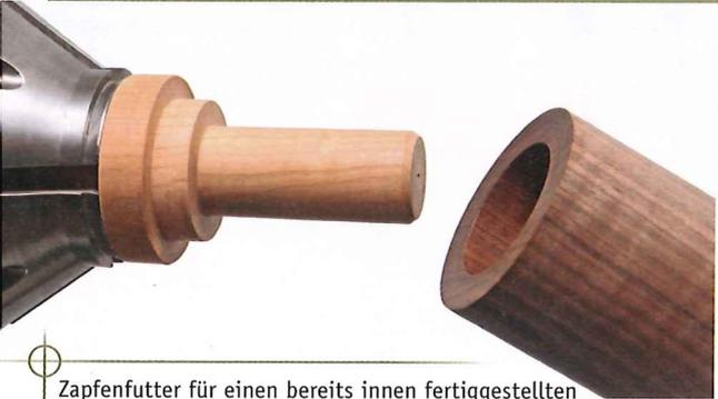
Zapfenfutter für einen bereits innen fertiggestellten Gewürzmöhlrohrling. Der Zapfen wird als negatives Abbild der Innenform gefertigt und erfordert besonders bei gestuften Profilen ein gewissenhaftes Arbeiten.
