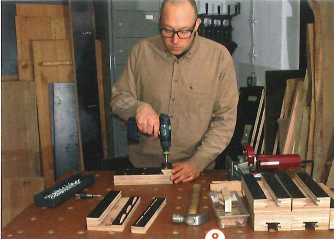
**8** > Die Schlitten für die Zwingen werden mit Flachdübeln und Schrauben sehr stabil hergestellt. Das hinten liegende Keilstück enthält zur Verstärkung zwei übereinanderliegende Flachdübel.
