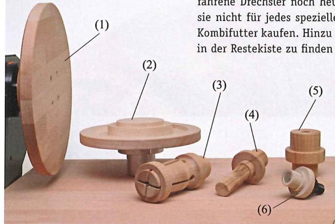
Selbst gefertigte Spannfutter aus Holz sparen Geld und erweitern den Drechselhorizont. (1) Planscheibe, (2) Klemmfutter für Querholz, (3) Klemmfutter für Langholz, (4) und (5) Zapfenfutter, (6) Adapter für kleine Planscheibe einer mitlaufenden Körnerspitze.
