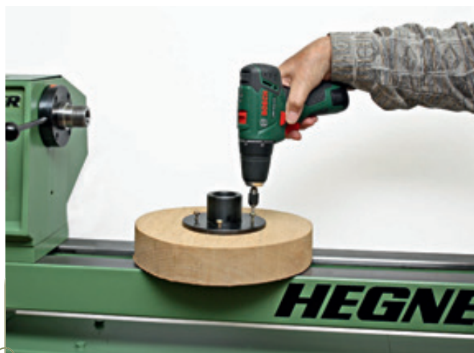
Planscheibe Ø 120 mm mit Zentrierhilfe. Zur Zentrierung ist nur ein Körnereinschlag im Mittelpunkt des Rohlings notwendig.
