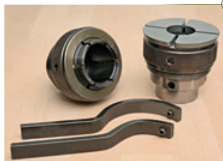
Zwei ältere Sorby-Kombifutter, links mit 50-mm-Spannzange und rechts mit aufspreizbaren Segmenten (95 mm). Diese Futter arbeiten nach dem Kegelprinzip und haben nur einen geringen Spannweg von etwa 5 mm. Eine Verletzungsgefahr ist bei dieser Futterkonstruktion nahezu ausgeschlossen.
