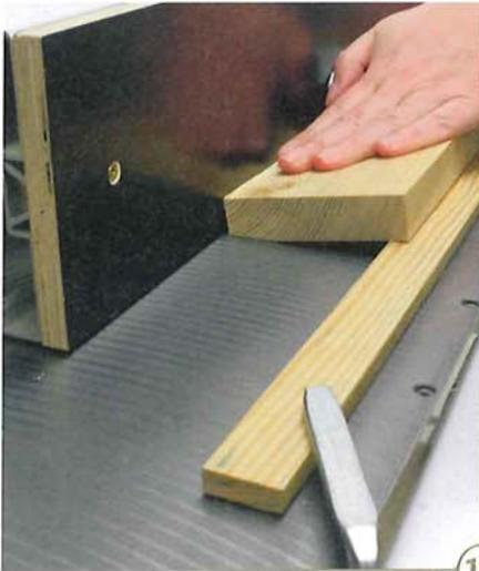
19 > Flache Schrägen können gehobelt werden wenn das Werkstück durch Unterlegen einer Leiste schräg zugeführt wird. Die Leiste wird dazu nur bis zur Hälfte der Länge abgerichtet und auf den Maschinentischen festgeklemmt. Die eingestellte Abnahme von etwa einem Millimeter wird nun nicht mehr verändert. Die Anzahl der Zuführungen des Werkstückes bestimmt die Breite und Tiefe der Schräge.
