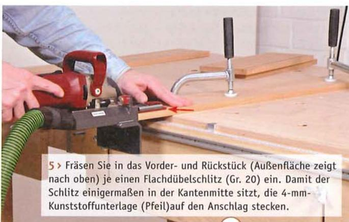
5 > Fräsen Sie in das Vorder- und Rückstück (Außenfläche zeigt nach oben) je einen Flachdübelschlitz (Gr. 20) ein. Damit der Schlitz einigermaßen in der Kantenmitte sitzt, die 4-mm-Kunststoffunterlage (Pfeil) auf den Anschlag stecken.
