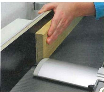
9 > Ziehen Sie nun den Fügeanschlag vor und senken die Schutzbrücke ganz ab. Geben Sie nur soviel von der Messerwelle frei, dass das Brett gerade zwischen die Schutzbrücke und den Fügeanschlag passt, ohne zu klemmen.
