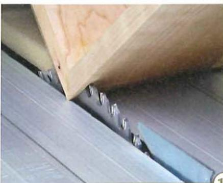
11 > Achten Sie auf die richtige Höheneinstellung des Sägeblattes, um nicht ins Kasteninnere zu schneiden. Hier gilt es zu wählen: Für eine Nut mit ebenem Nutgrund wäre ein Flachzahn-Sägeblatt optimal, für einen möglichst auorrissfreien Schnitt hingegen (wie hier) ein Sägeblatt mit Wechselbezzahnung.
