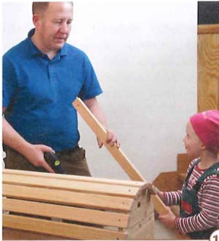
10 > Runden Sie nun die Kanten (Radius 3 mm) und schleifen Sie alle Sitzleisten. Schrauben Sie diese dann mit Edelstahlschrauben (4 x 60 mm) am Vorder- und Hinterstück an: zuerst die fünf oberen, danach die je vier an den Längsseiten um 15° schräg geschnittenen Seitenleisten.
