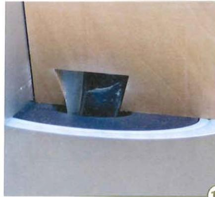
16 > Die Vorgehensweise ist ähnlich wie beim Sägen der falschen Federn. Statt eines Sägeblattes kommt ein Fräser zum Einsatz. Die 45°-Rampe wird am Fräsanschlag entlang geführt. Besonders effektiv sieht diese Verbindung aus, wenn man sie mit einem Gratfräser erstellt.
