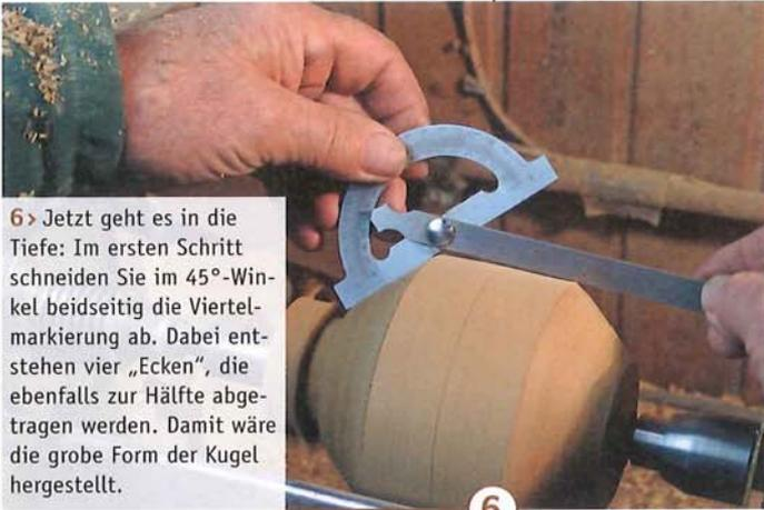
6 > Jetzt geht es in die Tiefe: Im ersten Schritt schneiden Sie im 45°-Winkel beidseitig die Viertelmarkierung ab. Dabei entstehen vier „Ecken“, die ebenfalls zur Hälfte abgetragen werden. Damit wäre die grobe Form der Kugel hergestellt.
