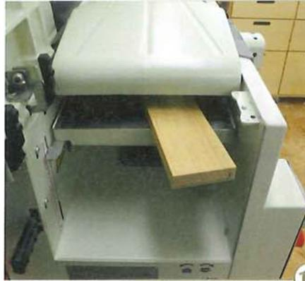
17 > Hobeln Sie nun alle Bretter auf Dicke, beginnend mit dem dicksten, mit einer Zustellung von einem Millimeter pro Durchgang. Tipp: Führen Sie die Bretter schräg zu, dann nutzen die Hobelmesser gleichmäßig auf ihrer ganzen Breite ab!
