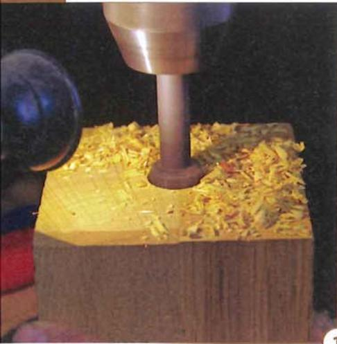
1 > Die Kugel soll einen Durchmesser von 110 mm haben. Der Rohling aus Eiche hat die Maße 120 mal 120 mal 170 mm. Auf einer Seite wird zentrisch ein Loch von 25 mm Durchmesser und 30 mm Tiefe gebohrt.
