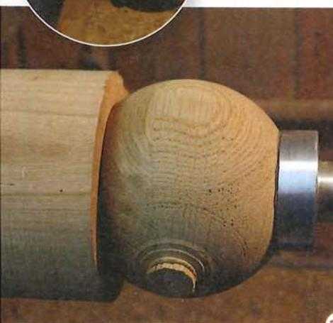
10 > Fertigen Sie aus weichem Restholz ein Kalottenfutter (Aushöhlung in Kugelform) für die Spindelstockseite. In den Reitstock kommt ein kleines mitlaufendes Futter. Solche Futter bietet der Handel an, die meisten Drechsler drehen sich diese Hilfsmittel aber selbst mit einer Aufnahme für die mitlaufende Standard-Körnerspitze. Spannen Sie dann die Kugel um 90° gedreht ein.
