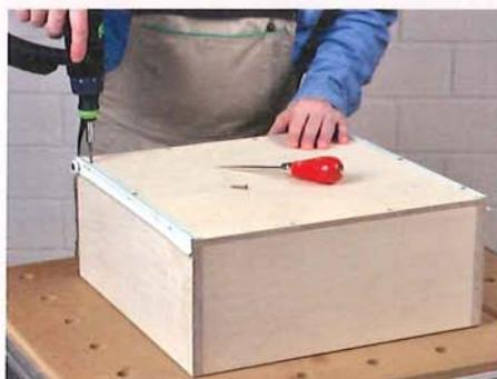
Einfacher geht's nicht: Schubkastenseiten mit Flachdübeln verbinden, Boden zuschneiden und mit dem Vorder- und Rückstück verschrauben und ganz zum Schluss die beiden Auszugschienen zusammen mit dem Boden an den Seitenteilen festschrauben – fertig!
