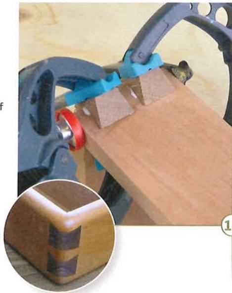
18 > Die falschen Zinken werden auf der Tischkreissäge passgenau geschnitten und in die Fräsungen geleimt. Auch hier kann Holzkontrast die Eckverbindung hervorheben. Nach dem bündigen Abschneiden der Überstände haben Sie eine stabile und dekorative Eckverbindung.
