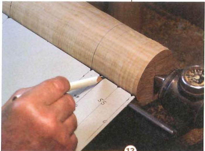
13 > Mit einem Schreibstift markieren wir die Maße auf das langsam rotierende Werkstück, exakt geführt durch in die Pappe geschnittene Kerben.
