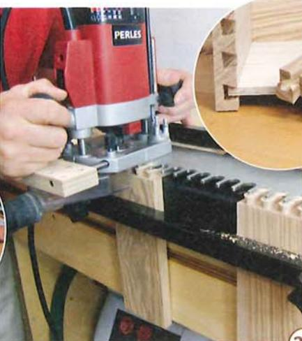
24 > Als Eckverbindung für die Schubladen bieten sich halbverdeckte Zinken an. Mit einer Vorrichtung für die Oberfräse sind diese schnell erstellt. Der Boden aus 6 mm starkem Multiplex sitzt in einer 8 mm tiefen Nut, die genau in einem Zinken positioniert wird. Die Nut ist dadurch später nicht zu sehen.
