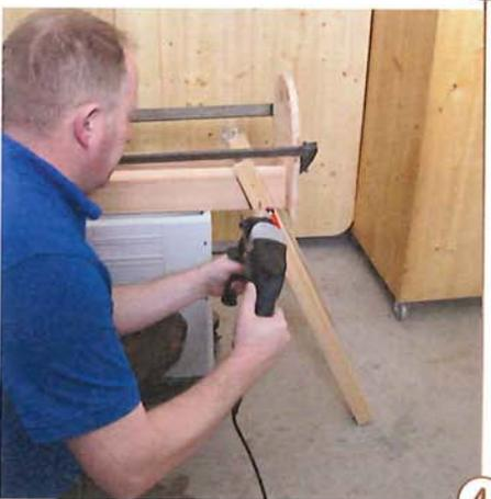
4 > Die Vorderbeine stehen 20° in Kopf-, die Hinterbeine 10° in Schweifrichtung schräg. Die Schrägstellung zur Seite (8°) wird an der Tischsäge am oberen Bein-Ende hergestellt. Markieren und bohren Sie alle Beine von der Mitte und von beiden Seiten bei 30 mm mit einem 4-mm-Bohrer vor. Je zwei Schloss-Schrauben (8 x 70 mm) verbinden später Bein und Rumpf.
