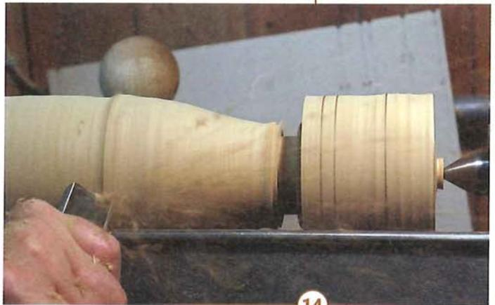
14 > Der nächste Arbeitsschritt betrifft nur die unterschiedlichen Durchmesser des Kegels. Hier ist ein gut geschärfter Abstechstahl in Kombination mit einem Bedan oder Plattenstahl nützlich. Mit einer Röhre kann nun genau nach dem Modell oder Zeichnung das Profil geschnitten werden.
