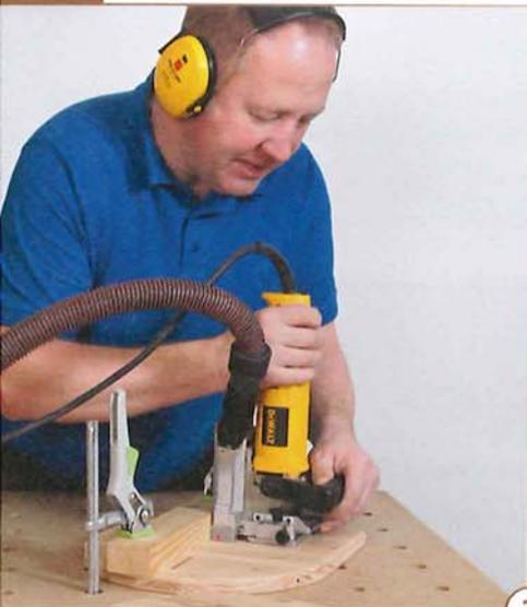
1 > Beginnen Sie mit dem Winkelzusschnitt an der Kreissäge (s. Illustration, S. 56). Seiten und Vorder- und Hinterstück verbindet je zwei 20-mm-Flachdübel bündig mit der Unterkante (Abstand 60 mm von der Seite). Fräsen Sie an der Außenseite des Vorderstücks zwei 20-mm-Flachdübel-Nuten für den Kopf.
