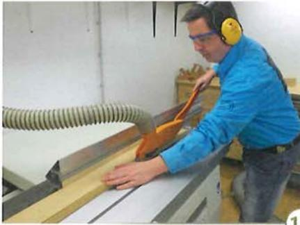
13 > Sägen Sie nun alle Bretter auf zwei bis drei Millimeter „über“ der gewünschten Endbreite. Alle Bretter haben dann die gleiche Ausgangsbreite und so wird ein Klemmen beim anschließenden Hobeln auf Breiten vermieden.
