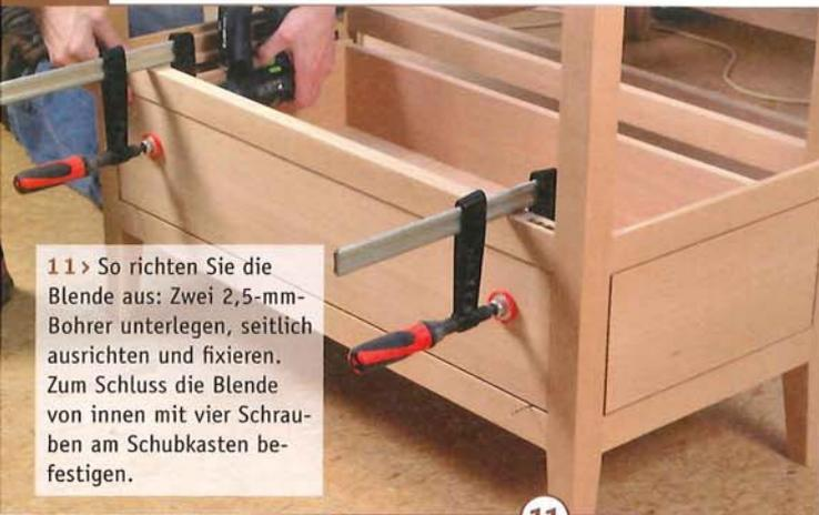
11 > So richten Sie die Blende aus: Zwei 2,5-mm-Bohrer unterlegen, seitlich ausrichten und fixieren. Zum Schluss die Blende von innen mit vier Schrauben am Schubkasten befestigen.
