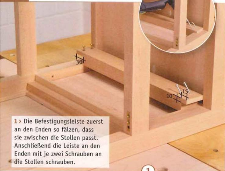
1 > Die Befestigungsleiste zuerst an den Enden so fälzen, dass sie zwischen die Stollen passt. Anschließend die Leiste an den Enden mit je zwei Schrauben an die Stollen schrauben.
