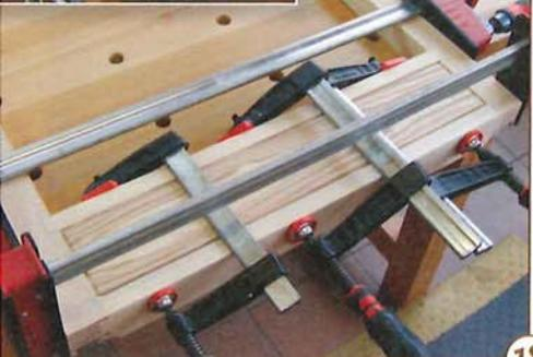
18 > Der erste Schritt des Verleimens folgt. Die beiden Seitenteile werden vorgeleimt. Die FüÙe werden am Ende mit einer passend abgelängten Leiste und zwei Schraubzwingen im richtigen Abstand gehalten (kleines Bild). Korpuszwingen machen Zulagen überflüssig und erleichtern das rechtwinklige Verleimen.
