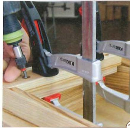
28 > Eine Stoppleiste an der Unterseite der oberen Traversen erfüllt gleich zwei Aufgaben. Sie gibt die genaue Position der geschlossenen Schublade vor und sie verhindert, dass die Schublade versehentlich zu weit herausgezogen werden kann. Diese Leiste wird von oben angeschraubt, bevor die Platte montiert wird.
