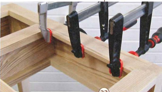
23 > An die oberen, seitlichen Traversen werden Leisten mit einem Querschnitt von 8 x 8 mm angeleimt. Sie dienen als Laufleisten für die verschiebbare Arbeitsplatte. An diese werden Winkelleisten angeschraubt. Eine sehr einfache aber ausreichende Führung, damit die Platte ein Stück nach vorne aufgeschoben werden kann.
