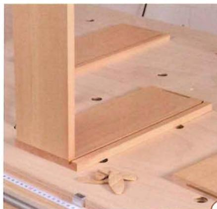
7 > Pro Ecke reicht ein Flachdübel Gr. 20 bei dieser Schubkastenhöhe völlig aus. Vorder- und Rückstück des Schubkastens gehen nur bis zur Nut. So kann der Boden später problemlos in die Nut eingeschoben und bei Beschädigungen auch jederzeit wieder entfernt werden.
