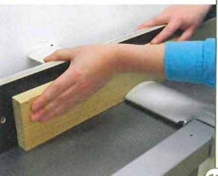
11 > Lassen Sie beide Hände auf dem Fügeanschlag „reiten“, indem Sie ihn teilweise umgreifen. Dies verringert die Gefahr abzurutschen, sollte das Werkstück Ihnen entgleiten! Genau wie beim Abrichten übernehmen beide Hände hinter der Hobelwelle die Führung und den Vorschub im Wechsel.
