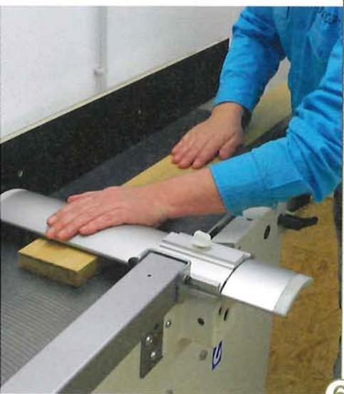
6 > Die Führungshand wandert nun über die Schutzbrücke und übt weiterhin Druck nach unten aus. Am Anfang des Brettes entsteht eine angehobelte Fläche. Es gilt, diese plan auf dem Abnahmetisch zu halten. Die linke Hand übernimmt nun auch zum Teil den Vorschub.
