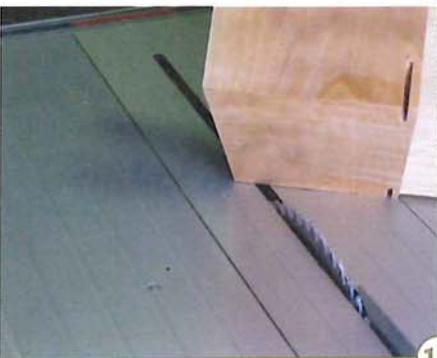
12 > Besonders dekorativ sehen die falschen Federn aus, wenn sie schräg oder sogar über Kreuz eingesetzt werden. Dies können Sie auf verschiedene Arten erreichen. Entweder bleibt das Sägeblatt gerade und Sie arbeiten mit dem Schiebetisch und schräg gestelltem Anschlaglineal ...
