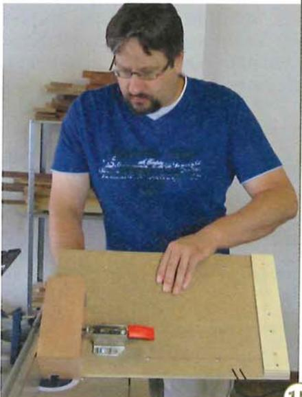
15 > Wie die falschen Federn können auch falsche Zinken eine stumpf auf Gehrung verleimte Ecke stabilisieren. Bei dieser Anwendung wird die 45°-Rampe auf dem Frästisch eingesetzt. Mit einem normalen Nutfräser können Sie Fingerzinken imitieren. Mit einem Gratfräser entstehen wie hier falsche schwalbenschwanzförmige Zinken.
