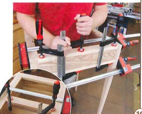
19 > Nacheinander werden die Rückseite, die Zwischenwand, die Vorderseite und der Laufrahmen eingeleimt. Die Art der Eckverbindungen und deren Anordnung machen das Verleimen in mehreren Schritten sehr einfach und stressfrei.
