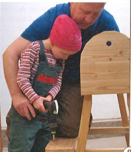
8 > Die Fußbretter stabilisieren das Fußgestell. An der Kreissäge erhalten sie je 50 mm von außen 4 mm tiefe Nuten. Die Fußbretter werden mit je zwei Edelstahlschrauben (4 x 60 mm) auf der Tragleiste befestigt. Punktuell zwischen den beiden Schraubpunkten wird Leim angegeben.
