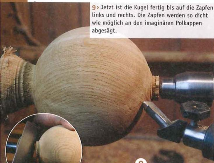
9 > Jetzt ist die Kugel fertig bis auf die Zapfen links und rechts. Die Zapfen werden so dicht wie möglich an den imaginären Polkappen abgesägt.
