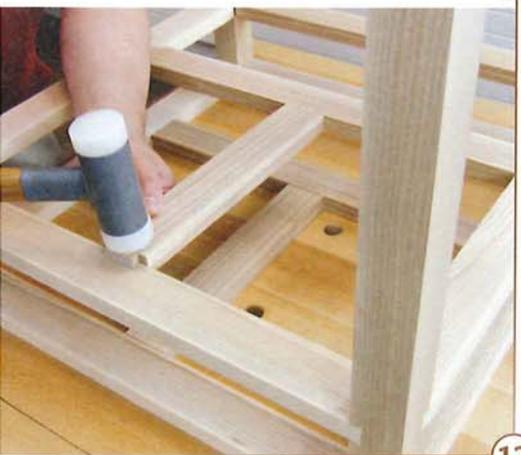
12 > Wie ein Puzzle können Sie nun die Einzelteile zum Gestell zusammensetzen. Dadurch, dass die Schwalben alle maschinell gefräst wurden, können gleiche Teile an beliebiger Stelle eingesetzt werden. Es ist nicht notwendig, sie einzeln zu markieren. Vertauschen kann man hier nichts.
