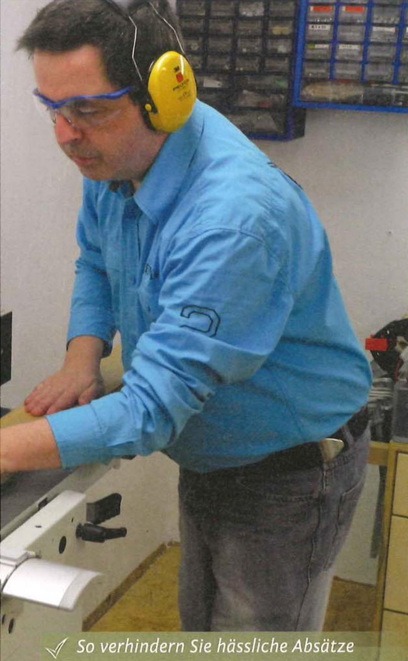
1 > Bevor ein unbesäumtes Brett gehobelt werden kann, muss die Waldkante sowie je nach Holzart auch der Splint entfernt werden. Ist es ein Mittelbrett, dann muss auch der Kern herausgesägt werden. Diese Arbeiten erfolgen entweder an der Kreissäge oder mit der Handkreissäge und Führungsschiene.
