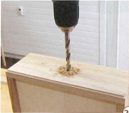
26 > In die Schubladenfronten muss ein Loch gebohrt werden. Hier wird der Geigenwirbel eingeklebt, der als Griff dient. Den genauen Bohrdurchmesser messen Sie direkt am Wirbel ab. Er sollte etwa 10 mm tief eingebohrt sein. Und wird mit Epoxidharz oder einem ähnlichen Klebstoff befestigt.
