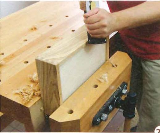
25 > Nach dem Verleimen der Schubkästen werden diese mit dem Hobel genau eingepasst. Ein wenig Luft sollten Sie schon haben, aber eben nicht zu viel. Als optische Trennung wird wie bei den Füllungen auch an die Schubladen ein kleiner Falz angebracht.
