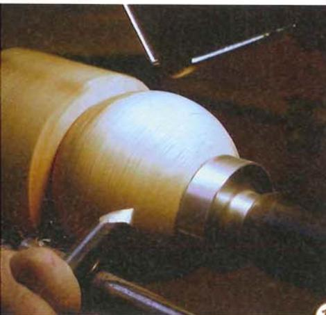
11 > Bei ausreichendem Anpressdruck über die Pinole, erhöhter Rotation und gleichzeitig feinsten Spanabnahme sind die überstehenden Zapfen schnell abgetragen. Drechseln Sie hier (wegen der Querlage der Fasern zur Achse) von der Drehachse aus nach außen. Durch sorgsames Wechseln der Kugel in dem Holzfutter und Schleifen entsteht so eine perfekte Form.
