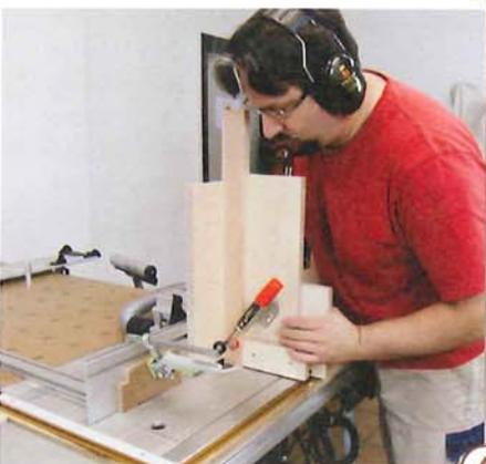
4 > Die Traversen werden mit der einfachen Zuführlade (auf Seite 15) gefräst. Sie hält die Werkstücke sicher in der richtigen Position, verhindert das Verkanten am Anschlag und die Finger sind weit weg vom rotierenden Fräser. Ein Kniehebelspanner macht den Werkstückwechsel sehr komfortabel.
