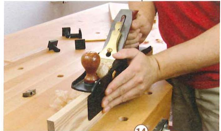
14 > Die Füllungen sitzen ohne Luft stumpf im Rahmen. Eine gute Verleimung ohne Fugen erreichen Sie, indem Sie die Füllungen einzeln einpassen. Der Handhobel ist hierzu das beste Werkzeug. Ein Fügeanschlag hilft, die Kanten im rechten Winkel zur Fläche zu halten.
