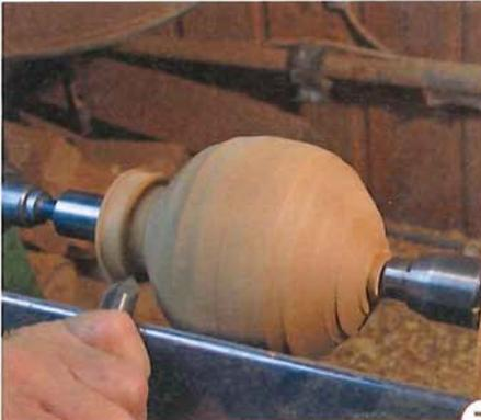
7 > Kleine Unebenheiten können jetzt noch mit der feinen Röhre beseitigt und nach Augenmaß geglättet werden. Sehr hilfreich ist auch eine Pappschablone, aus der die exakte Kreisform mit dem Kugeldurchmesser geschnitten wird. Legen Sie sie immer wieder an die werdende Kugel.
