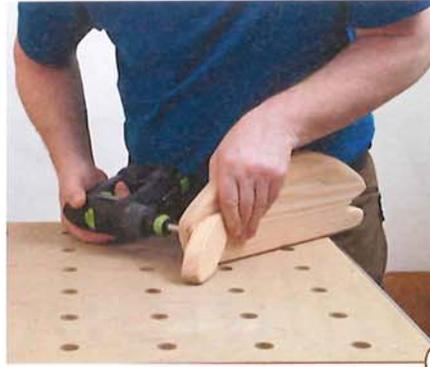
13 > Mit Leim und zwei Edelstahlschrauben (4 x 60 mm) wird der Kopf am Rumpf des Pferdes befestigt. Nun können Sie die Ohren mit je zwei Edelstahlschrauben (3,5 x 40 mm) und Leim von der Innenseite her an den Wangenbrettern befestigen.
