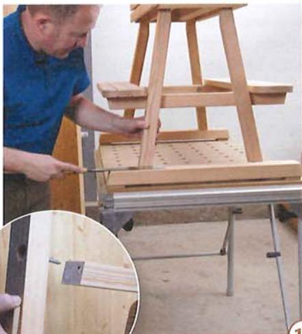
11 > Kürzen Sie die Beine und verbinden Sie dann die Tragleisten mit Schlüsselschrauben (8 x 80 mm) am Ende der Beine. Am Hirnholz der Beine wird zweimal dünn Leim angegeben, da nach dem ersten Auftrag der Leim vom Hirnholz aufgesogen wird. Die Bohrung erfolgt beidseitig 10 mm von den Innenkanten der Beine.
