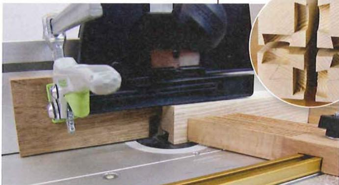
3 > Die Schwalbenschwanzverbindung zwischen Fuß und Traverse wird auf dem Frästisch erstellt. Die genauen Maße der Fräsung bestimmen Sie anhand Ihres Gratfräasers. Die in der Zeichnung angegebenen Maße dienen als Richtwerte. Verwenden Sie Andruckfedern und einen Stoppklotz beim Fräsen.
