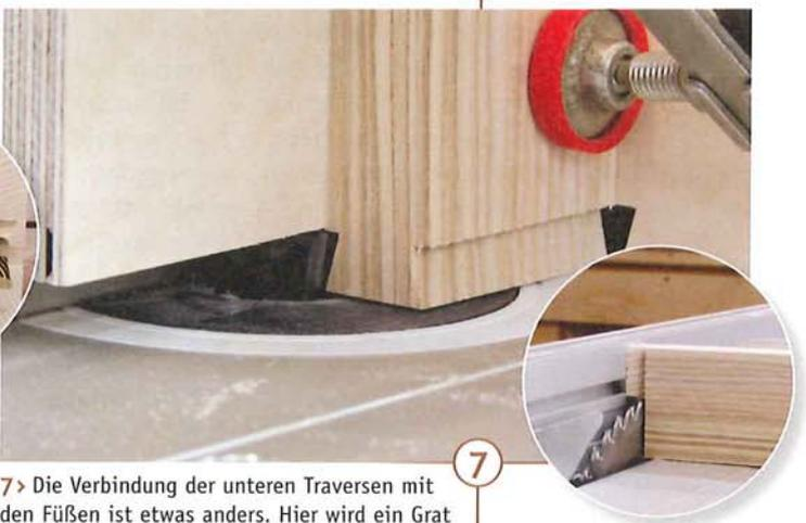
7 > Die Verbindung der unteren Traversen mit den Füßen ist etwas anders. Hier wird ein Grat an die beiden Enden der Traverse angefräst. Die Zuführlade wird für diese Fräsungen umgebaut. Anschließend wird die Verbindung an der Tischkreissäge zum Teil entfernt (Absetzen genannt). Es bleibt eine 20 mm lange Schwalbe übrig.
