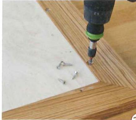
29 > Die gefälzte Füllung der Platte wurde von einem Polsterer mit schwarzem Alcantara bezogen. Sie wird von unten mit dem Rahmen verschraubt. Sollte der Bezug einmal abgenutzt oder beschädigt sein, kann man ihn austauschen.
