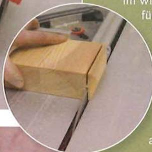
Dieses Kapitälchen (Bilderfolge 3 bis 7) besteht beispielsweise aus vier Teilen: einem Grundholz (als Basis), einem schmückenden Walmholz und je einer oberen und unteren Abdeckung. Das Walmholz wird an der Kreissäge im Winkel von 15° zugeschnitten (Bild 3) und später auf das (umlaufend fünf Millimeter größere) Grundholz geleimt (Bild 4). Beim Zuschnitt sollte ein Abstand von etwa 120 Millimetern zwischen Sägeblatt und der haltenden Hand einkalkuliert werden.
