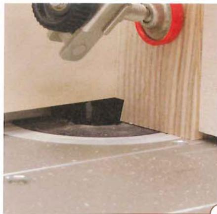
5 > Passen Sie die Schwalben der oberen Traversen ganz genau an die Fräsung in den Füßen an. Die Anschläge an der Zuführlade dienen gleichzeitig als Opferholz. Die Fräsungen werden dadurch aussrissfrei.
