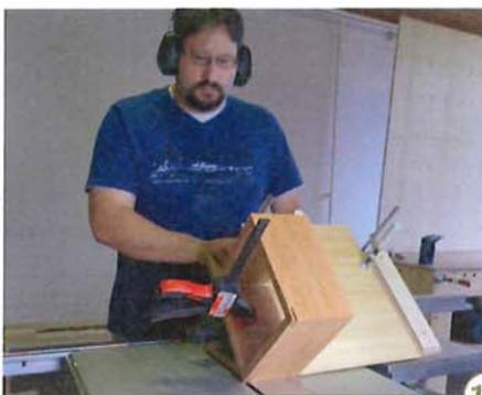
10 > Falsche Federn werden diagonal in die verleimte Gehung eingesetzt. Dazu muss zunächst ein Schlitz geschnitten werden. Hierzu können Sie unsere 45°-Rampe wie hier auf dem Schiebetisch Ihrer Säge befestigen, oder Sie führen sie quer am Parallelanschlag vorbei.
