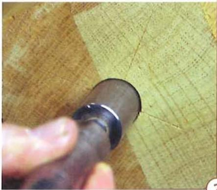
2 > In dieses Loch wird der Exzenter-spanner (auch bekannt als Pin-Futter) eingeführt, auf die mitlaufende Körnerspitze des Reitstocks zentrisch ausgerichtet und festgespannt.
