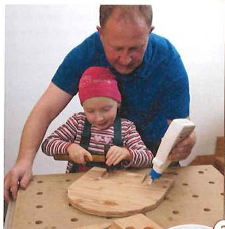
2 > Am fertig zugeschnittenen Hinterteil setzen Sie dann für den Schweif mitig 50 mm von oben eine Bohrung (d = 25 mm). Die Oberfräse rundet das Bohrloch und die Außenkanten beidseitig ab. Nun können Sie den Rumpf verleimen.
