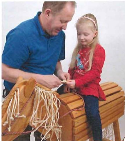
16 > Nun werden noch die Enden der Mähne verknotet. Sie besteht aus 25 Sisalschnüren (je 450 mm lang). Das Verknoten verhindert, dass die Schnüre aufribbeln oder die Mähne versehentlich durch die Bohrlöcher rutscht. Sisal ist ein Naturprodukt und altert durch Witterungseinflüsse.
