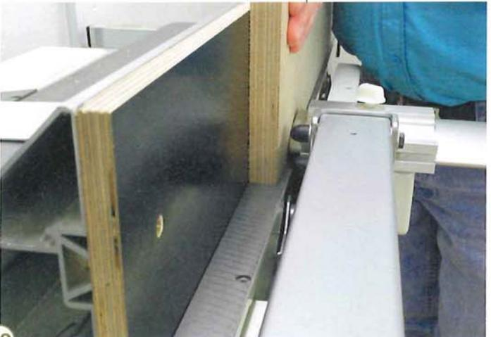
20 > Auch Kanten von Plattenwerkstoffen können hervorragend gefügt werden, was sehr nützlich sein kann bei Einpassarbeiten. Plattenwerkstoffkanten stumpfen die Hobelmesser schneller und unregelmäßig ab. Reservieren Sie deshalb für diese Arbeiten die vorderen zwei bis drei Zentimeter der Hobelwelle und meiden Sie diesen Bereich bei der Bearbeitung von Massivholz.
