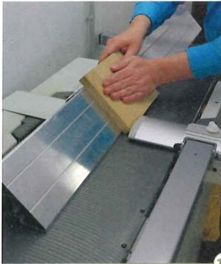
18 > Der Abricht-Dickenhobel kann noch mehr: Am schräg gestellten Fügeanschlag lassen sich schnell Kanten fassen, auch stirnseitig. Die Rüstzeit ist kurz im Vergleich zum Aufbau eines Frästisches oder dem Rüsten der Tischfräse. Beginnen Sie immer mit einer Stirnseite und drehen Sie das Werkstück im Uhrzeigersinn. Eventuelle Ausrisse werden somit im nächsten Durchgang wieder entfernt.
