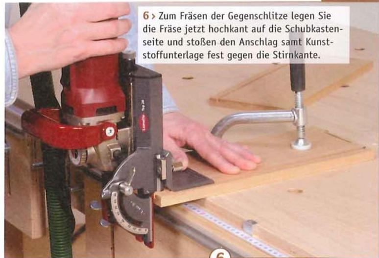
6 > Zum Fräsen der Gegenschlitz legen Sie die Fräse jetzt hochkant auf die Schubkasten-seite und stoßen den Anschlag samt Kunststoffunterlage fest gegen die Stirnkante.
