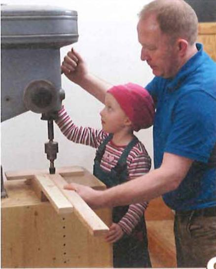
9 > Je nach Alter des Kindes können Sie an der Ständerbohrmaschine die Sitzleisten gemeinsam bohren. Zum Einsatz kommt ein 5-mm-Bohrer mit aufgestecktem Senker. Die Bohr- und Senktiefe wird über die Tiefeneinstellung der Ständerbohrmaschine gewährleistet.
