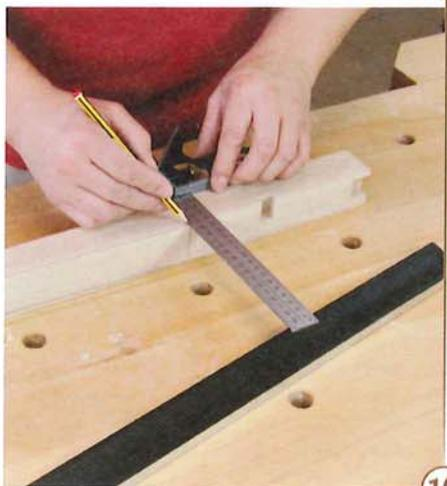
16 > Erst wenn alle Verbindungen zwischen Traversen und Laufrahmen erstellt wurden, geht es an das Anzeichnen und Abschrägen der Füße. Lassen Sie unbedingt die oberen 200 mm gerade. Von diesem Punkt aus verjüngen sich die Füße auf einen Querschnitt von 20 x 20 mm.
