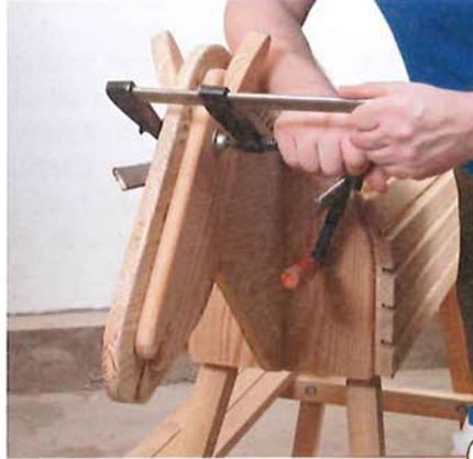
14 > Die Wangenbretter werden auf den Kopf und die Seitenteile auf den Rumpf geleimt. Achten Sie bei transportablen Pferden unbedingt darauf, dass beim Anbringen der Seitenteile kein Leim an den Kopf selbst kommt. So können Sie etwa transparentes Paketklebeband im Fugenbereich einsetzen.
