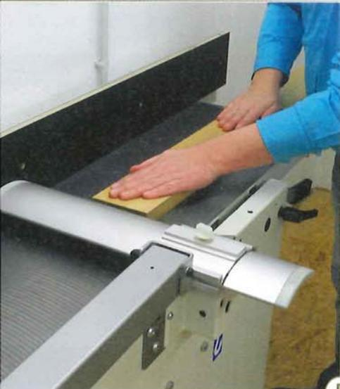
5 > Beim Zuführen des Brettes übernimmt die linke Hand die Führung und drückt das Brett auf den Aufgabebesch. Die rechte Hand übernimmt den Vorschub und drückt das Brett nach vorne. Der Vorschub ist möglichst regelmäßig. Keinesfalls darf das Brett zurückgezogen werden: Rückschlaggefahr!
