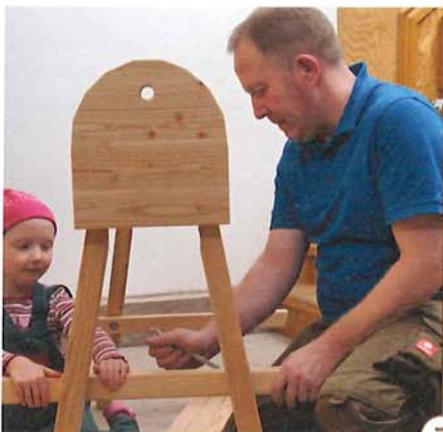
7 > Die Tragleisten werden an der Kreissäge an den Enden um 15° schräg geschnitten. Mit Schlüssel-Schrauben (8 x 80 mm) und D4-Leim werden sie 300 mm von der Rumpfunterkante an den Beinen befestigt. Auch hier wird dünn vorgebohrt, dann von der Innenseite der Beine ein Sackloch erstellt.
