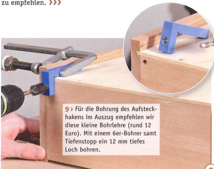
9 > Für die Bohrung des Aufsteckhakens im Auszug empfehlen wir diese kleine Bohrlehre (rund 12 Euro). Mit einem 6er-Bohrer samt Tiefenstopp ein 12 mm tiefes Loch bohren.
