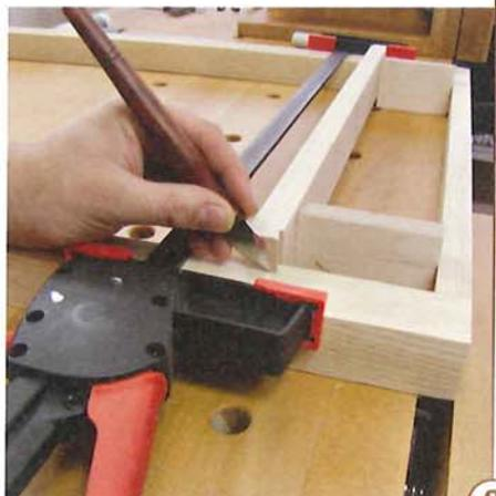
8 > Positionieren und fixieren Sie die unteren Traversen. Mit einem Anreißmesser lassen sich die Schwalben haargenau auf die (hier liegenden) Füße übertragen. Zwei Abstandhalter mit der Länge von 88 mm werden dabei zwischen obere und untere Traverse geklemmt. Sie sorgen dafür, dass alle Traversen später auf der gleichen Höhe sitzen.
