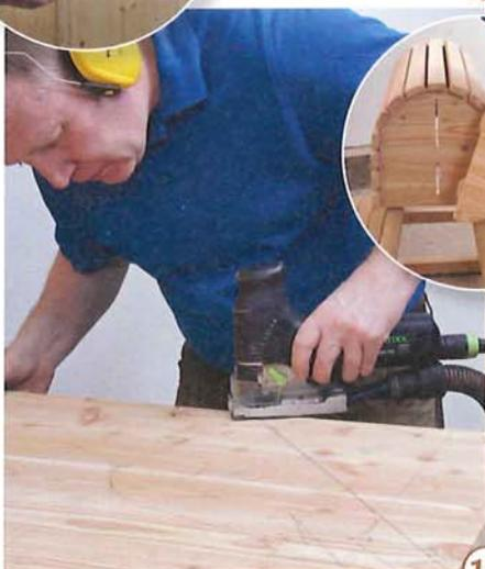
12 > Mit der Stich- oder Bandsäge wird der Kopf nach Vorlage (S. 56) ausgesägt, die Schnittkanten mit dem Bandschleifer nachbearbeitet und die Kanten gerundet. Auch der Ausschnitt für die Sitzleiste (kleines Bild) und die Bohrungen für die Mähne sind jetzt an der Reihe.
