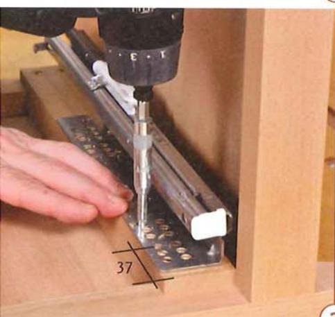
2 > Richten Sie den Auszug genau bündig zur oberen Leistenkante aus. Der Abstand vom vorderen Leistenende bis zum dritten Loch beträgt 37 mm. Mit einem Zentrierbohrer können Sie nun Schraubenlöcher vorbohren, die sich automatisch mittig im Befestigungsloch befinden.
