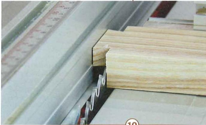
10 > Der innere Laufrahmen für die Schubladen besteht aus zwei T-förmig angeordneten Hölzern (Pos. 3 und 4) je über und unter der Schublade. Sie werden untereinander sowie mit den umlaufenden Traversen mit Schwalben verbunden werden. Die Schwalben selbst werden auf dem Frästisch erstellt und auf der Tischkreissäge auf 10 mm abgesetzt.
