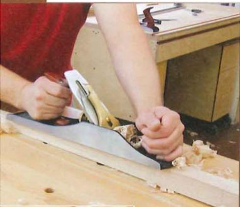
17 > Das Abschrägen selbst erfolgt mit dem Handhobel. Das geht schnell, man erspart sich den Bau von Vorrichtungen und vor allem arbeiten Sie sehr kontrolliert. Die Gefahr, das Werkstück hierbei zu beschädigen oder gar zu zerstören ist sehr gering. Schrägen Sie die Beine nur an den beiden nach innen weisenden Seiten.
