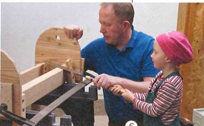
6 > Die Japansäge schneidet die Beine bündig mit den Seiten (dem Winkelverlauf folgend) schräg. Zum Glätten des Hirnholzes eignet sich ein Bandschleifer.
