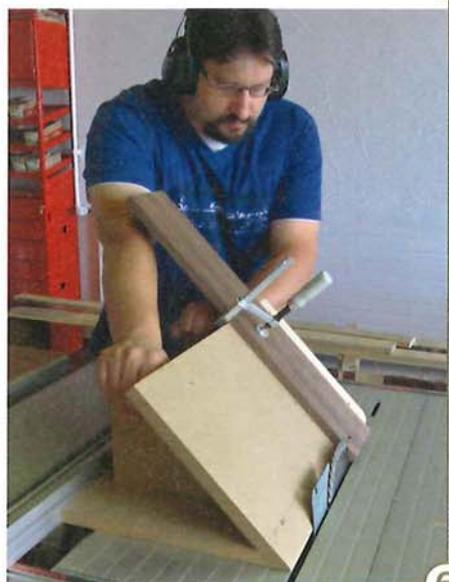
6 > Das Werkstück wird durch die Rampe auf 45° zur Tischoberfläche angehoben. Durch Neigen des Sägeblattes können nun Winkel jenseits von 45° problemlos geschnitten werden. Die Vorrichtung wird samt aufgespanntem Werkstück am Parallelanschlag entlang geführt. Sie selbst können weit außerhalb des Gefahrenbereiches stehen, die Hände sind weit vom Sägeblatt entfernt.
