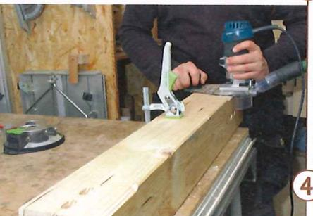
4 > Die zwischen den Zargen liegende Kante erhält eine ausgeprägte 45°-Fase. Die Fläche der Fase sollte groß genug sein, um den Bohrer gut ansetzen zu können.
