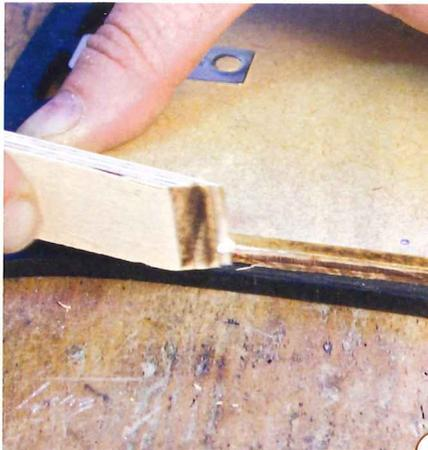
**9** > Haben Sie den ausgetretenen Leim mit einem Keil oder Spachtel entfernt, können Sie die Kanten der Rückwand brechen (Schleifpapier) und die Seiten sowie die Rückwand beizen (letzteres ist optional).
