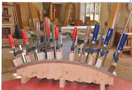
Dazu gehört dieser Zwingenigel, mit dem Misslinger die Querstücke der Glastür schichtverleimt.
