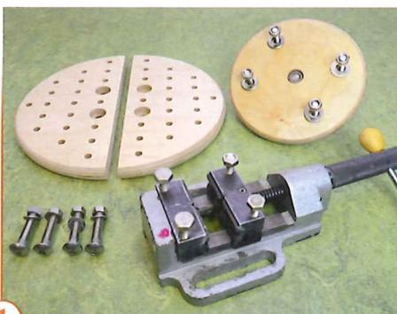
1> Es eignet sich ein Maschinenschraubstock mit mindestens 60 mm Backenbreite. Außerdem müssen die Backen dick genug sein, damit sich die vier Gewindebohrungen (mindestens M8) einschneiden lassen und eine ordentliche Auflagefläche für die Tellerhälften gegeben ist.
