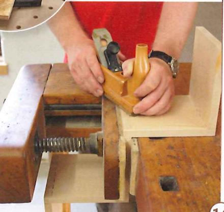
14 > Nun können Sie mit dem Putzhobel die Zinkenüberstände putzen. Dabei arbeitet man von außen bis zur Mitte mit leicht schräg gehaltenem Hobel. Schleifen Sie alle Teile mit feinem Schleifpapier (mehrmals, bis 180er Korn), wässern Sie sie und schleifen Sie nach dem Trocknen noch einmal fein über.
