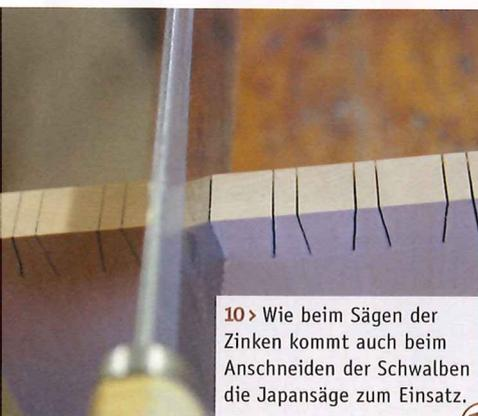
10 > Wie beim Sägen der Zinken kommt auch beim Anschneiden der Schwalben die Japansäge zum Einsatz.
