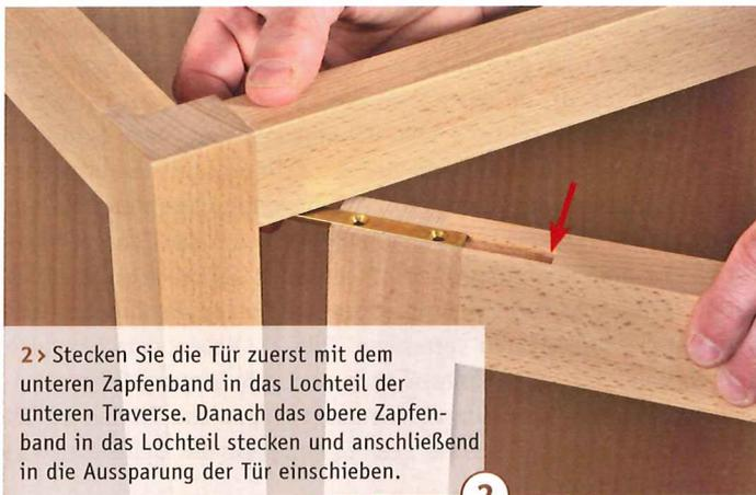
2 > Stecken Sie die Tür zuerst mit dem unteren Zapfenband in das Lochteil der unteren Traverse. Danach das obere Zapfenband in das Lochteil stecken und anschließend in die Aussparung der Tür einschieben.
