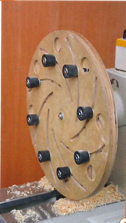
**1** Das Longworth-Futter ist aufgespannt, nun kann es losgehen. Normalerweise dient es dazu, fast fertige Schalen für deren Fußpflege einzuspannen. Doch auch für das Drechseln und Bohren eines Hockersitzes ist es gut geeignet. Der Rohling ist schon vorab kreisrund gesägt, gefräst oder gedrechselt.
