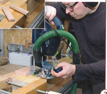
3 > Mit einem Hilfsanschlag gelangen die Serienfräsungen für die Domino-Dübel sehr gut. Der Hilfsanschlag wird mit einer Zwinde befestigt.
