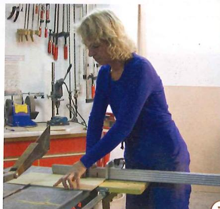
7 > Sägen Sie nun die Rückwände (Sperrholz oder Hartfaser) und Abstandsleisten (aus Sperrholz) zu. Die Größe der Rückwände ergibt sich aus der Größe des zu rahmenden Motivs plus 3 mm Luft in der Breite plus Distanzstreifen (siehe Holzliste).
