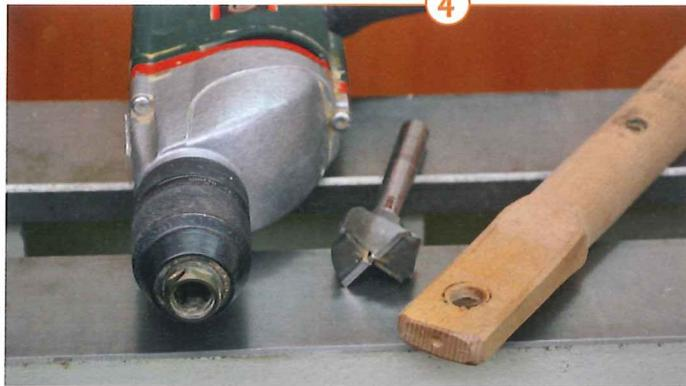
**4** Das sind die Einzelteile einer einfachen Bohrvorrichtung: Bohrmaschine, Forstnerbohrer und eine Hartholzleiste. Sie ist unten passend für die Auflage im Handauflagen-Unterteil gedrechselt. Oben hat sie eine Bohrung, die dem Schaftdurchmesser des Bohrers entspricht. Der Trick ist, dass der Bohrer nicht im schneidenden Bereich geführt wird, sondern am Schaft. So lässt sich viel exakter arbeiten.
