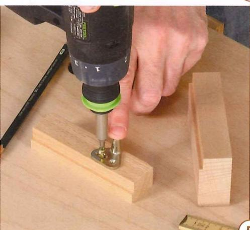
5 > Anschließend wird der Schließbolzen zunächst nur mit einer Schraube im Langloch des Bolzens befestigt. Durch das Langloch können Sie den Bolzen später noch ein wenig verschieben und passend zum Schließhaken ausrichten.
