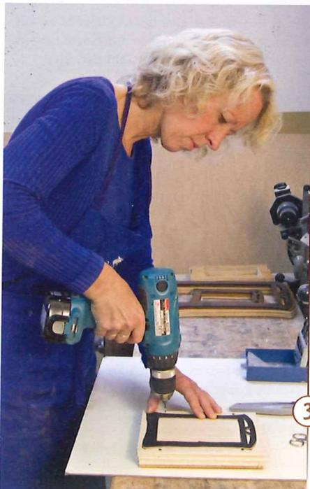
3 > Bohren Sie 4-mm-Löcher in die Ausschnitte, um das Dekupiersägeblatt dort einzufädeln. Wenn Sie am Rand der auszusägenden Fläche bohren, können die abfallenden inneren Ausschnitte das Ausgangsmaterial für kleinere Rahmen sein.
