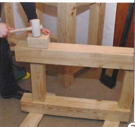
7 > Bei der Montage wird abschnittsweise vorgegangen. Die Teile werden ohne Leim miteinander verbunden und mit langen Zwingen oder Gurten verpresst.
