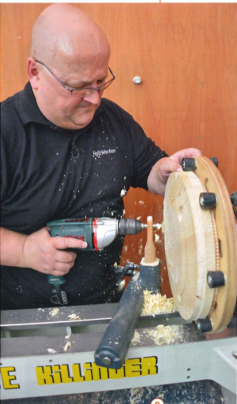
9 > Steuern Sie dann die zwei weiteren Bohrpunkt an. Diese legen Sie entweder per Anriss fest oder finden sie mit der Teileinrichtung Ihrer Drechselbank.
