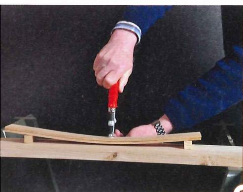
1 > Die Schichtverleimung von zwei 12-mm-Eiche-Streifen für die Rückenlehne geschieht mit Hilfe zweier zwei Zentimeter dicken Klötze. Die Durchbiegung stellt sich nach dem Aushärten des Leims und dem Entfernen der Zwinge auf etwa 1,5 Zentimeter zurück.
