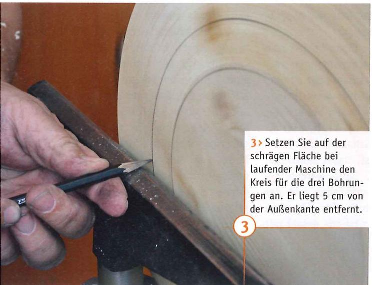
**3** Setzen Sie auf der schrägen Fläche bei laufender Maschine den Kreis für die drei Bohrungen an. Er liegt 5 cm von der Außenkante entfernt.
