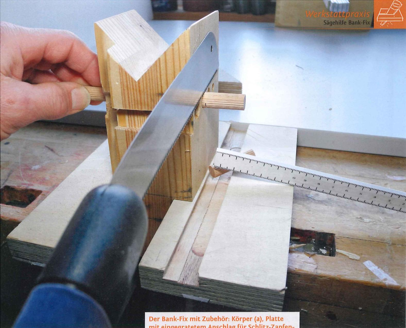
Der Bank-Fix mit Zubehör: Körper (a), Platte mit eingegratetem Anschlag für Schlitz-Zapfenverbindungen, rechts im Bild (b), Tiefenanschlag (c), Schwenkanschlag (d), Gehrungsanschlag für größere Werkstücke (e).
