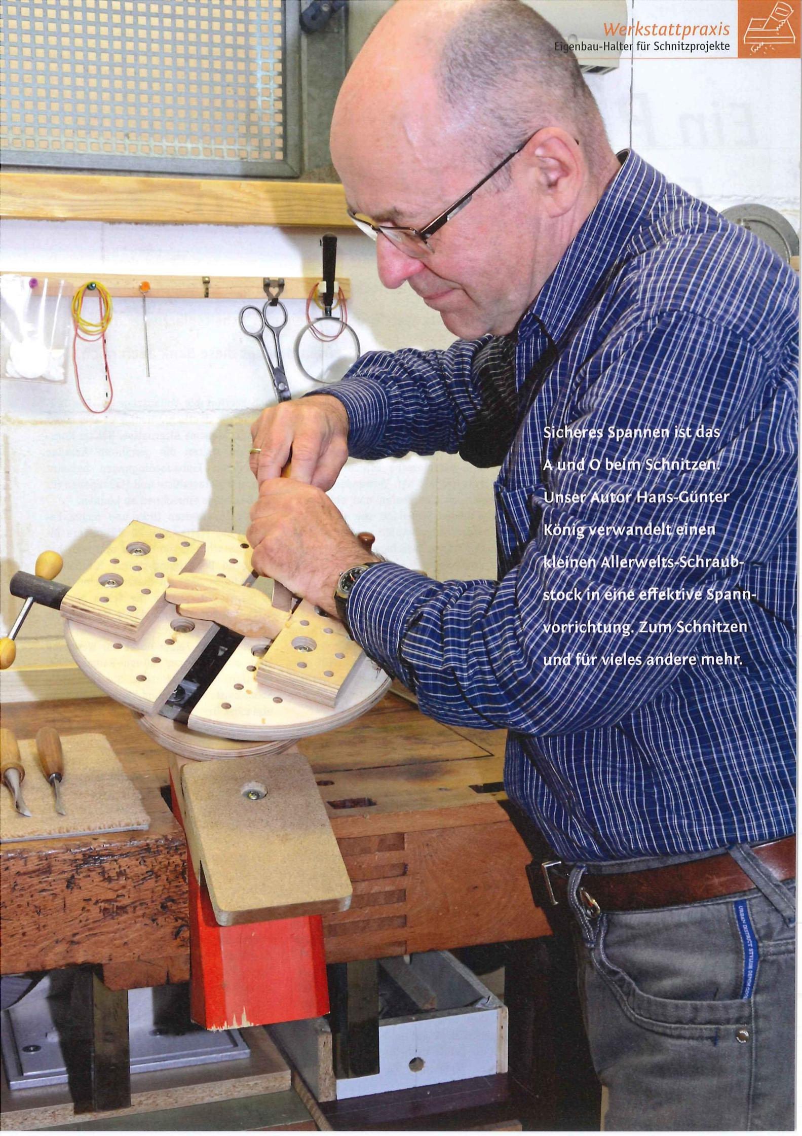
Sicheres Spannen ist das A und O beim Schnitzen. Unser Autor Hans-Günter König verwandelt einen kleinen Allerwelts-Schraubstock in eine effektive Spannvorrichtung. Zum Schnitzen und für vieles andere mehr.
