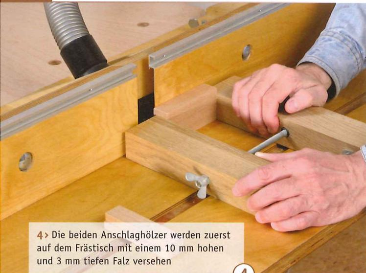
4 > Die beiden Anschlaghölzer werden zuerst auf dem Frästisch mit einem 10 mm hohen und 3 mm tiefen Falz versehen
