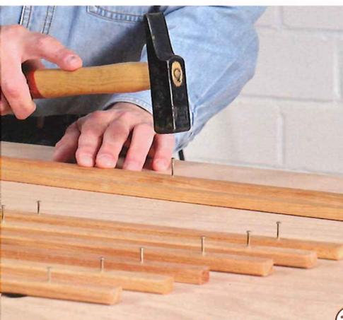
15 > Schlagen Sie im nächsten Schritt schon mal alle Rundkopfstifte (1,8 x 20 mm) in die Bohrungen. Das erleichtert später die Montage der Leisten ungemein und verhindert wirkungsvoll, dass die Nägel krumm geschlagen werden.
