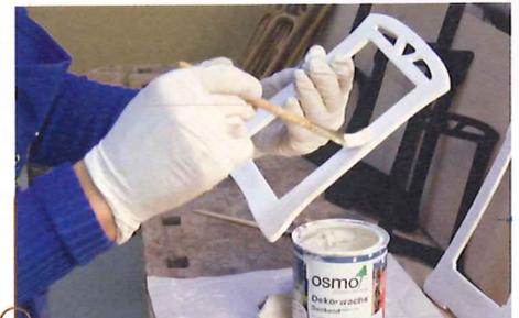
Dieser Rahmen hat eine lasierte Oberfläche mit Dekorwachs. Durch Abreiben mit einem Lappen nach dem Pinselauftrag entsteht der etwas durchscheinende Lasureffekt.
