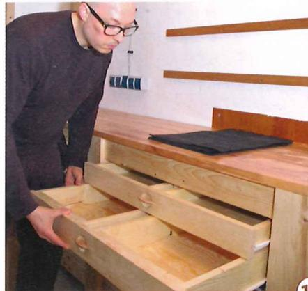
14 > Ein besonderer Kniff ist die Konstruktion der Schubkästen: Hinter einer Front verbergen sich zwei Schubkästen. So werden doppelt so viele Führungen verbaut, was die Doppel-Schubkästen sehr viel mehr tragen lässt als ein einzelner breiter. Übersichtlich bleibt trotzdem alles.
