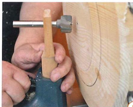
**5** Die Hartholzleiste wird eingespannt und der bereits eingesteckte 25-mm-Bohrer auf Höhe der Drehachse eingerichtet.
