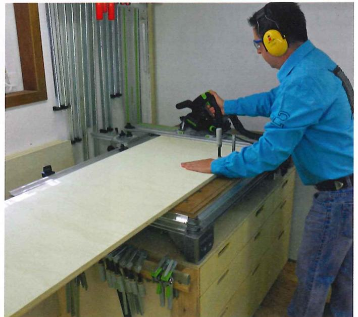
Zum Ablängen großer Werkstücke kann der Schrank ganz leicht links oder rechts positioniert werden.
