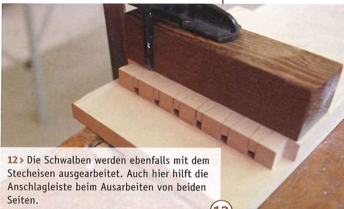
12 > Die Schwalben werden ebenfalls mit dem Stechisen ausgearbeitet. Auch hier hilft die Anschlagleiste beim Ausarbeiten von beiden Seiten.
