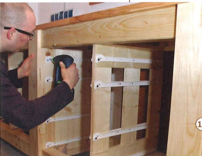
12 > An die Seitenwände und die Zwischenwände (hier als Rahmen ausgeführt) werden die Schubkastenführungen geschraubt.
