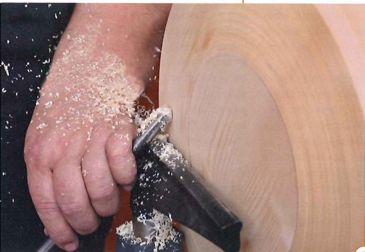
**2** Nach dem Plandrechseln wird der äußere Bereich der Unterseite schräg angelegt. Das wirkt leichter und die Bohrung kann später im rechten Winkel zur Schräge angesetzt werden. Zeichnen Sie so an: Die 8:1-Schräge wird an der Kante einen Zentimeter hoch und ragt acht Zentimeter in die Fläche. Das ergibt eine Schräge von etwa 7,5°. Entfernen Sie den Überschuss und drechseln Sie die flache Kegelfläche glatt. Die Drehzahl liegt bei nur etwa 450 U/min.
