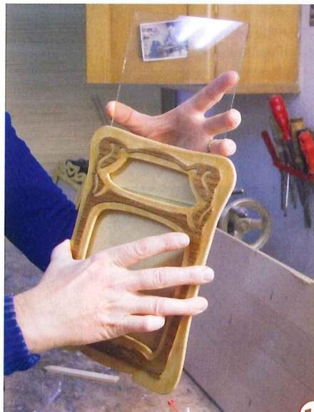
**12** > Fertig ist der Rahmen. Glasscheibe und Bild werden jetzt von oben in den Rahmen geschoben und können jederzeit ohne Aufwand ausgewechselt werden.
