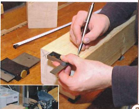
2 > Die Positionen der Dübel werden bei den Tischfüßen und Zargen angerissen. Eine Probefräsung an einem Abfallstück ist immer empfehlenswert.
