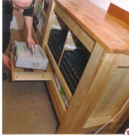
13 > Je nach Bedarf können unterschiedliche Träger gebaut werden. Für die gängigen Werkzeugkoffer eignen sich so genannte Tablarauszüge – einfache Böden (hier auch als Rahmen ausgeführt) mit einer Frontleiste. Passend gesetzte Dübel in den Böden halten die Koffer immer perfekt am Platz.
