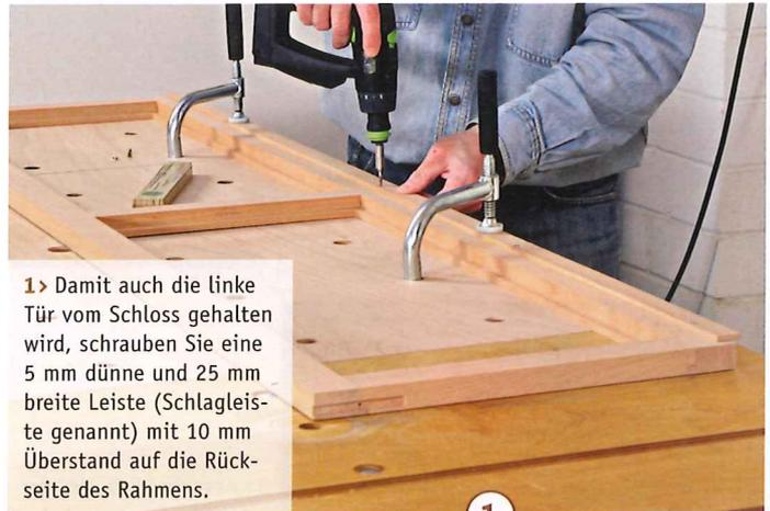
1 > Damit auch die linke Tür vom Schloss gehalten wird, schrauben Sie eine 5 mm dünne und 25 mm breite Leiste (Schlagleiste genannt) mit 10 mm Überstand auf die Rückseite des Rahmens.
