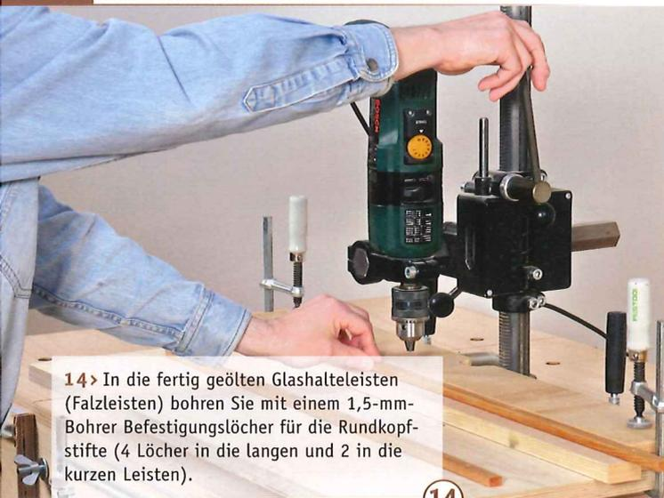
14 > In die fertig geölten Glashalteleisten (Falzleisten) bohren Sie mit einem 1,5-mm-Bohrer Befestigungslöcher für die Rundkopfstifte (4 Löcher in die langen und 2 in die kurzen Leisten).
