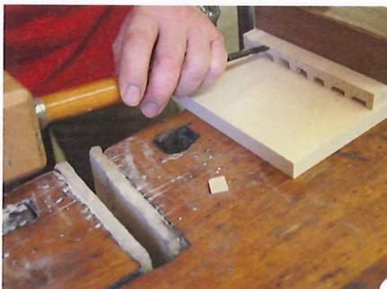
8 > Die Zinkenzwischenräume werden mit dem Stechisen ausgearbeitet. Eine am Zinkengrund (Holzdicke + 0,5 mm) aufgespannte Leiste erleichtert das Einhalten der Zinkengrundlinie. Damit es nicht zu Ausrissen kommt, wird von beiden Seiten bis zur Mitte gearbeitet.
