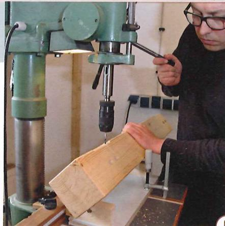
5 > Entsprechend der Schraubengröße wird auf den Flächen vorgebohrt. Eine Hilfskonstruktion hält das Tischbein in Position.
