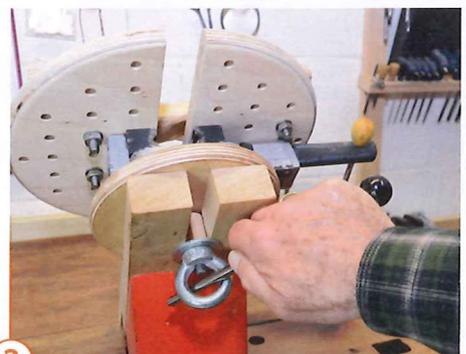
3> Der Schnitzteller – befestigt an einem Schnitzwinkel – im praktischen Einsatz: Eine spürbare Arbeiterleichterung! Nur zum endgültigen Fertigschnitzen muss das Werkstück noch in der Hand gehalten werden. Gespannt wird hier mit einer Ringschraube und einem Hebel aus Rundstahl.
