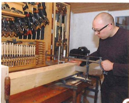
1 > Mit einer großen Gehrungssäge lassen sich schöne und präzise Schnitte bewerkstelligen. Alternativ kann bei diesen Abmessungen möglicherweise der örtliche Zimmermann aushelfen.
