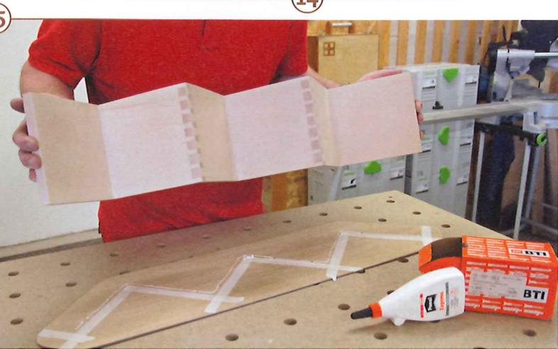
15 > Die Rückwand aus furniertem 6-mm-Sperrholz wird mit Leim und Schrauben am Treppenregal befestigt. Sie hält das Regal in Form und dient zur Befestigung an der Wand. Nun können Sie Öl und Wachs auftragen und einen guten Platz aussuchen.
