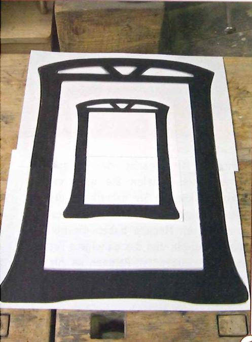
1 > Die aus Karton mit dem Cutter und der Schere geschnittene Schablone wurde von Postkartenformat DIN A6 mit dem Kopierer um 200 % vergrößert auf DIN A 4.
