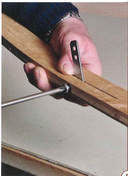
5 > Die fertig geformte und geschliffene Armlehne (siehe Zeichnung) hat bereits auf ihrer Unterseite (hier oben) ihren markanten Schlitz. In ihm wird das kurze Scharnierblech mit Hilfe einer Maschinenschraube drehbar gelagert. Diese wird direkt ins (vorgebohrte) Schichtholz der Armlehne geschraubt.
