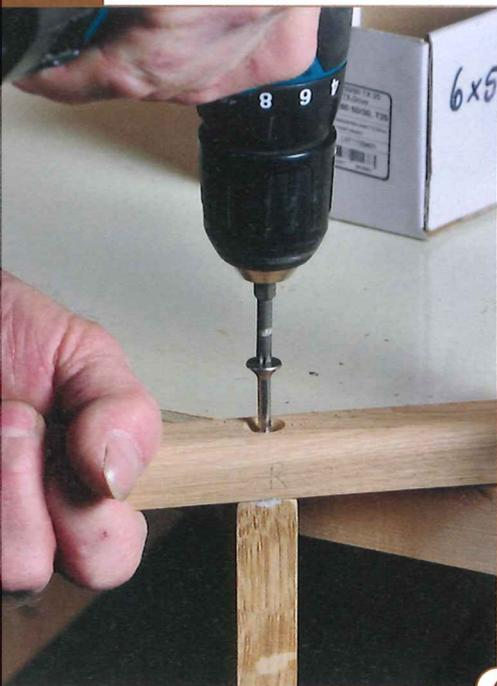
4 > Ist der Leim trocken, wird die Verbindung durchbohrt und mit einer 6 x 50-Holzschraube versehen. Diese sorgt für die Tragkraft der Verbindung, der Leim hilft nur gegen das lästige Verrutschen der Teile.
