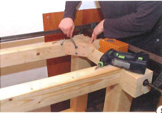
8 > Statt mit Leim werden Zargen und Bein oben und unten mit Eckklötzchen gesichert. Spanplatten-schrauben (4,5 x 80 mm) werden in die Zargen gedreht und je zwei Schlüsselschrauben (Sechskant-schrauben 6 x 120) diagonal ins Tischbein.
