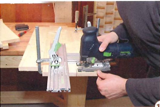
10 > Zwischen die Tischfüße werden außen Seitenplatten eingeschraubt. Diese müssen zuvor ausgeklinkt werden, damit sie zwischen die Eckklötzchen passen. Hier ist es das Maß 107 x 40 mm; messen Sie aber an Ihrer Bank.
