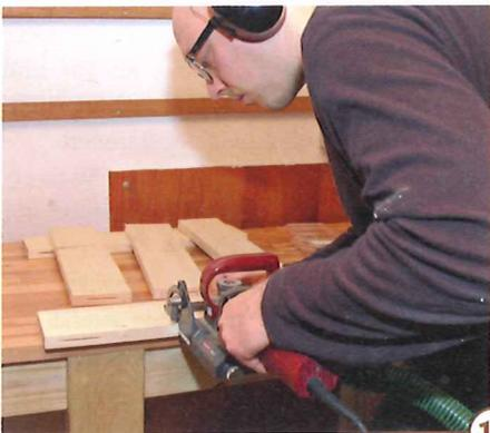
11 > Die Zwischenwände können aus durchgehenden Platten hergestellt werden. Hier wählte ich stattdessen Rahmen aus (vorhandenen), zuvor zusammengefügt Brettern.
