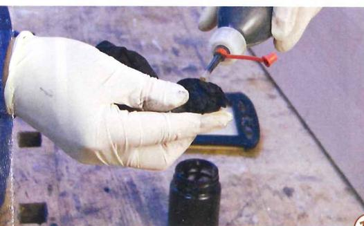
**10** > Wenn Sie eine besonders edle Oberfläche wollen, können Sie den Rahmen zuerst mit Streichschellack oder Schellack „Sanding Sealer“ einpinseln und fein zwischen-schleifen.
