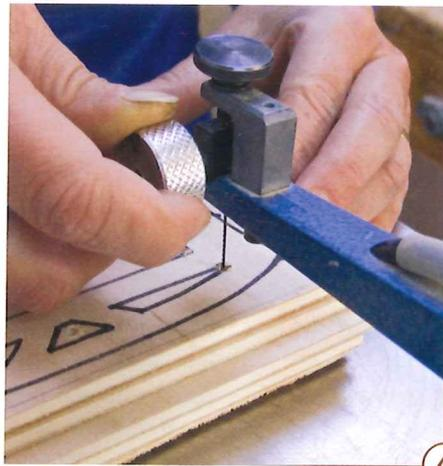
4 > Es empfiehlt sich, Schnellspannbacken zu verwenden, da Sie sonst die meiste Zeit mit Ein- und Ausspannen des Sägeblattes verbringen. Diese werden von einigen Herstellern angeboten.
