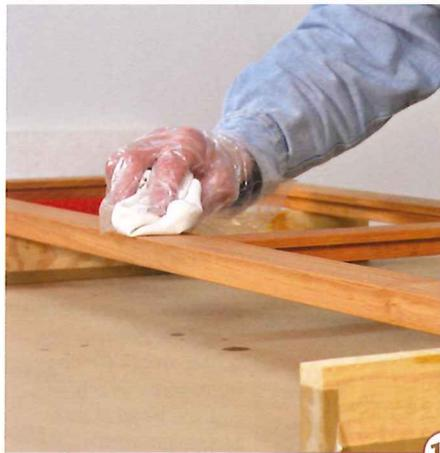
10 > Nach etwa 15 Minuten das nicht eingezogene Öl sorgfältig mit einem Pinsel oder Lappen vertreiben bzw. abreiben. Keinerlei Ölpfützen, Überschüsse oder Abläufer (Ölnasen) antrocknen lassen. Wichtig: Mit Öl getränkte Lappen wegen Selbstentzündungsgefahr in luftdicht verschlossenem Blech- oder Glasgefäß lagern.
