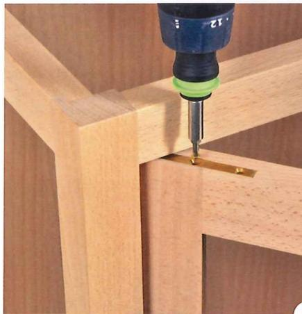
3 > Zum Schluss das Zapfenband bei geöffneter Tür in der Aussparung mit zwei 3-x-20-mm-Senkkopfschrauben befestigen. Zum Aushängen der Tür einfach in umgekehrter Reihenfolge vorgehen und dabei die Tür immer gut mit einer Hand festhalten.
