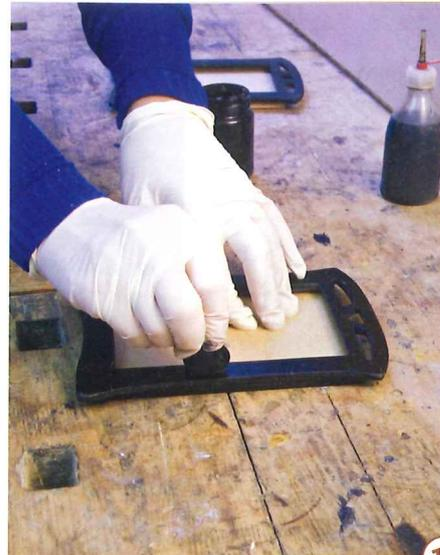
**11** > Anschließend polieren Sie mit einem Ballen und durch Spiritusbeize schwarz gefärbtem Schellack (wie in HolzWerken 08 beschrieben).
