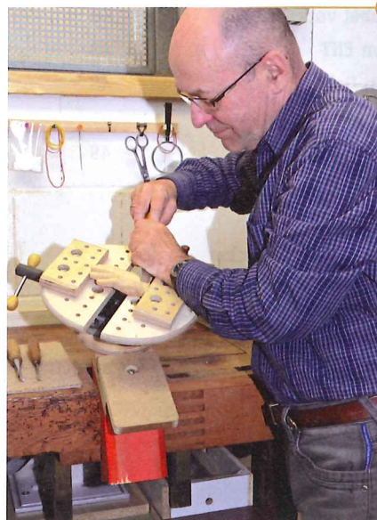
Schnitzen ohne Kreuzschmerzen: Am variablen Schnitzsteller in komfortabler Höhe spannen und arbeiten.
