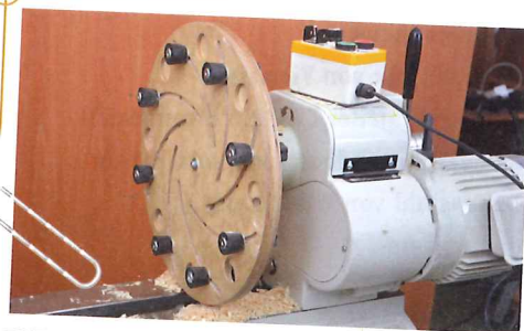
Futter für Drechsler: Mit dem Longworth-Futter können Sie nicht nur Löcher für schräge Hockerbeine bohren.
