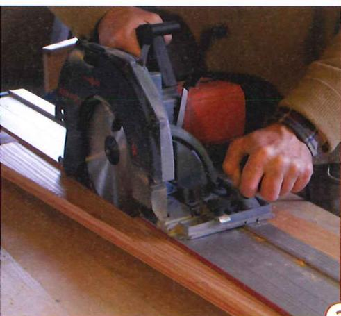
2 > Die Schräge an den beiden Seiten lässt sich mit Handkreissäge und Schiene am einfachsten zuschneiden.
