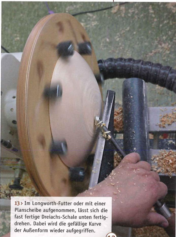
13 > Im Longworth-Futter oder mit einer Planscheibe aufgenommen, lässt sich die fast fertige Dreiachs-Schale unten fertigdrehen. Dabei wird die gefällige Kurve der Außenform wieder aufgegriffen.
