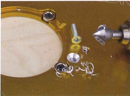
5 > Anschließend wird von der Oberseite der Einlegeplatte weiter gearbeitet. Mit einem HSS- oder Hartmetall-Senker wird Platz für den Schraubenkopf gemacht. Die Befestigungsschrauben dürfen auf keinen Fall über die Fläche der Einlegeplatte überstehen – sonst bleibt später das Werkstück daran hängen.
