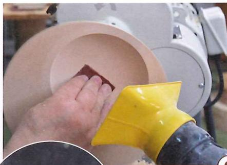
6 > Die fertig ausgeformte Innenschale kann nun bereits bis Körnung 240 (auf Wunsch auch höher) geschliffen werden. Wie immer bei exzentrisch gespannten Werkstücken ist besondere Vorsicht geboten, damit Hand oder Arm nicht in den Flugkreis geraten.
