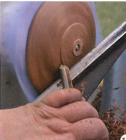
19 > Drechseln Sie die obere Form des Deckels. Wie gesagt: Hier ist es Hirnholz, daher die Bearbeitungsrichtung von außen nach innen. Außen können Sie die Wandstärke noch erfüllen, in der Mitte geht es ans Rechnen. Wenn Sie (bei einer Hohlungstiefe von 15 mm unten) auf 20 mm auskommen, haben Sie eine perfekte Deckel-Dicke von 5 mm.
