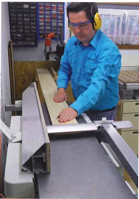
Der Weg des Werkstückes über die Abrichte darf nirgendwo gestört werden: Wichtig unter anderem bei der Höhenfestlegung für den Bohrmaschinentisch (im Hintergrund).
