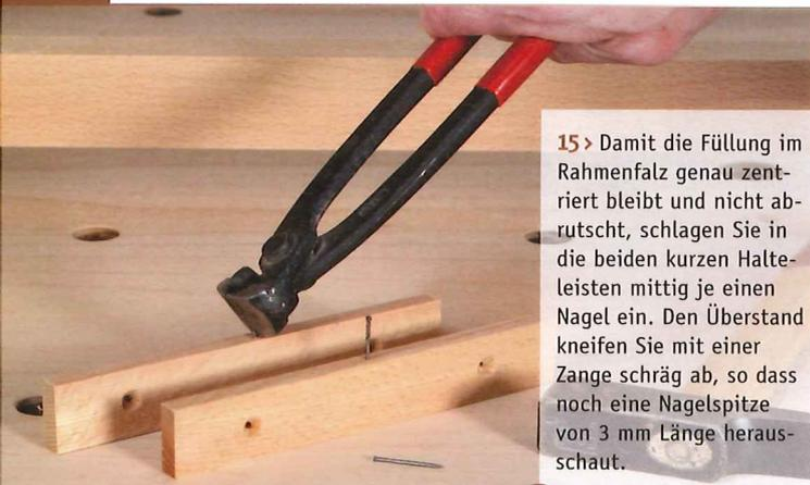
15 > Damit die Füllung im Rahmenfalz genau zentriert bleibt und nicht abrutscht, schlagen Sie in die beiden kurzen Halteleisten mittig je einen Nagel ein. Den Überstand kneifen Sie mit einer Zange schräg ab, so dass noch eine Nagelspitze von 3 mm Länge heraus-schaut.
