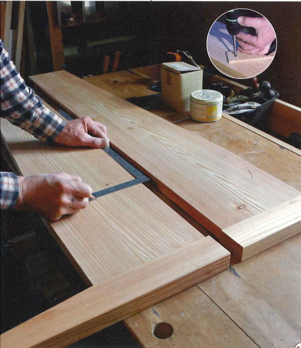
**17** > Die Positionen der Schrauben werden sorgfältig angerissen. Wenn Sie keine große Ständerbohrmaschine haben und sich vor Ausriss schützen wollen, können Sie eine Schablone aufspannen.
