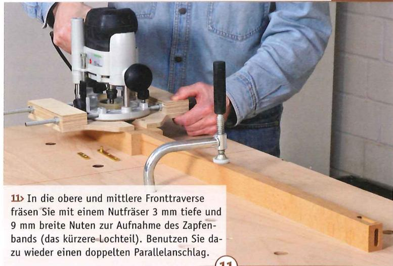
11 > In die obere und mittlere Fronttraverse fräsen Sie mit einem Nutfräser 3 mm tiefe und 9 mm breite Nuten zur Aufnahme des Zapfenbands (das kürzere Lochteil). Benutzen Sie dazu wieder einen doppelten Parallelanschlag.
