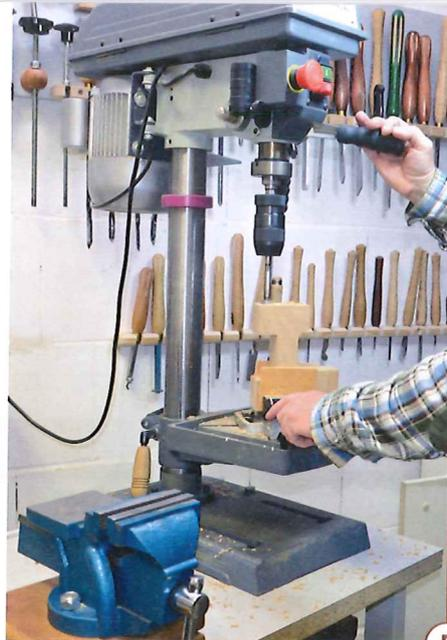
5 > Die recht dünne Drehscheibe, welche die Nadel bewegt, sollte für eine sichere Verbindung mit der Antriebsachse einen Bund erhalten. Für ihn wird mit einem Forstnerbohrer eine passende Grundbohrung eingebracht. In deren Zentrum liegt dann die Bohrung, durch die die Antriebswelle verläuft. Für die Welle muss auch an der anderen Seite des Korpus gebohrt werden. Achten Sie auf eine gute Flucht der Bohrungen.
