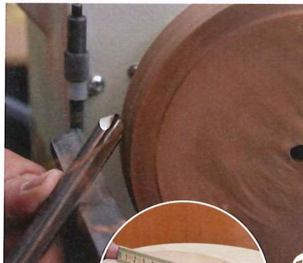
15 > Zunächst geht es an die Deckelunterseite. Messen Sie den Innendurchmesser der Innenschale (kleines Bild) und geben Sie einen Zentimeter dazu. Das ist der Außendurchmesser des Dosendeckels. Danach wird die Deckelunterseite noch plan geschnitten.
