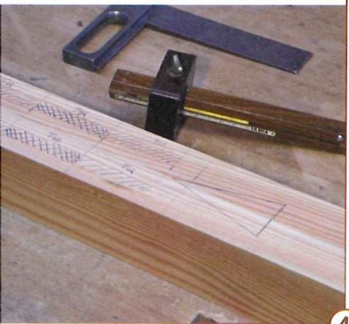
4 > Reißen Sie die Schlitz an den Kufen an. Markieren Sie das Material, das entfernt werden soll. Das Loch für den Mittelzapfen ist 42 mm tief, die Bereiche für den Nutzapfen sind 12 mm tief.
