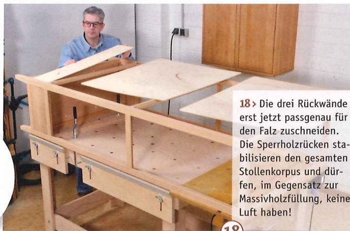
18 > Die drei Rückwände erst jetzt passgenau für den Falz zuschneiden. Die Sperrholzrücken stabilisieren den gesamten Stollenkorpus und dürfen, im Gegensatz zur Massivholzfüllung, keine Luft haben!
