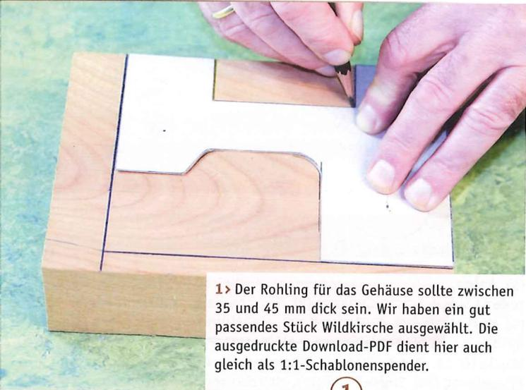
1 > Der Rohling für das Gehäuse sollte zwischen 35 und 45 mm dick sein. Wir haben ein gut passendes Stück Wildkirsche ausgewählt. Die ausgedruckte Download-PDF dient hier auch gleich als 1:1-Schablonespender.
