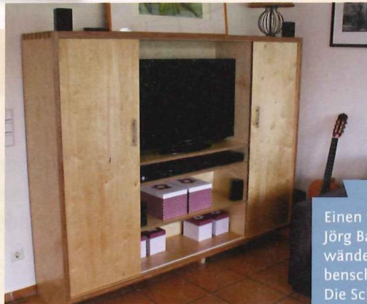
Einen wandelbaren Fernsehschrank baute Jörg Bauer aus Geldern. In die Schrankwände aus Birke-Multiplex hat er Schwalbenschwanzverbindungen eingearbeitet. Die Schiebetüren verdecken entweder den Fernseher oder die Regale in den Seiten.
