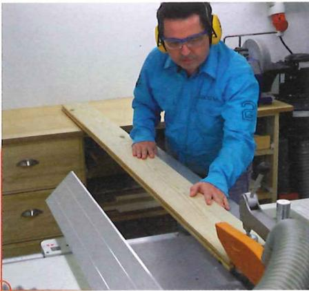
Der Weg des Werkstückes über die Säge oder Tischfräse beginnt hinten auf dem selbst gebauten Schrank. Diese Unterstüztung ist sogar sehr bequem.
