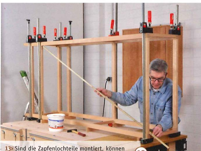
13 > Sind die Zapfenlochteile montiert, können Sie die Seitenrahmen mit den Front- und Rücktraversen verleimen. Achten Sie darauf, die Zwingen genau senkrecht im Verlauf der Zargen anzusetzen, dann ist das Stollengestell auch rechtwinklig. Trotzdem mit dem Stichmaß nochmals überprüfen! Das Ganze am besten über Nacht trocknen lassen.
