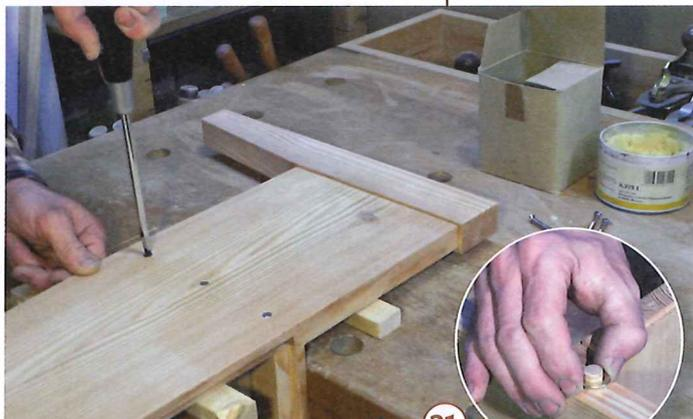
21 > Schrauben Sie den Korpus probehalber zusammen und setzen Sie die Klappe vorsichtig ein. Legen Sie je eine dünne Unterscheibe auf den Dorn. Sie sorgt für den nötigen Abstand zum Korpus.
