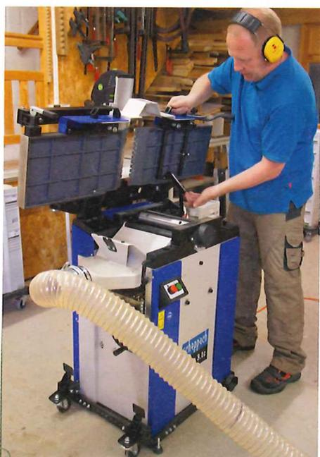
Die über Federkraft leicht zu betätigenden Abrichttische bewegen sich gemeinsam und können nach dem Lösen der Arretierung einfach bewegt werden. Für den Abrichtbetrieb muss der Tisch arretiert werden.
