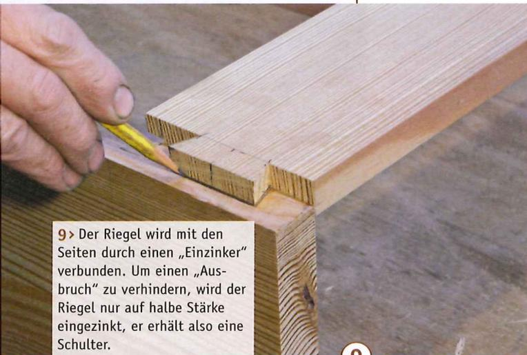
9 > Der Riegel wird mit den Seiten durch einen „Einzinker“ verbunden. Um einen „Ausbruch“ zu verhindern, wird der Riegel nur auf halbe Stärke eingezinkt, er erhält also eine Schulter.
