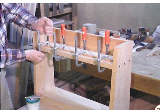
22 > Die Klappe erhält einen Anschlag. An der Unterseite des oberen Bodens wird hierfür eine dünne Leiste aufgeleimt. Die Vorderkante des oberen Bodens wird nach dem probeweisen Zusammenbau passend zu den Seiten schräg gehobelt.
