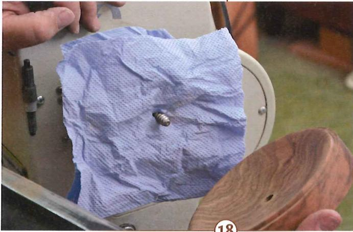
18 > Mit einigen Lagen weichen Tuchs als Puffer gegen Druckstellen spannen Sie den Deckel nun um. Er wird wiederum durch das Schraubenfutter gehalten.
