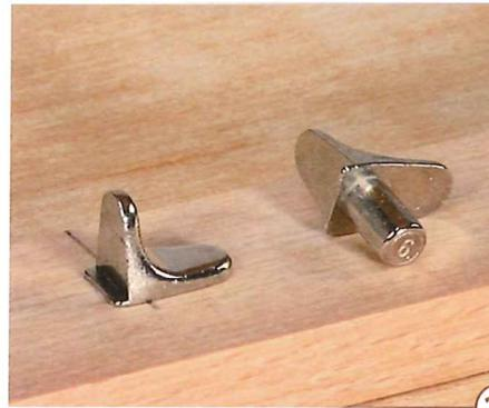
21 > Benutzen Sie als Bodenträger nur solche, die über einen Stützwinkel verfügen. Diese Lasche unterhalb des 5-mm-Rundstifts verleiht dem Bodenträger deutlich mehr Stabilität und Tragkraft als einfache runde Bodenträgerstifte.
