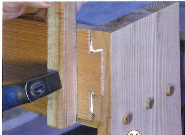
24 > Der obere Riegel, der mit den Seiten durch einen „Einzinker“ verbunden ist, wird mit Zulage vorsichtig eingeschlagen und mit Zwingen fixiert.
