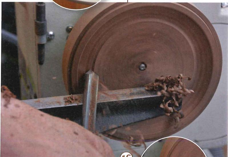
16 > Im nächsten Schritt formen Sie den Falz auf Maß (kleines Bild). Ist die „Anprobe“ auf der Schale zufriedenstellend, folgt das Aushöhlen der Deckelunterseite in einer stimmigen Kurve, 15 Millimeter tief. Sobald in der Mitte die Schraube sichtbar wird, heißt es, vorsichtig an sie herantasten.
