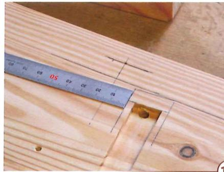
**18** > Ermitteln Sie den Drehpunkt der Klappe. Er liegt (bei 28 mm Klappenstärke) 14 mm unterhalb des mittleren Bodens und 16 mm hinter der Vorderkante der Seiten. Die Klappe soll an der Front um zwei Millimeter zurückspringen.
