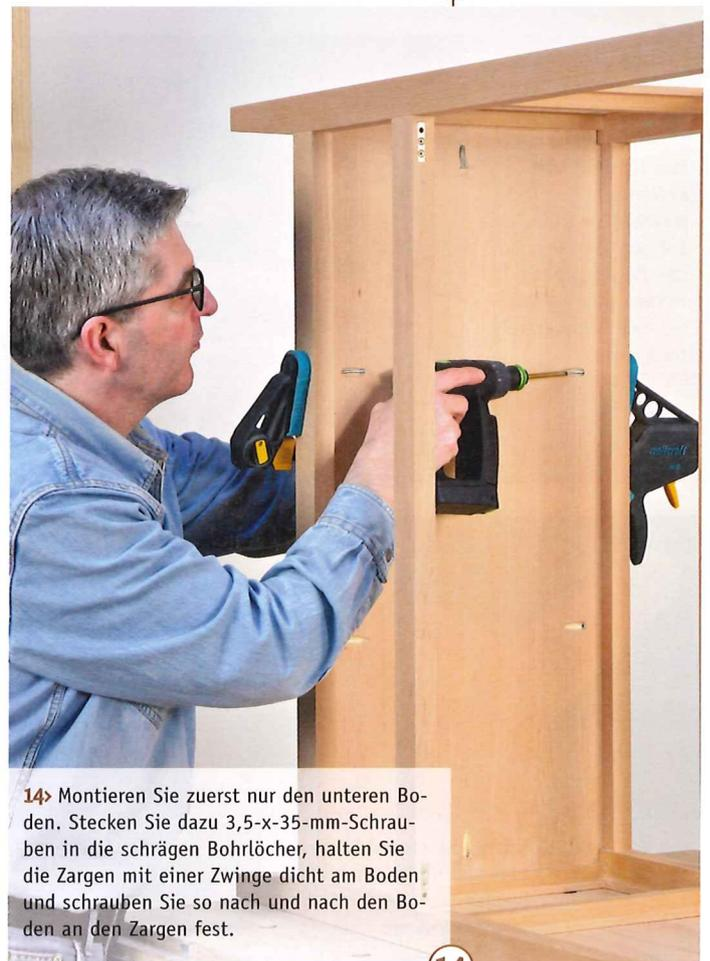
14 > Montieren Sie zuerst nur den unteren Boden. Stecken Sie dazu 3,5-x-35-mm-Schrauben in die schrägen Bohrlöcher, halten Sie die Zargen mit einer Zwinde dicht am Boden und schrauben Sie so nach und nach den Boden an den Zargen fest.
