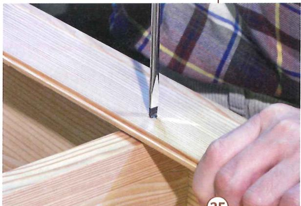
25 > Abschließend wird die Rückwand eingeschraubt. Die Bretter sind untereinander durch eine 4 mm dünne Feder verbunden.
