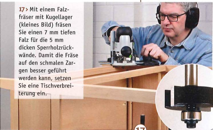
17 > Mit einem Falzfräser mit Kugellager (kleines Bild) fräsen Sie einen 7 mm tiefen Falz für die 5 mm dicken Sperrholzrückwände. Damit die Fräse auf den schmalen Zargen besser geführt werden kann, setzen Sie eine Tischverbreiterung ein.
