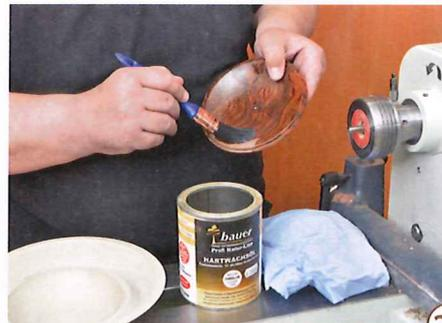
22 > Diese schöne Schale verdient besonderen Einsatz bei der Oberfläche: Hier ist es Hartwachsöl, das 24 Stunden trocknen darf und dann leicht mit einem Scotch-Brite-Schwamm übergeschliffen wird. Danach noch einmal leicht ölen und trocknen lassen. Zum Schluss wird alles auf der Schwabbel-scheibe mit etwas Carnaubawachs aufpoliert.
