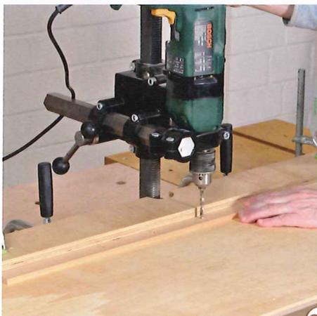
20 > Damit die Einlegeböden in der Höhe verstellbar sind, bohren Sie in die aufrechten Glas-halteleisten durchgehende 5-mm-Löcher für die Bodenträger. Die Positionen der Löcher können Sie natürlich frei wählen. Sie richten sich in erster Linie nach den Dingen, die Sie in der Vitrine präsentieren möchten.
