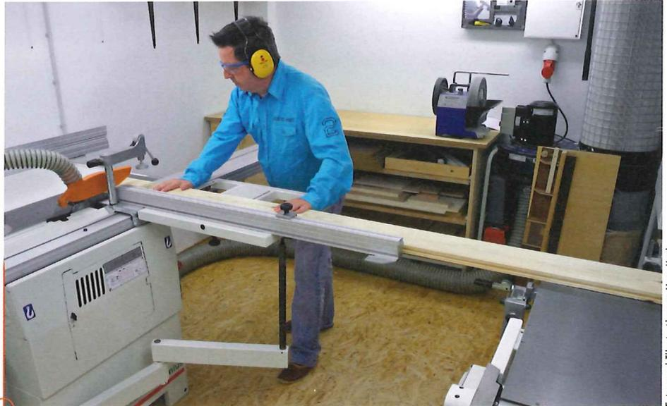
Beim Sägen oder Fräsen am Kopfende des Bretts streicht das Werkstück hauchknapp über den Tisch der Abrichte (rechts im Bild).
