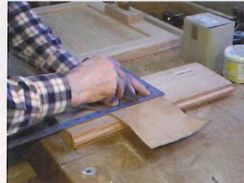
Schneiden Sie das Leder auf 94 x 60 Millimeter zu. Beide Enden werden mit dem Hobel leicht angefast, damit sie sich leichter ins Holz stecken lassen.
