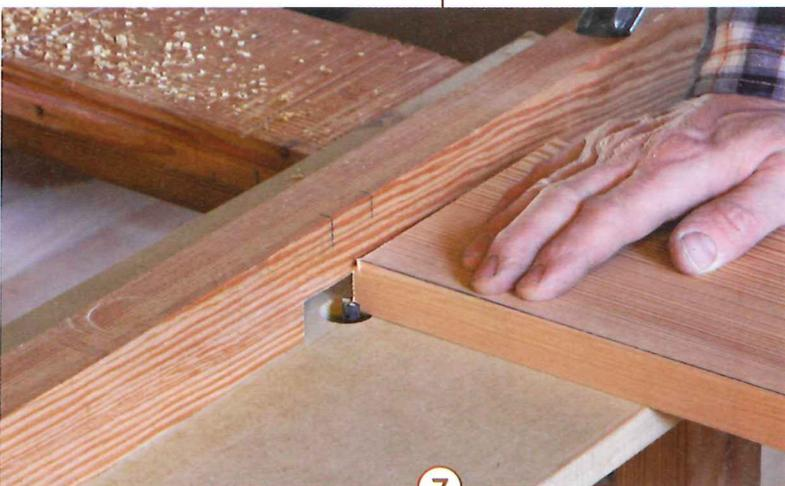
7 > Die drei Zwischenböden bekommen an den Köpfen je einen kleinen Falz. Wichtig: Dieser Falz sollte einen halben Millimeter kürzer sein als die aufnehmende Nut tief ist, damit die Brüstungen dicht schließen.
