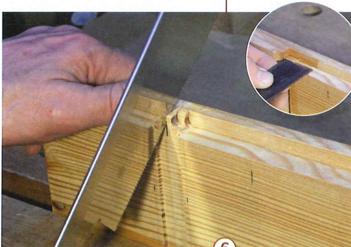
6 > Die Seiten sind hinten gefälzt, um die Rückwand aufnehmen zu können. Dieser Falz läuft jeweils nicht durch. Er muss daher nach dem Einsatzfräsen eckig ausgestemmt werden.
