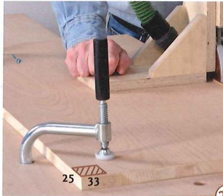
22 > Die überstehenden Kanten werden anschließend mit der Oberfräse und einem Bündigfräser bis zur Plattenfläche abgefräst. Danach werden auch die beiden Schmalkanten mit Umleimern versehen. Zum Schluss werden die hinteren Ecken noch passend zu den Stollen etwas ausgeklinkt (s. Schraffur).
