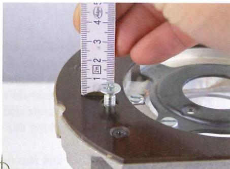
1 > Sie benötigen M5- oder M6-Senkkopfschrauben, um die Maschine an der Einlegeplatte zu befestigen. Die Schrauben müssen so lang sein, dass Sie die vorhandenen Gewinde in ganzer Länge nutzen. Die Materialstärke der Einlegeplatte müssen Sie noch addieren.
