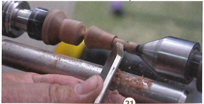
21 > Der letzte Akt ist der Deckelknopf: Nehmen Sie den Rohling zwischen die Spitzen. Ein fertiger Durchmesser von 17 mm und eine Höhe von 20 mm bis zum angedrehten Zapfen sind empfehlenswerte Maße. Den Zapfendurchmesser wählen Sie passend zur Deckel-Bohrung für das Schraubenfutter. Die Zapfenlänge entspricht der Deckeldicke plus drei Millimeter. Der Zapfen steht also im Deckelinneren durch und wird am Ende verrundet.
