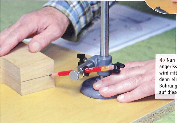
4 > Nun können die Bohrungen angerissen werden. Begonnen wird mit einer Symmetrieachse, denn eine Reihe der nötigen Bohrungen befindet sich genau auf dieser Linie.
