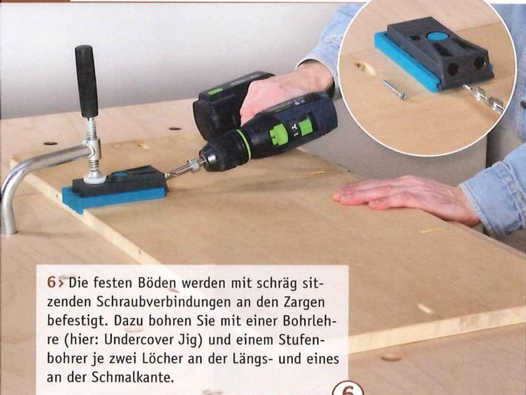
6 > Die festen Böden werden mit schräg sitzenden Schraubverbindungen an den Zargen befestigt. Dazu bohren Sie mit einer Bohrlehre (hier: Undercover Jig) und einem Stufenbohrer je zwei Löcher an der Längs- und eines an der Schmalkante.
