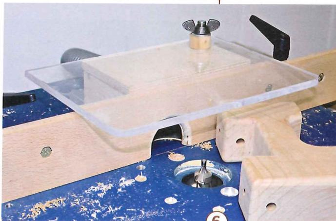
6 > Nun wird der Korpus noch rundum verrundet. Der kleine Fräser mit dünnem Anlaufstift reicht beim Abrunden der Kanten weit in die inneren Ecken und spart viel Nachschleifarbeit von Hand.
