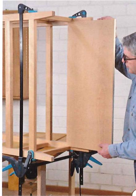
1 > Sägen Sie die beiden festen Böden erst zu, wenn der Korpus probe-weise zusammengesteckt wurde. Für die spätere Stabilität ist es sehr wichtig, dass die Böden in der Länge ohne jegliches Spiel zwischen die beiden seitlichen Zargen passen.
