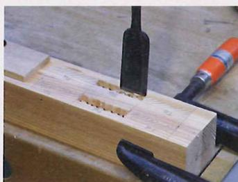
Jetzt wird mit einem breiten und extra scharfen Stecheisen oder einer Stoßaxt das überschüssige Material an den Seiten (Wangen) des Schlitzes abgestochen. In gleicher Abfolge werden dann auch die Schlitzlöcher für den Nutzapfen hergestellt.
