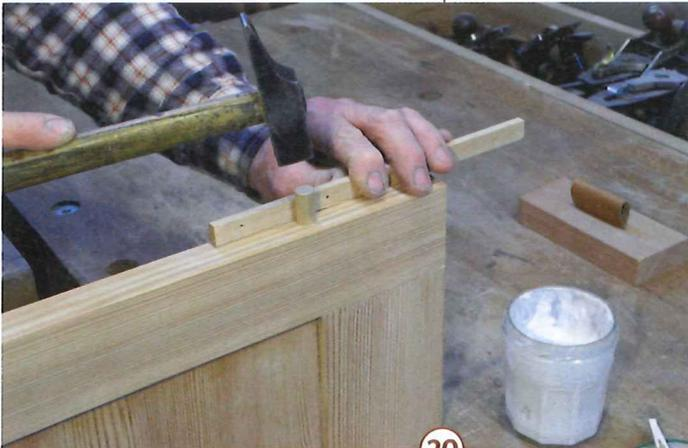
20 > Der Dorn wird an der Klappe mit ein paar Tropfen Leim eingeschlagen. Eine Leiste dient als Tiefenanschlag.
