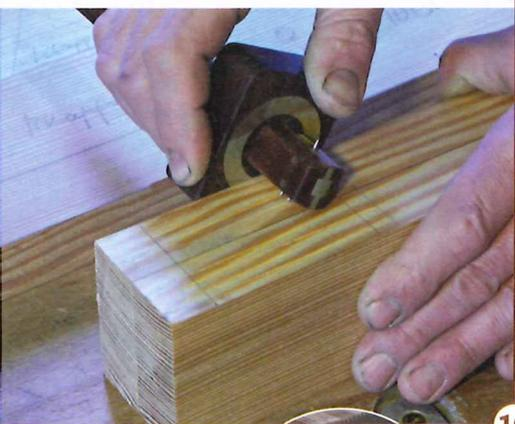
10 > Nun zur Klappe: Die Schlitzte der Doppelzapfen sind mit 6 mm recht schmal. Vor allem zwischen den beiden Zapfen lässt sich nur schwer nacharbeiten. Im Zweifel genügt auch ein einfacher Zapfen.
