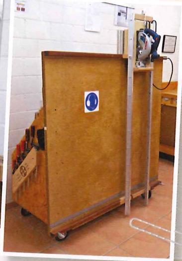
Eine Tischkreissäge hat Philippe Zehnder nicht in seiner Werkstatt. Um dennoch Plattenzuschnitte machen zu können, hat er platzsparend seinen Zwingenwagen zur Plattensäge kombiniert. Mit ihr kann er senkrechte Schnitte im 90°-Winkel in bis zu 120 Zentimeter breiten Werkstücken setzen. Dazu hat er sich einen Schlitten für eine normale Handkreissäge ausgedacht und schneidet mit ihr, wie er schreibt, sicher und exakt.
