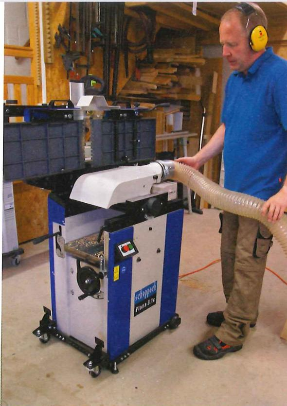
Die große Abrichthaube sorgt bei der Plana 3.1c für eine nahezu vollständige Spanabsaugung sowohl im Abricht- als auch im Dickenhobelbetrieb. Sie ist recht leicht zu bedienen.
