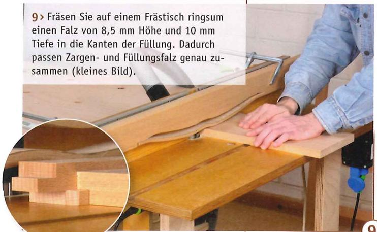
9 > Fräsen Sie auf einem Frästisch ringsum einen Falz von 8,5 mm Höhe und 10 mm Tiefe in die Kanten der Füllung. Dadurch passen Zargen- und Füllungsfalz genau zusammen (kleines Bild).
