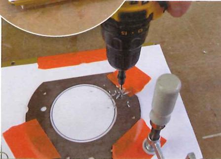
4 > Die Einlegeplatte wird für das Bohren auf der Werkbank festgespannt. Das Bohren erfolgt in mehreren Schritten mit HSS-Bohrern für Metall. Beginnen Sie mit einem Bohrer mit 3 mm Durchmesser. Bohren Sie diese Löcher in Schritten von jeweils einem Millimeter immer weiter auf, bis Sie den Durchmesser der Befestigungsschrauben zuzüglich einem Millimeter erreicht haben. Das alles geschieht immer noch von der Rückseite der Platte aus.
