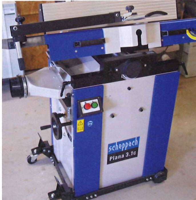
Unterhalb des Abrichttisches befinden sich zwei Arretierungspunkte, durch die sich der Abrichttisch feststellt oder lösen lässt. Die muss man erst einmal finden. Das im Bild zu sehende Roll-Untergestell ist als Zubehör erhältlich.
