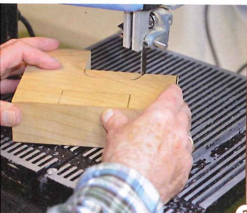
2 > Um Nacharbeit zu sparen, sollten wegen der besseren Schnittgüte die äußeren Schnitte möglichst mit der Kreissäge ausgeführt werden. Die Innenkonturen erfordern eine Bandsäge.
