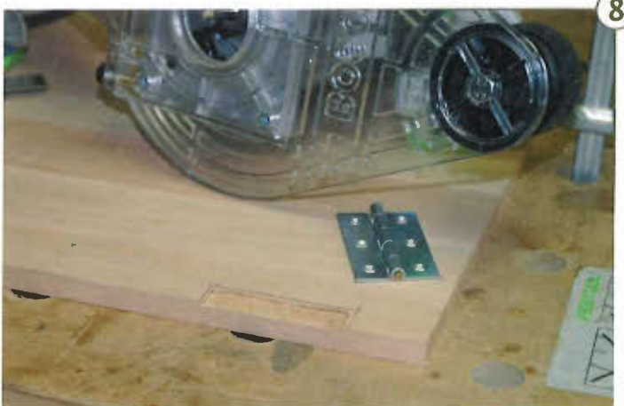
8 > Der restliche Überstand wird an der Markierung abgestochen und über die gefräste Referenzfläche mit aufgelegter Spiegelseite egalisiert.
