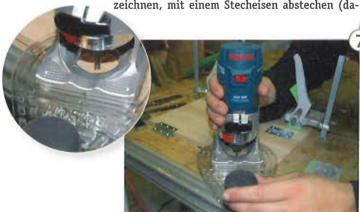
7 > Für die Sichtfräsung ist ein genauer und deutlicher Anriss notwendig. Die Frästiefeneinstellung erfolgt in Scharnierstärke. Durch das geringe Zerspanvolumen lässt sich die Fräse relativ einfach führen. Wichtige Voraussetzung: das Werkstück muss fest gespannt sein!
