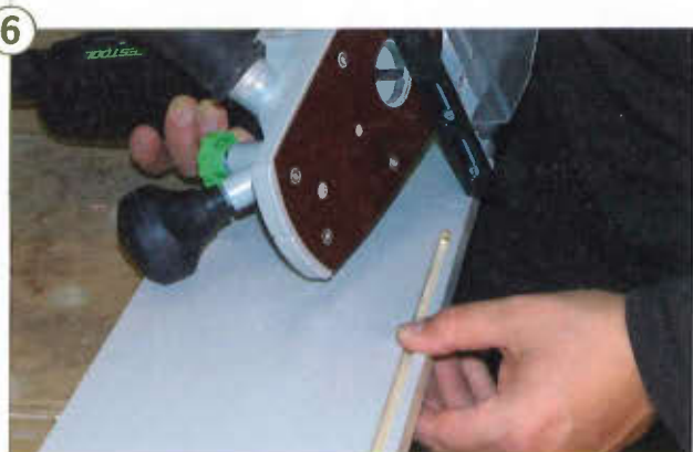
6 > Das Ergebnis kann sich sehen lassen. Schnell, präzise und sauber genutet.
