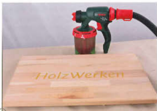
Ein Liter passt in den Farbbehälter des Systems. Man kann sowohl lösemittelhaltige als auch wasserbasierte Flüssigkeiten spritzen.
