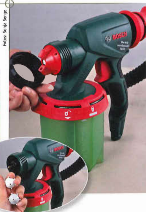
Alle Kunststoffteile sind gut verarbeitet und lassen sich leicht reinigen. Für unterschiedliche Aufgaben gibt es zwei Düsen (kleines Bild).
