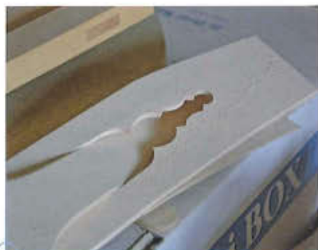
Nach dem Biegen geht der Finger (die schmale Stelle in der Mitte des Verschlusses) durch das Schloss (das verzierte Loch). Der darunter liegende Latz trägt nicht auf, da das Band an den richtigen Stellen ausgedünnt wurde.
