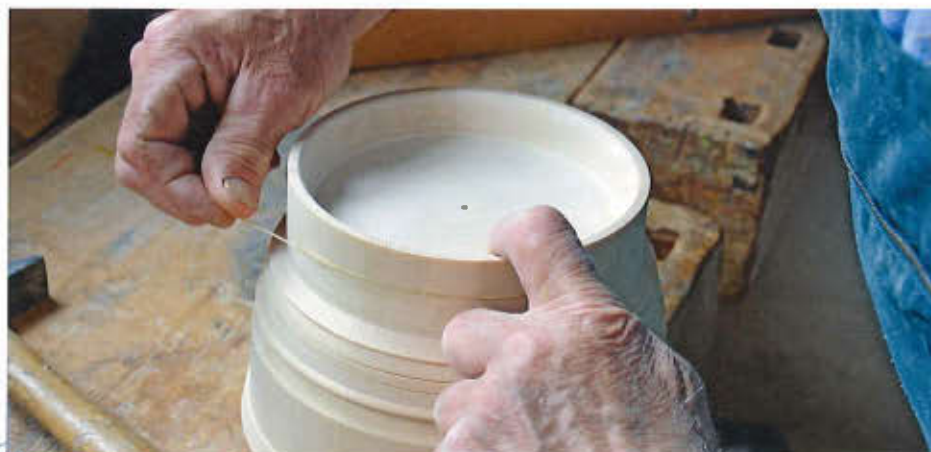
Mit einem „Massbäschtli“ vermisst der 63-Jährige den Eimer und ermittelt so, wie lang das Holzband werden muss. Die Holzbänder werden nicht verleimt, sondern nur mit Holznägeln am Eimer befestigt.
