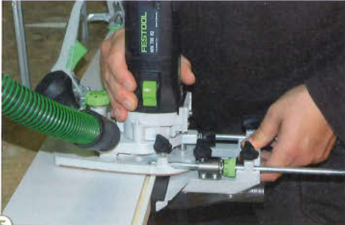
5 > Genau platzierte feine Nuten sind eine Paradedisziplin der Kantenfräse. Durch die kompakte Bauform geht dies auch bei schmalen Werkstücken, wenn stationäres Arbeiten nicht gewünscht oder möglich ist.
