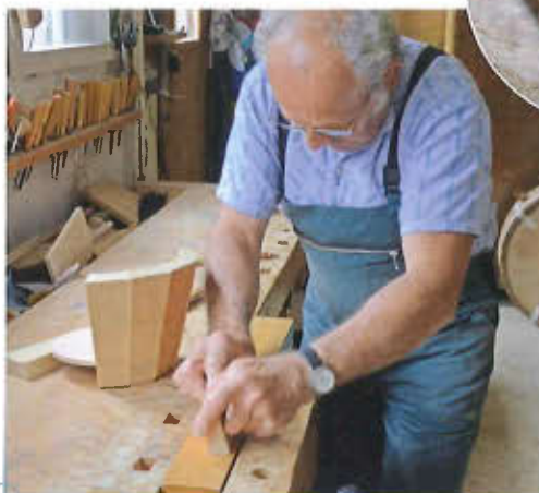
Sind die Dauben für eine Weißküferarbeit, etwa einen Melkeimer, zugeschnitten, werden sie an der Raubank eingepasst. Dann kann der Gefäßrohling verleimt werden.
