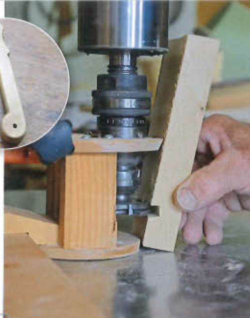
Wurden die Nuten in den Dauben früher stundenlang gesägt und gestemmt, geht das heute mit einer Vorrichtung an der Kopierfräse schneller – hier im Stillstand zur Demonstration ohne Sicherheitseinrichtung gezeigt.
