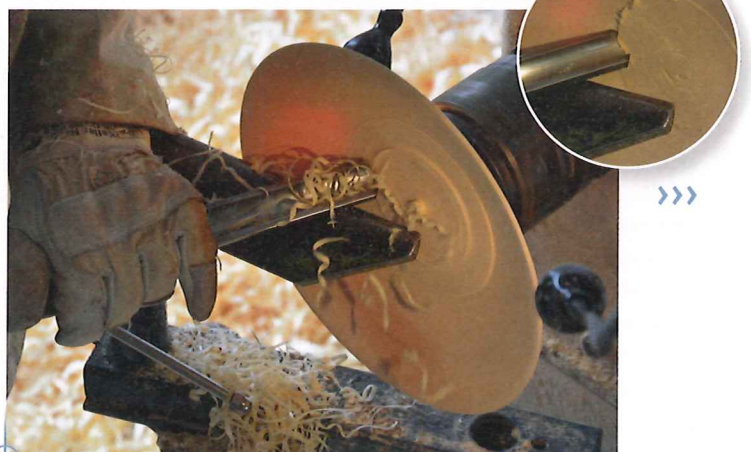
Ungewöhnlich: Innen greift er auch zur Schruppröhre. Das Langholz-Werkzeug setzt er dann nur mit dem „stehenden“ Außenbereich der Schneide ein.
