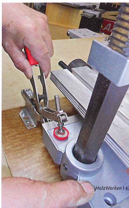
Der Bohrständers wird frei über die Tischplatte bewegt. Steht die Bohrspitze über dem angezeichneten Bohrpunkt, rasten die Kniehebelspanner ein.
