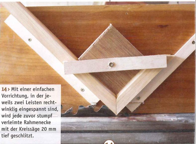
14 > Mit einer einfachen Vorrichtung, in der jeweils zwei Leisten rechtwinklig eingespannt sind, wird jede zuvor stumpf verleimte Rahmenecke mit der Kreissäge 20 mm tief geschlitzt.
