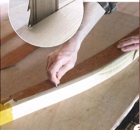
**3** > Nun kann der Zuschnitt beginnen: Beine und Armlehne werden angerissen und an der Bandsäge ausgeschnitten. Bei den hier verwendeten großen Radien von etwa zwei bis drei Metern kann auch mit breiterem Blatt geschnitten werden.
