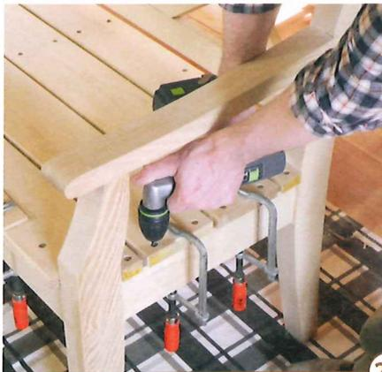
27 > Fixieren Sie zunächst das erste und das letzte Brett. Halten Sie die übrigen Bretter mit Zwingen und verwenden Sie Distanzhölzer. Ein Winkelvorsatz hilft beim Verschrauben unter der Armlehne. Leimen Sie die Stößel ein und schneiden Sie sie bündig.
