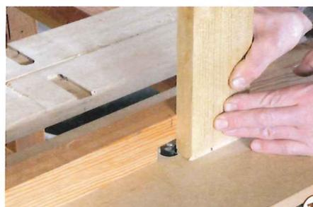
19 > An Vorder- und Hinterzarge wird mittig eine Gratnut gefräst. Hier wird die Mittelzarge eingeschoben, die das Gestell aussteift und ein Durchbiegen des Belags verhindert.
