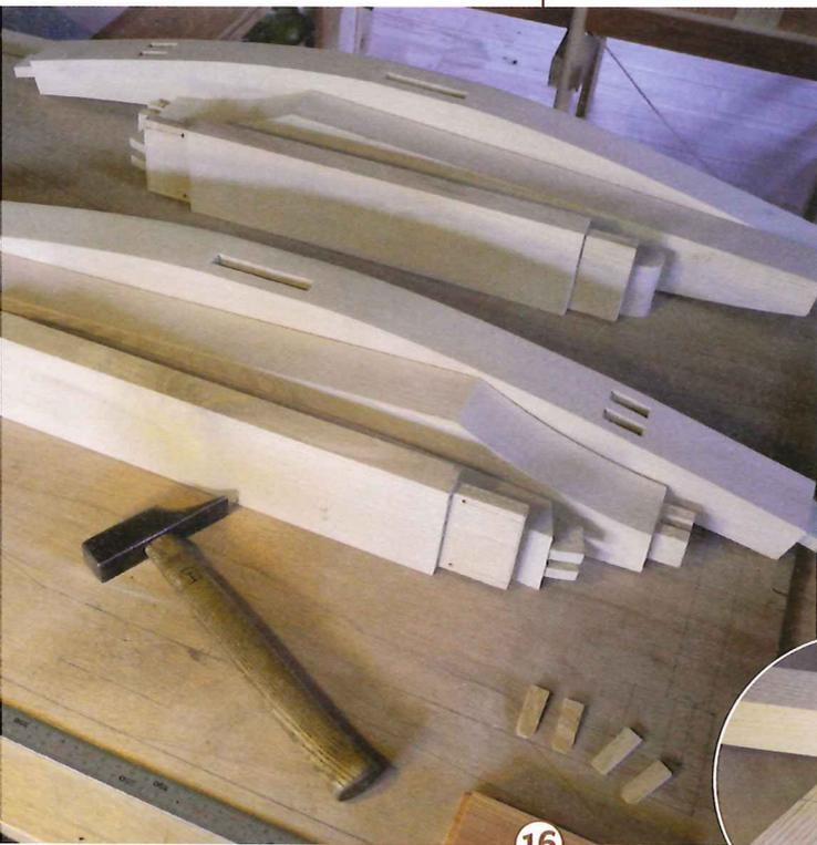
16 > Die zusammengepassten und geputzten Teile der Seiten sind fertig zum Verleimen. Im Vordergrund rechts die vier Keile für die Zargen.
