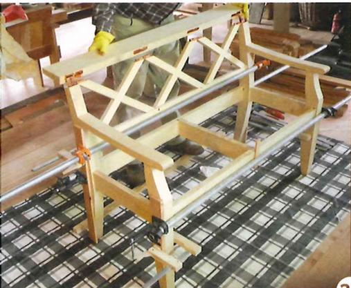
24 > Die Mittelzarge des Gestells wird in die beiden langen Zargen ge Gratet. Stecken Sie dann die H-förmig zusammengefügte Zargen in einen Seitenrahmen auf dem Boden und legen oben den zweiten Seitenrahmen auf. Setzen Sie die Zwingen an, zuerst an den Zargen, dann an der Rückenlehne.
