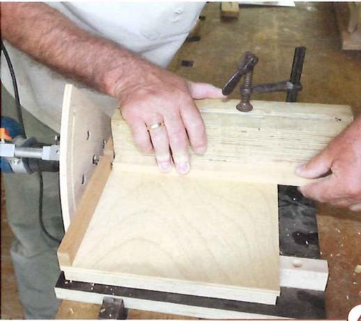
4 > Hier wird die Querleiste des Sockels stirnseitig mit Dübeln versehen. Dafür dient diese Vorrichtung mit einer Halterung für eine Bohrmaschine und einem verschiebbaren Tisch. Die Bohrmaschinenachse verläuft parallel zur Tischfläche und ist in der Höhe verstellbar. Indem man den Tisch in Richtung Bohrer verschiebt, wird die Bohrung am aufgespannten Werkstück erzeugt. Alternativ einsetzbar: Ein Horizontal-Frästisch!
