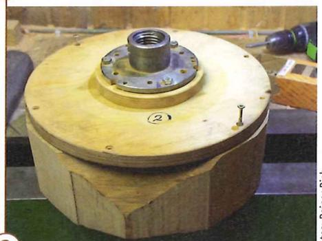
2 > Den grob geschnittenen Rohling für den Fuß spannen Sie mit einer Planscheibe, indem Sie die Schrauben soweit wie möglich an den Rand der künftigen Unterseite eindrehen. Also in den Bereich, der später ohnehin weggeschnitten wird.
