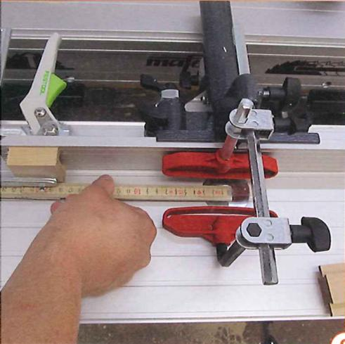
**9** > Auf beiden Seiten der Mittelleiste wird eine solche Nut gefräst. Wie gesagt nicht über die gesamte Länge, sondern nur über etwas mehr als die Hälfte der Leistenlänge. Je größer die Überlappung der beiden Nuten ist, umso weiter kann die Schublade herausgezogen werden. Lassen Sie die Nuten aber nicht zu weit überlappen, sonst wird der Auszug instabil. Bewährt hat sich eine Überlappung von 30 mm.
