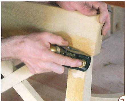
25 > An der Verbindung von Rückenlehne und Hinterbein werden etwaige Überstände mit einem Blockhobel beigeputzt. Ein Anfeuchten der Oberfläche erleichtert das Arbeiten und schützt vor Ausriss.
