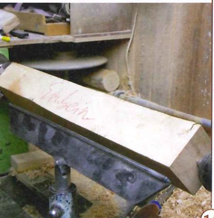
14 > Jetzt erwartet uns eine klassische Langholzarbeit. Die Kante entweder mit dem 4-Backen-Futter einspannen oder mit dem Dreizack- oder Haifischzahn-Mitnehmer fixieren und schrappen, dass die Späne fliegen.
