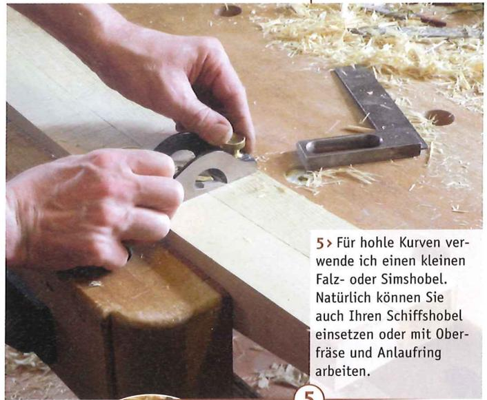
**5** > Für hohle Kurven verwende ich einen kleinen Falz- oder Simshobel. Natürlich können Sie auch Ihren Schiffshobel einsetzen oder mit Oberfräse und Anlaufring arbeiten.
