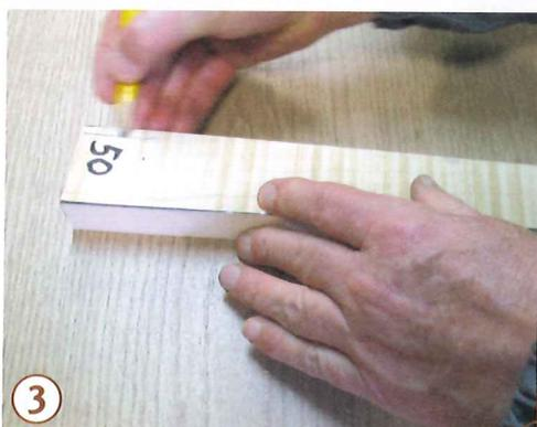
3 Um die Sägespuren später nicht aufwendig durch Schleifen beseitigen zu müssen, sollten Sie jetzt die Längsseiten des Grundkörpers durch Hobeln oder Schleifen glätten. Von der breiten Seite (fünf Zentimeter) des Trapezes aus zeichnen Sie dann die etwa fünf Millimeter starken Greifarme der Grillzange auf den Grundkörper.
