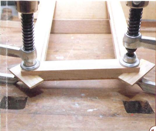
15 > In den Schlitz wird eine Feder geleimt und der Verbund gepresst, bis der Leim abgebunden hat.
