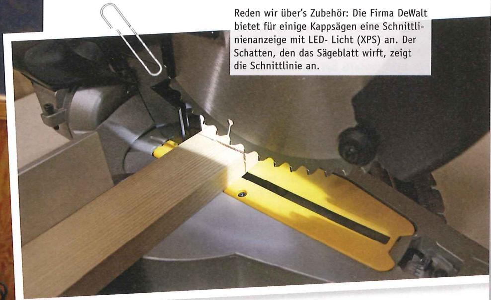
Reden wir über's Zubehör: Die Firma DeWalt bietet für einige Kappsägen eine Schnittlinienanzeige mit LED- Licht (XPS) an. Der Schatten, den das Sägeblatt wirft, zeigt die Schnittlinie an.
