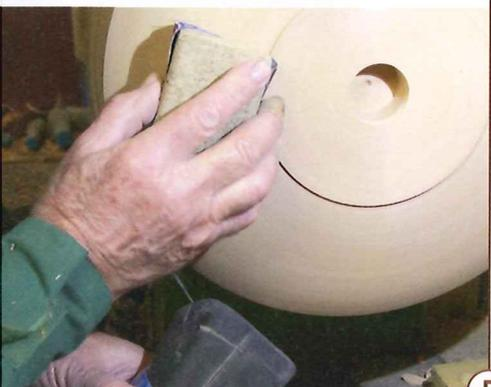
5 > Die Oberfläche wird geschliffen, wobei hier wie immer beim Drechseln gilt: Wer gut schneidet, muss weniger schleifen (oder umgekehrt).
