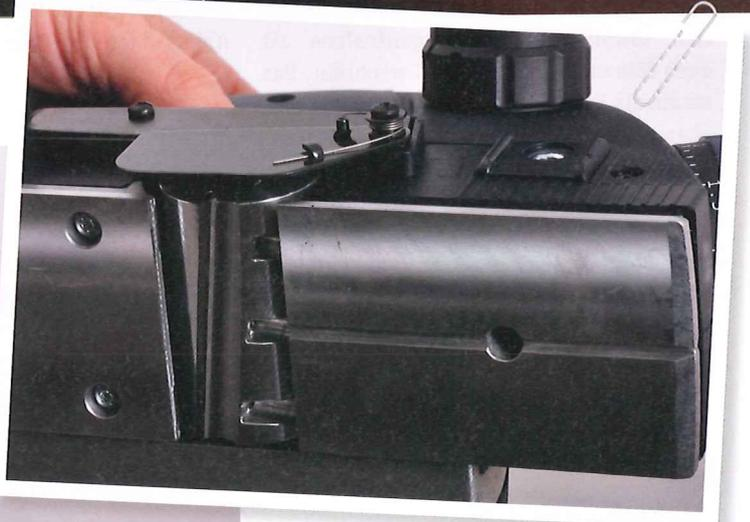
Die aufwändig gefertigte Welle nimmt spiralförmig geschliffene Messer auf, die sehr leise arbeiten. Der Messerwechsel ist in zwei Minuten erledigt. Die vordere Hobelsohle hat eine V-Nut für das schnelle Anfasen von Bauteilen.
