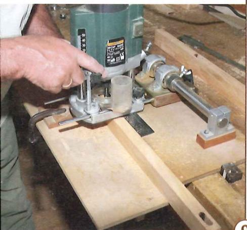
9 > Die 380 mm kurzen Leisten des Rückwand-Rahmens bekommen zur Aufnahme der Zapfen Schlitzlöcher (20 x 12 mm) an den Enden. Jeder Schlitz beginnt 10 mm vor dem Leistenende und ist 36 mm tief.
