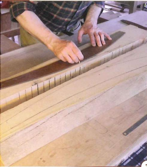
**1** > Beginnen Sie mit der Holz Auswahl: Die Fasern des Holzes sollten den Linien der Konstruktion folgen. Schneiden Sie alle Beine möglichst so zu, dass im Querschnitt die Jahrringe diagonal liegen. Zum Anriss werden Schablonen aus Pappe, Hartfaser oder Sperrholz verwendet.
