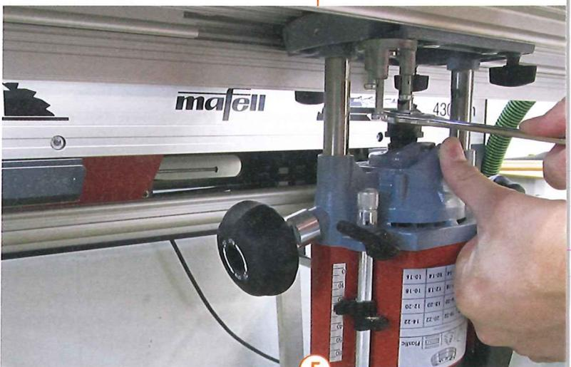
**5** Der Gratfräser wird nicht mehr benötigt. Es wird stattdessen ein Nutfräser mit einem Durchmesser von mindestens 8 mm – besser, so wie hier, 12 mm – eingesetzt. Je nach Frästisch können Sie nun auch auf einen anderen Einlegering wechseln und so die Tischöffnung so klein wie möglich halten.
