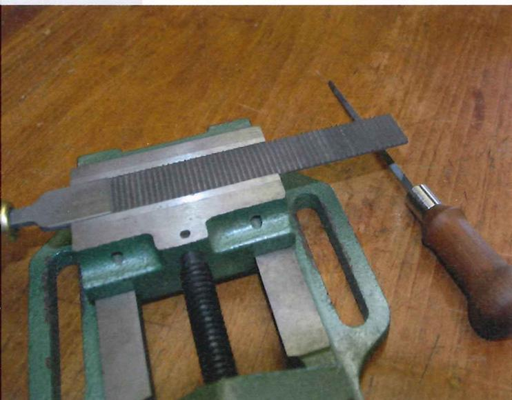
Das Schärfeprinzip ist ähnlich wie einer Handsäge, durch die breite Auflagefläche jedoch wesentlich einfacher und geht leicht von der Hand. Das Werkzeug muss dazu nur gespannt werden, dann fährt eine Dreiecksfeile durch alle Zahnzwischenräume.
