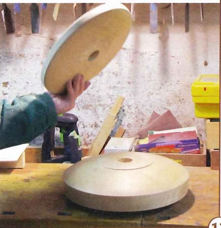
13 > Fast fertig! Sitz und Fuß müssen nur noch durch einen Ständer verbunden werden. Jetzt muss genau gemessen werden, damit am Ende unter Einbeziehung der beiden Zapfen sowie der Dicke von Fuß und Sitz die gewünschte Sitzhöhe erreicht wird. Falls ein weiches Stoffkissen das Wohlfühl fördern soll, müssen zwei, drei Zentimeter abgezogen werden.
