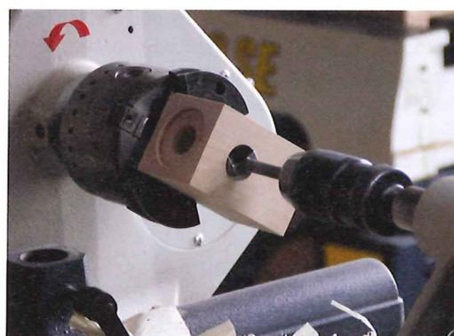
Zwei Backen spannen das Holz bei Bohrungen quer zur ersten Bohrung, wie bei diesem Rohling für eine Muskatmühle.
