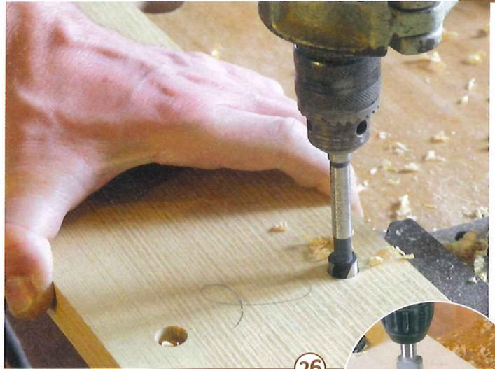
26 > Reißen Sie die Löcher für die Befestigung des Belags an. Bohren Sie mit dem Forstnerbohrer 7 mm tief vor. Diese Bohrung nimmt später den Stößel auf, den Sie mit dem Zapfenschneider herstellen können (kleines Bild). Dann mit dem Spiralbohrer das Schraubenloch bohren.
