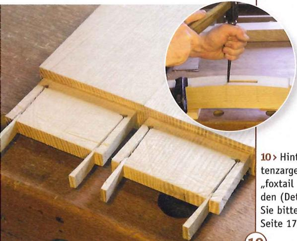
10 > Hinterbein und Seitenzarge werden mit dem „foxtail tenon“ verbunden (Details entnehmen Sie bitte dem Kasten auf Seite 17).
