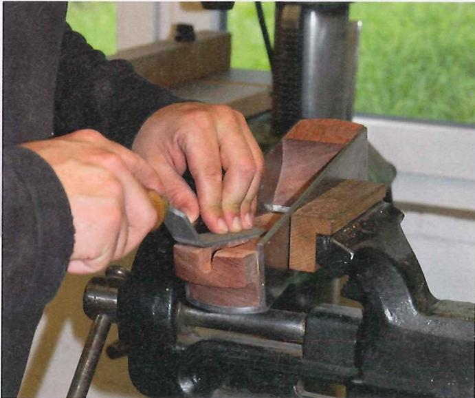
Eine echte Hilfe sind Float-Feilen beim Hobelbau. Hier beim Nachputzen der Eisenauflagefläche eines Infillhobel-Bausatzes (Anbieter: Gerd Fritsche). Das harte Bubinga war kein Problem für das Liogier-Werkzeug und die erzeugte Oberfläche makellos.
