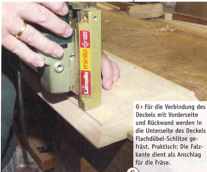
6 > Für die Verbindung des Deckels mit Vorderseite und Rückwand werden in die Unterseite des Deckels Flachdübel-Schlitzes gefräst. Praktisch: Die Falzkante dient als Anschlag für die Fräse.
