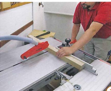
7> Bevor nun die letzte Fräsung gemacht wird, müssen die noch langen Leisten auf die richtige Länge gebracht werden. Die Länge der Auszugleisten entspricht genau der Länge Ihrer Schubladenseite. Sie können beim Ablängen die drei Leisten ineinanderschieben. So müssen Sie nicht alle einzeln schneiden.
