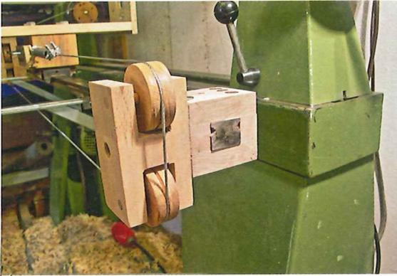
Der Halter für die hinteren Umlenkrollen rechts an der Bank ist ganz am Ende der Führungsschiene ebenfalls fest verbaut.
