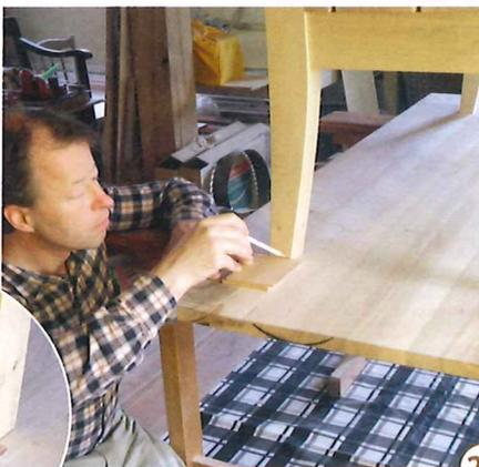
28 > Kürzen der Hinterbeine für eine geneigte Sitzfläche: Unterlegen Sie die Vorderbeine mit dünnen Brettchen (hier 15 mm). Tragen Sie dann mit einem gleich starken Brettchen an den Hinterbeinen 15 mm ab. Kürzen Sie die Hinterbeine mit der Handsäge und brechen Sie die Kanten stark.
