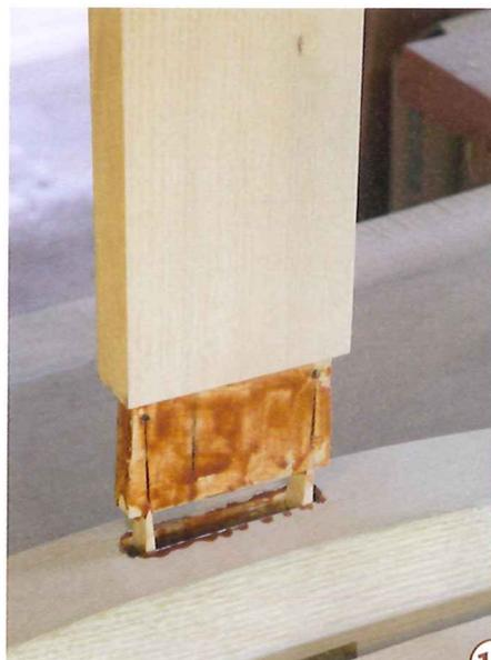
17 > Beginnen Sie das Verleimen mit dem foxtail tenon. Die Keilchen werden vorsichtig wenige Millimeter tief in die Schnitte gesteckt und dann der Zapfen in den Schlitz geführt. Es folgen die anderen Zapfenverbindungen.
