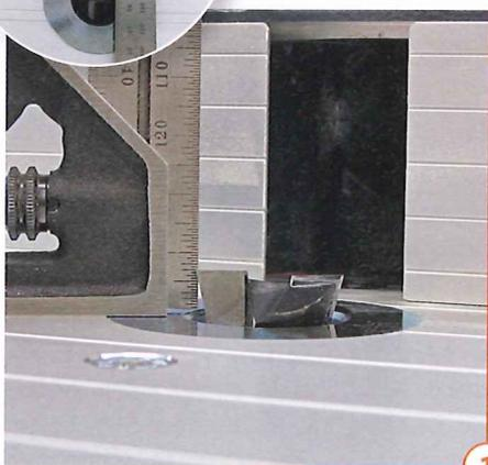
**1** Der erste Arbeitsschritt beim Fräsen der Auszüge ist das Einbringen der Gratnut in die beiden Außenleisten. Die Nut ist 7 mm tief und im engeren Bereich 26 mm breit. Die genauen Maße finden sie auch auf der Zeichnung hier oben. Stellen Sie den Fräsanschlag so ein, dass zwischen dem Anschlag und der äußeren Spitze des Fräses 40 mm Abstand verbleiben.
