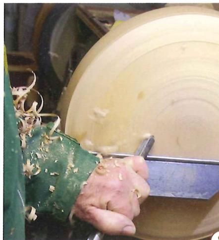
8 > Die konvexe Unterseite des Fußes wird mit der Röhre profiliert (Bild) und zum Schluss mit einem fein abgezogenen Schaber versäubert.
