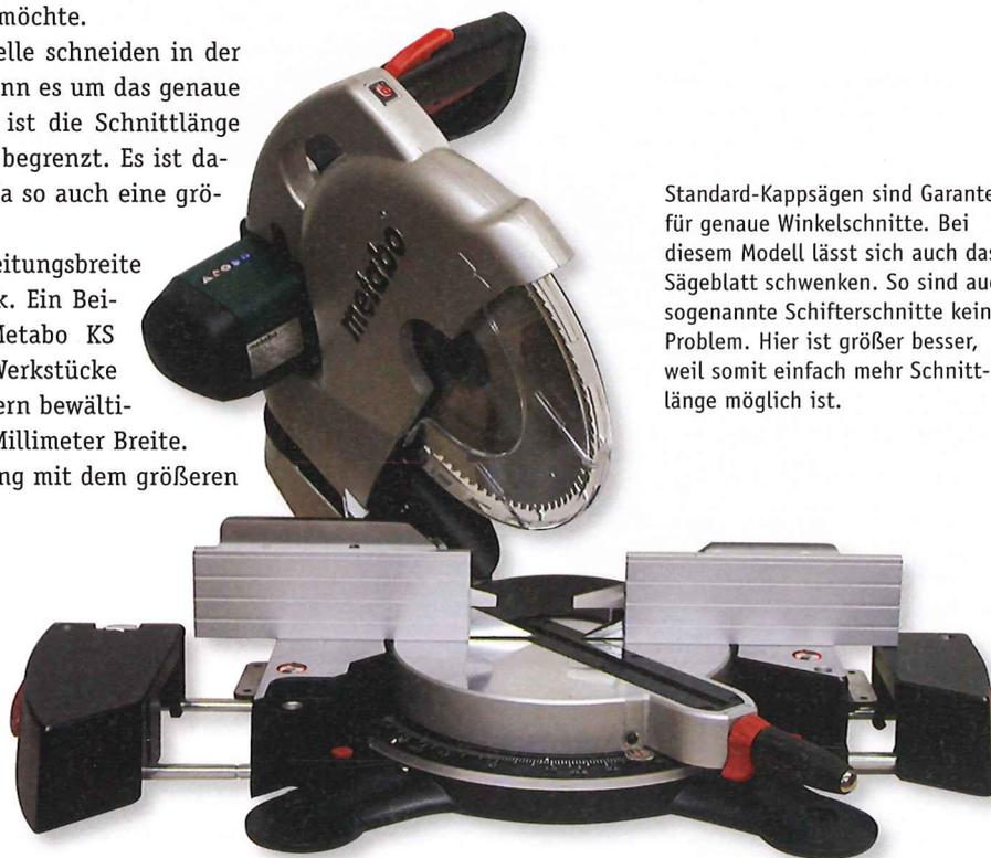
Standard-Kappsägen sind Garanten für genaue Winkelschnitte. Bei diesem Modell lässt sich auch das Sägeblatt schwenken. So sind auch sogenannte Schifterschnitte kein Problem. Hier ist größer besser, weil somit einfach mehr Schnittlänge möglich ist.
