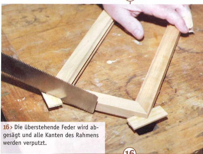
16 > Die überstehende Feder wird abgesägt und alle Kanten des Rahmens werden verputzt.
