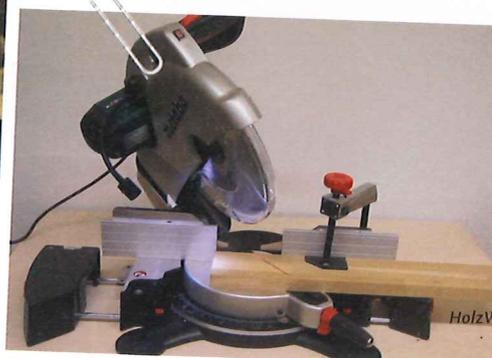
Mindestens genauso praktisch wie ein Laser: Diese Säge von Metabo ist zusätzlich mit einem schwenkbaren Arbeitslicht ausgestattet. Andere Modelle haben immerhin einen Arm, der mit einer Lampe bestückt werden kann.
