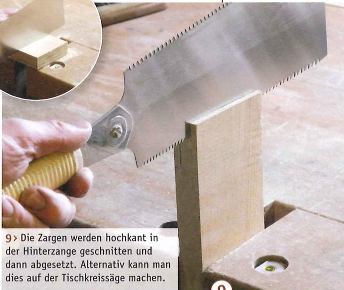
9 > Die Zargen werden hochkant in der Hinterzange geschnitten und dann abgesetzt. Alternativ kann man dies auf der Tischkreissäge machen.
