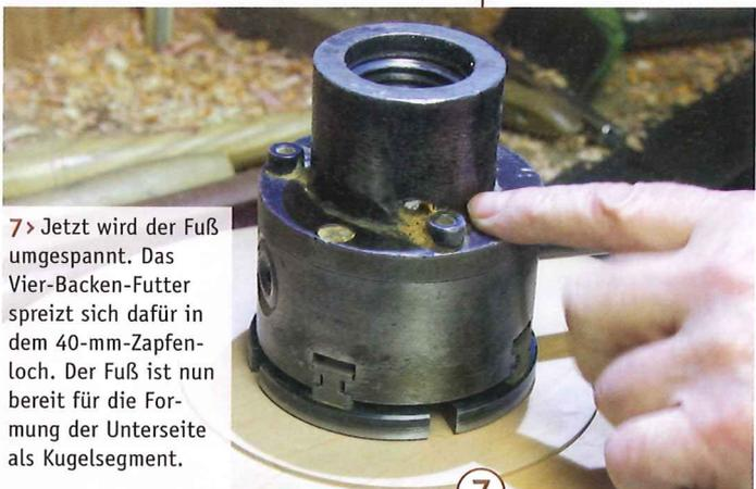
7 > Jetzt wird der Fuß umgespannt. Das Vier-Backen-Futter spreizt sich dafür in dem 40-mm-Zapfenloch. Der Fuß ist nun bereit für die Formung der Unterseite als Kugelsegment.
