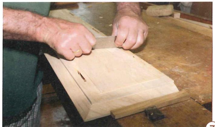
7 > Alle Flächen der Grundplatte und des Deckels werden, so wie zuvor bereits die Einzelteile des Sockels, mit Ziehklinge, Putzhobel oder Schleifpapier geglättet.
