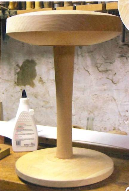
17 > Der letzte Arbeitsschritt ist der schönste. Einige Tropfen Leim gleichmäßig auf Zapfen und in Löcher verteilen und die drei Teile untermäßigem Druck zusammenpressen. Bei genauer Arbeit reicht der Andruck durch Ihr Körpergewicht. Nach einer Stunde Trocknung kann der Gesundheitshocker getestet werden. Er schwingt gleichmäßig und fällt trotz heftigen Schwungs mit der Hand nicht um.
