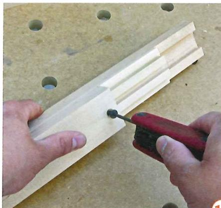
**12** > Schubladenseitig kommt eine Madenschraube zum Einsatz. Zum Einsetzen der Schublade wird diese ausgedreht. Ist die Schublade aufgeschoben, dreht man die Schraube ein. Ab jetzt stoppt die Schublade, wenn sie voll ausgezogen ist.
