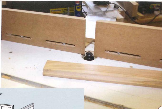
1 > Starten wir mit dem Sockel: Eine Leiste wird auf das Maß 1250 x 70 x 20 mm geschnitten und gehobelt. An eine Längsseite wird oben und unten jeweils eine Hohlkehle (Radius = 10 mm) gefräst.
