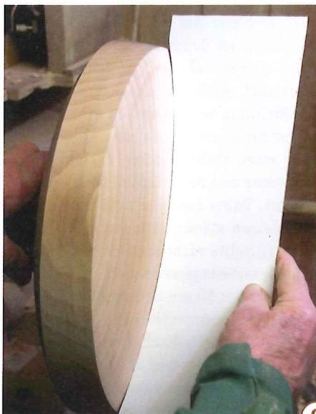
9 > Mit der Schablone messen und kontrollieren Sie die Kurve immer wieder. Präzision ist geboten, weil kleine Unebenheiten an der Oberfläche ein gleichmäßiges Abrollen verhindern. Das stört! Nach einem feinen Schliff ist der Fuß schließlich fertig.
