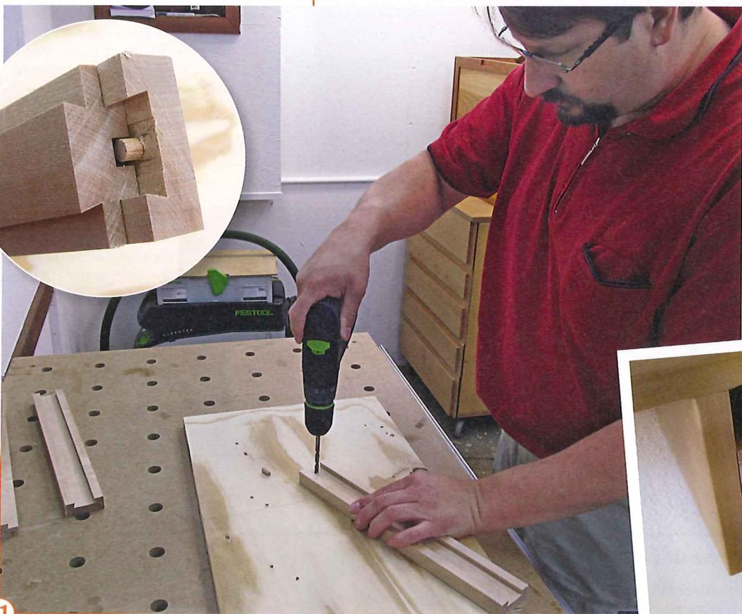
**13** > Damit der Auszug richtig funktioniert, muss er auf die richtige Weise zusammengesteckt werden. Beim korpusseitigen Auszugsteil weist der Stopper zur Korpus-Vorderkante, beim schubladenseitigen Auszugsteil hingegen nach hinten. Die Einbau-richtung der Mittelleiste ergibt sich dann von alleine.
