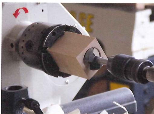
Vier Backen spannen das Holz bei Zentrierbohrungen parallel zu den Fasern.
