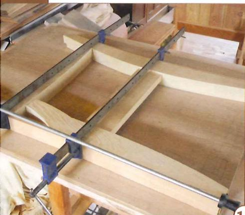
15 > Das probeweise Zusammenspannen vermeidet Überraschungen und ermöglicht ein Nachpassen der Verbindungen.
