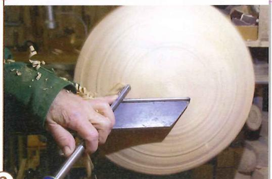
3 > Die Oberseite des Fußes wird in der Mitte gedreht, damit der Ständer rund um den Zapfen satt aufsteht. Der Rest wird nach eigenem Formempfinden profiliert, in diesem Fall zum Rand hin abfallend.
