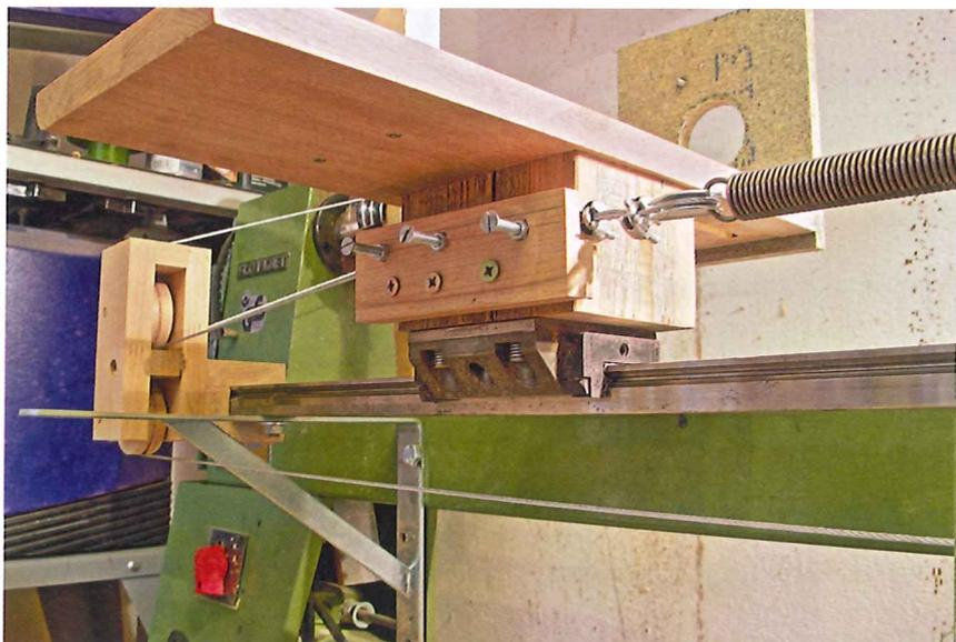
Der Oberfräsen-Schlitten (ohne Maschine) in der Untersicht. Rechts angebaut ist die kräftige Zugfeder, die das Seilsystem auf Spannung hält.
