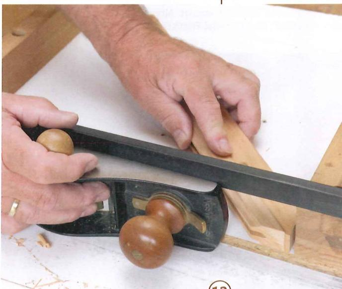
13 > Um dichte Fugen zu erhalten, werden die Leisten um Spielkartendicke länger zugeschnitten und mit dem Hobel und einer 45°-Stoßlade exakt auf Maß und Winkel gehobelt.
