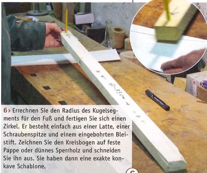
6 > Errechnen Sie den Radius des Kugelsegments für den Fuß und fertigen Sie sich einen Zirkel. Er besteht einfach aus einer Latte, einer Schraubenspitze und einem eingebohrten Bleistift. Zeichnen Sie den Kreisbogen auf feste Pappe oder dünnes Sperrholz und schneiden Sie ihn aus. Sie haben dann eine exakte konkave Schablone.
