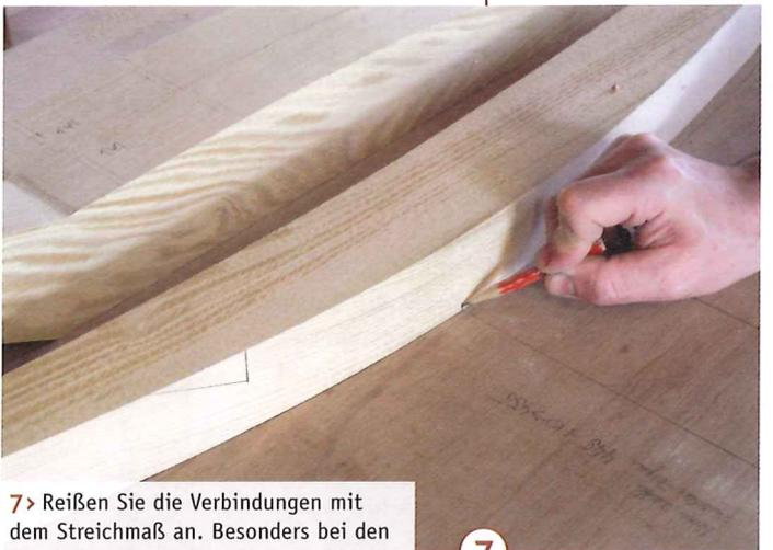
**7** > Reißen Sie die Verbindungen mit dem Streichmaß an. Besonders bei den Verbindungen der Armlehne macht sich der 1:1-Aufriss nützlich. Sie können die Positionen von Schlitz und Zapfen einfach vom Riss übertragen.
