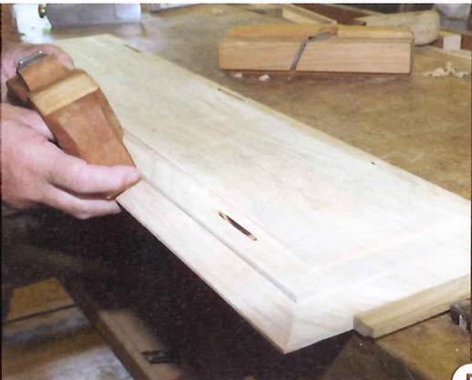
5 > Grundplatte und Deckel des Aufbaus werden mehrfach gefalzt – siehe Zeichnung. Für eine gefälligere Optik bekommt der Deckel an drei Seiten auf der Kreissäge eine 45°-Abschrägung, die mit dem Hobel fein nachgearbeitet wird.
