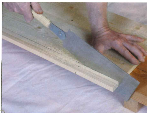
Längsschnitt: Führen bei 15°
