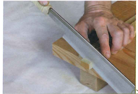
Feinschnitt: 30°-Schnitt mit kurzen Hieben
