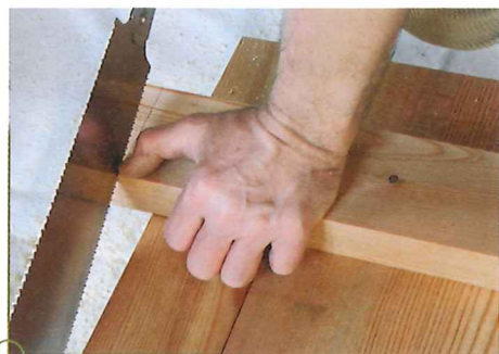
Querschnitt: Ansetzen mit Daumen als Anschlag
