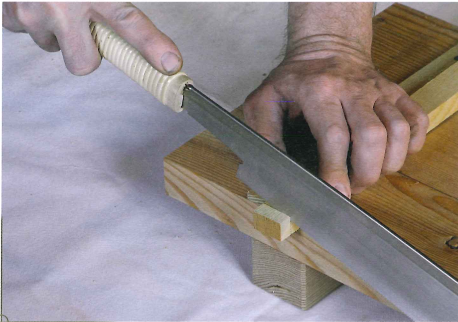
Feinschnitt: Ansetzen am Riss
