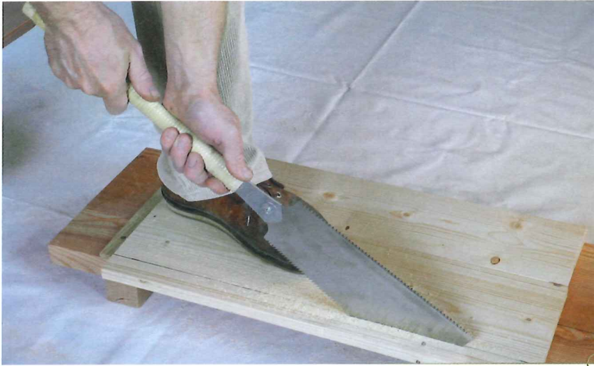
Längsschnitt: Beidhändig geführter schneller Schnitt bei 30°.
