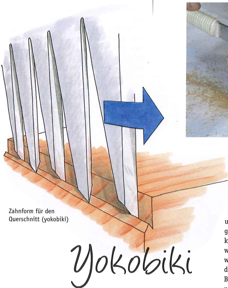
Querschnitt: Schnittbeginn bei 15°
