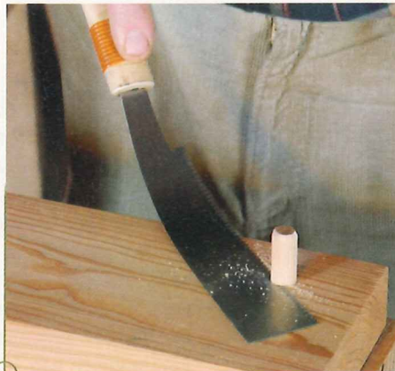
Kugibiki (Nagelsäge): Mit ihrem extrem dünnen Blatt ist sie sehr flexibel. Dank einer ungeschränkten Bezaehlung eignet sie sich für flächenbündige Schnitte, etwa wenn der Überstand eines Dübels oder Holznagels abgetrennt werden soll.
