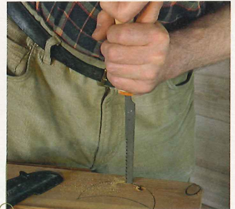
Mawashibiki (Stichsäge): Das leicht keilförmige und sehr schmale Blatt wird für Schweifungen mit engen Radien verwendet. Mitunter findet diese Säge auch bei Holzbildhauern Verwendung.
