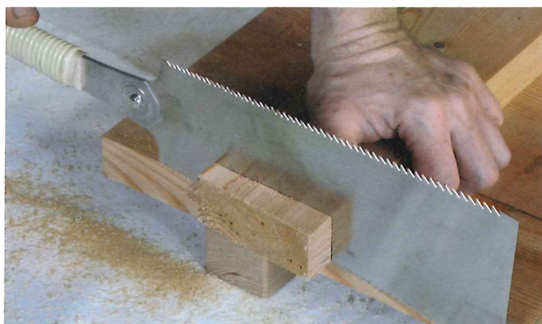
Querschnitt: Säge am Ende waagrecht führen
