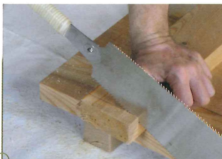
Querschnitt: Schnittbeginn bei 15°
