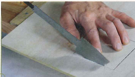
Azebiki – für Einschnitte: Ein kurzes Blatt mit bogenförmiger Bezaehlung ermöglicht Einschnitte in Bretter und Platten oder „tot laufende“ Schnitte. Zwei gegenüberliegende Bezaehlungen erlauben Schnitte längs und quer zur Faser.
