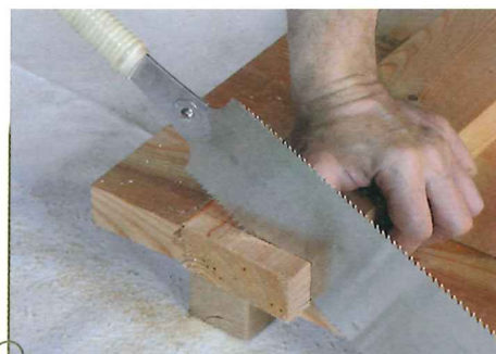
Querschnitt: Weiterführen bei 30°
