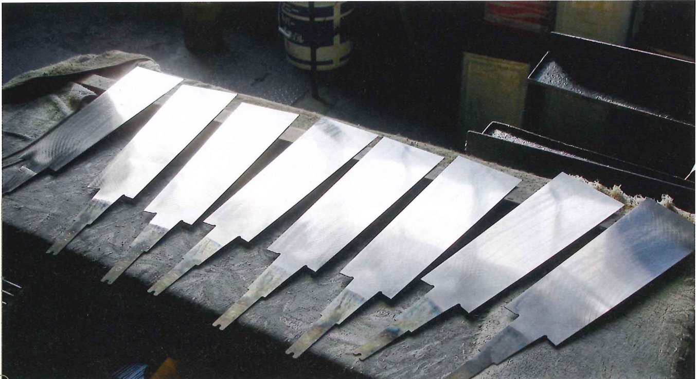
Die Güte des Schiffs trägt bei der Benutzung dazu bei, die Säge möglichst reibungsarm durch die Schnittfuge gleiten zu lassen.
