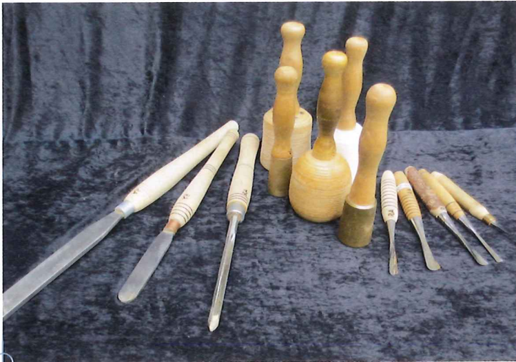
Klüpfel und Werkzeuggriffe nach Augustin'scher Art: Sie sind auf der Drechselbank entstanden.
