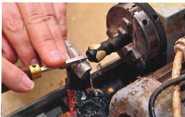
Vasendreheln im Miniformat läuft genauso wie im großen Maßstab. Am kniffligsten ist das dünnwandige Ausdrehen.
