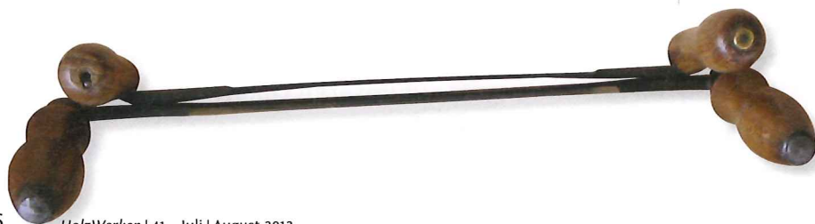
Gerade Ziehmesser haben eine Fasse und eine Spiegelseite. Das schmale Messer in der Mitte ist besonders gut zum Putzen von schwieriger Maserung und engen Innenkurven geeignet.
