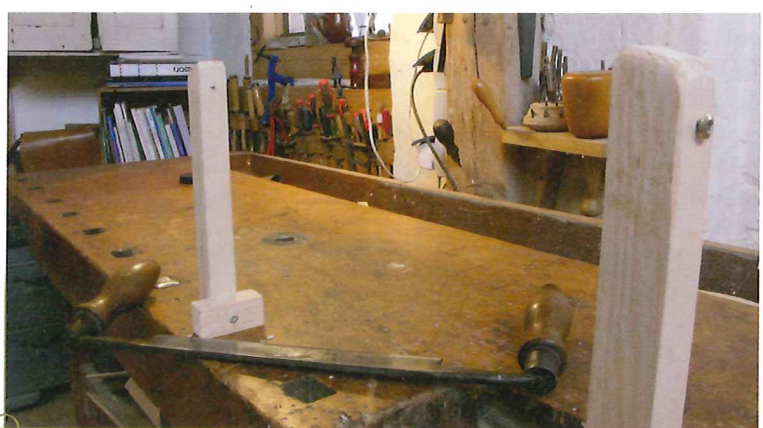
Um an der Hobelbank sinnvoll mit dem Ziehmesser arbeiten zu können, kann man sich hohe Bankhaken aus Holz selber bauen. Die vorstehenden Spitzen zweier Schrauben sorgen dafür, dass das Werkstück nicht verrutscht.
