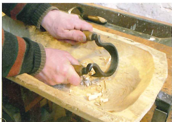
Gebogene Ziehmesser höhlen das Innere von geschnitzten Schalen aus.
