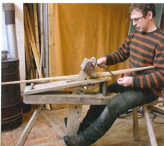
Zugbank und Ziehmesser ergänzen sich ideal. Besonders Bogebauer schätzen noch die ergonomische und für lange Teile unübertroffene altertümliche Werkbank.
