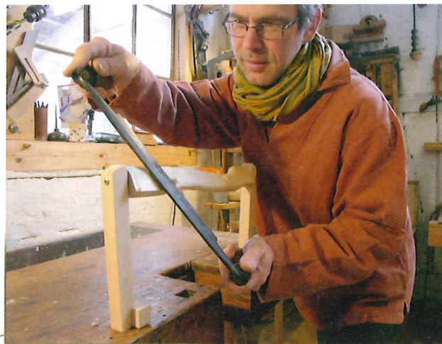
Mit ziehendem Schnitt kann man aber auch sehr feinfühlig arbeiten, wie beim Putzen dieses Axtstieles.
