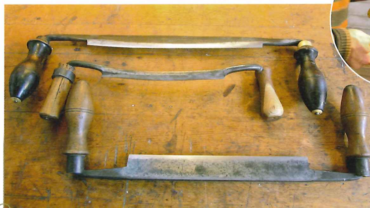
Gerade Ziehmesser haben eine Fasse und eine Spiegelseite. Das schmale Messer in der Mitte ist besonders gut zum Putzen von schwieriger Maserung und engen Innenkurven geeignet.
