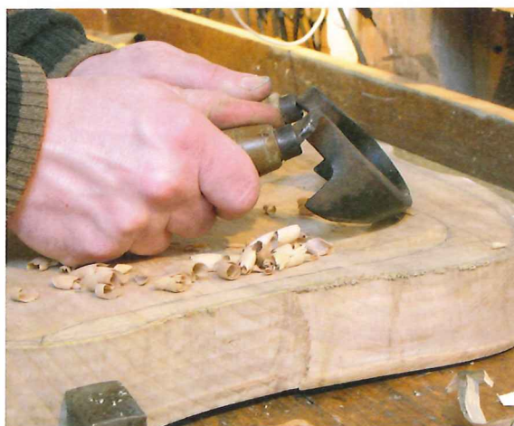
Auch die Sitzflächen von Windsorstühlen werden mit dem Ziehmesser geglättet.
