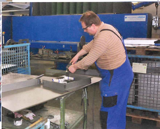
Die Blechteile werden zunächst per Laser ausgeschnitten und dann von einem Schweiß-Roboter zusammengefügt. Kleine Nacharbeiten geschehen mit der Flex.
