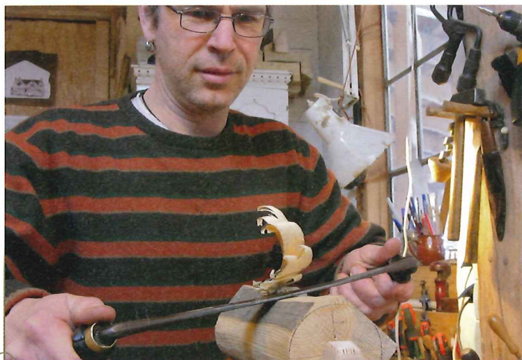
Mit den robusten, beidhändig geführten Klingen kann man richtig Masse herunterreißen, etwa um Drechselkanteln vorzurunden.
