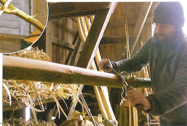
Am häufigsten werden Ziehmesser heutzutage zum sauberen Entrinden benutzt, wie hier im Großen bei Tipistangen, oder im Kleinen, wie bei dieser Eibengabel für ein Wildholz Möbel.
