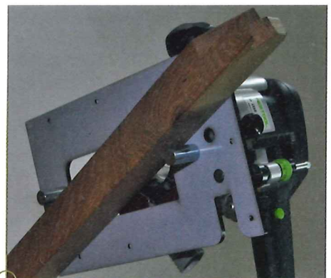
Der Anti-Abkip-Stift ist lang genug, um auch bei dicken Werkstücken wirksam zu sein.
