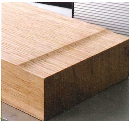
Solch ein breiter Ausriss am Brettende ist charakteristisch für zu hoch sitzende Messer.
