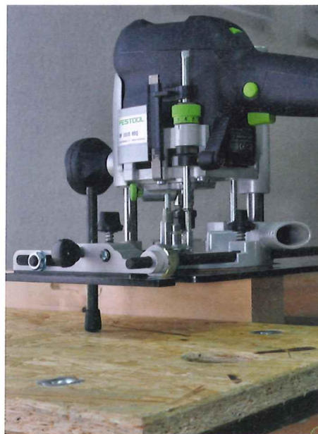
Der Anti-Abkip-Stift ist lang genug, um auch bei dicken Werkstücken wirksam zu sein.
