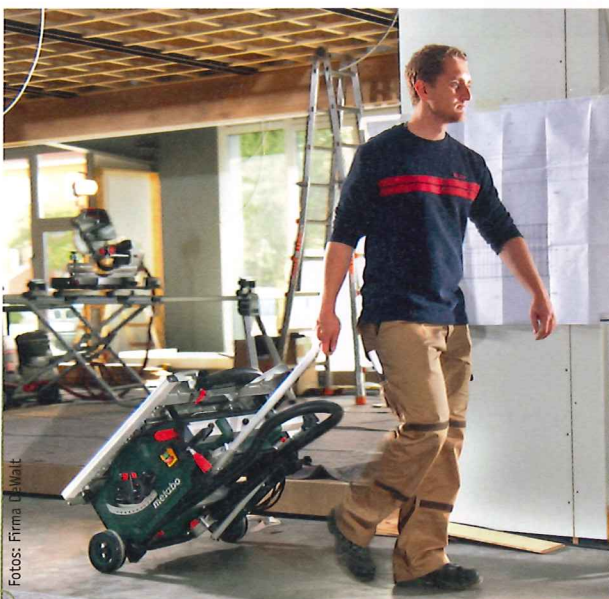
Nicht nur auf der Baustelle, sondern auch in der heimischen Keller- oder Garagenwerkstatt praktisch: Die zusammenklappbare TS 254.
