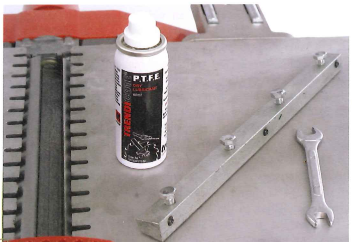
Gesäubert und mit ein wenig Öl oder Schmiermittel benetzt, sollten sich die Schrauben auch von Hand leichtgängig bewegen lassen.
