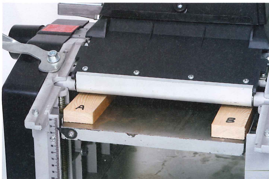
Zur Kontrolle des Tisches schieben Sie zwei schmale Kontrollleisten durch den Dickenhobel...
