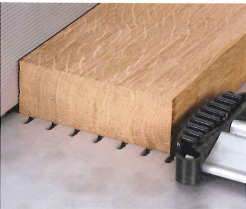
Sitzen die Messer viel zu tief, stößt das Werkstück an die Lippe des Abnahmetischs an.
