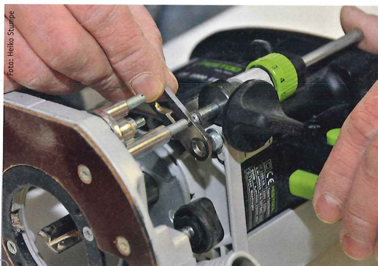
Der Abstand zwischen dem Taster und dem Revolveranschlag Ihrer Oberfräse ist gleichzeitig die Tiefe für das Einlassen des Scharniers.
