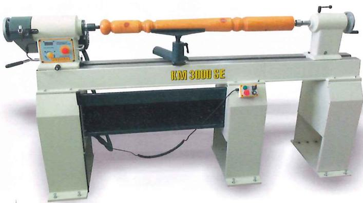
Mit einem dritten Fuß wächst die Länge des Bankbetts auf 150 Zentimeter. Ein vierter Fuß macht schließlich satte 230 Zentimeter möglich.
