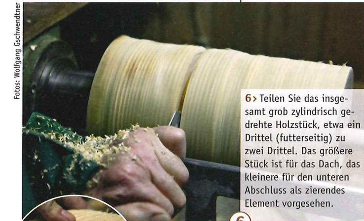
**6** > Teilen Sie das insgesamt grob zylindrisch gedrehte Holzstück, etwa ein Drittel (futterseitig) zu zwei Dritteln. Das größere Stück ist für das Dach, das kleinere für den unteren Abschluss als zierendes Element vorgesehen.
