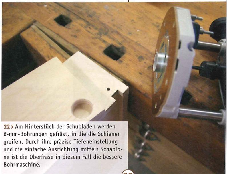
22 > Am Hinterstück der Schubladen werden 6-mm-Bohrungen gefräst, in die die Schienen greifen. Durch ihre präzise Tiefeneinstellung und die einfache Ausrichtung mittels Schablone ist die Oberfräse in diesem Fall die bessere Bohrmaschine.
