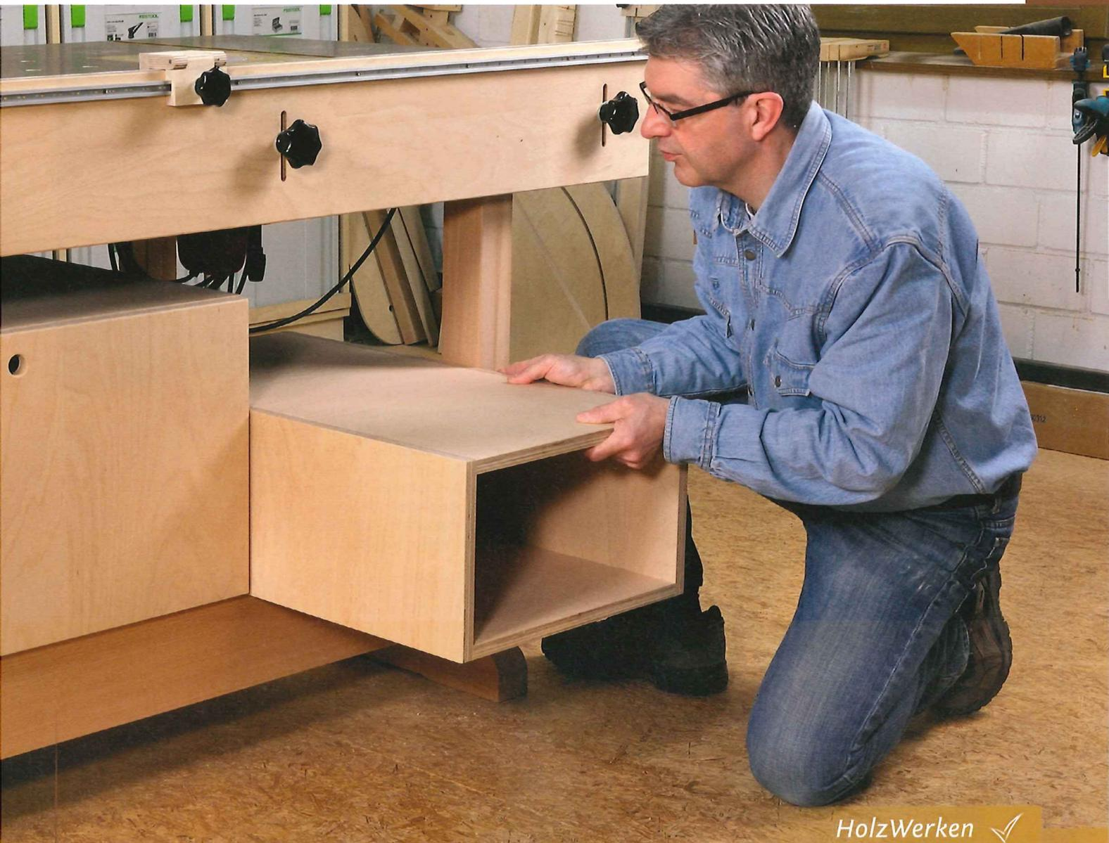
Ein 120 cm breites und 40 cm hohes, dreitüriges Schrankelement bietet jede Menge Stauraum für Spannelemente, Werkzeuge, Maschinen, Fräser und Zubehör. Unter dem Frästisch befindet sich noch ein 42 cm breites, aber nur 25 cm hohes Schränkchen.
