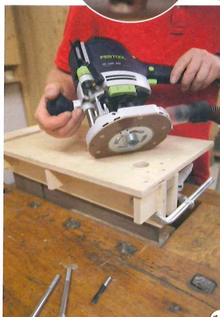
13 > Auch zum Bohren der Achsen werden Oberfräse und Kopierring eingesetzt. So können Sie präzise und winklig bohren. Das Verlängern der Bohrungen mit der Handbohrmaschine ist problemlos möglich, da der Bohrer in den vorgefrästen Öffnungen präzise geführt wurde.
