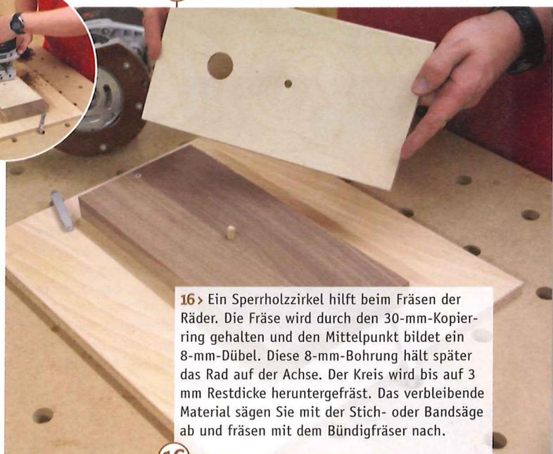
16 > Ein Sperrholzzirkel hilft beim Fräsen der Räder. Die Fräse wird durch den 30-mm-Kopier-ring gehalten und den Mittelpunkt bildet ein 8-mm-Dübel. Diese 8-mm-Bohrung hält später das Rad auf der Achse. Der Kreis wird bis auf 3 mm Restdicke heruntergefräst. Das verbleibende Material sägen Sie mit der Stich- oder Bandsäge ab und fräsen mit dem Bündigfräser nach.
