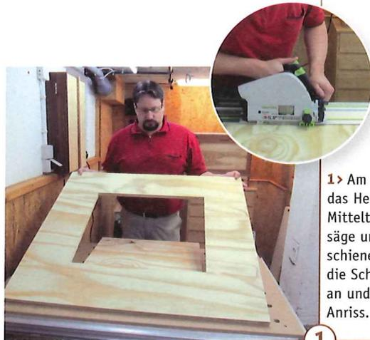
1 > Am einfachsten gelingt das Heraustrennen des Mittelteils mit der Tauchsäge und einer Führungsschiene. Zeichnen Sie sich die Schnittposition genau an und arbeiten Sie nach Anriss.
