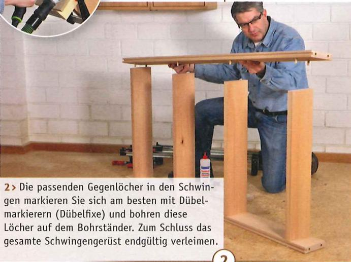
2 > Die passenden Gegenlöcher in den Schwingen markieren Sie sich am besten mit Dübelmarkierern (Dübelfixe) und bohren diese Löcher auf dem Bohrständer. Zum Schluss das gesamte Schwingengerüst endgültig verleimen.
