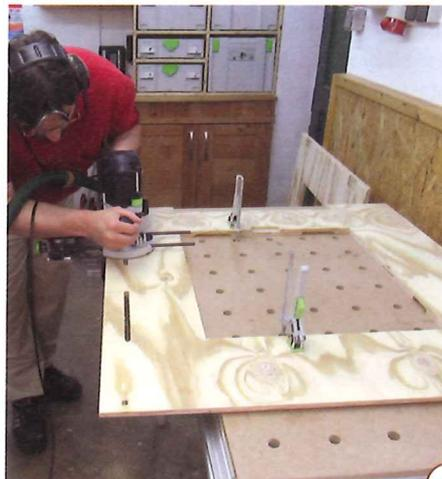
4 > Die Schlitz in den Seitenteilen können Sie einfach mit der Oberfräse und einem montierten Parallelanschlag ausfräsen. Diese Fräsungen müssen nicht auf den zehntel Millimeter genau ausgeführt werden, denn zu stramm sollen die Einsteck-Winkel auch nicht laufen.
