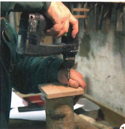
13 > Das Mittelstück mit Rinde bekommt jetzt über Fläche und Seiten verteilt vier Löcher für die Futterknödel. Um diese Bohrung in der Ständerbohrmaschine verdrehsicher herstellen zu können, schrauben Sie provisorisch auf beide Seiten mit jeweils zwei Schrauben quadratische Holzbretter.
