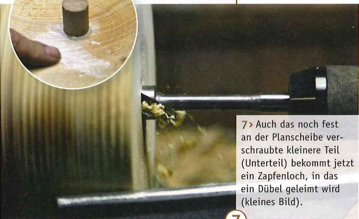
**7** > Auch das noch fest an der Planscheibe verschraubte kleinere Teil (Unterteil) bekommt jetzt ein Zapfenloch, in das ein Dübel geleimt wird (kleines Bild).
