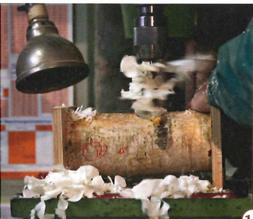
14 > Bewährt haben sich Löcher für die Meisenknödel bis zur Mitte des Stammes und mit einem Durchmesser von 50 bis 55 Millimetern.
