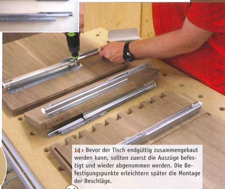
14 > Bevor der Tisch endgültig zusammengebaut werden kann, sollten zuerst die Auszüge befestigt und wieder abgenommen werden. Die Befestigungspunkte erleichtern später die Montage der Beschläge.
