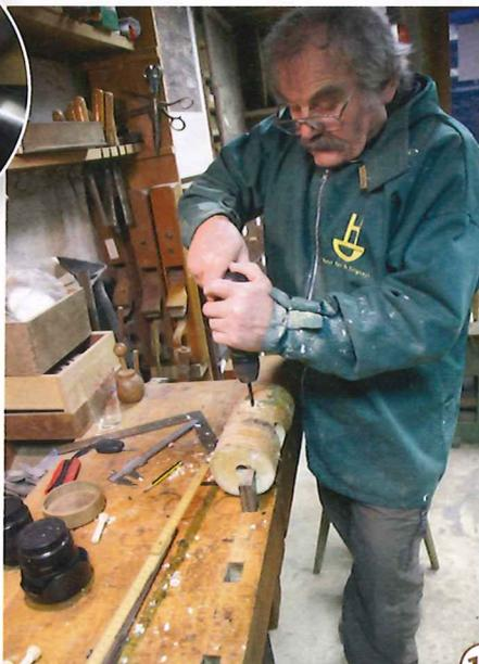
16 > Die Sitzstangen werden in Löcher jeweils zehn Millimeter unterhalb der großen Futterlöcher geleimt. Danach stecken Sie Dach und Unterteil unter Zugabe einiger Tropfen Leim mit dem Mittelteil zusammen. Aus einem Messing- oder Edelstahldraht biegen wir einen Bügel, der in die Kugel geschoben wird.
