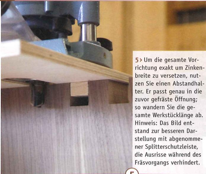
5> Um die gesamte Vorrichtung exakt um Zinkenbreite zu versetzen, nutzen Sie einen Abstandhalter. Er passt genau in die zuvor gefräste Öffnung; so wandern Sie die gesamte Werkstücklänge ab. Hinweis: Das Bild entstand zur besseren Darstellung mit abgenommener Splitterschutzleiste, die Ausrisse während des Fräsvorgangs verhindert.
