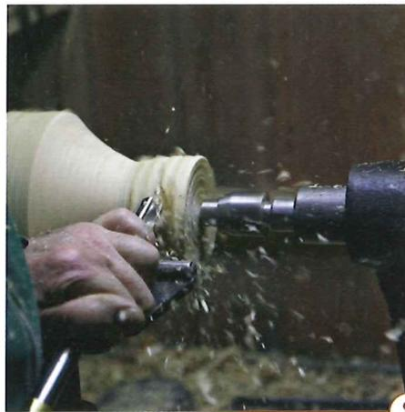
**8** > Ab jetzt wird richtig gedreht, am besten mit einer 13er-Formröhre. Da am Unterteil der Leim noch trocknet, geht es wieder mit dem Dach weiter. Stützen Sie das Werkstück so lange wie möglich mit dem Reitstock.
