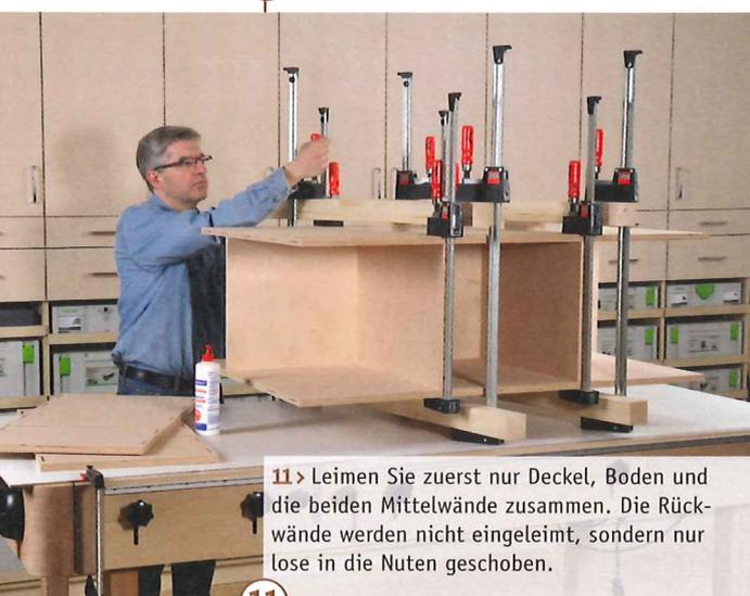
11 > Leimen Sie zuerst nur Deckel, Boden und die beiden Mittelwände zusammen. Die Rückwände werden nicht eingeleimt, sondern nur lose in die Nuten geschoben.
