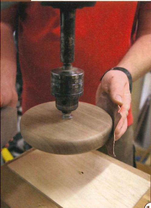
17 > Praktisch: Das an den Kanten gerundete Rad schleift man ohne große Mühe in der Ständerbohrmaschine. Eine 8-mm-Schraube mit Unterlegscheiben und Mutter hält es und dient zum festen Einspannen im Bohrfutter.
