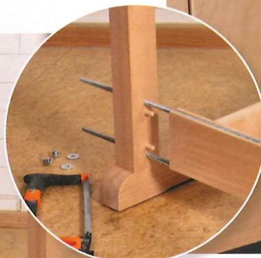
Das gesamte Untergestell besteht aus einem extrem stabilen Schwingengerüst, das auch problemlos vollgepackte Unterschränke trägt. Zwei seitliche, groß dimensionierte Fußteile werden mit langen M10-Gewindestangen sicher und fest mit den Schwingen verbunden werden (kleines Bild).
