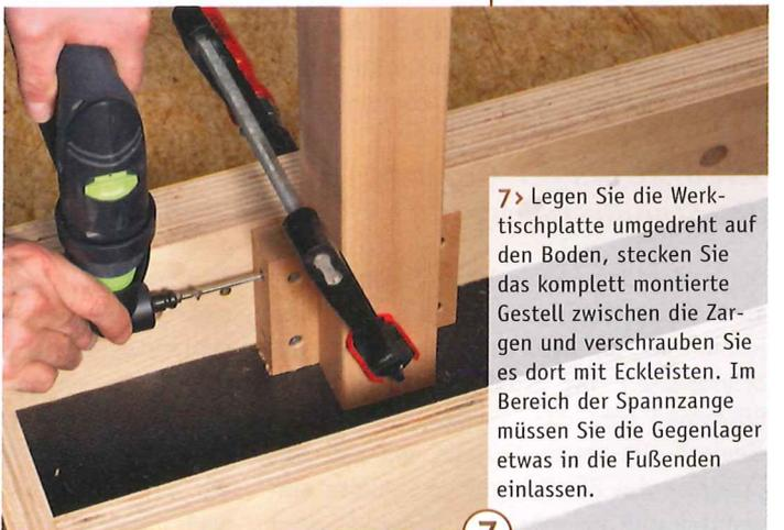
7 > Legen Sie die Werk-tischplatte umgedreht auf den Boden, stecken Sie das komplett montierte Gestell zwischen die Zargen und verschrauben Sie es dort mit Eckleisten. Im Bereich der Spannzan-gen müssen Sie die Gegenlager etwas in die Fußenden einlassen.
