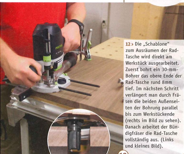
12 > Die „Schablone“ zum Ausräumen der Radtasche wird direkt am Werkstück ausgearbeitet. Zuerst bohrt ein 30-mm-Bohrer das obere Ende der Rad-Tasche rund 8mm tief. Im nächsten Schritt verlängert man durch Fräsen die beiden Außenseiten der Bohrung parallel bis zum Werkstückende (rechts im Bild zu sehen). Danach arbeitet der Bündigfräser die Rad-Tasche vollständig aus. (Links und kleines Bild).
