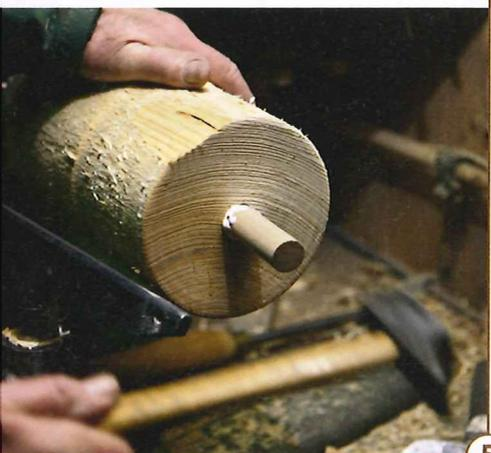
**5** > ... ein passender Dübel aus Hartholz geleimt wird. Dieser Dübel wird zunächst als Spanzapfen und später als Verbindungsdübel dienen.
