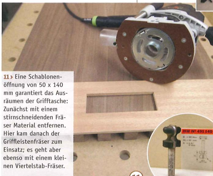
11 > Eine Schablonenöffnung von 50 x 140 mm garantiert das Ausräumen der Grifftasche: Zunächst mit einem stirnschneidenden Fräser Material entfernen. Hier kam danach der Griffleistenfräser zum Einsatz; es geht aber ebenso mit einem kleinen Viertelstab-Fräser.
