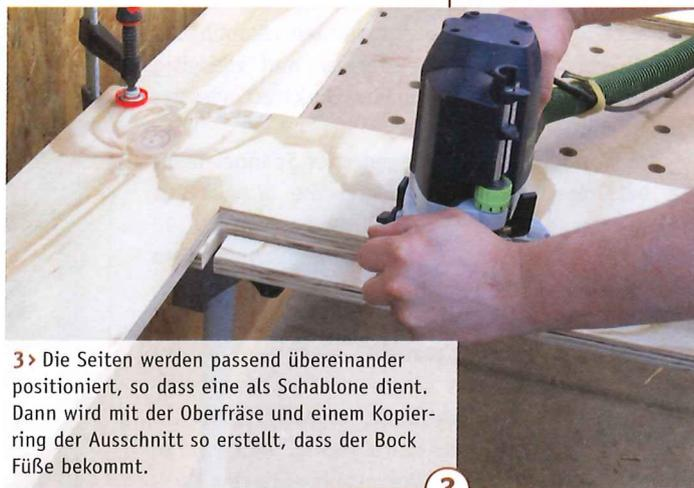
3 > Die Seiten werden passend übereinander positioniert, so dass eine als Schablone dient. Dann wird mit der Oberfräse und einem Kopier-ring der Ausschnitt so erstellt, dass der Bock Füße bekommt.
