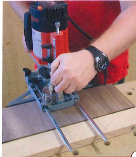
8> Auch beim Anfräsen der Zapfenlängsseiten kommt die Oberfräse zum Einsatz. Da die äußeren Kanten schon bearbeitet (abgesetzt) wurden, sind Ausrisse an den Schmalflächen kein Thema mehr. Beim Fräsen der kurzen Mittelwand ist es erforderlich, eine Halteleiste zu befestigen. So kann auch die kurze Seite bearbeitet werden.
