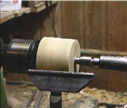
11 > Das Unterteil wird nun ebenfalls über den eingeleimten Dübel eingespannt und ...
