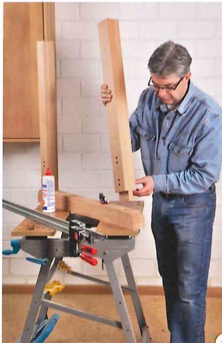
6 > Nachdem Sie in die Gestellfüße noch die Dübel- und Gewindelöcher gebohrt haben, werden Sie mit den Fußbalken verleimt. Achten Sie hier unbedingt auf die Rechtwinkligkeit der Füße zum unteren Balken.
