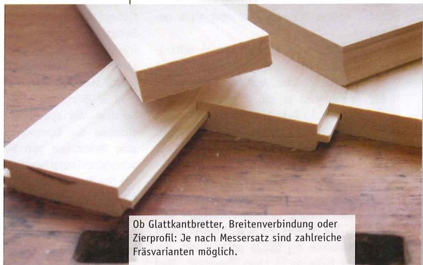
Ob Glattkantbretter, Breitenverbindung oder Zierprofil: Je nach Messersatz sind zahlreiche Fräsvarianten möglich.
