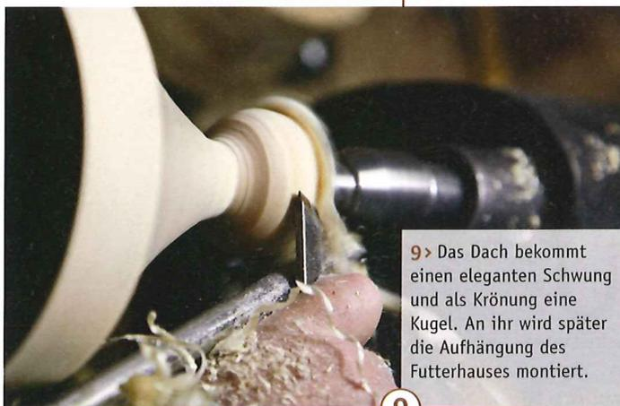
**9** > Das Dach bekommt einen eleganten Schwung und als Krönung eine Kugel. An ihr wird später die Aufhängung des Futterhauses montiert.
