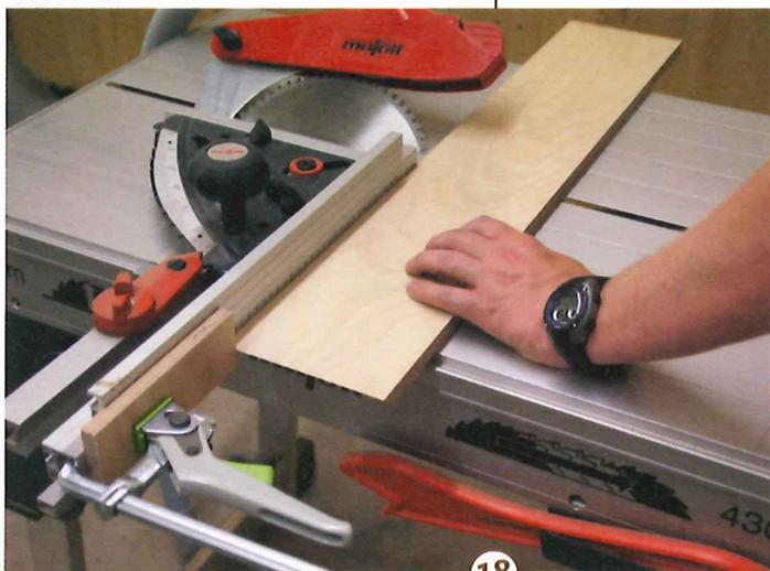
18 > Schneiden Sie die Schubladen-Teile auf Gehrung. Ein am Anschlag der Säge befestigter Klotz garantiert die gleiche Länge. Das ist wichtig, da die Kästen zusammengefaltet werden. Die folgende Falttechnik hat den Vorteil, dass keine Schnittflächen (Schmalflächen der Sperrholzplatte) zu sehen sind.
