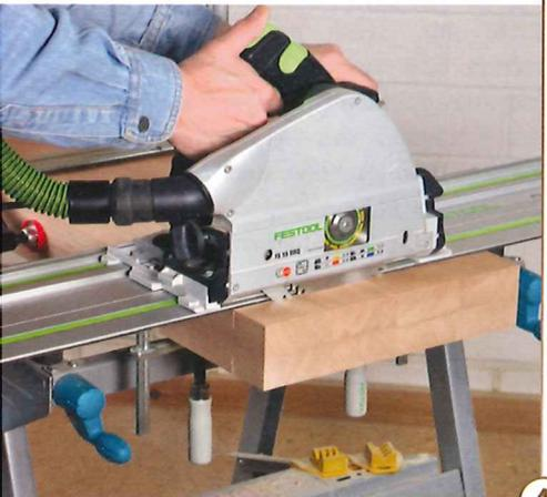
4 > ... denn in den nächsten beiden Schritten können Sie die Zapfenstärke noch genau anpassen. Dazu spannen Sie zuerst alle vier Füße zusammen und sägen mithilfe der Führungsschiene die Zapfenbrüstungen an.
