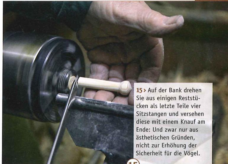
15 > Auf der Bank drehen Sie aus einigen Reststücken als letzte Teile vier Sitzstangen und versehen diese mit einem Knauf am Ende: Und zwar nur aus ästhetischen Gründen, nicht zur Erhöhung der Sicherheit für die Vögel.
