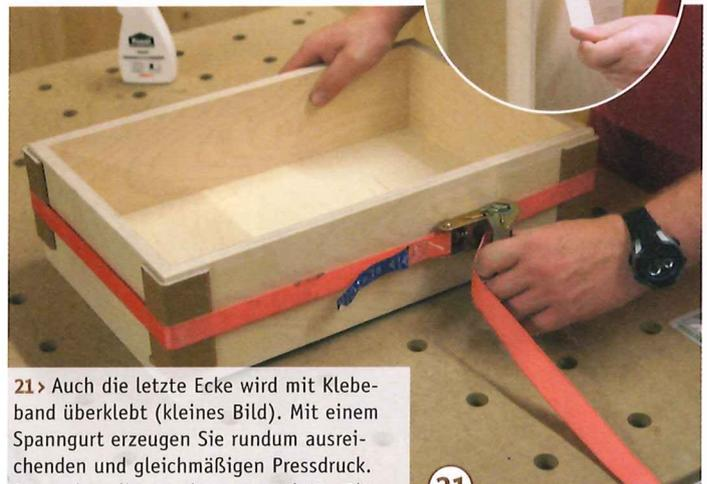
21 > Auch die letzte Ecke wird mit Klebeband überklebt (kleines Bild). Mit einem Spanngurt erzeugen Sie rundum ausreichenden und gleichmäßigen Pressdruck. Pappecken dienen als Kantenschutz. Ein weiterer großer Vorteil dieser Technik ist die hohe Winkelgenauigkeit der so gefertigten Schubladen.
