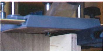
7> Nun zu den Nutzapfen als Verbinder zum Beispiel der Mittelwand mit der Tischplatte: Ein einfacher Sperrholzwinkel erleichtert ihr Absetzen. Er dient gleichzeitig als Splitterschutz gegen Ausrisse und stützt die mit einem Parallelanschlag ausgerüstete Oberfräse gegen ungewolltes Verwackeln. Achten Sie auf die Fräsrichtung ihrer Oberfräse beim Bau dieser Fräshilfe.
