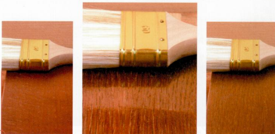
Hochglanz entsteht durch Glanzmittel und Füllstoffe im Lack: Der Pinsel spiegelt sich ganz deutlich in der gebeizten und zweimal lackierten Fläche (Mitte). Ist Mattierungsmittel im Lack, spiegelt sich nichts (links). Ein seidenmatter Glanz entsteht, wenn der Lack ein wenig Glanz- und Mattierungsmittel enthält (rechts).
