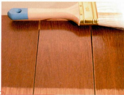
Das linke Brettchen wurde mit mattem Wasserlack, das mittlere mit seidenglänzendem Wasserlack und das rechte mit hochglänzendem Kunstharzlack behandelt.
