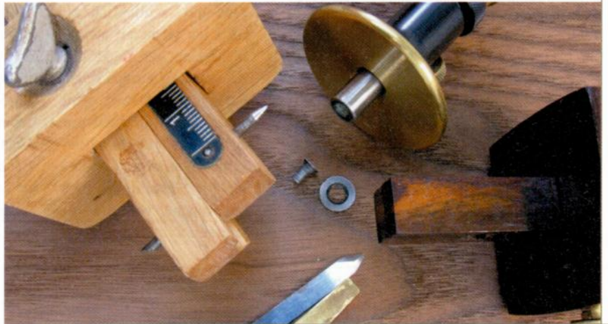
Nadel (links), Schneidrad (Mitte) oder Messerchen (unten): Streichmaße kommen in der Regel in einer dieser Varianten auf den Markt. Alle drei sollten gelegentlich auf Schärfe beziehungsweise ihre intakte Spitze überprüft werden.
