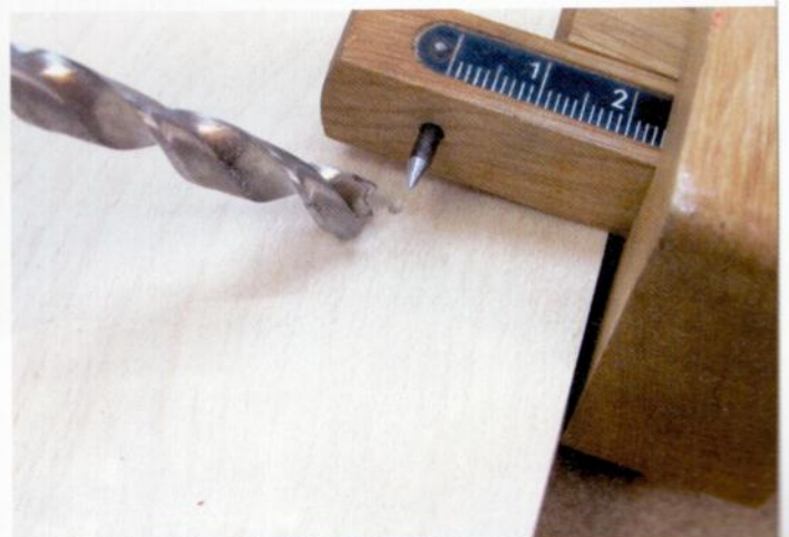
Für das Übertragen von Punkten wie hier für eine Bohrung ist ein Nadel-Streichmaß nicht von anderen Modellen zu übertreffen.
