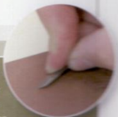
Für das Übertragen von Punkten wie hier für eine Bohrung ist ein Nadel-Streichmaß nicht von anderen Modellen zu übertreffen.
