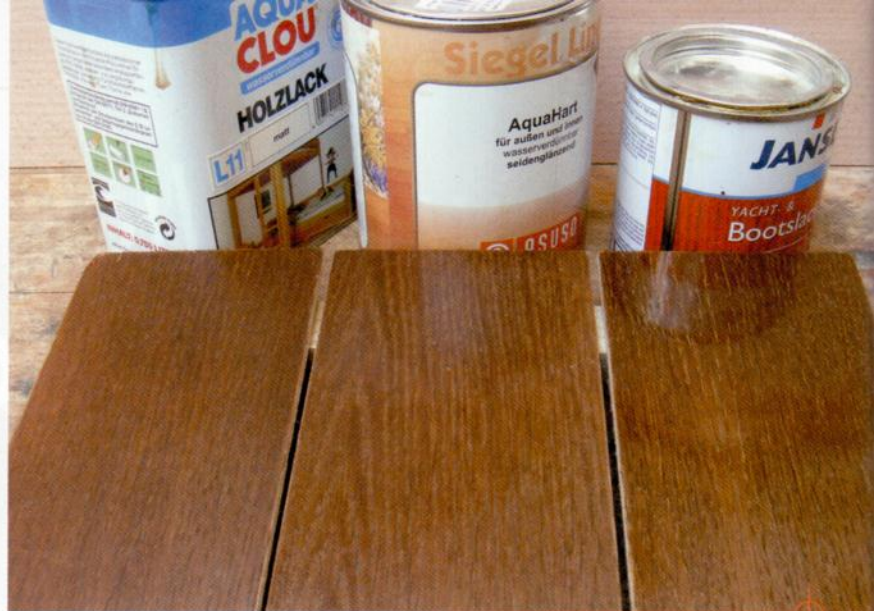
Matter, seidenglänzender und hochglänzender Lack wurden jeweils zwei Mal auf die vorher mit Eiche furnierten und gebeizten Musterbrettchen aufgetragen.
