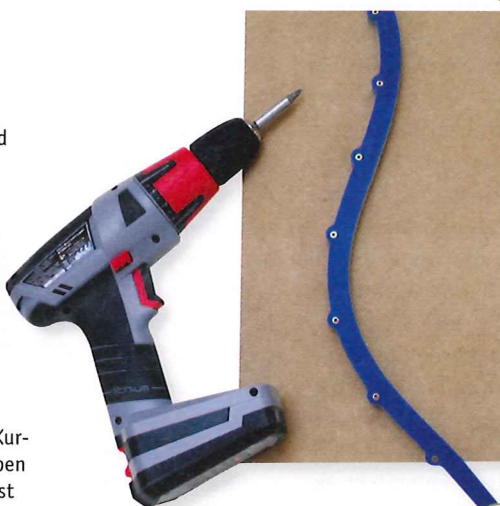
6> Alternativ zur Mutterschablone kann eine biegsame Kurvenfrässhablone (Kurvenlinfix oder Kurvenformfix) als Anschlag beim Fräsen von Schwester und Bruder dienen.
