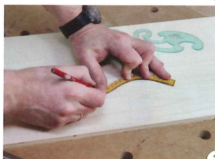
2> Beim Anreißen der Mutterschablone sind Kurvenlineale hilfreich. Üben Sie die Technik zunächst mit einfachen Formen.
