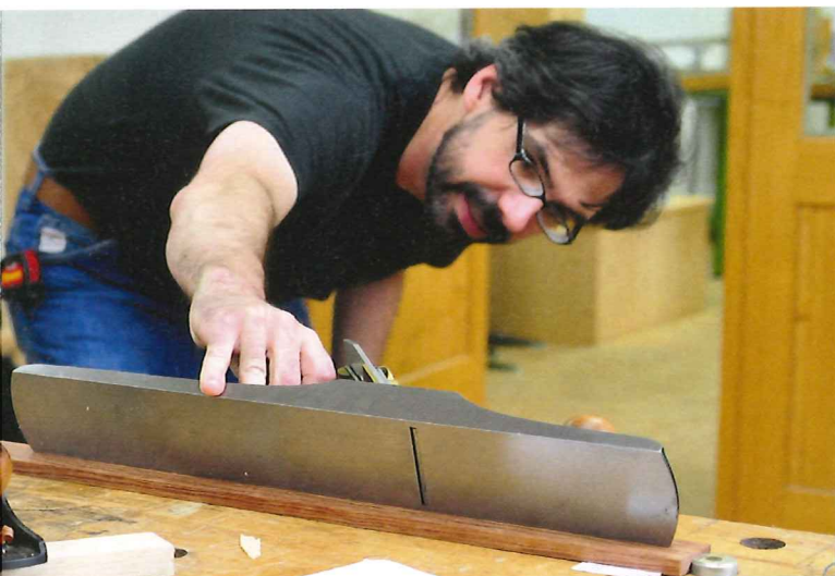
Vorgemacht: Es sind neben den wichtigen Tipps die kleinen Kniffe, die Schwarz verrät: Etwa, einfach mit der aufgesetzten Kante der Raubank die Geradlinigkeit des Holzes zu testen.
