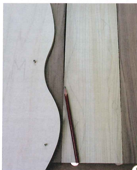
8> Mit Hilfe der Mutterschablone werden die Konturen auf dem Material angezeichnet und ...
