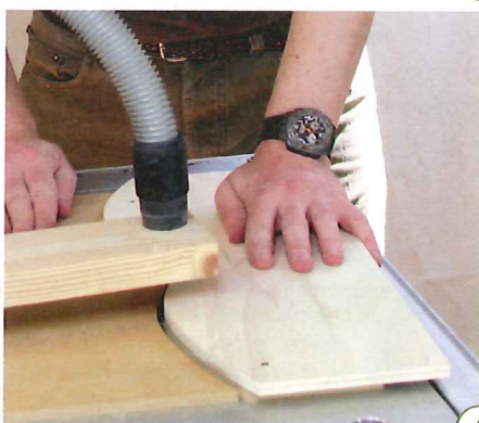
4> An der unter dem Tisch montierten Oberfräse lässt sich diese Technik exakt und sicher ausführen.
