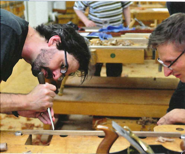
Einer hartnäckigen Stelle voller Ausrisse begegnet Schwarz mit einem Stechbeitel: Schabend werden die Fasern geglättet. Unbeobachtet bleibt er an seiner Werkbank praktisch nie.
