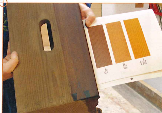
Nicht erschrecken: die getrocknete Beize wirkt stumpf und gräulich; sie erhält erst durch das Überzugsmittel den endgültigen Farbton (hier an der rechten Kante des Bänkkens).
