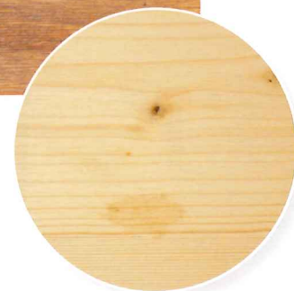
Beizfehler II: Leimflecken sind auf dem unbehandelten Holz kaum zu sehen (kleines Bild), aber die Beize bringt sie dann ans Licht!
