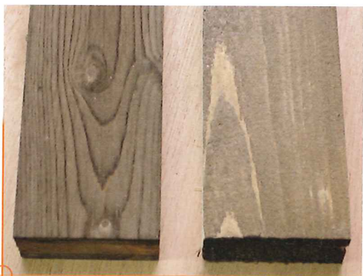
Das linke Brettchen wurde mit einer Positivbeize, das rechte mit einer einfachen Farbstoffbeize behandelt. Letztere verkehrt die natürliche Maserstruktur ins Gegenteil, das Beizbild wird negativ.
