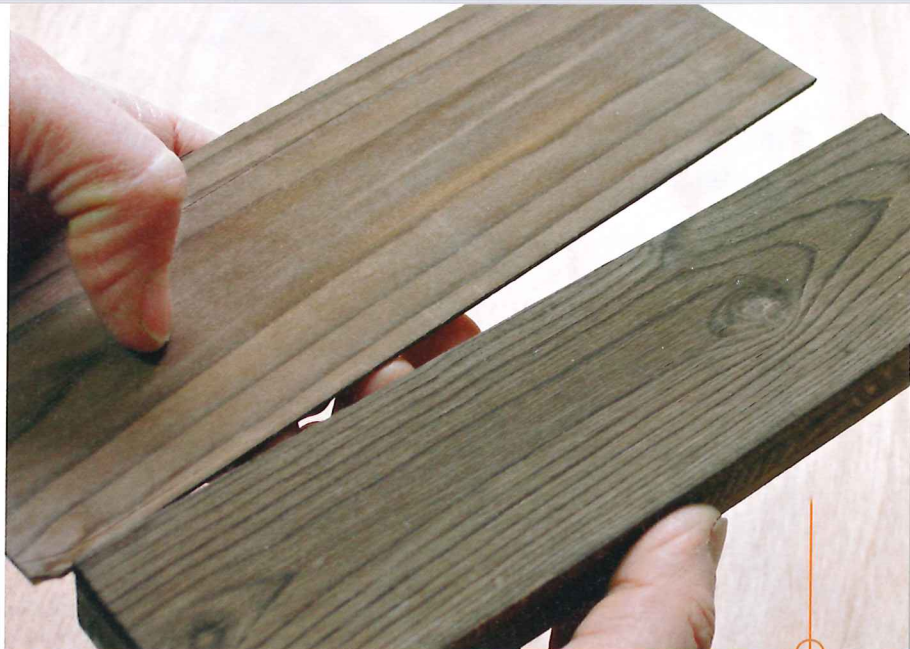
Dieselbe Positivbeize wirkt auf Massivholz anders als auf einem Furnier derselben Holzsorte! Das hat Konsequenzen für Möbel, die aus beiden Materialien bestehen. Hier sollte mit unterschiedlichen Konzentrationen der gleichen Beize gegengesteuert werden.
