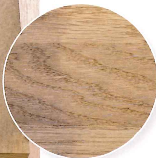
Beizfehler I: Wenn man den Beizvorgang unterbricht, ist der Übergang später nicht zu verstecken (großes Bild). Im kleinen Bild wurde der Beizüberschuss nicht ordentlich „vertrieben“, also mit leerem Schwamm oder Pinsel aufgenommen.
