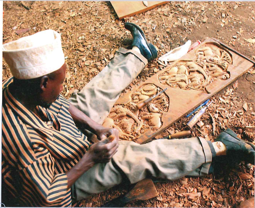
Spannvorrichtungen kommen nicht zum Einsatz: Das Körpergewicht des Schnitzers hält das Werkstück fest.
