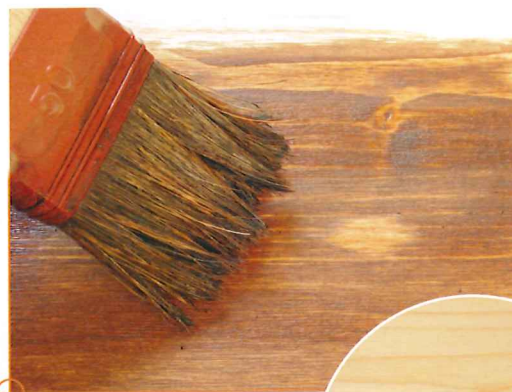
Beizfehler II: Leimflecken sind auf dem unbehandelten Holz kaum zu sehen (kleines Bild), aber die Beize bringt sie dann ans Licht!
