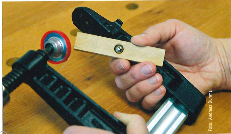
Ein schräg eingebohrter und eingepresster Kugelmagnet auf Neodym-Basis hält auch ein 5 x 10 Zentimeter großes Multiplex-Stück als Zulage an der Zwingen.
