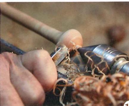
19 > Der Stiel wird erst mit der flachen Röhre und dann mit dem Meißel präzise auf 12 mm Stärke geschlichtet und auf insgesamt 100 mm gekappt. Der kleine Rest des Holzes im Futter wird noch nicht ausgespannt.
