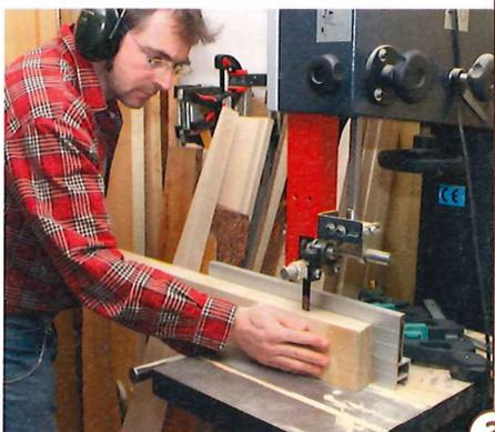
3 > Die Seitenwände werden mit der Bandsäge mittig aufgesägt und dann spiegelbildlich zusammengeleimt.
