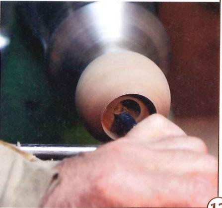
12 > Jetzt kann mit dem Ausdrehen des Mörsers gestartet werden. Als nützliches Werkzeug hat sich hier ein Tassenstahl erwiesen. Wichtig ist, dass der Boden wirklich sauber konkav ist und in der Mitte kein „Knubbel“ stehen bleibt. Der würde nämlich ein Zerquetschen der Körner durch den Stempel des Stößels vereiteln (siehe Zeichnung).
