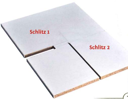
1 > Einfach, schnell und sehr präzise: Kreise aussägen mit einer zweifach geschlitzten Platte.
