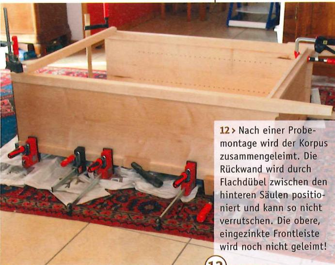
12 > Nach einer Probe-montage wird der Korpus zusammengeleimt. Die Rückwand wird durch Flachdübel zwischen den hinteren Säulen positioniert und kann so nicht verrutschen. Die obere, eingezinkte Frontleiste wird noch nicht geleimt!
