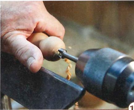
17 > Mit einem 12-mm-Forstner wird die Kugel 10 mm tief gebohrt und danach abgetrennt, wobei die Oberfläche auf der der Bohrung abgewandten Seite nicht perfekt sein muss.
