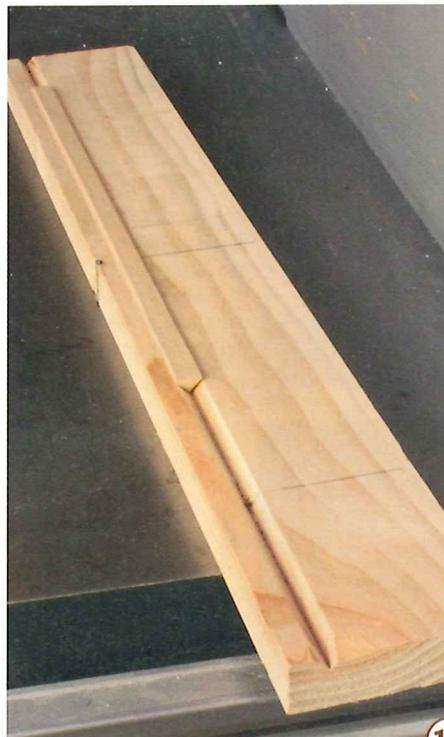
16 > Die Leisten für die Füllungen werden quad-ratisch gehobelt und dann mit Hilfe eines Brettes mit V-Nut im Dickenhobel mit einer Fasse versehen.
