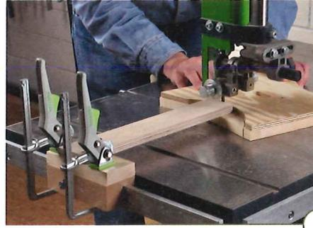
3 > Außerdem sollte sich das Sägeblatt zwei Millimeter tief in der Auskerbung befinden. Dadurch entsteht immer ein kleiner Überstand zur Schablone, der anschließend mit der Oberfräse und einem Bündigfräser entfernt wird.
