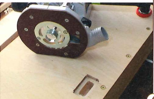
4 > Mit der Oberfräse werden die Schlitz für die untere Frontleiste in die Säulen gefräst. Eine alte Vorrichtung war vorhanden, nur die Positionierung zur Kante stimmte nicht. Durch einen aufgeklebten Sperrholzstreifen wurde die Position korrigiert.
