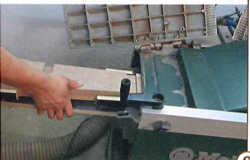
9 > Das Werkstück wird, fest in der Schablone liegend, durch die Dickenhobelmaschine geschoben. Bei den ersten Hobelgängen greifen die Vorschubwalzen noch nicht. Daher kommt es hierbei zu kräftigen Hobelschlägen, die jedoch bei den weiteren Hobelgängen wegfallen.
