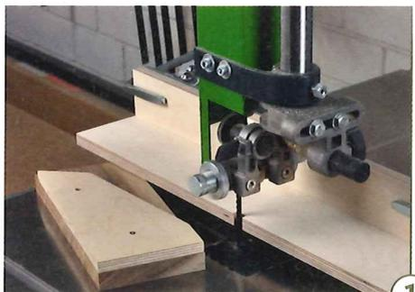
1 > Befestigen Sie zuerst das Winkelbrett mit zwei Hebelzwingen so am Parallelanschlag, dass sich das Sägeblatt innerhalb der kleinen Auskerbung an der Kante befindet.
