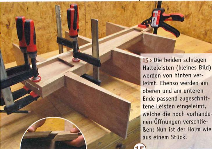
15 > Die beiden schrägen Halteleisten (kleines Bild) werden von hinten verleimt. Ebenso werden am oberen und am unteren Ende passend zugeschnittene Leisten eingeleimt, welche die noch vorhandenen Öffnungen verschließen: Nun ist der Holm wie aus einem Stück.
