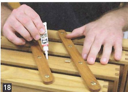
direkt danach mit einem Lappen entfernen. Nachdem das Öl getrocknet ist, erfolgt der zweite Ölauftrag. Schrauben Sie die einzelnen Ablagen mit den Scherenleisten zusammen. Achten Sie darauf, dass alle Schrauben so sitzen, dass die Holzteile nicht zusammengepresst werden. Die Stoppbolzen werden abschließend in das vorge-sehene Loch eingeklebt.
