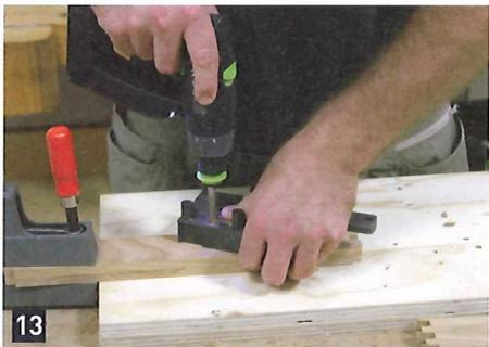
Zeichnen Sie die Positionen der Löcher für die Drehpunkte und die Stoppbolzen auf den Seiten und auf den Scherenleisten (Pos. 4) an und bohren Sie sie. Die Seiten einer Ablage können Sie zum Bohren zusammenspannen. Mit einer Dübelschablone oder einem Bohrständer wird sichergestellt, dass die Löcher genau rechtwinklig gebohrt werden. Senken Sie die Löcher
