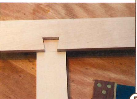
5 > Mit der Vorrichtung (siehe Kasten) wird ein Schwalbenschwanz gefräst, der als Schablone zum Anzeichnen auf die oberen Frontleisten dient.
