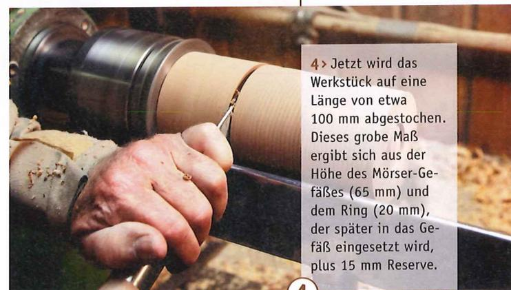
4 > Jetzt wird das Werkstück auf eine Länge von etwa 100 mm abgestochen. Dieses grobe Maß ergibt sich aus der Höhe des Mörser-Gefäßes (65 mm) und dem Ring (20 mm), der später in das Gefäß eingesetzt wird, plus 15 mm Reserve.
