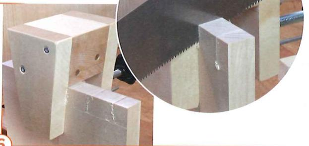
gen werden, die Schrauben sorgen für eine präzise Positionierung der Seitenwände. In der Hinterzange wird die Führung dann gespannt (Bild 5). So werden die 8-mm-Bohrungen für die Magneten an den Führungsflächen gebohrt und die Magnete mit Sekundenkleber eingeklebt. Wichtig: Sie dürfen nicht aus der Fläche herausragen, sondern sollten einen halben bis einen Millimeter zurückgesetzt werden.
