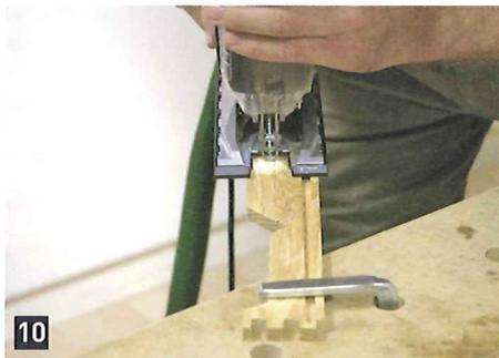
Übertragen Sie jetzt die Kontur auf die Fronten und schneiden Sie auch diese mit Fräszugabe aus. Spannen Sie die Schablone auf dem MFT fest und legen Sie die erste Front ein. Die Fräse so einstellen, dass das Kugellager genau auf der Schablone läuft. Fräsen Sie zunächst die erste Seite der Front und drehen Sie sie dann, um die zweite Seite zu fräsen. Wenn es zu
