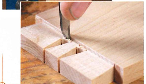
Die Reste entfernt grob eine Laubsäge. Schneller geht das wirklich kaum (Mitte). Lassen Sie nur etwa einen Millimeter zum Sauberstechen stehen. Stechen Sie von beiden Seiten, beginnend außen. Auf der Innenseite geleitet die Falzbrüstung den Stechbeitel (unten).
