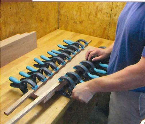
5 > Nach beiden Schrägschnitten am Wandholm, wird dieses Teil außen in der Dicke verstärkt (aufgedoppelt). Es werden zwei Leisten, 20mm breit und 15 mm dick an der Rückseite aufgeleimt. Die Leisten können dabei ruhig ein wenig überstehen. Diese Überstände werden nach dem Aushärten mit der Handsäge und einem Handhobel entfernt.
