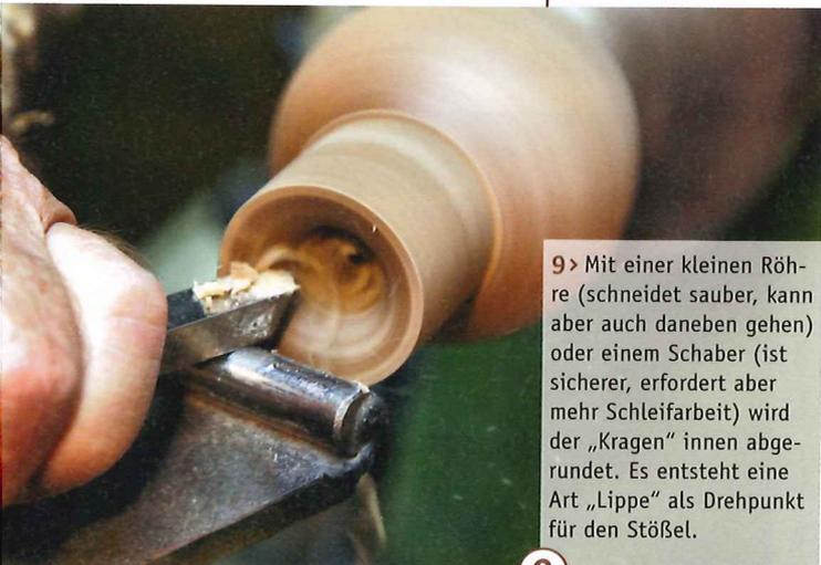
9 > Mit einer kleinen Röhre (schneidet sauber, kann aber auch daneben gehen) oder einem Schaber (ist sicherer, erfordert aber mehr Schleifarbeit) wird der „Kragen“ innen abgerundet. Es entsteht eine Art „Lippe“ als Drehpunkt für den Stößel.
