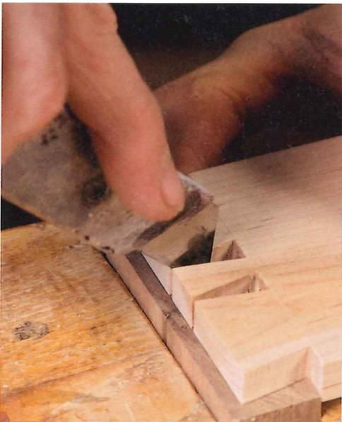
Übertragen Sie die Schwalbenschwänze: Spannen Sie die Schubkastenfront in die Hobelbank-Zange und schieben Sie die gefälzte Seite darüber. Die Seite verrutscht nicht und die Übertragung per Messer wird haargenau (oben). Zeichnen Sie so auch gleich die Länge an, das wird genauer, als hier das Streichmaß zu nehmen (unten).
