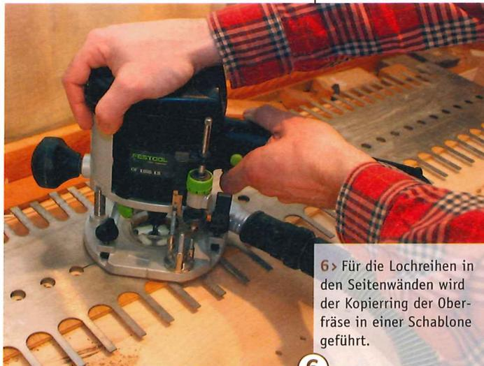
6 > Für die Lochreihen in den Seitenwänden wird der Kopiering der Oberfräse in einer Schablone geführt.
