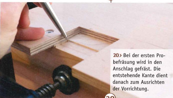
20 > Bei der ersten Pro-befräsung wird in den Anschlag gefräst. Die entstehende Kante dient danach zum Ausrichten der Vorrichtung.
