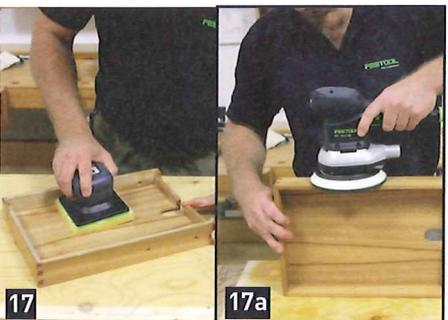
ter mit einer selbstverschließenden Öffnung, unter dem ein auswechselbarer Schwamm montiert ist. Wenn Sie jetzt auf den Behälter drücken, wird das Öl direkt auf die Fläche aufgetragen und mit dem Schwamm verteilt. Nach circa 15 Minuten Einwirkzeit wird es mit dem grünen Schleifvlies eingeschleift. Der entstehende Schleifstaub und das überschüssige Öl
