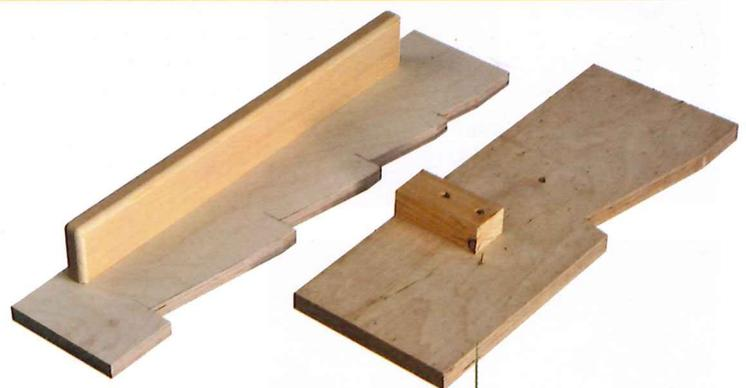
1 > Ob Ihre Keil-Schneidlade für eine (rechts) oder für mehrere (links) Keilgrößen gemacht ist, entscheiden Sie. Auf jeden Fall ist ein Klotz oder eine Leiste für den guten Griff sinnvoll.
