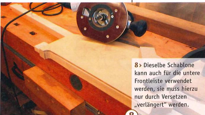
8 > Dieselbe Schablone kann auch für die untere Frontleiste verwendet werden, sie muss hierzu nur durch Versetzen „verlängert“ werden.
