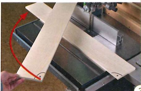
3 > Im nächsten Schritt drehen Sie das untere Brett einmal um 180°, so dass sich das rechte Ende mit der Markierung danach links befindet.
