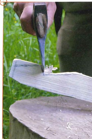
Das roh gesplattene Hartholz wird zu nächst mit kräftigen Schlägen in die konisch-rechtwinklige Grundform gebracht. Zum exakten Einkerbten des Leinenhakens wird der Absetzschnitt verwendet: Das Werkstück wird zusammen mit der am Riss angesetzten Beilklinge auf den Hauklotz geschlagen.
