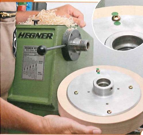
5> Entnehmen Sie die Schraube wieder und entfernen Sie die erste Planscheibe. Jetzt wird die zweite, 180 mm große Planscheibe in ihrem Sitz mit vier Holzschrauben befestigt und zur Fertigstellung der Vorderseite des Futters auf die Drechselbankspindel geschraubt. Der grüne Gegen-Punkt auf der Planscheibe sorgt dafür, dass diese immer wieder gleich aufgeschraubt wird.
