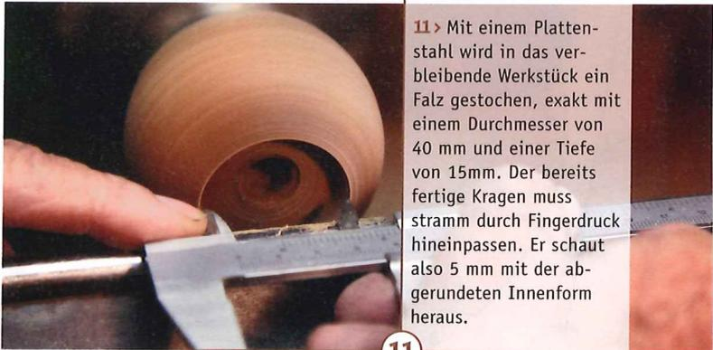
11 > Mit einem Plattenstahl wird in das verbleibende Werkstück ein Falz gestochen, exakt mit einem Durchmesser von 40 mm und einer Tiefe von 15 mm. Der bereits fertige Kragen muss stramm durch Fingerdruck hineinpassen. Er schaut also 5 mm mit der abgerundeten Innenform heraus.
