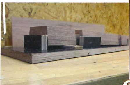
8 > Der Wandholm wird nun auch in der Fläche schräg ausgearbeitet. Das untere, breite Ende soll dicker bleiben als das obere, schmale Ende. Diese flächige Schräge wird mit der Dickenhobelmaschine erzeugt, indem eine Vorrichtung ein Ende anhebt.
