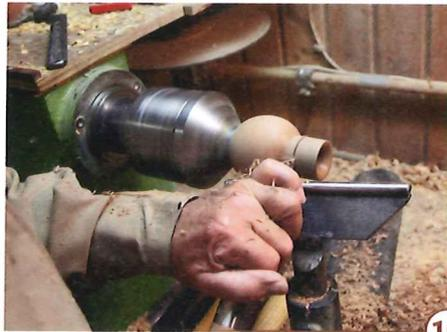
10 > Jetzt wird der Kragen genau auf eine Länge von 20 mm abgetrennt. Kurz vor dem Durchtrennen die Drehzahl reduzieren und den Ring mit einer Hand stützen und auffangen.
