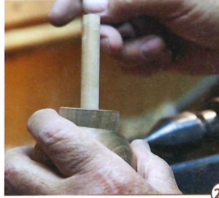
20 > Ein kleiner Test zur Kontrolle zwischendurch: Der Stößel wird durch den Kragen geschoben und beide dann, Stempel voraus, in den Mörser gesteckt. Herausziehen lässt sich der Stößel nun nicht mehr.
