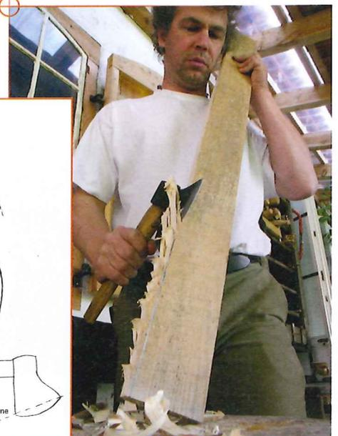
Auch in der Schreinerwerkstatt hat das Beil seinen Platz. Nachdem zuerst mit steilen Schlägen vorgekerbt wurde, wird das Brett mit einem Breitbeil besäumt. Dies geht deutlich schneller als mit der Handsäge.
