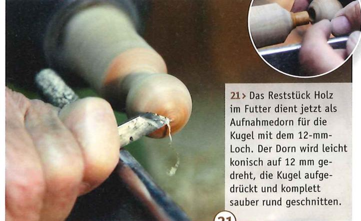
21 > Das Reststück Holz im Futter dient jetzt als Aufnahmedorn für die Kugel mit dem 12-mm-Loch. Der Dorn wird leicht konisch auf 12 mm gedreht, die Kugel aufgedrückt und komplett sauber rund geschnitten.
