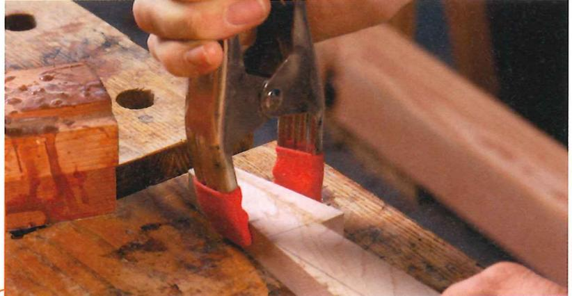
Leimen Sie den Stopper an. Platzieren Sie ihn am schmalen Ende, das Richtung Blatt weist. So kann die Vorrichtung Seiten jeder Länge aufnehmen.
