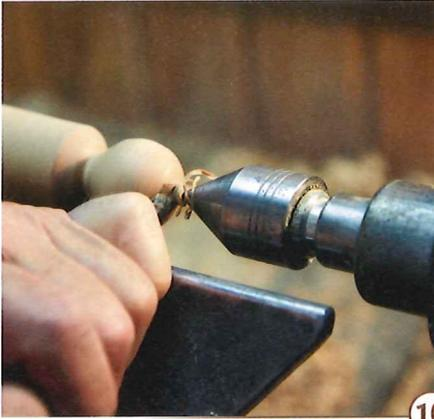
16 > An der rechten Seite des zylindrischen Langholzes wird eine Kugel mit einem Durchmesser von etwa 32 mm gedreht, die bis auf die linke Seite perfekt rund ist. Für die folgende Bohrung wird ein kleines Zentrierloch gestochen. Übrigens: Wie Sie eine perfekte Kugel drechseln, haben wir in *HolzWerken* März/April 2009 demonstriert.
