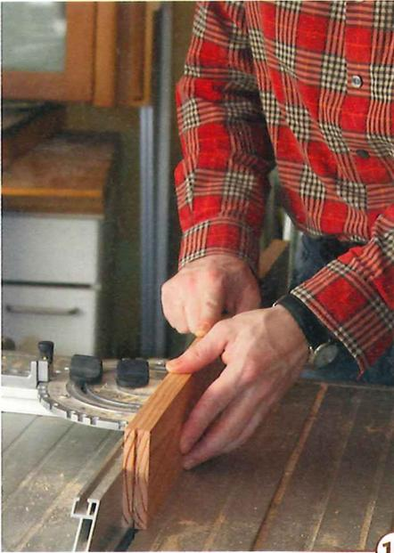
10 > Die Nuten in den Rückwand-Rahmenteilen können mit der Tischkreissäge gesägt werden.
