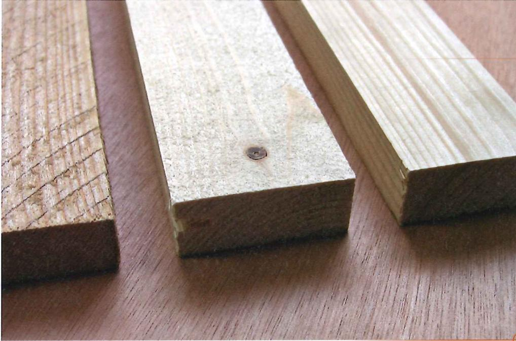
Die Struktur bestimmt das Ergebnis, hier ein kleiner Test: Fichtenholz sägerau, grob und fein geschliffen von links nach rechts.
