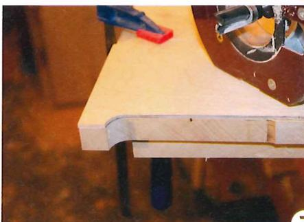
7 > Mit doppelseitigem Klebeband wird die Sperrholzsablone für die Radien (R15) an der Unterkante der Seitenwände aufgeklebt und die Kontur mit einem Bündigfräser gefräst.
