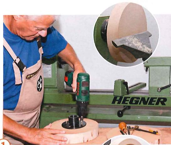
2 › Jetzt wird eine andere Planscheibe, die nur wenig kleiner als das angestrebte Fertigmaß des Schraubfutters ist, auf der Stirnfläche des Rohlings etwa 4 mm tief passgenau eingelassen. Ein kleines Stahllineal prüft zwischendurch, ob innen alles plan ist.
