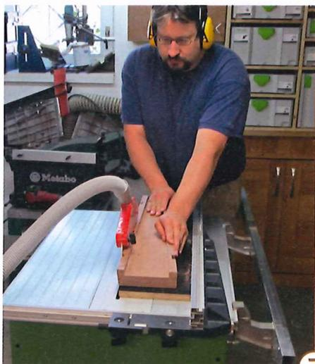
7 > Erst nachdem die Nuten fertig sind, werden auch die Längskanten des Wandholmes (von „oben“ gesehen) mit 5° abgeseigt. Wir machen das hier, indem wir das Werkstück erneut auf die Siebdruckplatte aufkleben und den Schnitt am Parallelanschlag ausführen. Per Handhobel geht's ebenso gut.
