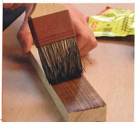
Fein geschliffen erscheint ein einheitliches Beizbild. Deutlich erkennbar ist, dass diese Oberfläche am wenigsten Oberflächenmittel (und hier damit weniger Farbstoff) aufnimmt.
