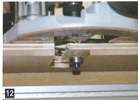
sind, werden die Teile auseinander geschnitten. Die Aussparung in den Böden können Sie entweder auch fräsen oder einzeln mit Forstnerbohrer und Stichsäge herstellen. Zum Fräsen wird eine Schablone aus Hartfaser hergestellt, die mit Zwingen unter den Boden gespannt wird. Mit dem gleichen Bündigfräser wie zuvor werden jetzt die Ausfräsungen hergestellt.
