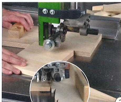
2 > Das Schneiden ist dann fast ein Kinderspiel: Spitze voraus, schneiden und das Holz jedes Mal umdrehen. Die Anschlagsschiene ist flach, so dass die Hand Platz hat, und steht so, dass die Vorrichtung des Sägeblatt nicht berührt.
