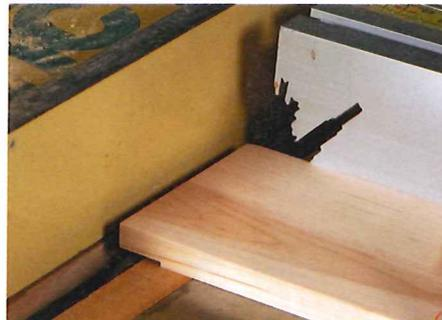
Falzen für eine gute Passung: Sägen oder fräsen Sie einen flachen Falz an die Innenflächen der Seiten, genau bis zur Risslinie. Das erleichtert das Ausrichten später beim Anreißen der Zinken an Front und Rücken.
