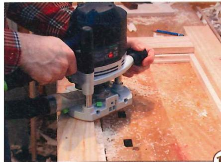
15 > Der Falz für die Tür-füllungen wird mit einem einfachen aufgespannten Rahmen als Führung für den Bündigfräser gefräst.
