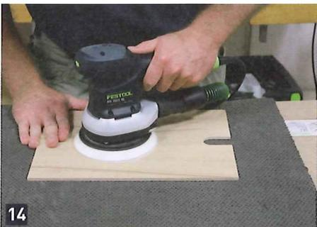
mit einem Querlochsenker so stark, dass die Schraubenköpfe exakt im Holz sitzen. Schleifen Sie jetzt die Innenflächen der Ablagen und die Böden mit einem Exzenterschleifer, letzter Schliff Körnung P180. Tragen Sie Leim auf den Fingerzinken und in der Nut auf und stecken Sie die Ablagen zusammen. Verspannen Sie die Verbindungen mit Zwingen. Es ist wichtig, dass
