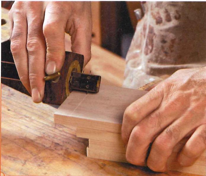
Reißen Sie die Länge der Schwalbenschwänze an. Verwenden sie am besten ein Streichmaß mit einer Klinge, um alle vier Flächen anzureißen; erledigen Sie dies an allen vier Seiten. Übrigens wurde das Nadel-Streichmaß im Bild in eines mit Klinge verwandelt, indem eine Fasse an die Nadel angefeilt wurde.
