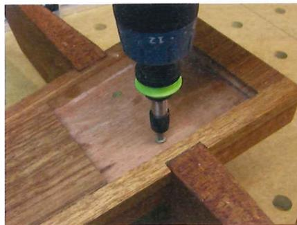
17 > Nach erfolgter Oberflächenbehandlung (hier: geölt) werden die Regalböden mit je drei Schrauben von hinten am Wandholm befestigt. Dafür werden die beiden Halteleisten an der Wand befestigt. Dann werden Sie mit einer unsichtbaren Halterung belohnt.
