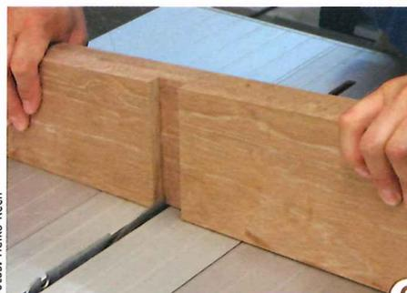
6 > Die Nuten vorne im Holm müssen nun auch um die aufgedoppelte Kante herum eingebracht werden. Auch diese Nuten können problemlos mit mehreren Schnitten auf der Tischkreissäge erstellt werden. Beachten Sie hierbei die notwendige Schräge am Sägeblatt.
