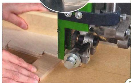
3 > Eine Unterlegplatte verhindert, dass sehr kleine Keile zwischen Blatt und Tischeinlage geraten. Sie wird zuerst mit dem Sägeblatt eingesägt und darf nicht verrutschen.
