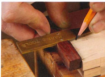
Reißen Sie nun die Schwalben an. Und das nur auf einem der beiden Enden! Sie nutzen dieses Brett, um alle anderen auf der Säge auszurichten.
