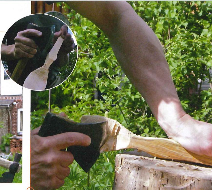
Wenn Werkstück und Faserverlauf vorgeben, dass vom Ende des Werkstücks geschnitten werden muss, wird das Werkstück liegend gehalten und vor dem Hauklotz bearbeitet. Das Beil wird dabei im Präzisionsgriff geführt zur Verlängerung der Hand. Die Löffel-Form wird, bis auf die Höhlung, komplett mit dem Beil angelegt (kleines Bild). Das spart viel Zeit!
