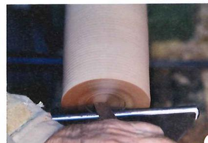
3 > Nach dem sicheren Fixieren mit dem Futter wird „fliegend“ ein Innen-Rezzess zum Spreizen gedreht. Er ist zugleich der Fuß für den Mörser-Körper.
