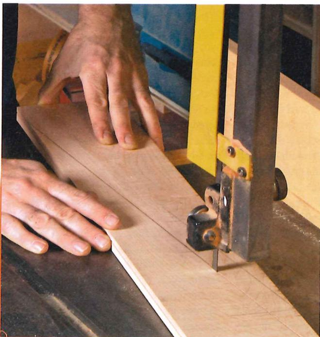
Schrägen Sie die Vorrichtung ab, so dass sie zu den Schwalben passt. Sie wird eine Handbreit länger als die Seite.
