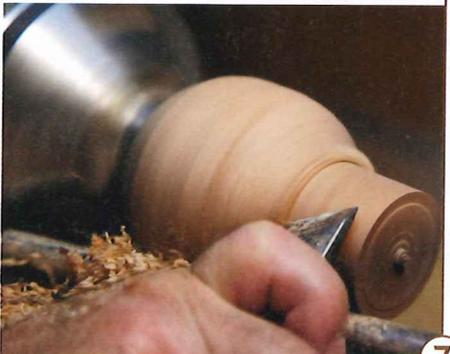
7 > Ab jetzt muss zehntel-millimetergenau gearbeitet und immer wieder gemessen werden. Es kommt darauf an, einen zylindrischen „Kragen“, also einen Ring von genau 40 mm Durchmesser zu drehen. Er wird zunächst 25 mm lang.
