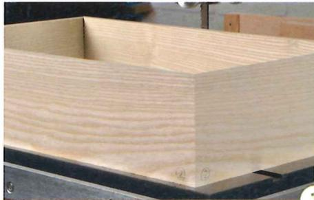
3 > Bei einem Kasten ist eine umlaufende Maserung ein Hingucker (Bild). Dazu genau in der Mitte auftrennen und wie ein Buch aufschlagen.
