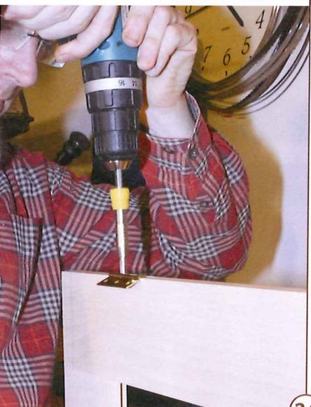
24 > Damit die Bohrungen mit dem Beschlag fluch-ten, gibt es im Fachhandel einen nützlichen Be-schlagbohrer. Der Bohrer wird durch einen kegligen Anschlag genau mittig in der angesenkten Beschlag-bohrung geführt.
