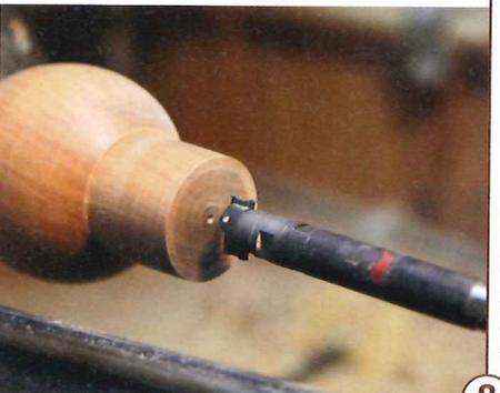
8 > Mit einem im Reitstock gespannten Forstnerbohrer (16 mm) wird ein 60 mm tiefes Loch gebohrt.
