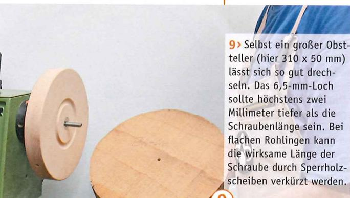
9> Selbst ein großer Obstteller (hier 310 x 50 mm) lässt sich so gut dreheln. Das 6,5-mm-Loch sollte höchstens zwei Millimeter tiefer als die Schraubenlänge sein. Bei flachen Rohlingen kann die wirksame Länge der Schraube durch Sperrholzscheiben verkürzt werden.
