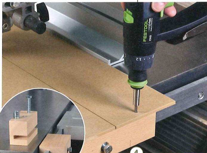
4 > Die Hartfaser- oder Sperrholzplatte wird daher am Rand fixiert. Das geht besonders gut bei einem umlaufenden Tischprofil wie hier. So lassen sich Hilfsleisten mit eingedrehter Gewindemuffe und M8-Schraube blitzschnell befestigen.
