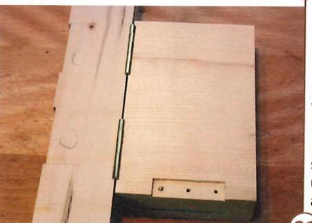
21 > Überprüfen Sie die Vorrichtung, indem Sie an Reststücken probefräsen. Bauen sie ein Paar Be-schläge tatsächlich ein und begutachten Sie vor allem das Spaltmaß.
