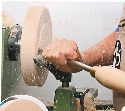
6> Drehen Sie die Stirnseite (Vorderseite des Futters) mit einer 6/13 mm-Schalenröhre plan und arbeiten mit einem leicht geneigten Flachstahl (Schaber) etwas nach. Das von hinten gebohrte Loch für die Spezialschraube sollte bei genauer Arbeit jetzt sichtbar sein.
