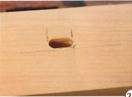
28 > Mit der Oberfräse werden die Nuten in das Bodenbrett und die obere Frontleiste gefräst. Jetzt kann die obere Frontleiste geleimt werden.
