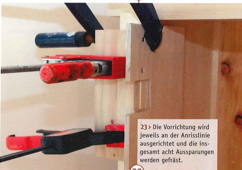
23 > Die Vorrichtung wird jeweils an der Anrisslinie ausgerichtet und die ins-gesamt acht Aussparungen werden gefräst.
