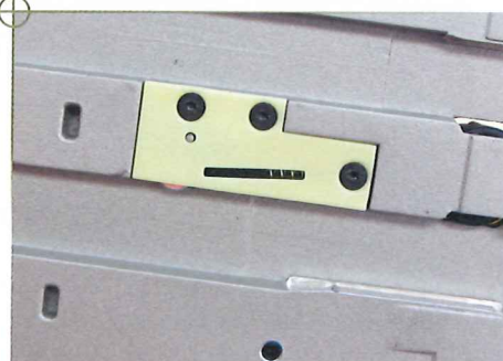
Der integrierte Rückschlagstopp der DWS520 macht das Eintauchen sehr sicher.
