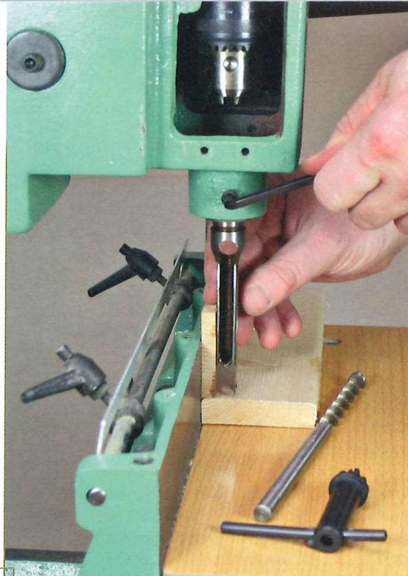
Die Montage von Meißel und Bohrer ist schnell erledigt. Das Ausrichten des Stemm-Meißels mit Hilfe einer Zulage schon die Meißelspitzen. Der Schneckenbohrer sollte ca. 0,8 bis 1,5 mm über die Spitzen des Stemm-Meißels heraus schauen.
