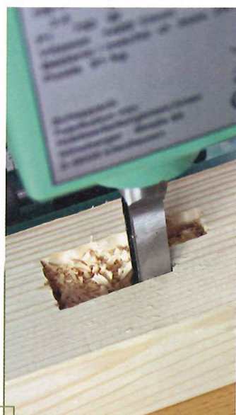
Mit mehreren Reihenbohrungen nebeneinander lassen sich auch mit kleineren Meißeln dickere Löcher stemmen. Mit einer passend gewählten Grundausrüstung können alle Schlitz- und Langlöcher gefertigt werden.
