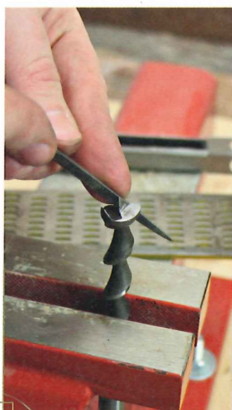
Das Nachschärfen des Schneckenbohrers ist keine Kunst: nur die Flanken an seinem Kopf müssen geschärft sein, der restliche Bohrer dient lediglich zum Abtransport der Späne.
