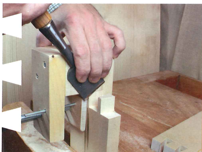
Genau, wie Sie es brauchen: Zinkenhilfen im Eigenbau
