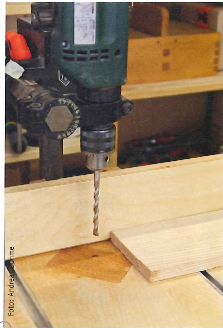
Die um 45° zur Plattenvorderkante gedrehte (hier rötlich) Einlegeplatte bietet dem unter den Bohrpunkt geschobenen Werkstück keine lästige Kante zum Hängenbleiben.
