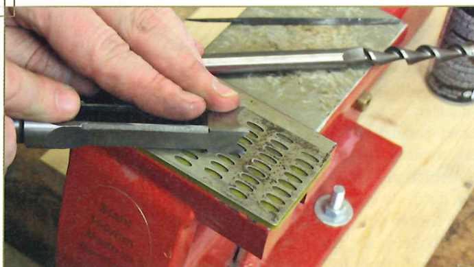
Das Schärfen des Meißels ist viel seltener nötig, als man denkt: eventuell vorhandene Grate werden außen abgezogen.
