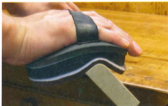
Das Schleifen von Profilen per Hand ist oft eine mühsame Angelegenheit. Mit einem weichen Schleifteller lassen sich einfache Rundungen auch per Maschine angehen. Ein Handpad schont die Haut und beugt Ermüdungen der Hand vor.
