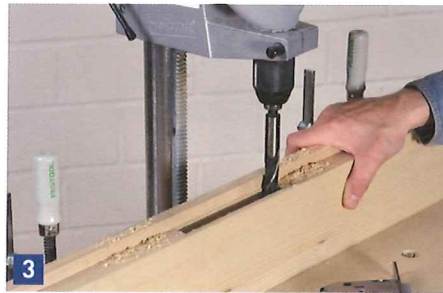
Den Rest entfernen Sie mit einem 16 mm Bohrer auf einem Bohrständler, indem Sie mehrere Löcher nebeneinander bohren und alles mit einem langen Stechbeitel nacharbeiten.
