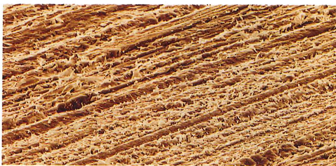
Holzstruktur nach dem Schliff mit Siliziumcarbid.
