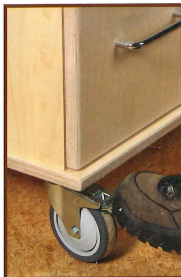
Highlight 7: Mobil durch Lenkrollen, stabil durch Totalfeststeller
