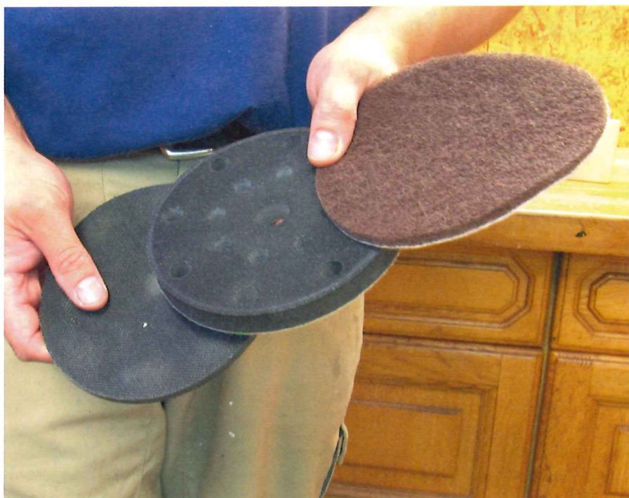
Ein so genanntes Interface-Pad wird zwischen den Schleifteller und das Schleifpapier geheftet und sorgt für einen noch schonenderen Schleifvorgang.
