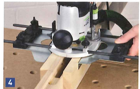
Den 20 mm breiten und etwa 3 mm dicken Stulp fräsen Sie am besten mit einem 20 mm Nutfräser und doppeltem Parallelanschlag ein. Dabei wird der Rahmen quasi eingeklemmt.
