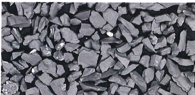
400-fache Vergrößerung: Aluminiumoxid unter dem Mikroskop.
