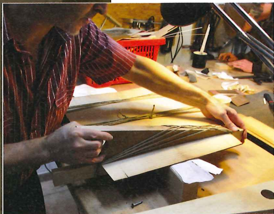
Böden und Decken werden mit Keilen, Packschnur und viel Geschick verleimt.
