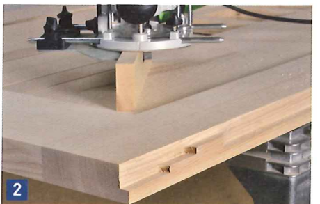
Den restlichen Falz (25 mm hoch und 13 mm tief) fräsen Sie mit der handgeführten Oberfräse samt Parallelanschlag und einem großen Nutfräser in mehreren Etappen heraus.
