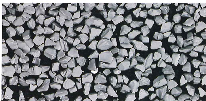
Siliziumcarbid in der 400-fachen Vergrößerung.
