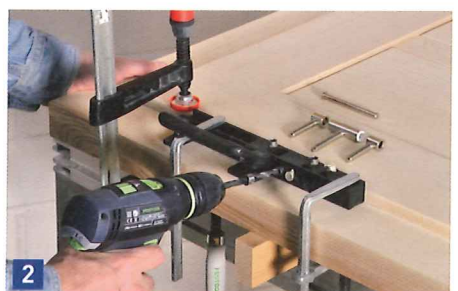
Benutzen Sie in jedem Fall die zum Einbohrband passende Bohrlehre und versuchen Sie auf keinen Fall durch bloßes Anzeichnen die Löcher zu bohren. Das geht garantiert schief!
