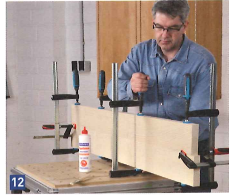
... hobeln), gleichmäßig mit Leim bestreichen und mit Zwingen fixieren. Nach dem Trocknen die gesamte Füllung auf genaue Dicke hobeln.
