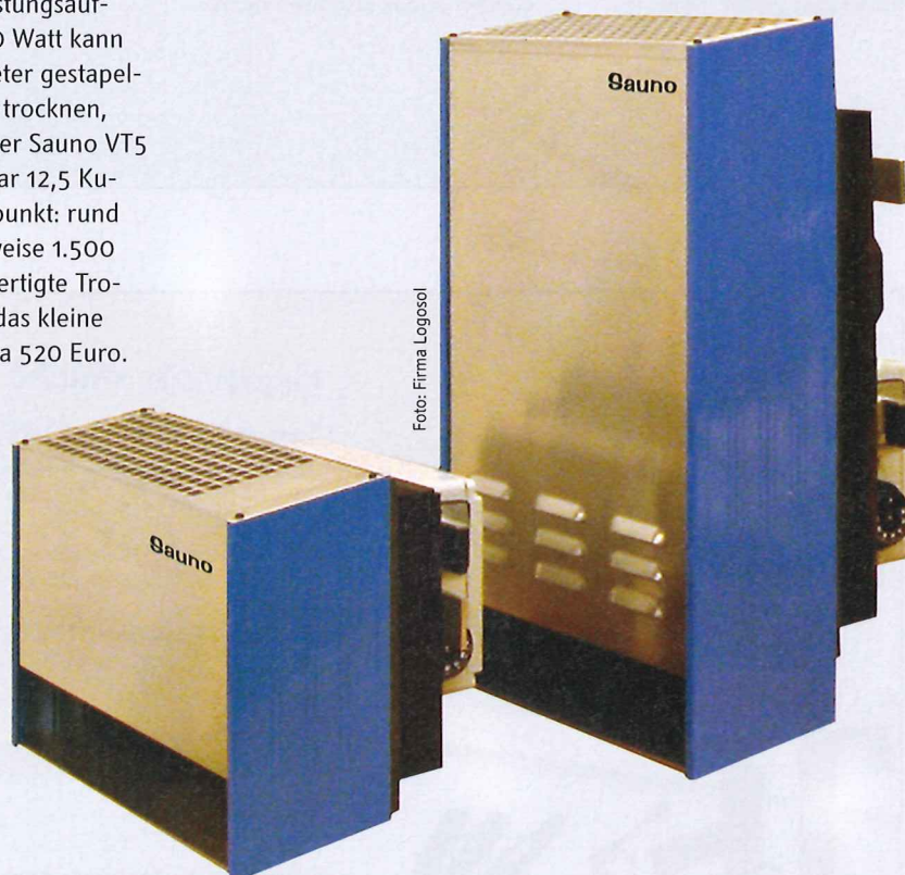
Die beiden Sauno-Aggregate im Größenvergleich: In der geeigneten Trockenkammer (nicht im Bild) holen sie die Feuchtigkeit innerhalb von Wochen aus dem Holz.
