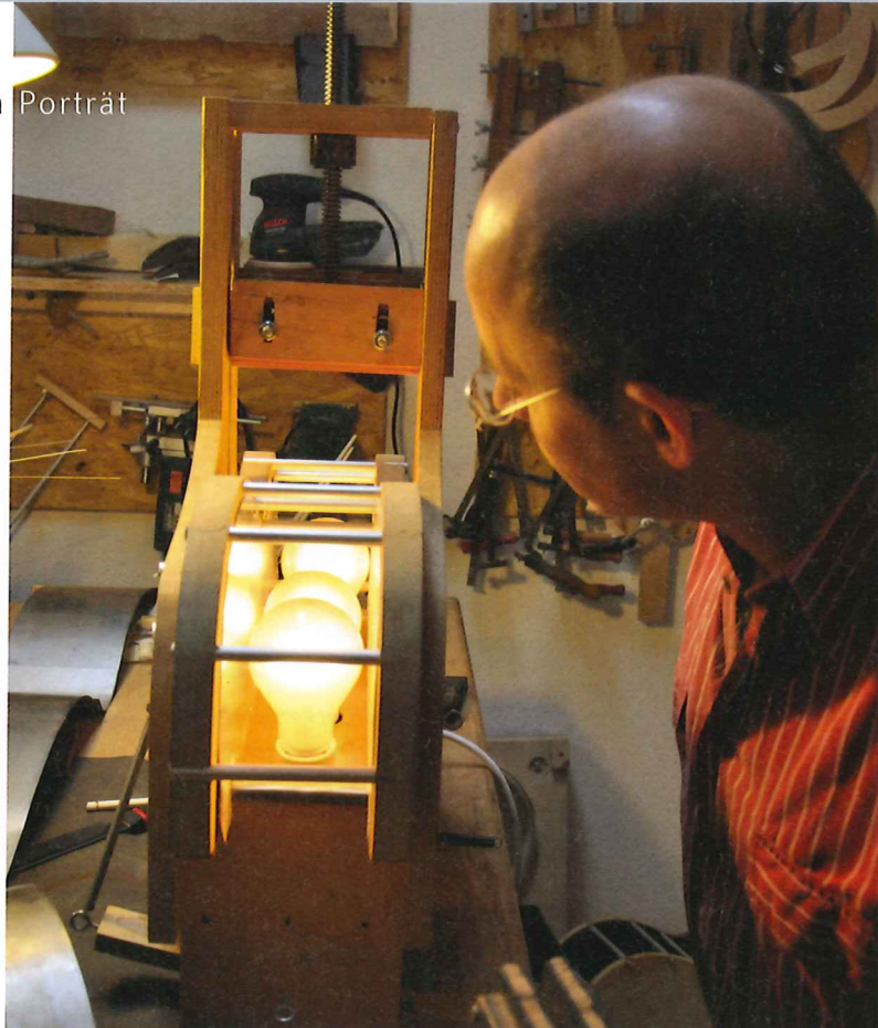
Der „Foxbender“, benannt nach dem Gitarrenbauer Charles Fox, erleichtert das Biegen der Zargen über der heißen Spezial-Birnen.
