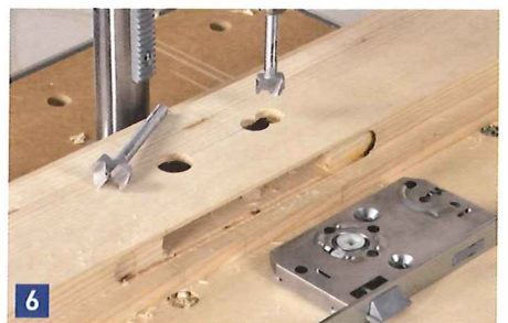
Das Loch für den Türdrücker bohren Sie mit einem 25 mm Forstnerbohrer. Für das Schlüsselloch einen 20 mm Bohrer einsetzen.
