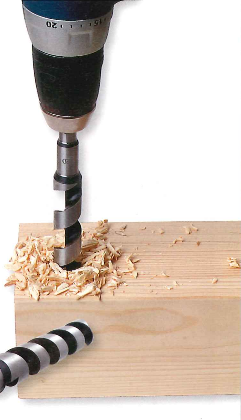
Schlangenbohrer können durch ihre gewendelte und sehr offene Form Späne aus großen Tiefen herauf fördern: wichtig bei sehr dicken Bauteilen. Sie haben oft Sechskantschäfte.
