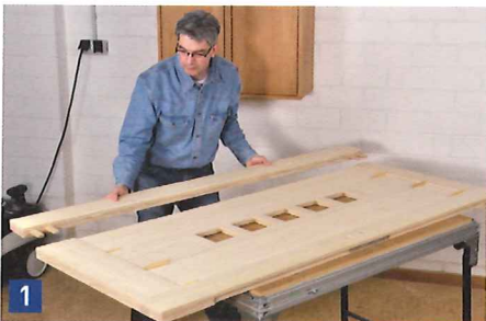
Leimen Sie die beiden aufrechten Rahmen mithilfe der 14 mm dicken Dominos an die restliche Tür. Damit sich dabei die Füllungen nicht verschieben, dünne Holzstreifen zwischenlegen.
