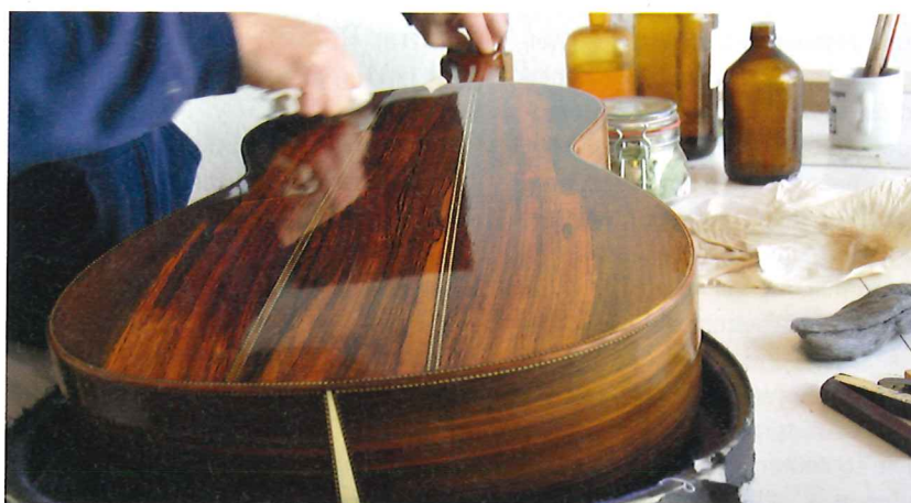
Schellack zum Abschluss: Ein Kursteilnehmer veredelt einen dreiteiligen Boden.
