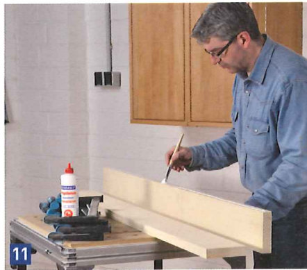
Die Füllungen werden aus zwei breiten Streifen verleimt. Dazu die Kanten die zusammengeleimt werden, sauber abrichten (gerade ...
