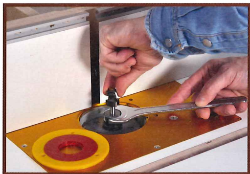
Highlight 1: Fräser bis 96 mm einsetzbar; Fräserwechsel von oben (je nach Oberfräse)
