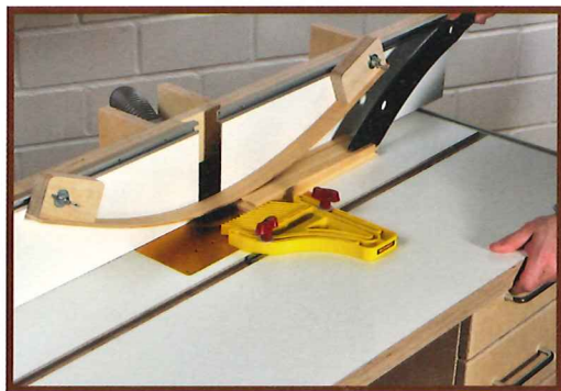
Highlight 4: Befestigungsschienen für Andruckbögen und -federn
