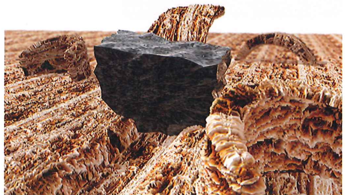
Siliziumcarbid ist etwas härter und vor allem regelmäßiger geformt. Es wird vor allem bei kurzfasrigen Werkstoffen eingesetzt, wie zum Beispiel MDF, oder für den Zwischenschliff.
