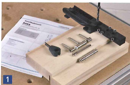
Für die dreiteiligen Türeinbohrbänder gibt es auch die passende Bohrlehre samt Anleitung. Trotzdem sollten Sie an Resthölzern zunächst einen Probeanschlag der Bänder durchführen.
