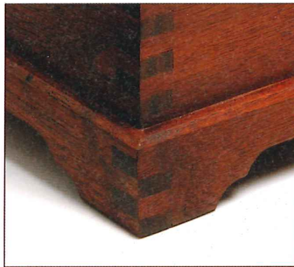
Akzentuierter Rahmen. Auch durch das Aussägen der Unterkanten eines Grundrahmens entstehen Füße.
