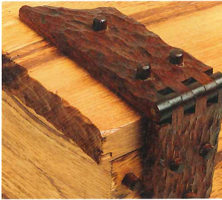
Holz. Selbst gemachte Scharniere unterstreichen die Handarbeit. Die flache Version (rechts) ist von unten geschraubt. Holznägel sichern die Varianten in L-Form (links).
