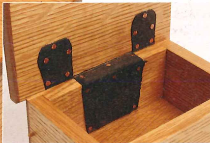
Leder. Drei Stücke – zwei in Richtung der Enden und ein Mittelstück –, mit Kupfer-nägeln angeschlagen, bilden ein besonderes Scharnier.
