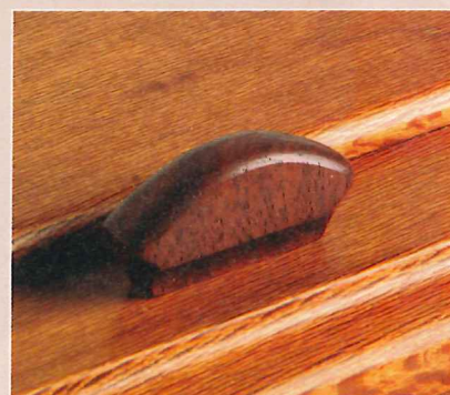
Fächer-Form. Runde und weiche Kanten geben diesem Griff ein graziles Aussehen, passend für leichte Deckel.
