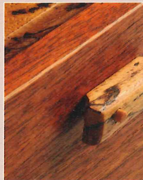
Vorne. Wenn der Griff vorne an einem angeschlagenen Deckel sitzt, dient er als Hebepunkt
