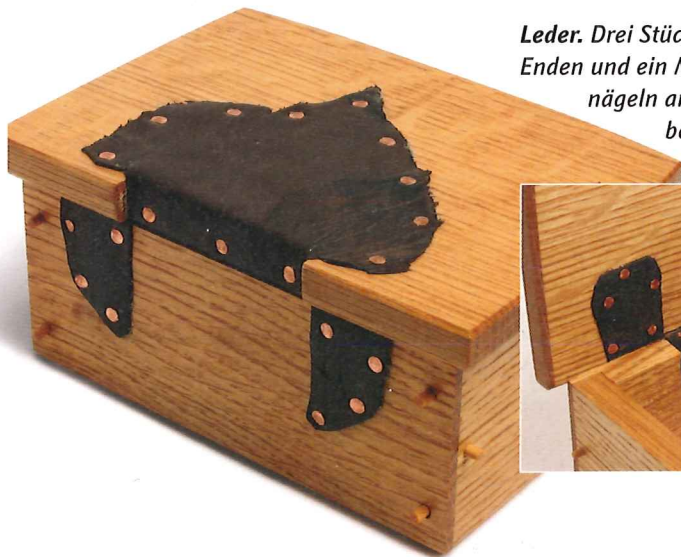
Holz. Selbst gemachte Scharniere unterstreichen die Handarbeit. Die flache Version (rechts) ist von unten geschraubt. Holznägel sichern die Varianten in L-Form (links).
