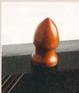
Gedrechselt. Kleine Drechselarbeiten ergeben wunderbare Griffe. Einzelne Messingschrauben halten sie fest.
