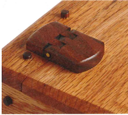
Holz. Selbst gemachte Scharniere unterstreichen die Handarbeit. Die flache Version (rechts) ist von unten geschraubt. Holznägel sichern die Varianten in L-Form (links).
