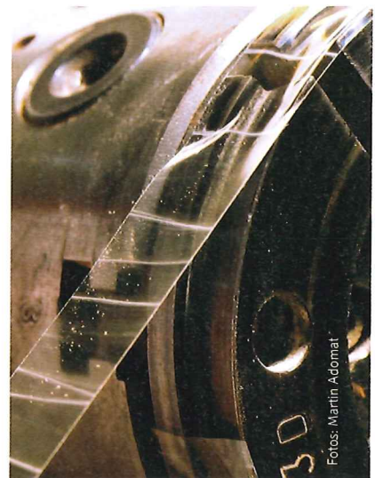
Schwarze Verfärbungen wie hier am Rezz der Schale lassen sich durch geschickt platzierten Tesafilm ausschließen.
