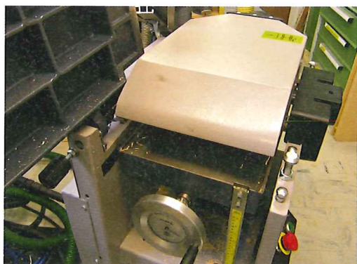
Die Verwandlung vom Abricht- in den Dickenhobel-Modus braucht nur wenige Minuten. Dazu werden Aufgabe- und Abnahmetisch hochgeklappt und die große Absaughaube montiert.
