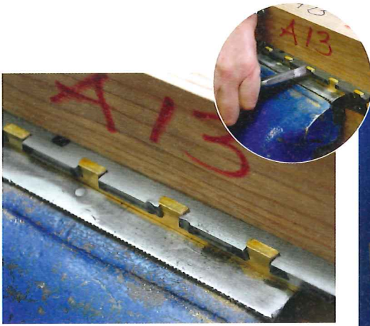
Mit verschiedenen Meißeln treibt Fritsche den Sohlenstahl so, dass er die Schwalben der Seiten umschließt: So entsteht eine unlösbare Verbindung.
