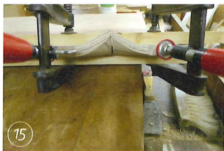
12 Die markanten „Ohren“-Griffe werden so gefertigt: Schneiden Sie in jeden der beiden Anleimer vier parallele Schlitz so, dass die Schnittfläche ein Dreieck ergibt. Passend dazu fertigen Sie sich etwas größere Furnierdreiecke.
