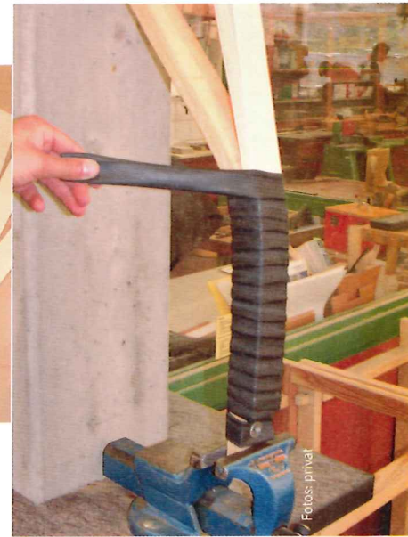
Das mit Leim versehene Furnierpaket wird Wicklung für Wicklung auf die Form gepresst und so sicher fixiert, bis der Kleber ausgehärtet ist.
