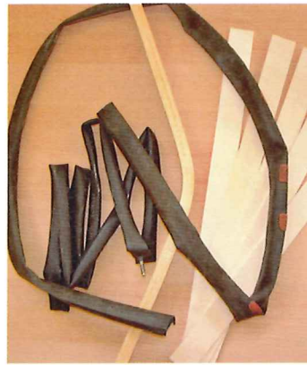
Die Gummistruktur des Fahrradschlauchs ist wie dafür gemacht, um gebogene Verleimungen unter die nötige Spannung zu setzen. Die sonst zur Form passende Gegenform wird so ganz überflüssig.
