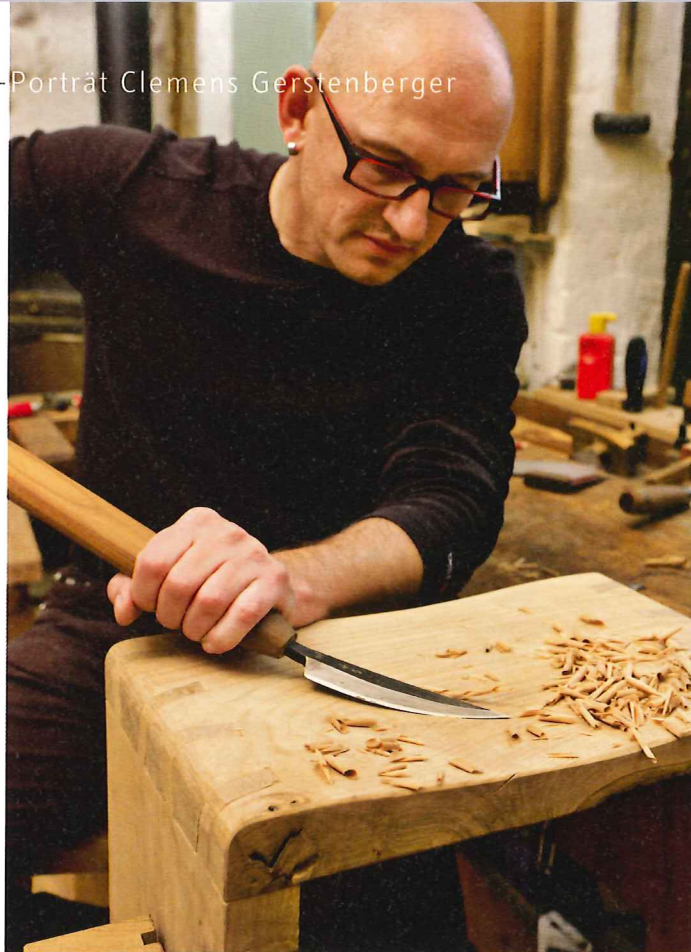
Yari Kanna heißt die japanische Urform des Hobels, die Gerstenberger regelmäßig in seiner Leipziger Werkstatt einsetzt.
