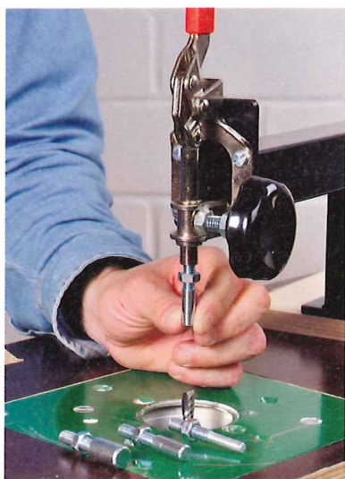
Eine frische Methode für den Frästisch: Mit einem Kopierstift lassen sich Schablonen von oben abfahren. Das erweitert Ihre Möglichkeiten radikal!
