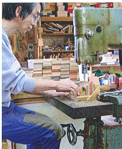
Die stationäre Oberfräse, ein japanisches Modell aus den 1970er Jahren, ist das zentrale Arbeitsmittel für die bisweilen winzigen Details der Schattellen.
