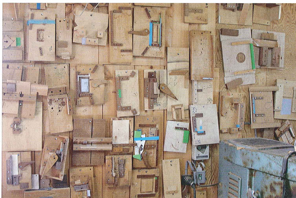
Die Wände hängen voller Schablonen für die Oberfräse. Das Werkstück wird meist mit kleinen Exzenterhebeln eingespannt.
