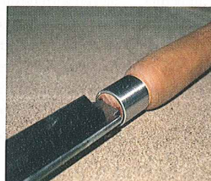
Maschinell oder von Hand lassen sich die Edelstahlrohr-Stücke auf Länge bringen. Als fertige Werkzeug-Zwingen strahlen sie schließlich bei selbst gefertigten Griffen.
