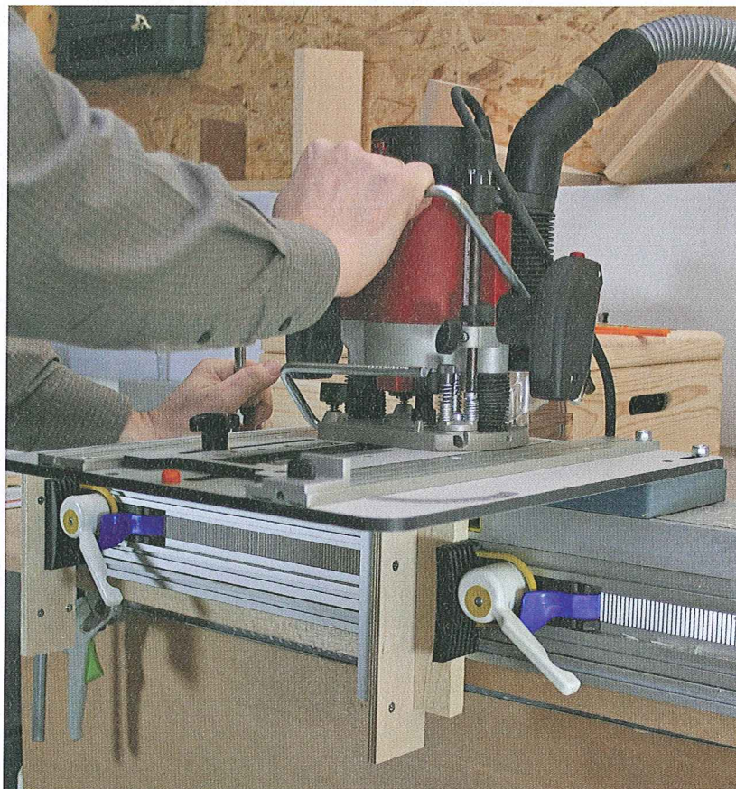
Der Grundaufbau der WoodRat mit Anschlägen und Spannhebeln. Dank des Eintauchbügels (Zubehör) bleibt die linke Hand frei, um über eine Kurbel die Gleitschiene unter der Platte und damit das eingespannte Werkstück zum Fräser zu verfahren.
