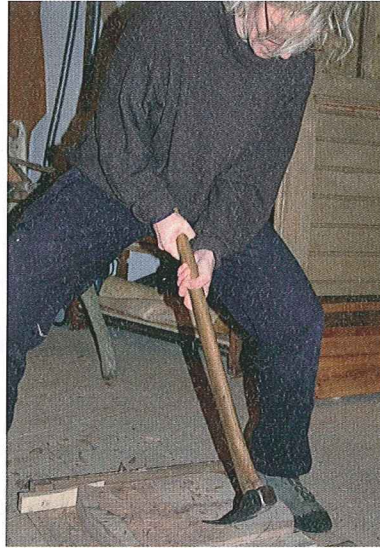
Das Aushöhlen von Stuhlsitzen wurde traditionell zwischen den Beinen mit langstieligen Hohldechseln gemacht. Eine weit gespreizte Beinstellung ist dabei sehr wichtig.
