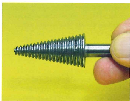
Ein konischer Aufspanndorn wie dieser ermöglicht die Nutzung der Drechselbank als Poliermotor. Allerdings ist das Wechseln der verschiedenen Baumwollscheiben etwas umständlich.
