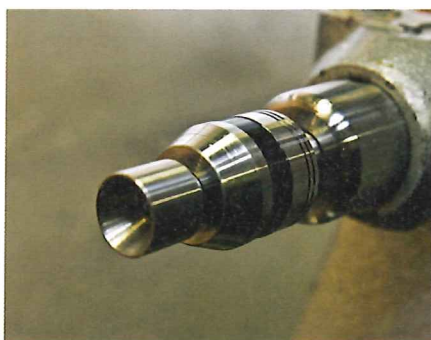
Alternativ kann auch ein solcher Hohlkegeleinsatz als Gegenlager verwendet werden. Eine Hutmutter, auf das Ende der Gewindestange geschraubt, sorgt für eine noch bessere Verbindung.
