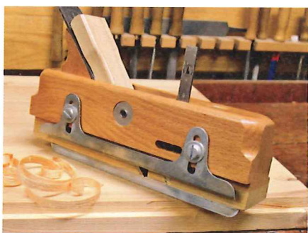
Mit dem Falzhobel sind Sie vereinzelt sogar schneller als eine Oberfräse.
