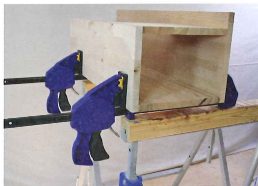
Wenn die Einhandzwingen erst mal sitzen, können in Ruhe weitere Zwingen an den Möbelkorpus gesetzt werden.
