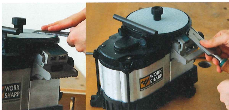
Auf der Oberseite lässt sich die Spiegelseite planen (links), ehe es unten in der Führung an die Fase geht. Einmal angeschliffene Winkel lassen sich exakt wiederholen.
