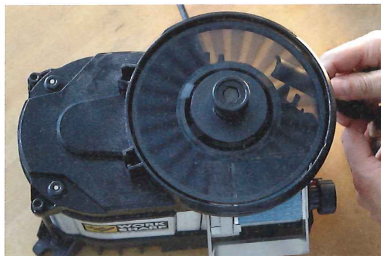
Blick durch die geschlitzte Scheibe: Sie ermöglicht bei gekrümmten Schneiden den Blick auf den kritischen Bereich. Eine Führung wäre hier wünschenswert.
