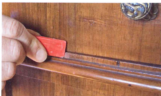
Hart- und Weichwax sind beim Reparieren von Möbeln nicht wegzudenken. Wie man auch größerer Schäden Herr wird, lesen Sie ab Seite 30
