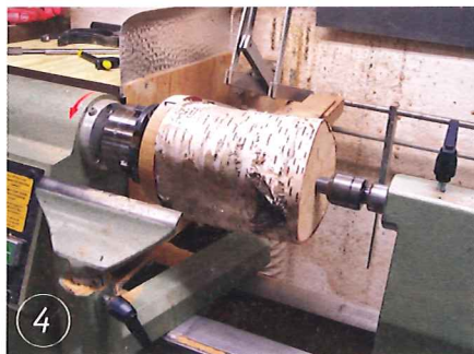
4 So wird der Rohling aufgespannt: Der Reitstock ist mit Körnerspitze samt Druckring bestückt und drückt das Holz von rechts kräftig auf die Haftscheibe.
