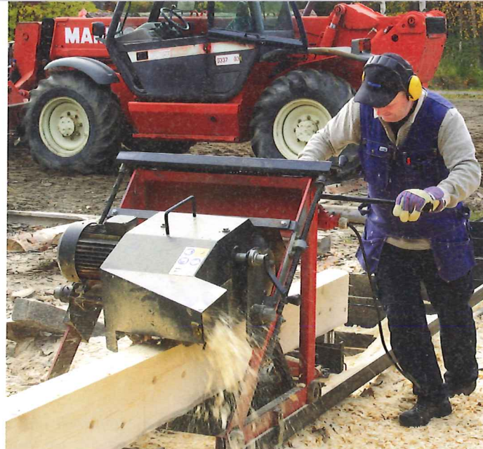
Auch das ist Teil des Kurses: Mit einem mobilen Sägewerk werden die Balken direkt an der Baustelle geschnitten. Im Bild links gut zu sehen: Der fertige „Dalaknut“ lässt dem Holz Platz zum Arbeiten.
