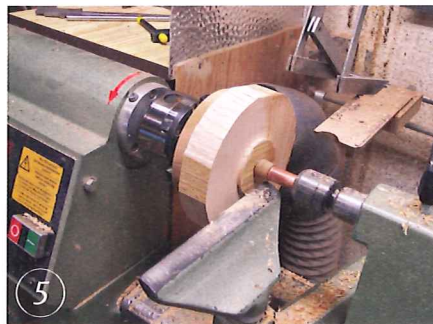
5 Auch flache Stücke wie hier ein Deckel lassen sich so einspannen. Im Bild übergibt die Körnerspitze den Druck nicht direkt, sondern über eine Filzplatte.
