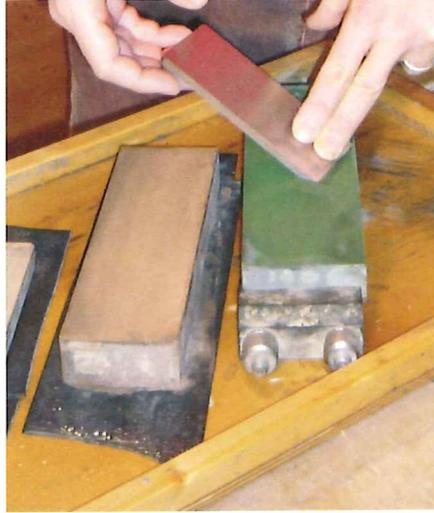
Beim Vor und Zurück des Eisens sollte die ganze Fläche des Steins ausgenutzt werden: Das vermindert die Aushöhlung. Wenn das Eisen wie hier parallel zur Schubrichtung steht, geht das besonders gut.
