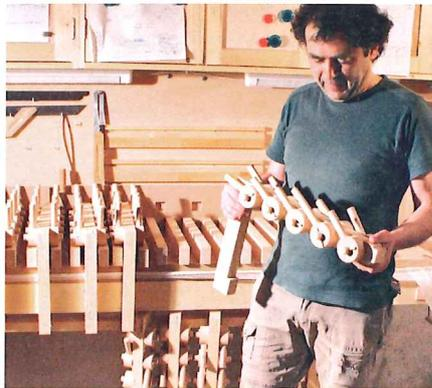
*So machen Sie Druck: Mit unserer ausgeklügelten Furnierpresse zum Selbstbau lassen sich auch große Plattenformate bändigen.*
