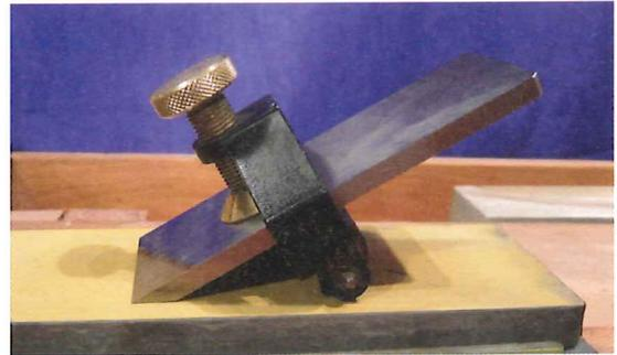
Die zu schleifende Fasenfläche ist umso kürzer, je dünner das Eisen ist: Dann kommt man von Hand schnell ins Kippeln und verschleift die Fase. Abhilfe bieten Führungen wie diese, die mit einer kleinen Rolle über den Stein gleitet.
