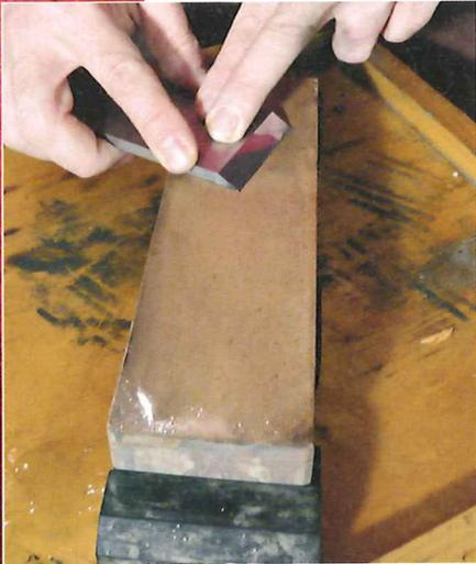
Die Spiegelseite muss nicht immer geschliffen werden, sollte aber einmal geplamt und poliert werden. Später wird sie nur noch bei Beschädigungen bearbeitet.
