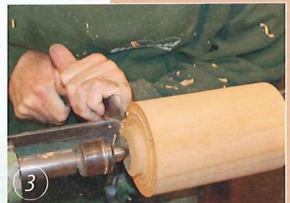
3 Damit die Büchse später ausgedreht werden kann, wird zum Spannen ein Zapfen Durchmesser 56 mm x 12 mm benötigt, den ich jetzt als nächsten Arbeitsschritt mit einem Schaber plan andrehe.
