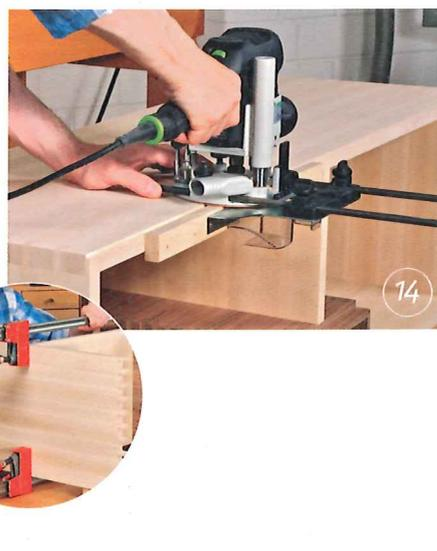
10 Beim Fräsen muss man dann nur darauf achten, dass die Führungshülse nicht etwa aus Versehen neben die Führungsfinger eingeschoben wird (rote Kreuze). Ansonsten kann man eigentlich nichts falsch machen.
