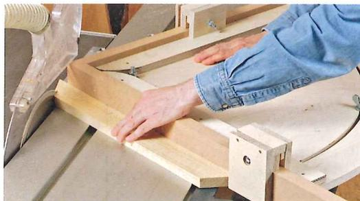
*Schluss mit offenen Gehrungen! Mit diesem Anschlag lassen sich beide Rahmenteile in einem Rutsch sägen – und passen so perfekt zueinander.*
