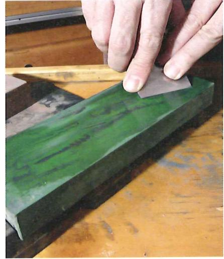
Der Wasserfilm übernimmt neben der Schmierung den Abtransport der abgenutzten Schleifkörner und der Stahlpartikel. Wichtig: Vor dem Wechsel auf einen feineren Stein das Eisen kurz mit einem Lappen abwischen.
