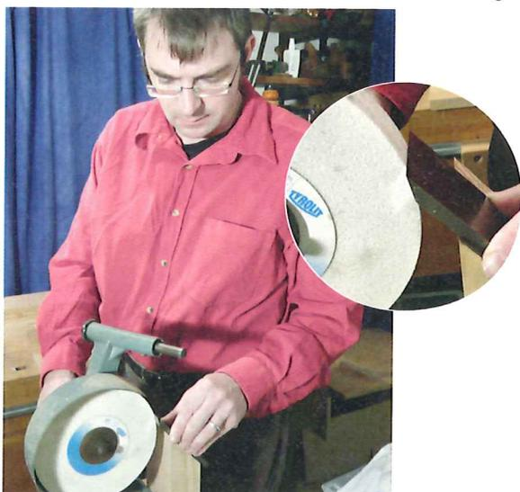
*Maschinen-Schliff mit runden Scheiben kann das manuelle Schleifen deutlich verkürzen. Dabei entsteht eine Hohlkehle an der Fase.*
