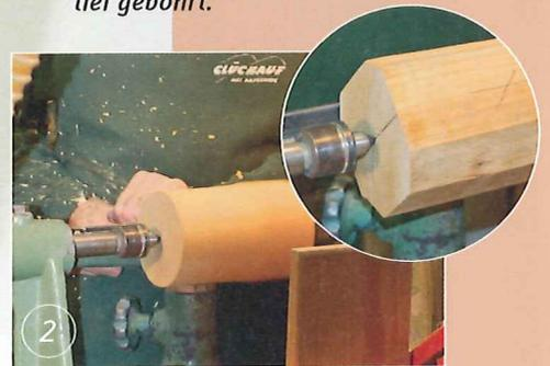
2 Die Kante wird zwischen den Spitzen im Mittelpunkt („1“) eingespannt und eine ebene Walze von rund 105 mm Durchmesser bei 2500 U/min mit der Schruppröhre fein gedreht. Prüfen Sie mit einem Lineal, ob die Walze plan ist.
