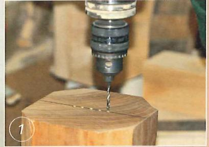
1 Die Dosenkante wird vorbereitet: Auf beiden Hirsseiten die Mittellinie anzeichnen, den Mittelpunkt und links und rechts zwei weitere Punkte anreißen (siehe Skizze). Zum späteren Einspannen wird an allen Punkten ein 2-mm-Loch rund 3 mm tief gebohrt.
