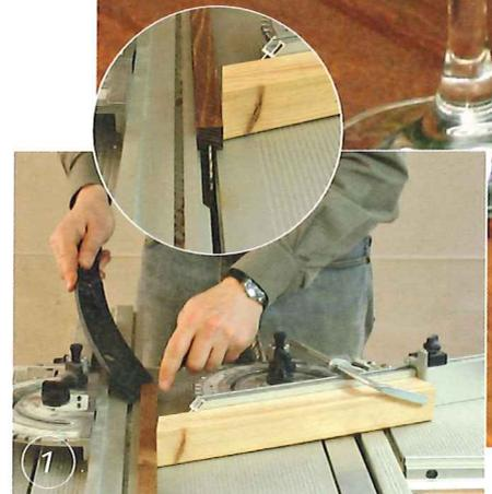
1 Beim Nuten der Stollen, Querstreben und Türteile auf der Tischkreissäge sorgt eine Andruckfeder für Sicherheit und hält die exakte Position der Leisten über dem Sägeblatt.
