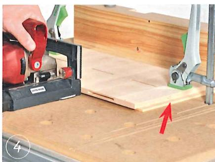
3 Um die Flachdübel für die Böden in den Regalen zu positionieren, hobeln Sie sich eine Leiste, die in der Dicke genau der Länge der Fingerzinken entspricht. Nutzen Sie eine passende Platte plus die Leiste (rot) als Anschlag bei den Nussbaumteilen. Die Schlitz in den Ahorn-Mittelwänden des Regals fräsen Sie – ohne Leiste – nur mit der Platte.
