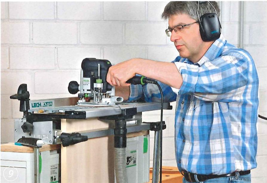
**8** Die 18 mm dicke Vorderkante des kleinen Regals wird unterdessen mit einem breiten Nutfräser auf dem Frästisch 25 mm tief und 8 mm hoch gefälzt, so dass nur 10 mm sichtbar bleiben. Für den Anschluss von Ahorn-Mittelwand und -Böden müssen hier noch je drei 20er Flachdübel mittig in alle vier Regal-seiten gefräst werden.
