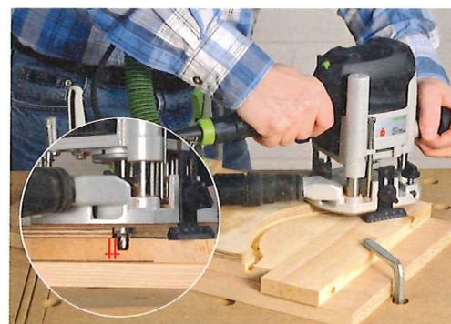
*Fräsen Sie in mindestens zwei Fräsetappen die Form der Schablone mit einem Nutfräser heraus. Dabei wird das Werkstück geringfügig größer als die Schablone ausgefräst.*
