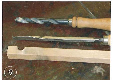
4 Jetzt auf beiden Seiten fest in Position „2“ einspannen. Ab jetzt wird es unwichtig, also die Drehzahl auf 2000 U/min vermindern. Die Handauflage steht etwas über der Mitte, parallel zum Werkstück und möglichst nah dran. Jetzt werden vier Millimeter (halber Lochabstand) mit der Schruppröhre „im Schatten“ entfernt.
