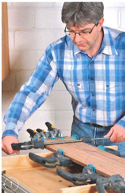
1 Für Korpus und Regale fertigen Sie sich die Platten aus Vollholz selbst: Dazu von der geraden Bohle Streifen schneiden, die der Bauteildicke plus 5 mm Zugabe entsprechen. Diese werden auf der Abrichte gefügt, in Streifen verleimt und die Platten dann fein ausgehobelt.
