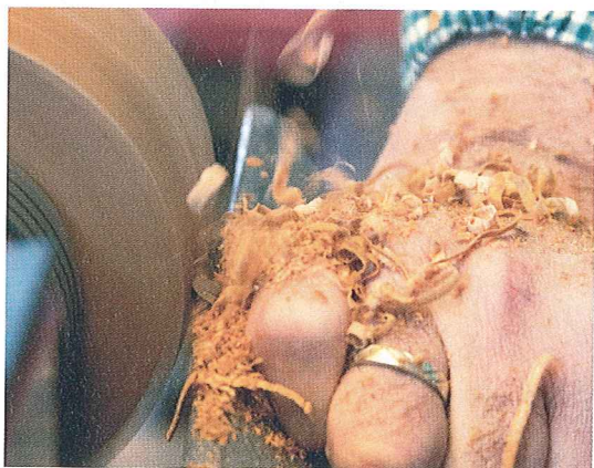
Fast nur mit dem Schaber tastet sich Otto Pfisterer langsam, aber zielsicher ins Holz.
