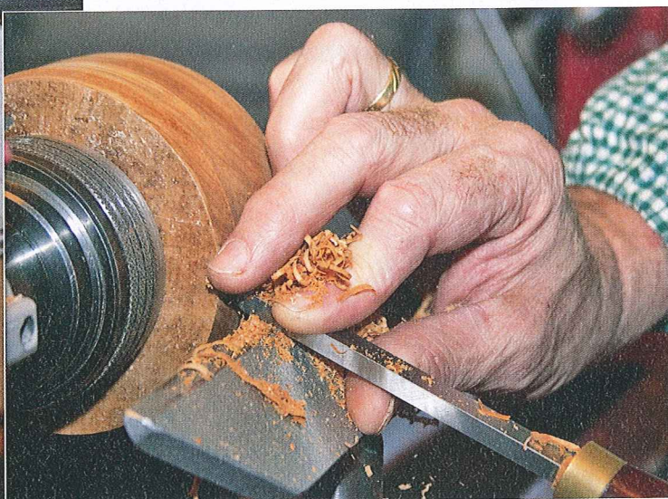
Mit der linken Hand führt Otto Pfisterer das Werkzeug, seine rechte ertastet den richtigen Winkel. Auf Röhren verzichtet der blinde Drechsler weitgehend.
