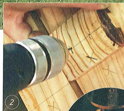
2 Zwischen den Stoßstangen-Teilen werden noch quer zwei Tragehölzer eingedübelt. Nach dem Anzeichnen wird ein Hilfsbrettchen an den Strich angelegt und dann passend mit zwei Millimetern durchbohrt. Das geschieht an beiden zu verbindenden Teilen. So wird markiert, wo der 16-mm-Dübelbohrer ansetzen muss.
