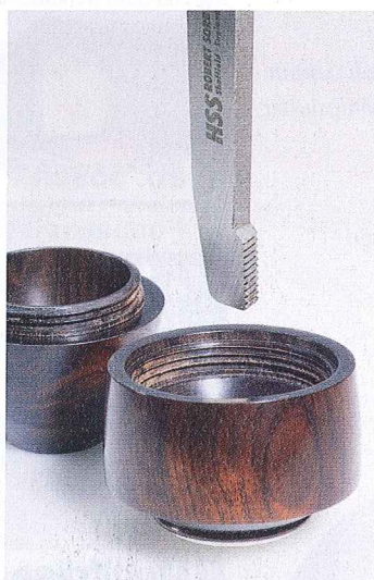
Gewinde am Holz: Mit dem Strähler ist das auf der Drechselbank möglich – in der kommenden Ausgabe!
