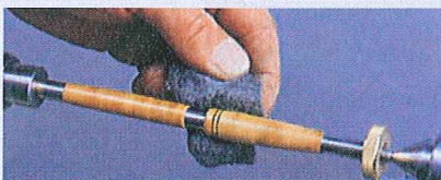
Reinigen der Holzoberfläche im gebrannten Bereich mit Stahlwolle.
