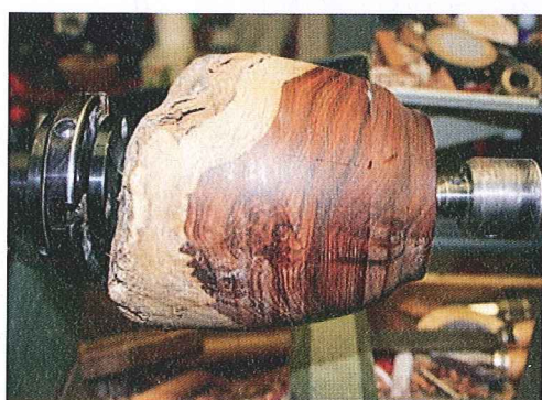
Tief hinein greifen die langen Spannzangen in diese Vasenrohling und halten das Werkstück auch im unrunder Zustand sicher.
