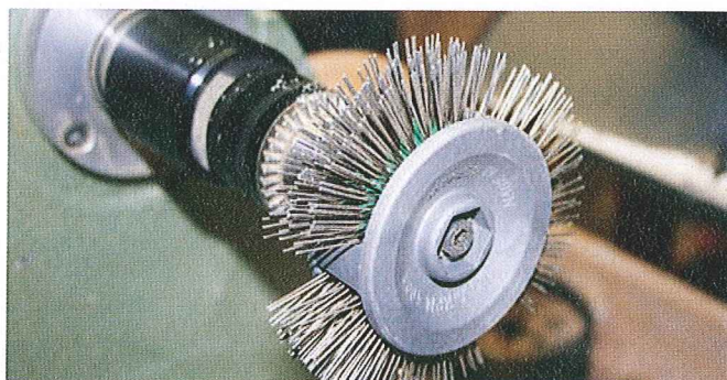
Vor allem bei Hölzern mit starkem Unterschied zwischen weichem Frühholz und festem Spätholz in jedem Jahrring erzielt das Bürsten tolle Effekte.
