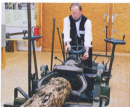
Reiner Klinkel hat als junger Zimmermann noch an der Säge gearbeitet. Hier bringt er den Stamm auf dem Gatterwagen auf die richtige Spur.
