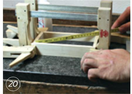
18 Der Korpus wird exakt auf dem Boden ausgerichtet und verleimt. Mit Leisten verteilen Sie den Druck gleichmäßig auf das gesamte Werkstück.
