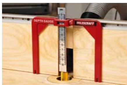
*Die Tiefenlehre ist beim Einstellen des Frägers in einem Frästisch eine große Hilfe. Dabei kann die Fräshöhe und die Frästiefe über die verschiebbare und arretierbare Skala millimetergenau abgelesen werden.*
