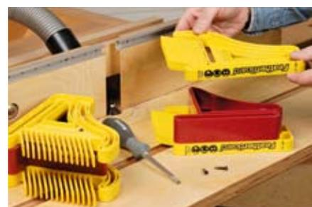
*Müssen besonders hohe Werkstücke sicher an den Anschlag gedrückt werden, können zwei Milescraft-Andruckfedern über ein Zwischenstück miteinander verschraubt werden.*
