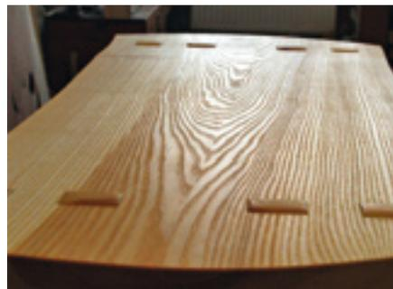
*Der spiegelfeine Glanz auf der Oberfläche ist das Ziel jeder Arbeit aus der Allgäuer Werkstatt. Erzielt wird er ausschließlich mit dem Hobel und etwas Schellack.*
