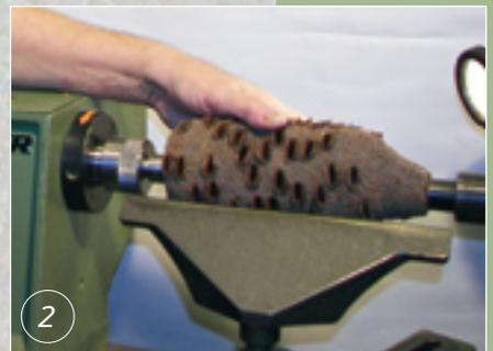
2 Ermitteln Sie die Drechselachse und fixieren Sie den beidseitig leicht angebohrten Rohling zwischen den Spitzen. Von Hand durchdrehen, um den ausreichenden Abstand zur Handauflage zu kontrollieren.
