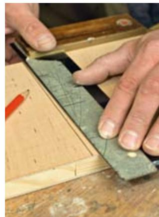
Wenn alles stimmt, muss sich die Zunge mit dem Strich auf der ganzen Linie in Deckung bringen lassen. Wenn nicht, ist entweder ein neuer Winkel fällig oder (bei höherwertigen Modellen möglich) eine Neujustierung.
