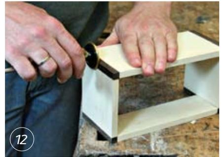
7 Die Schnittkanten lassen sich gut mit dem Reformputzhobel versäubern. Damit die Schublade später leichter ins Fach gleitet, erhält das Vorderteil innen eine kleine Fase. Maximal sollten zwei Millimeter Material durch das Trennen und Hobeln verloren gehen!
