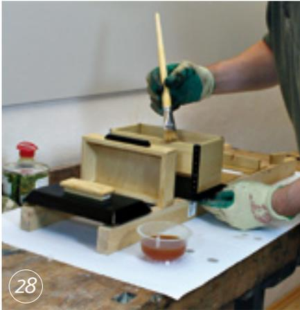
28 **Finish:** Alle Flächen und Kanten werden mit 240er Körnung geschliffen, alle Teile einmal mit flüssigem Holzwachs eingelassen. Polieren mit der Sisalbürste verleiht der Schatulle sanften Glanz.
