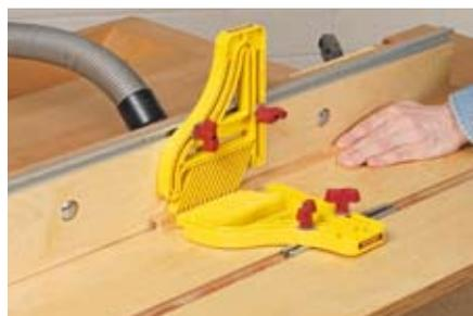
*Verhindert kippen! Mit zwei Andruckfedern können Sie beispielsweise einen großen Falz aus einer Leiste herausfräsen. Der gesamte Gefahrenbereich ist durch die Andruckfedern fast vollständig verdeckt.*
