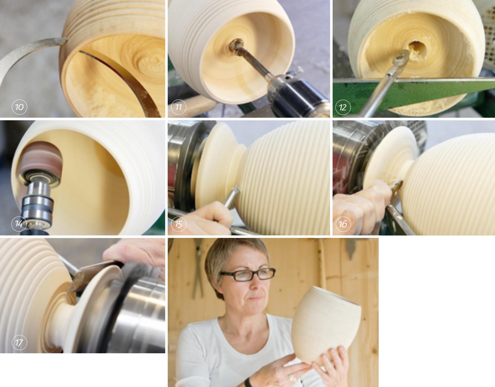
Das Futter während des Drechselns immer wieder nachziehen, denn das nasse Holz ist sehr weich und kann unter dem Arbeitsdruck leicht nachgeben oder etwas schwinden. Vom Spannfutter ausgehend grenzen Sie mit dem Bleistift etwa 2,5 bis 3 Zentimeter als Arbeitsraum für das spätere Abstechen des Gefäßes.
