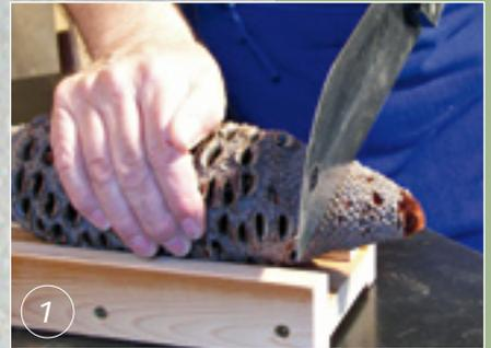
1 Um die Frucht zwischen den Spitzen einspannen zu können, werden an beiden Enden parallele Flächen mit einer Feinsäge hergestellt. Dabei wird die Frucht in einer Lade fixiert.
