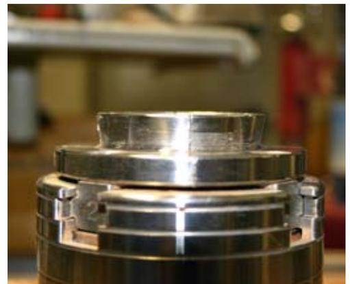
*Die abgeschrägte Bauart der Schwalbenschwanz-Backen sorgen für den richtigen Grip – sofern der Rezz im gleichen Winkel „hinterdreht“ wird.*
