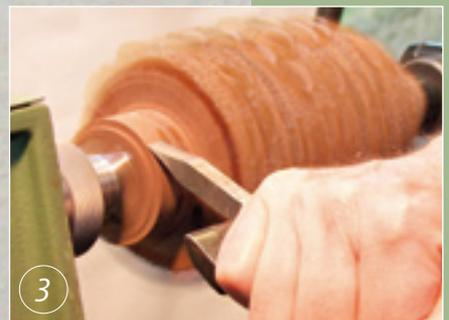
3 Zunächst wird am Spindelstockende bei etwa 1400 U/min ein Zapfen für die Aufnahme in ein Backenfutter angedreht. Dabei verwende ich einen 10-mm-Plattenstahl.
