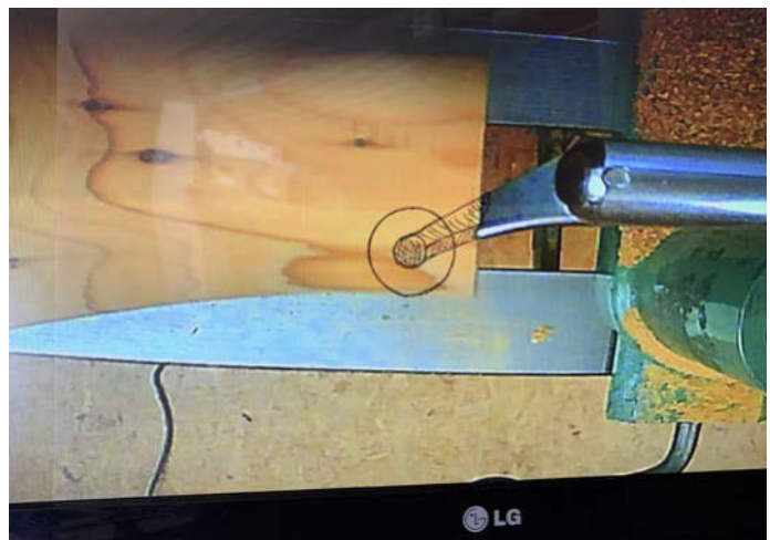
Das Ergebnis: Der Bildschirm zeigt die Schneide innerhalb des Werkstückes als Geisterbild. Wenn der Wandstärke-Kreis die Werkstück-Kontur berührt, ist die Wunschstärke erreicht.
