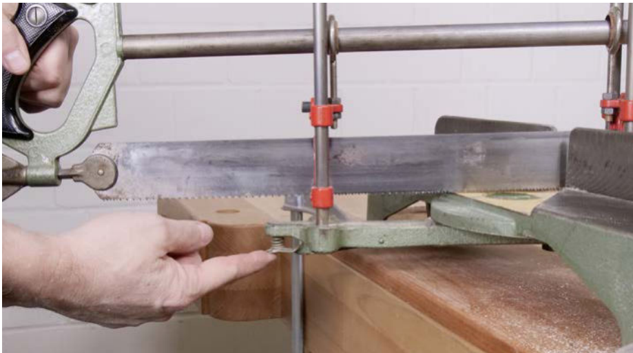
Diese vier Stangen stecken fest in der Einstellschiene, die sich auf die nötigen Standard-Schnittwinkel verstellen lässt. Dazu wird eine federbelastete Sperre gedrückt ...
