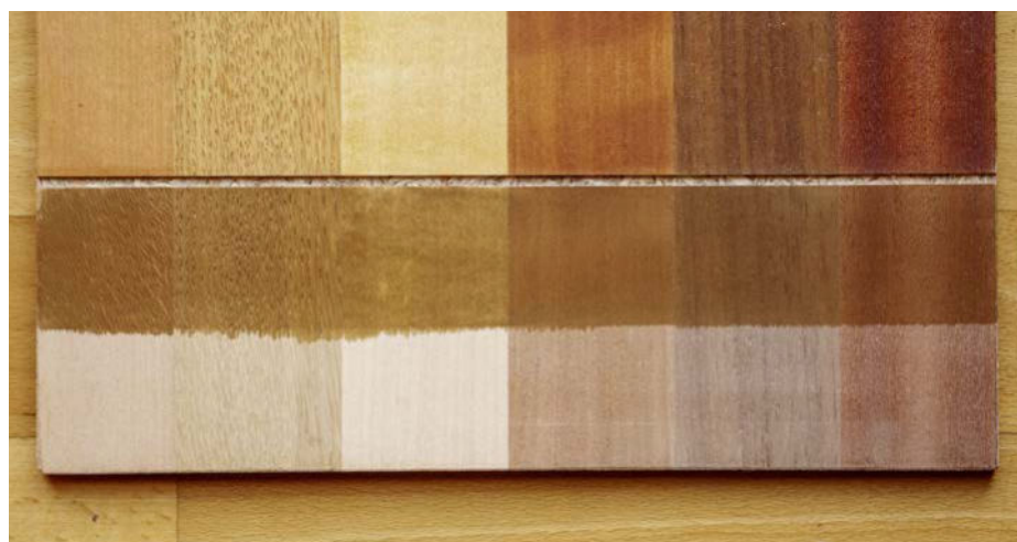
Alle zuvor unterschiedlich farbigen Holzarten haben sich durch die braune Beize (mittig) farblich angenähert. Ist die Beize getrocknet, wirkt sie matt. Der anschließende Überzug mit Lack oder Hartwachsöl lässt die gebeizten Flächen wieder satter und dunkler wirken.
