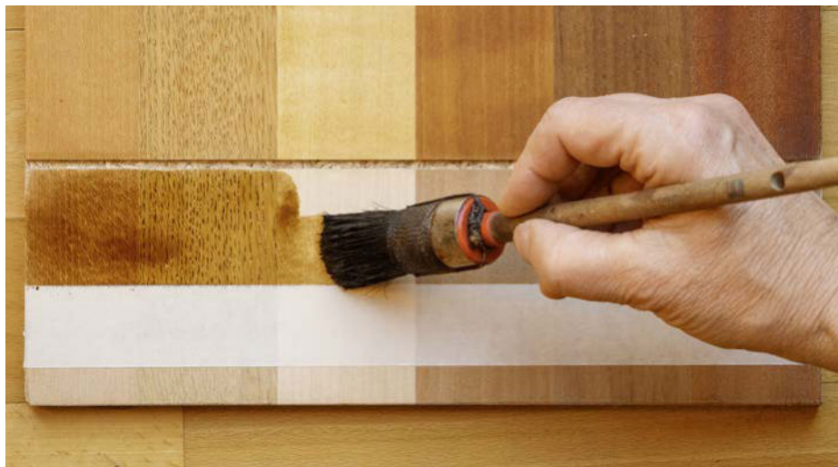
Das Brett ist mit Hartholzstreifen furniert (von links: Buche, Eiche, Ahorn, Kirschbaum, Nussbaum, Mahagoni). Alle werden in einem Streifen mit derselben braunen Wasserbeize gebeizt. Dadurch kann man Holzarten einander angleichen oder imitieren.
