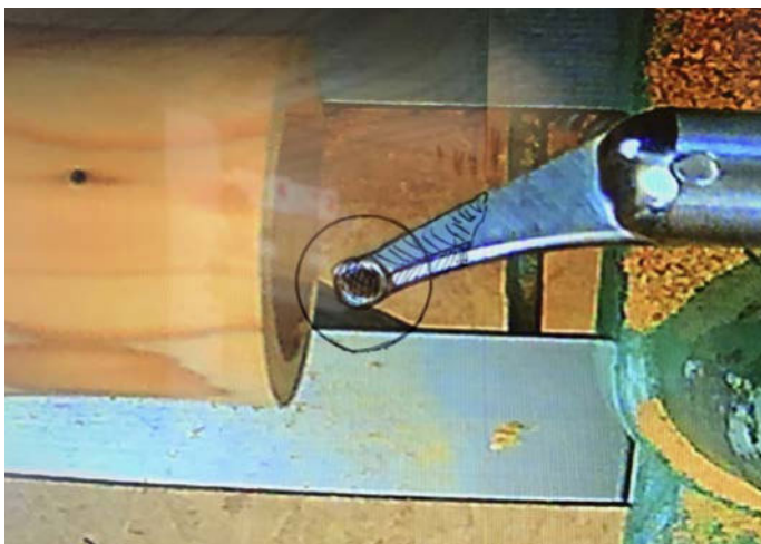
Auf der Schutzfolie des Bildschirms ziehe ich jetzt das Werkzeug und die vorgesehene Wandstärke nach. Hier im Bild das Ergebnis, die Schablone ist bereits wieder entfernt.
