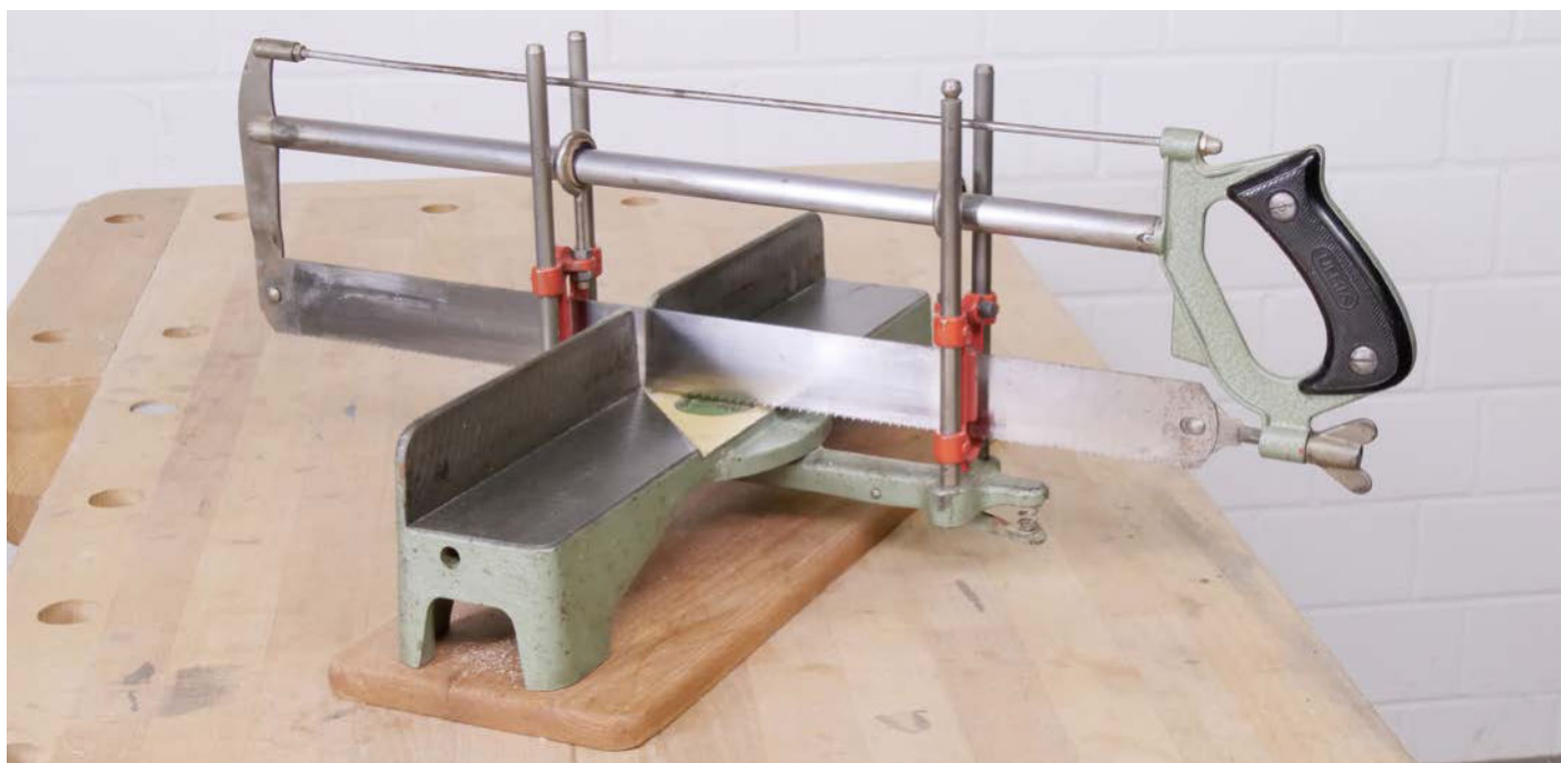
Mit ein, zwei Handbewegungen ist eine klassische Gestellsäge auf die Hobelbank gehoben. Die untergeschraubte Holzplatte schützt die Bankoberfläche und hier packen auch die Zwingen an, um sie darauf zu halten.
