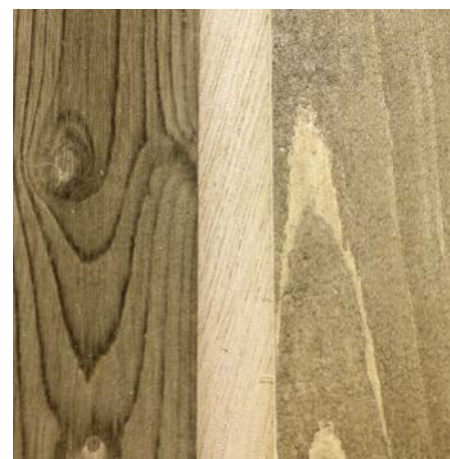
Ein weiteres Beispiel: Nur Positivbeizen ergeben ein positives Beizbild: Dunkle Jahrringe bleiben dunkel (links). Wasser- und Alkoholbeizen färben diese aufgrund ihrer Dichte weniger und erscheinen unnatürlich hell (rechts).
