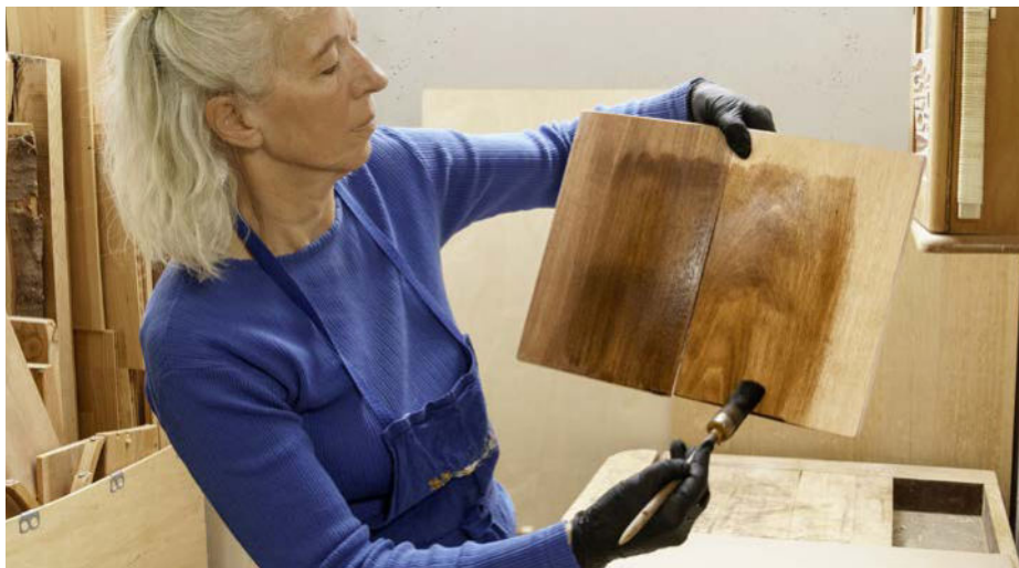
Das Ausgangsmaterial macht den Unterschied: Auf dem edlen Nussbaumfurnier links wirkt derselbe Farbton dunkler und eleganter als auf der unruhigen Multiplexplatte mit Schäl furnier rechts. Beizpinsel mit Kunststoffmanschette sind hier am besten geeignet.
