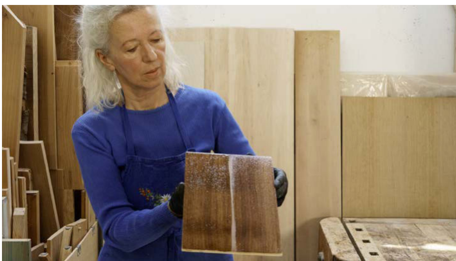
Frisch aufgetragen sind beide Überzüge (links Hartwachsöl, rechts Acryllack auf Wasserbasis) in ihrem Glanzgrad ähnlich. Nach dem Trocknen feuert der Acryllack das gebeizte Holz jedoch weniger an als Hartwachsöl und wirkt daher unauffälliger.
