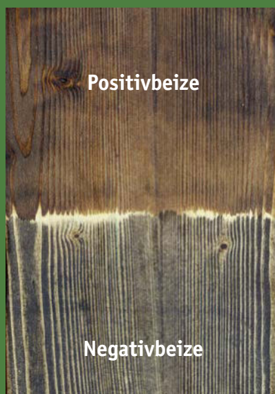
Ein weiteres Beispiel: Nur Positivbeizen ergeben ein positives Beizbild: Dunkle Jahrringe bleiben dunkel (links). Wasser- und Alkoholbeizen färben diese aufgrund ihrer Dichte weniger und erscheinen unnatürlich hell (rechts).
