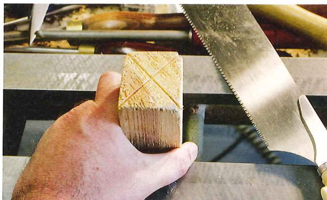
*Mit der Hand- oder der Bandsäge lässt sich die Mitte einer Kante einfach ermitteln.*
