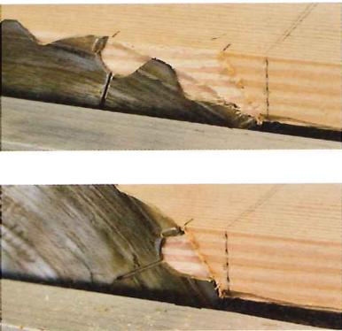
Die ausgefahrene Höhe des Sägeblatts bestimmt, wie weit die Kreissäge bei ausgesetzten Schnitten unten „vorprescht“.
