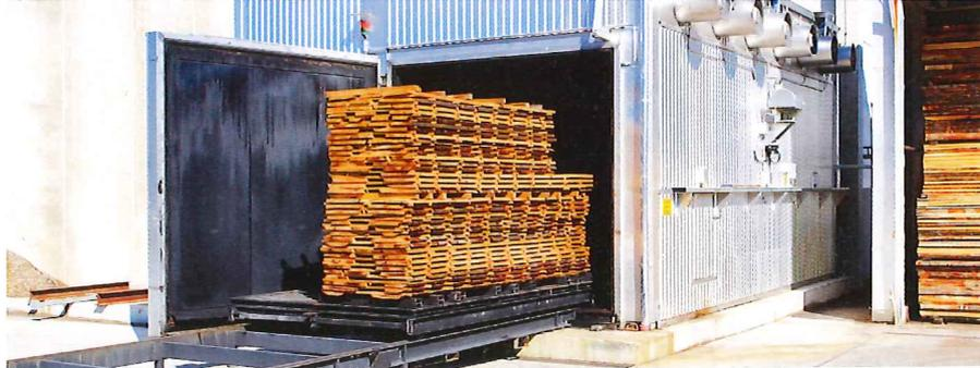
In großen Wärmekammern werden die Holzstapel unter genau definierten Temperaturen und Feuchtigkeitsgraden zu Thermoholz veredelt.
