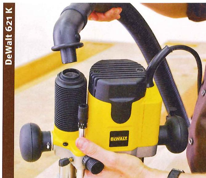
Staubabsaugung durch eine Säule: DeWalt wartet bei seinem Entwurf mit einigen pfiffigen Details auf.
