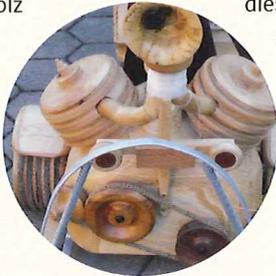
ist die Geschwindigkeit identisch. Unter dem Tankdeckel ist die Batterieladestation. Die Hinterräder sind jeweils aus elf Scheiben gedrechselt, auf jeder zweiten Scheibe ist ein Keilriemen, damit das Trike auf Gummi läuft. Das Vorderrad war auf diese Weise nicht zu konstruieren, deshalb habe ich es aus Gummi belassen, lediglich die Felge habe ich
